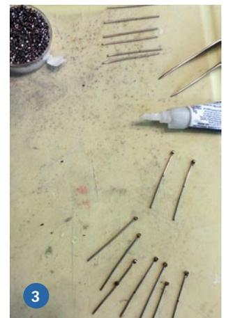
**1) Dieser Flaschenzug für die Großschot entstand aus 0,3 Millimeter dickem, schwarzem Papier. 2) Beim Auftakeln wird der obere Block mit lösablen Hacken am Großbaum befestigt. 3) Auf der Spitze der Relingstütze und auf Höhe von 20 Millimeter wurden mit Sekundenkleber Perlen in Innoxfarbe aufgeklebt**
