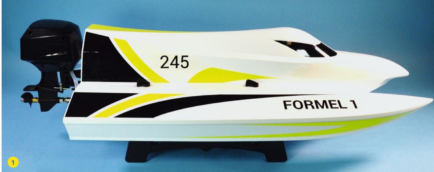
1) Das FORMEL1-Tunnelmodell gibt es zwar in dieser Form nicht mehr zu kaufen, aber ein kleinerer Nachkömmling mit den gleichen Eigenschaften ist bei HobbyKing erhältlich. 2) Das Modell mit geöffnetem Innenraum. 3) Der Propeller ist im Ruder gelagert, der Außenbordmotor nur Imitation. 4) Der kompakte und gut abgedichtete RC-Einbauraum
