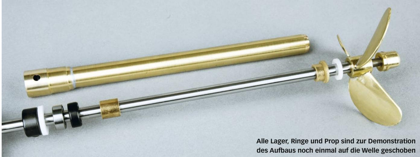
Alle Lager, Ringe und Prop sind zur Demonstration des Aufbaus noch einmal auf die Welle geschoben
