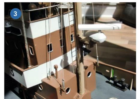
1) Der verbreiterte Rumpf ist fertig. 2) Das offene Beiboot, das bereits nach dem ersten Umbau so bestand, wurde beibehalten. 3) Das Radar am vorderen Mast wird über ein umgebautes Mikroservo angetrieben. Die Auslösefunktion des Schlepphakens wurde mit einem Hubmagneten realisiert
