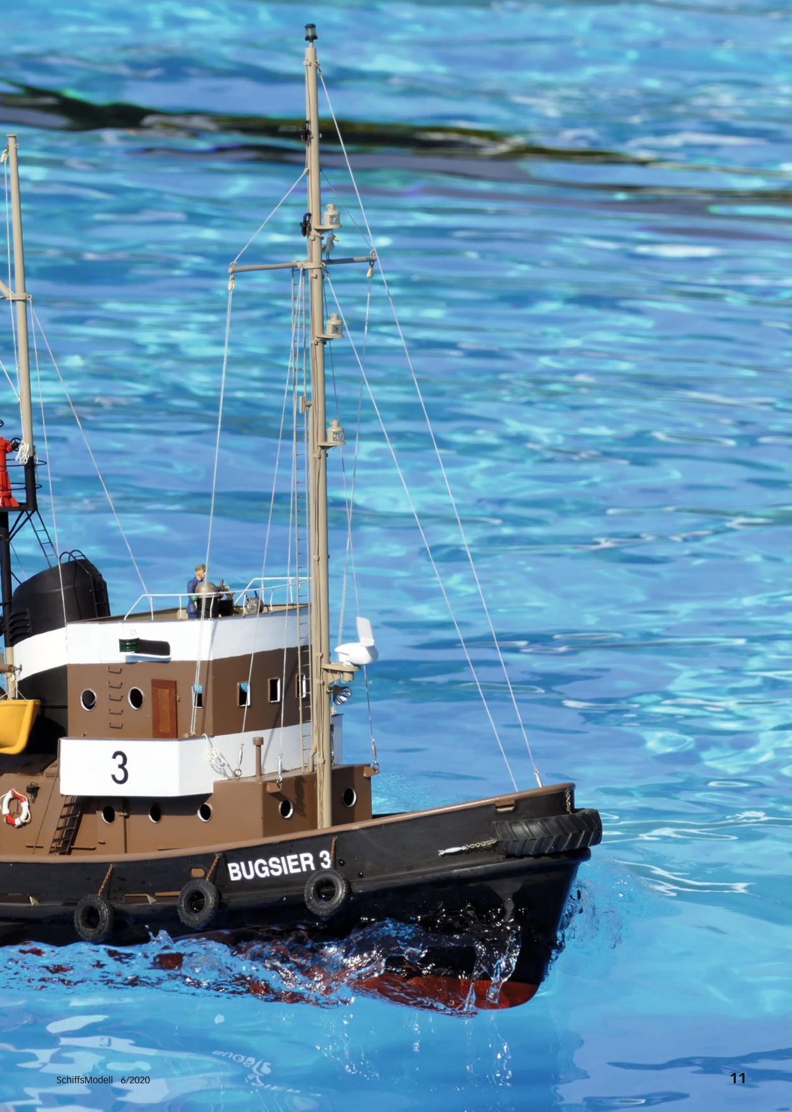
**B**ereits im Jahr 2009 erfolgte eine Komplettrestauration nach Originalbildern im Bauzustand nach dem Umbau des Originals 1967. Weiterverwendet wurden lediglich die Rumpfschale mit Schanzkleid sowie die Winden. Die Aufbauten entstanden komplett neu aus 0,5 Millimeter (mm) dickem Platinenmaterial (FR4) und Messingblech. 2018 war nun nach weiteren neun Jahren Fahrbetrieb eine Generalüberholung erforderlich, die ich auch gleich zum Anlass für einige kleine Ergänzungen genommen habe.
