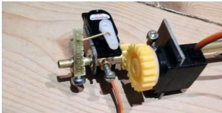
Dieses Bild zeigt die Ansteuerung des Löschmonitors. Das Servo zum Heben und Senken des Monitors (links) wird komplett mit geschwenkt
