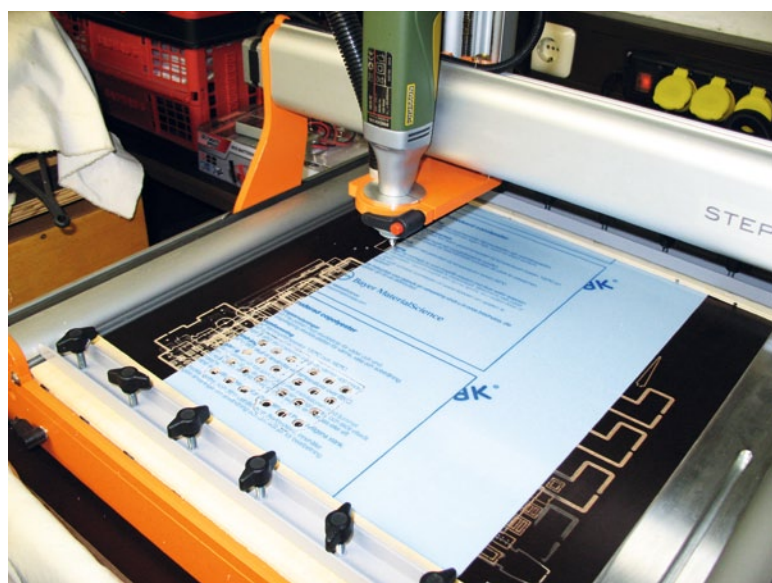
Aus einer 1 Millimeter starken Plexiglasplatte entstand die Abdeckung der neuen Optionsplätze
