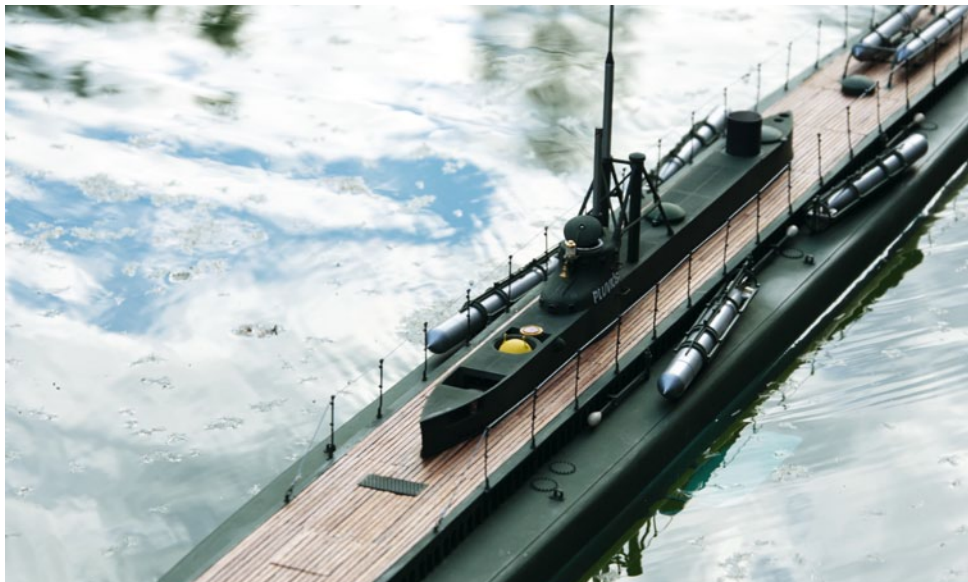
Blick auf die Brise-lames, Torpedos und dem gelben Rettungssignalball
