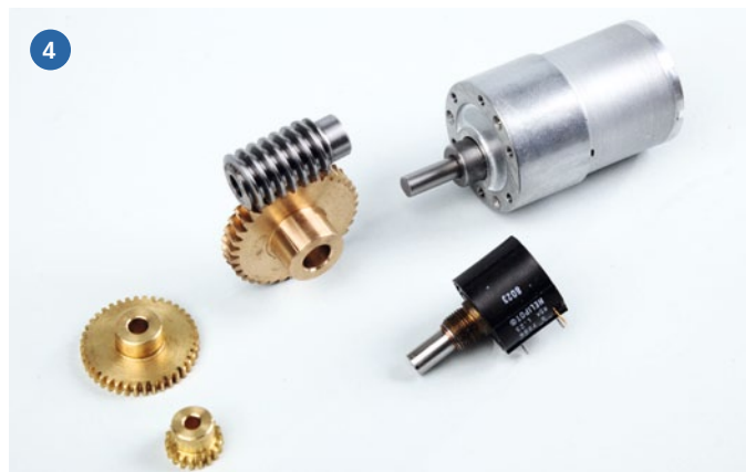
1) Zusammenstellung von Kegelrad und Glocke – man erkennt, dass immer nur eines greifen kann. 2) Die Komponenten für den Axial-Versub in einzelnen Gruppen. 3) Exzenter für den Schubantrieb. 4) Der Getriebeantrieb für den Axialversub
