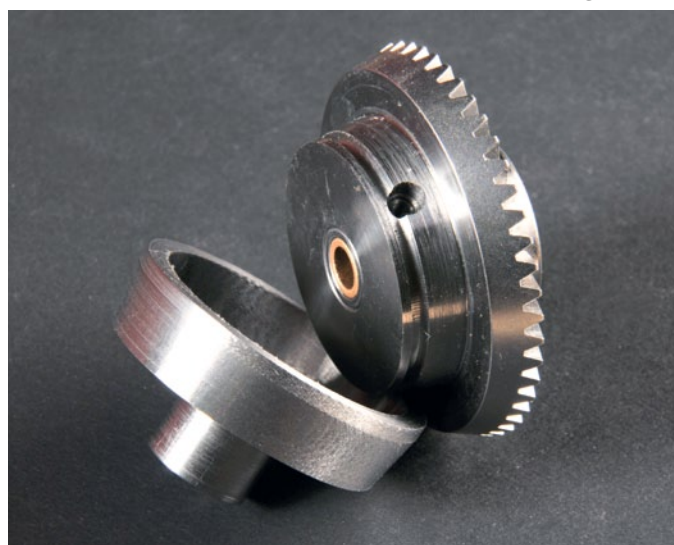
Eines der beiden großen Kegelräder mit Kupplungsglocke – sie bilden das „Grundelement“ des Wendegetriebes
