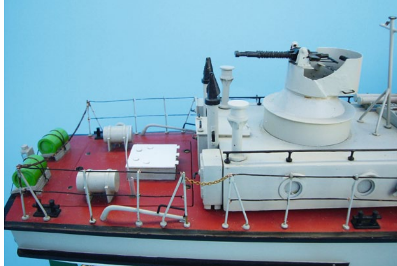
Das Achterdeck der 1:31-TÜMMLER. Über die Revisionsluke hat man Zugang zur Ruderanlage
