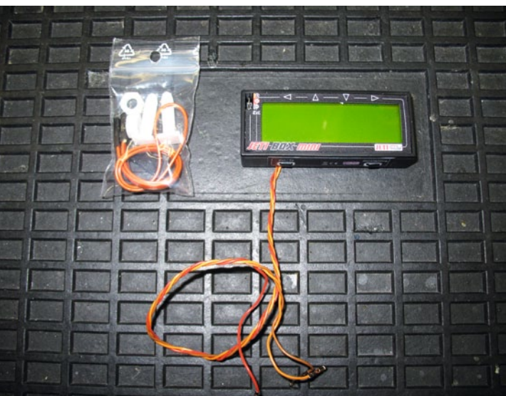
Über dieses Display werden später sämtliche Einstellungen vorgenommen und die Telemetrie-Daten angezeigt
