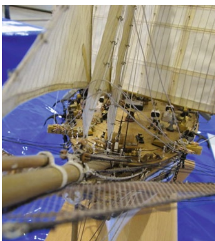
Deutlich zu erkennen: Der seitlich versetzte Außenklüverbaum
