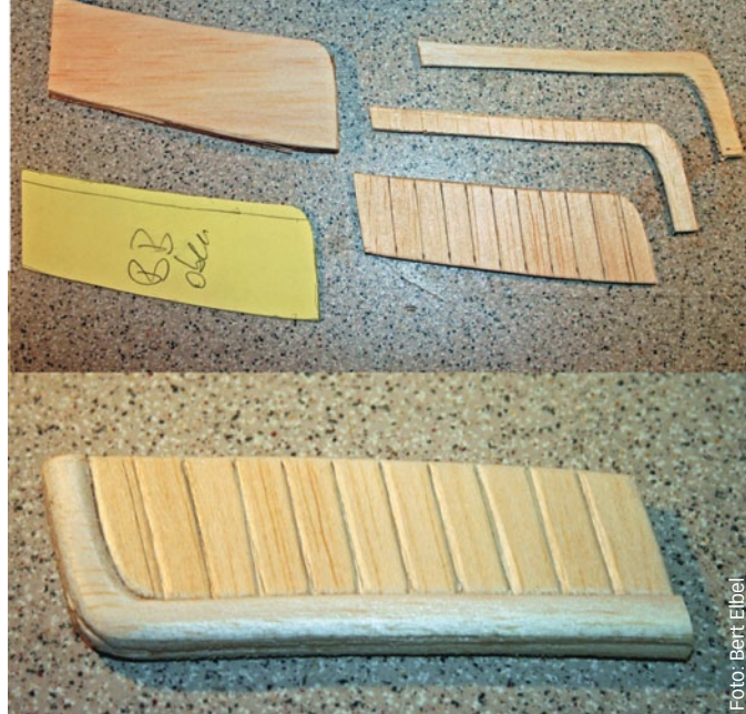
Baustufenfotos eines Sitzpolsters, bereits mit Harz getränkt
