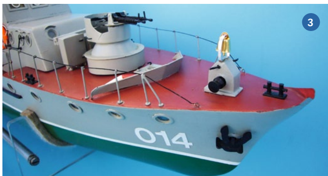
1) Fahrstand bei 1:31-TÜMMLER mit Signalnocken – sie waren etwas Besonderes beim Reedeschutzboot. 2) Pfahlmast der TÜMMLER mit Seilen und Abspannung TÜMMLER 1:25. Hier ist sogar eine funktionsfähige Beleuchtung realisiert. 3) Vordeck der 1:31-TÜMMLER mit Wellenbrecher. 4) Blick auf Ruder und Propeller der 1:31-TÜMMLER. Die Wellen lassen sich nach Demontage der Propeller ohne Ruderausbau herausziehen
