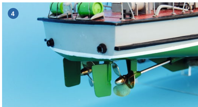
1) Fahrstand bei 1:31-TÜMMLER mit Signalnocken – sie waren etwas Besonderes beim Reedeschutzboot. 2) Pfahlmast der TÜMMLER mit Seilen und Abspannung TÜMMLER 1:25. Hier ist sogar eine funktionsfähige Beleuchtung realisiert. 3) Vordeck der 1:31-TÜMMLER mit Wellenbrecher. 4) Blick auf Ruder und Propeller der 1:31-TÜMMLER. Die Wellen lassen sich nach Demontage der Propeller ohne Ruderausbau herausziehen
