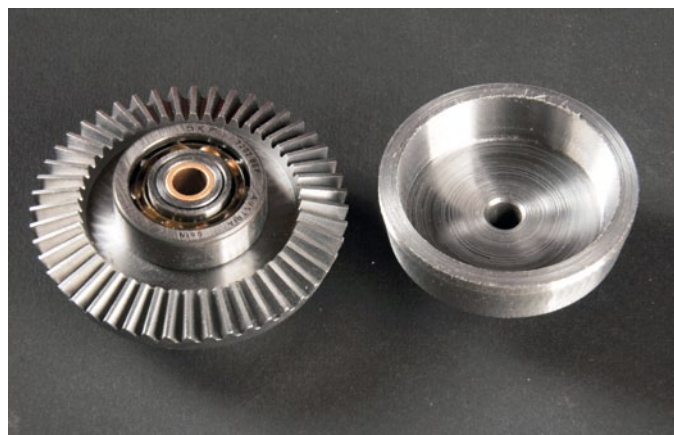
Eines der beiden großen Kegelräder mit Kupplungsglocke – sie bilden das „Grundelement“ des Wendegetriebes
