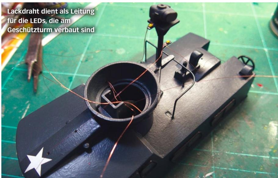
Lackdraht dient als Leitung für die LEDs, die am Geschützturm verbaut sind
