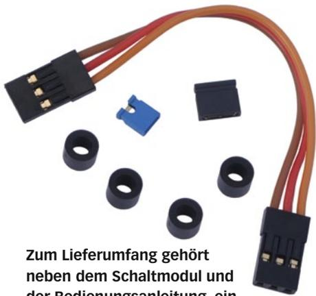
Zum Lieferumfang gehört neben dem Schaltmodul und der Bedienungsanleitung, ein Patchkabel, zwei Kodierbrücken und vier Distanzhülsen
