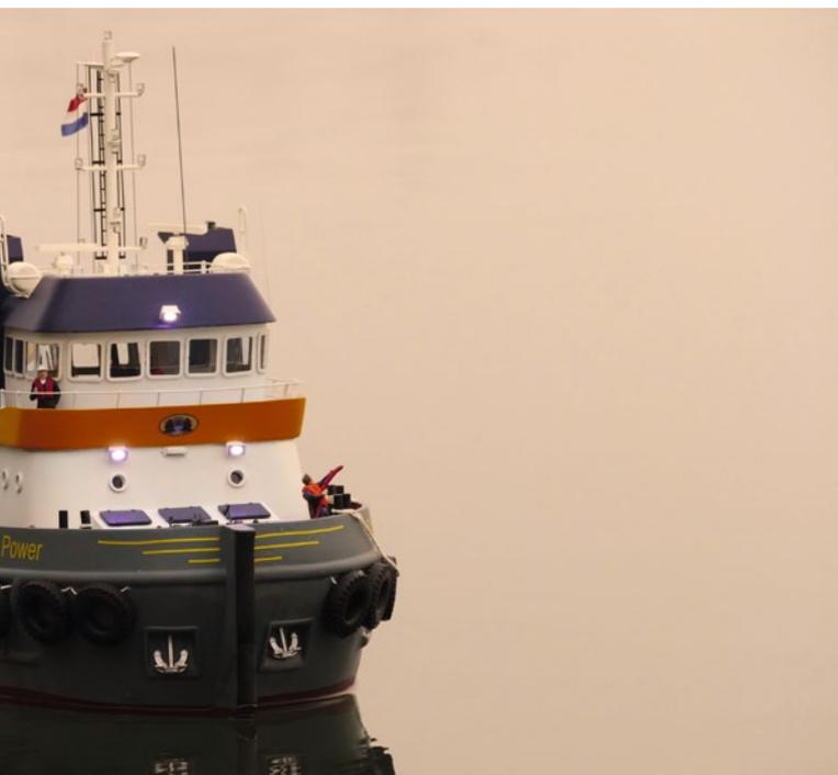
Er ist nur mit dem Ruderhausdach verklebt und die elektrischen Verbindungen sind über ein Stecksystem realisiert. Das gleiche gilt auch für die dort befestigten Positionslampen und Strahler. Alle Widerstände der einzelnen LEDs befinden sich ebenfalls unter dem Dach, sodass nur wenige Leitungen nach unten gezogen werden müssen.
