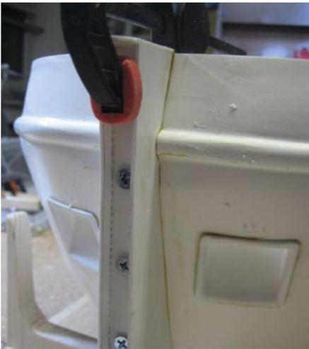
**Charakteristisch für die DUTCH POWER ist der im Bug des Rumpfs integrierte Schubbock**
