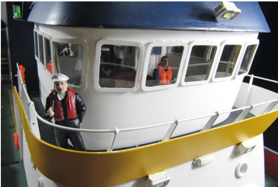
Der Aufbau setzt sich aus einem bunten Materialmix in Form eines GFK-Grundkörpers, Tiefziehtteilen und Plattenmaterialien zusammen
