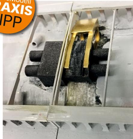
einander in die Bootsmittle zu legen. In diesem Fall so dicht, dass die Schrauben sich überschneiden, weshalb sie ein Stück hintereinander versetzt laufen müssen. Für die 45-mm-Propeller habe ich wieder downsizing betrieben und mir als Schablone Aufkleber geplottet, um die Blätter dem Vorbild entsprechend schmaler schleifen zu können.
