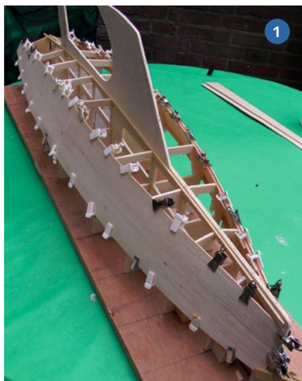
1+2) Holz eignet sich hervorragend zum Bau von Rumpfen – unabhängig von der Spantenform
