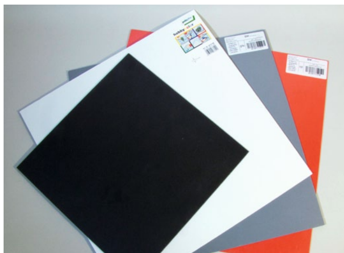
Die 3 mm starken Schaum-PVC-Platten lassen sich gut verarbeiten
