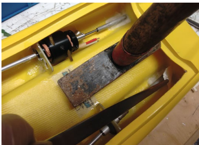
Ein mittelschwerer Hammer hält den Rumpf in Position, während die Wellen einlamiert werden
