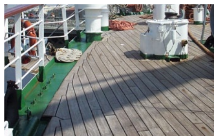
Abbildung 12: „Systemlose“ Plankenstöße beim modernen polnischen SSS DAR MŁODZIEŻY
