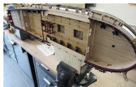
Der Rumpf ist zweiteilig geplant und wird erst ganz zum Schluss zusammengesetzt. Zuvor werden alle anderen Arbeiten an Deck erledigt
