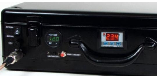
Der große Heizkoffer mit Temperaturregler und Spannungsüberwachung
