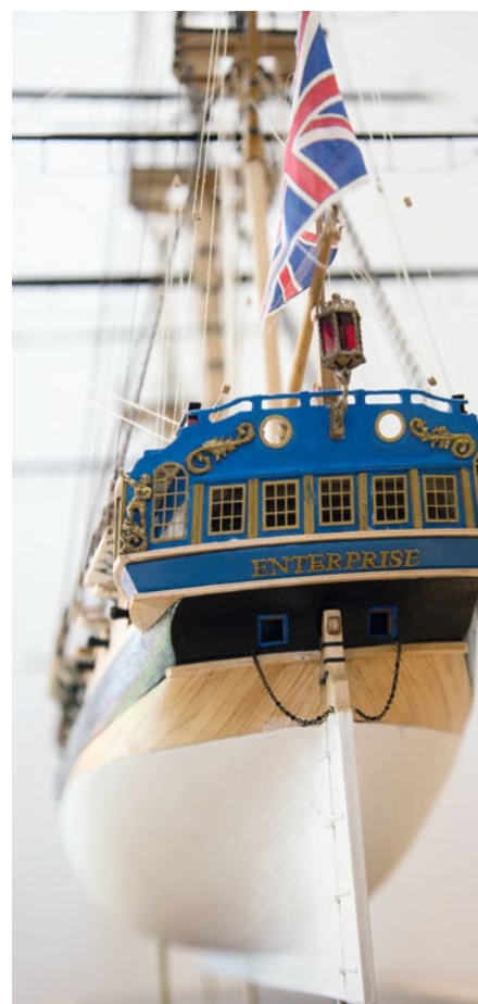
Der Rumpf ist zweiteilig geplant und wird erst ganz zum Schluss zusammengesetzt. Zuvor werden alle anderen Arbeiten an Deck erledigt
