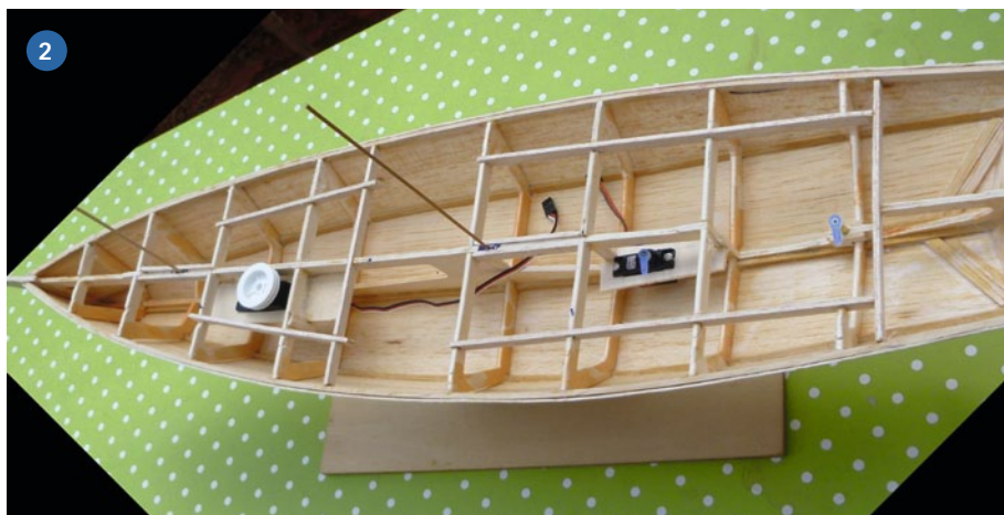
1+2) Holz eignet sich hervorragend zum Bau von Rumpfen – unabhängig von der Spantenform
