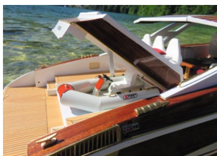
Die Tendergarage beherbergt das Schlauchboot
