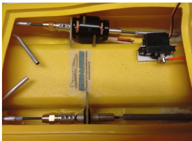
Reibung erzeugt Wärme und um die abzuleiten, ist die Bogenflexwelle Teil des Kühlkreislaufs
