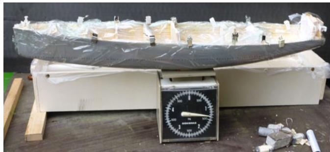
Ist die Verdrängung bekannt, lässt sich das maximale Gewicht auf der Waage ablesen
