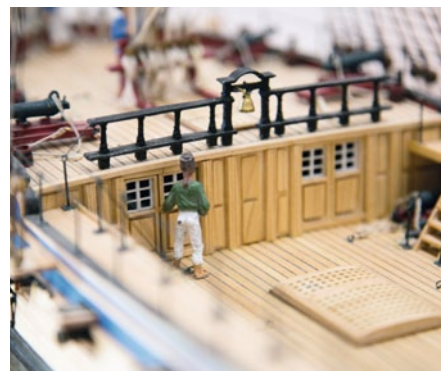
Der Zugang unter Deck wurde ebenfalls zum Teil mithilfe des 3D-Druckers angefertigt: Beispielsweise die Fensterrahmen
