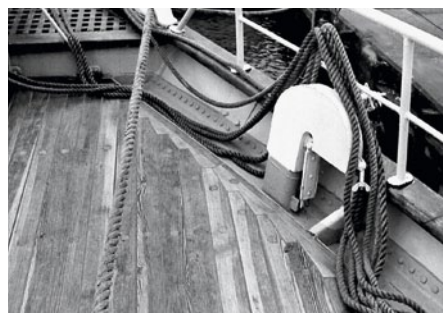
Abbildung 9: Backdeck der SSS WILHELM PIECK, Fischung nach Abbildung 4 C
