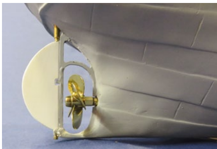
Das Ruderblatt wird mit einer 20 Millimeter langen Gewindeschraube gesichert. In Gold glänzt die Schiffsschraube der WILHELM THAM
