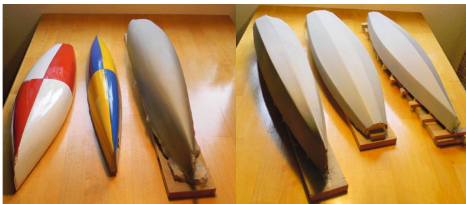
Rundspanter sind widerstandsärmer und wirken formschöner, allerdings lassen sich Knickspanter viel leichter bauen
