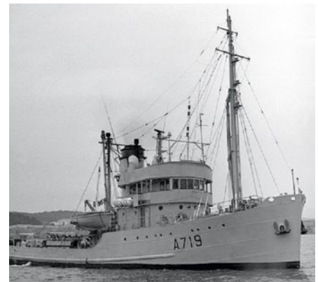
BELIER mit zusätzlichem Mast/Ladebaum hinter dem Kamin, in den Bückenocks schon Rettungsflöße, Reling-Verkleidung am obersten Deck
