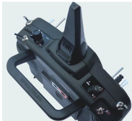
Neuere Spektrum-Sender sind mit Antennen-Diversity ausgestattet, im Griff befindet sich die zweite Antenne
