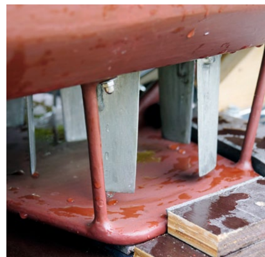
Der Durchmesser eines VSP beträgt respektable 180 mm und die Blatthöhe stolze 90 mm – so etwa kann man nicht als Fertigprodukt kaufen
