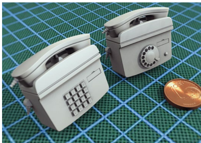
In SchiffsModell 12/2019 stellten wir die Konstruktion eines Brückenhaus-Telefons dar. Oben einmal die Ausgangsdatei und darunter das fertige Teil aus dem Resin-Drucker
