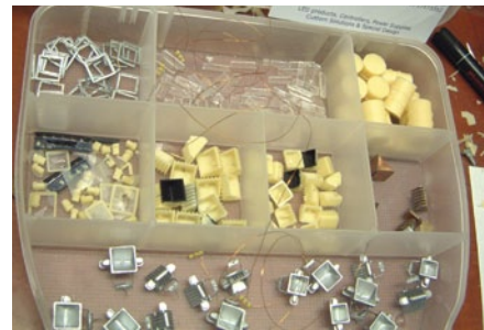
In Massen gefertigte Einzelteile für die Decks- und Arbeitsstrahler. Hierbei halfen Resin-Abgüsse aus Formen
