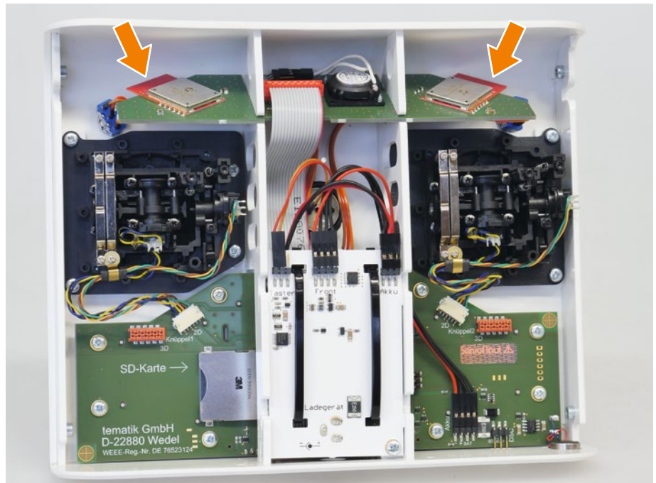
Bei der HS16 von Servonaut hat man die beiden Patchantennen in sehr vorteilhaften Winkeln zueinander und zudem schräg im Gehäuse platziert
