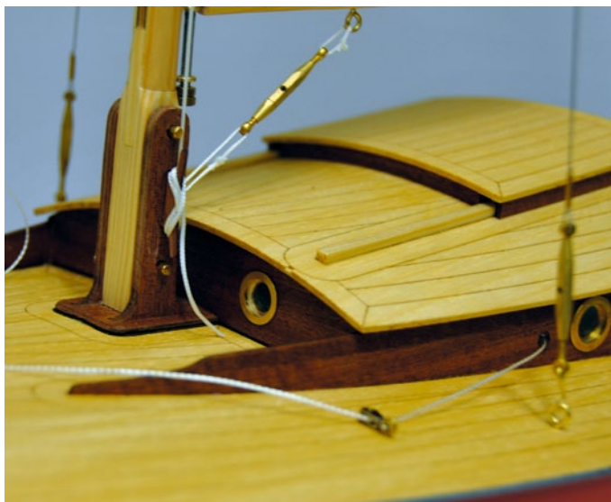
Entkoppelte Vorsegelsteuerung mit einem Segelverstell-Servo im Modell, wobei hier die Vorsegelschot direkt durch die Kajütwand geführt ist
