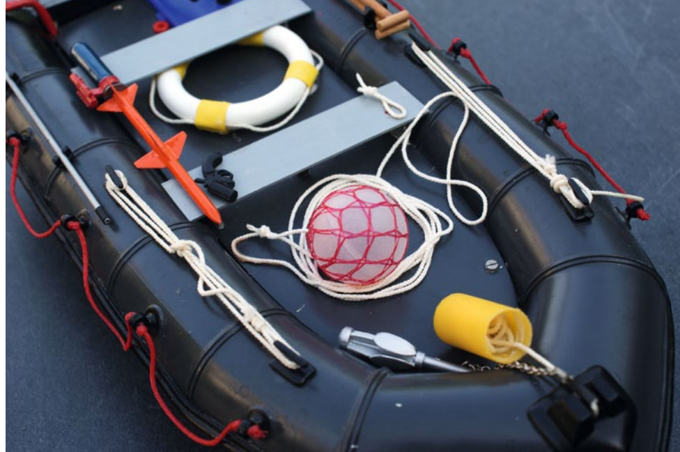
Neben einer aufgerüsteten Außenborder-Attrappe kamen noch ein Leinenschussgerät, ein Klappanker mit Ankerboje, Paddel sowie Leinen auf das umgerüstete Schlauchboot
