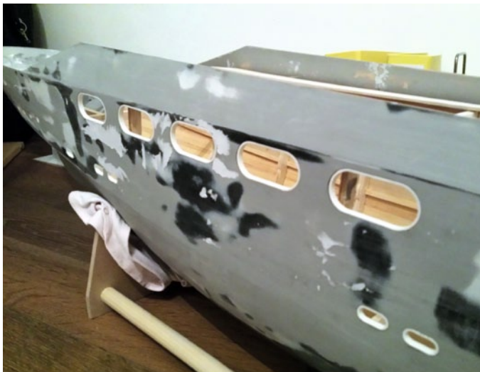
Rumpfföffnungen im mittleren Schiffsbereich
