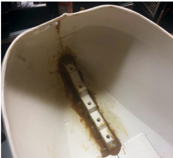
Im Rumpf ist der Sockel zur Finnen-Befestigung mit Stabilit Express eingeklebt
