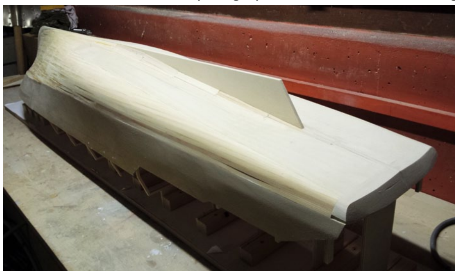
Jetzt ist der Rumpf fertig beplankt und bereit für den GFK-Überzug
