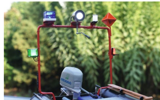
Am Heck des Schlauchboots wurde ein Bügel installiert, wie er typischerweise bei zahlreichen solcher Boote zum Einsatz kommt. Neben der nautischen Beleuchtung ist er mit einem Suchscheinwerfer und Blaulicht ausgestattet
