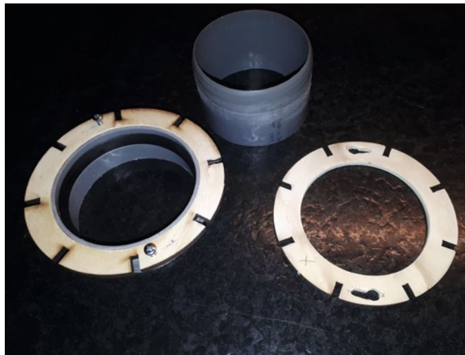
Alle für den Aufbau des Fasses benötigten Teile waren als Lasercut beigelegt
