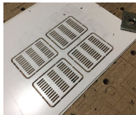
Mal nicht in 3D gedruckt, aber am PC entworfen, die Polystyrol-Teile für die Seekästenabdeckung
