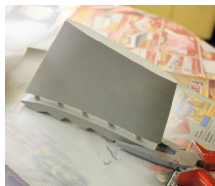
Die Finne entstand zunächst als zweiteiliges Teil am PC und wurde dann bei Shapeways in Nylon 3D-gedruckt
