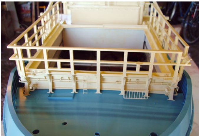
Mit Hilfe von Plastik-Profilen, die alle Klebe-verschweißt wurden, konnte auch die typische Blechkanten-Optik imitiert werden
