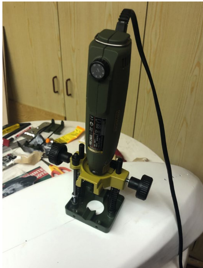
Der Oberfräsen-Aufsatz mit Tiefenanschlag für das Proxxon-Handwerkzeug ermöglichte saubere Löcher und Ausfräsungen
