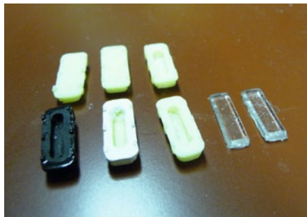
Einzelteile für die Deckenleuchten. Hierhin passen immer drei SMD-LEDs
