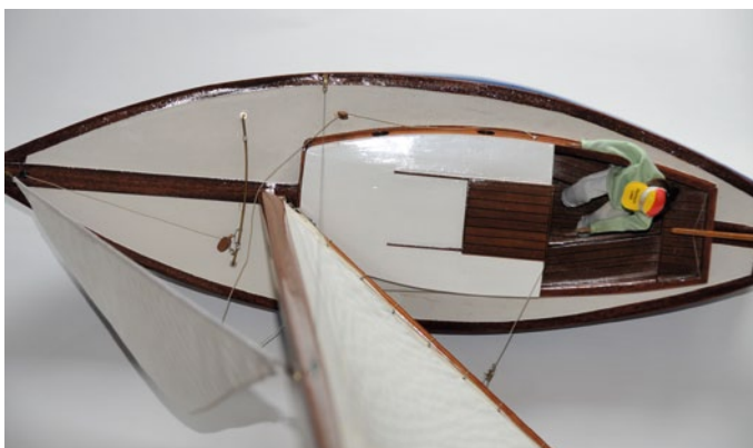
Das System der gekoppelten Vorsegelsteuerung liefert genügend Schotweg, damit das Vorsegel sauber auswehen kann und befeuert die WHOA NELLIE ordentlich
