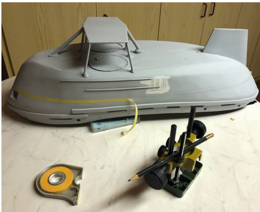
Anreißen der Wasserlinie, um eine genaue Stelle zum Abkleben des Überwasserrumpfs zu erhalten
