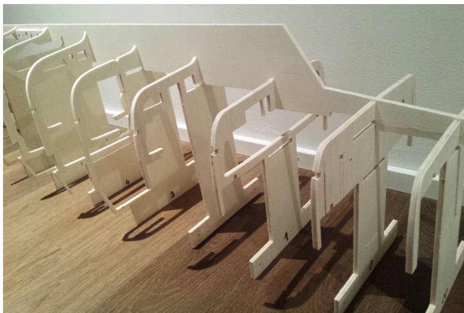
Das Spantgerüst kopfüber auf der Helling
