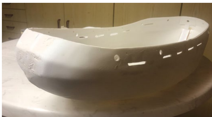
Viele Spachtelarbeiten später gab sich der Rumpf der STELLA langsam zu erkennen
