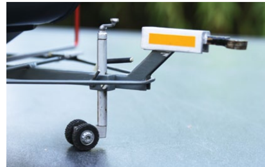
Das Deichselrad stammt aus dem Fundus von Wolfgang Brang: Ein Paar grobstollige Räder für einen Baustellenkipper sowie einige Messingrohre und fertig war das höhenverstellbare und bewegliche Deichselrad
