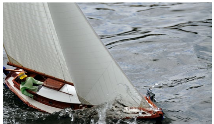
Das System der gekoppelten Vorsegelsteuerung liefert genügend Schotweg, damit das Vorsegel sauber auswehen kann und befeuert die WHOA NELLIE ordentlich
