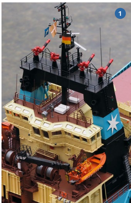
1) Oben auf der Verbindungsbrücke sind vier starke Löschmonitore platziert, die sich drehen lassen und spritzen. 2) Blick auf die Einzelteile zur Produktion der Monitore. Um die gebogenen Zwischenstücke aus Kupferrohr zu bekommen, mussten diese zuvor ausgeglüht werden. 3) Unter der Verbindungsbrücke ist die aus Zahnradstangen bestehende Schwenkmechanik der Monitore versteckt
