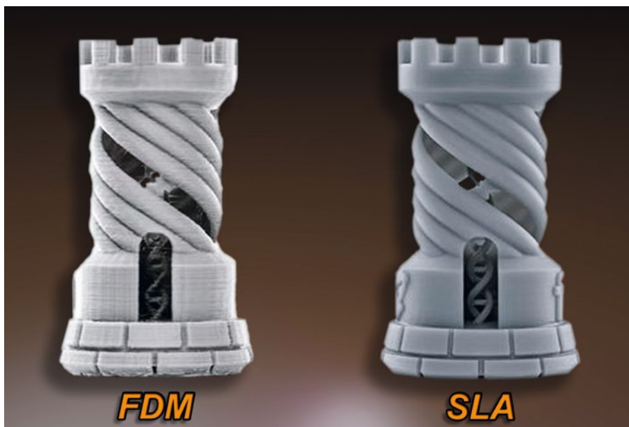
Dieses Beispiel desselben Gegenstands – links mit Filament- und rechts mit Resin-Drucker gedruckt – verdeutlicht die Oberflächen-Unterschiede
