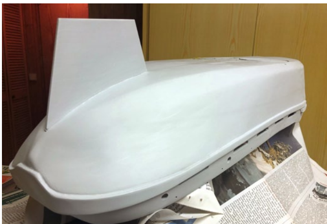
Später, nach dem Spachteln aller Übergänge, sieht auch der Bereich um die Finne sehr gut aus
