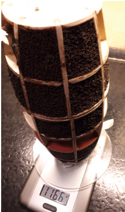
Die Spantzwischenräume wurden mit 0,6-mm-Sperrholzbrettchen verschlossen und eine „Spachtelmasse“ aus Schrot vermisch mit Holzleim in das Spantengerüst gespachtelt
