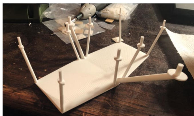
Am PC wurde die Schutzplatte für die VSP-Antriebe entworfen und gleich mit den Befestigungsgestängen geplant
