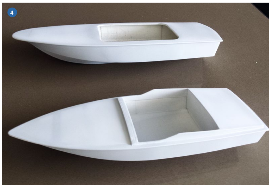
1) Süllwülste sind am Rumpf platziert. 2) Der vordere Aufbau ist fast fertig. 3) Die seitlichen Rumpftreppen können nun eingepasst werden. 4) Die Tenderboote als 3D-Druckerzeugnisse: eine CIGARETTE und eine DONZI
