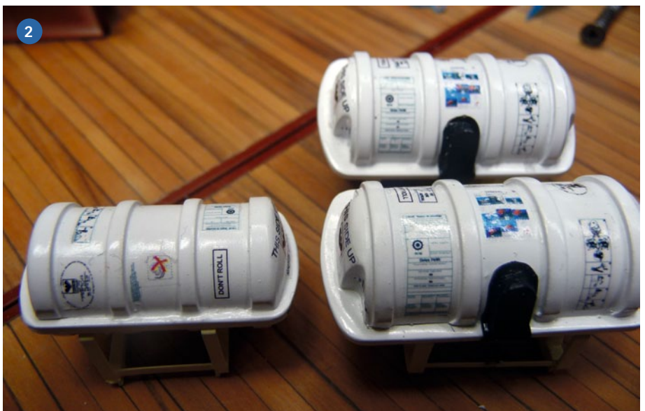
1) Auf dem Schiff sind mehrere Container abgestellt. Sie entstanden aus Resin-Abgüssen in Silikonformen. 2) Kleinigkeiten wie die Schriften und Hinweise hier auf der Rettungsinsel sorgen für absolute Authentizität. 3) Ebenfalls ein Massenprodukt sind die unzähligen, aus PU-Gummi gegossenen Fender-Elemente
