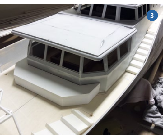
1) Süllwülste sind am Rumpf platziert. 2) Der vordere Aufbau ist fast fertig. 3) Die seitlichen Rumpftreppen können nun eingepasst werden. 4) Die Tenderboote als 3D-Druckerzeugnisse: eine CIGARETTE und eine DONZI
