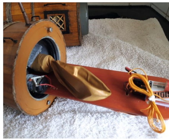
Die verbaute Elektronik – zwei Fahrregler für Pumpe und Motor und die NiMH-Batterie
