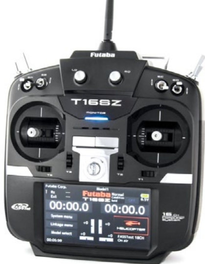
Die neue Futaba T16SZ ist ein typischer Sender mit Stabantenne, die sich abwinkel lässt
