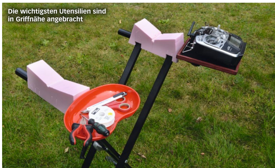
Das Styrodur wurde mit dem heißen Draht in Form gebracht, damit alles perfekt sitzt
