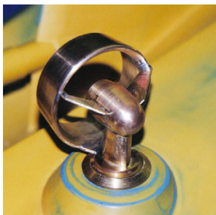
Zur Probe montierter Azimuth-Antrieb. Ähnlichkeiten zum bekannten Schottel-Antrieb sind nicht zu leugnen
