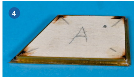
Gelöteter Rahmen, Innenseite mit Innenholzteil
