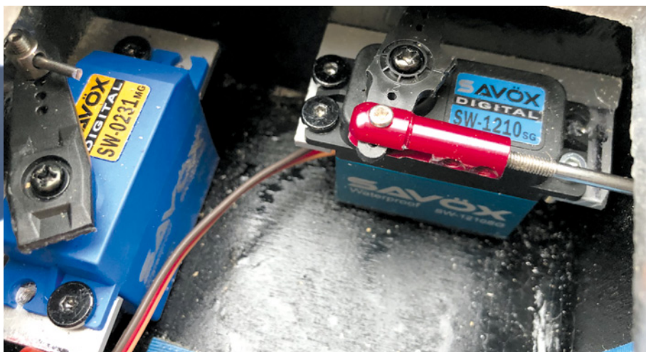
Die beiden Test-Servos befinden sich in einer RC-Box für ein Verbrenner-Rennboot. Das SW-0231 übernimmt die Gassenlenkung und das stärkere SW-1210 die Ruderansteuerung
