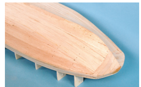
Fertig verschliffener Bugklotz aus 10-mm-Balsaplatten
