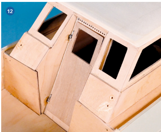
Angepasste und eingesetzte Tür am rohbaufertigen Modell
