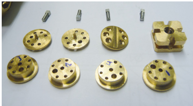
Die kreisrunden Mitnehmer sind zweiteilig. Das eckige Teil rechts sitzt später auf der Verstellwelle und kann in der Nabe vor und zurück bewegt werden. Die oben links zu sehenden Stifte/Dorne greifen sowohl in das eckige Teil als auch den Mitnehmer und führen dadurch den Verstellvorgang aus
