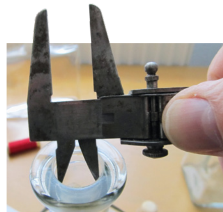
Zum Bestimmen des Flaschenhalsdurchmessers hat sich eine Schieblehre bewährt
