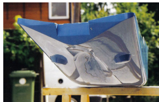
Anhand des einen Wellentunnels lässt sich bereits erkennen, dass die MAERSK MASTER nur einen Hauptantrieb hat
