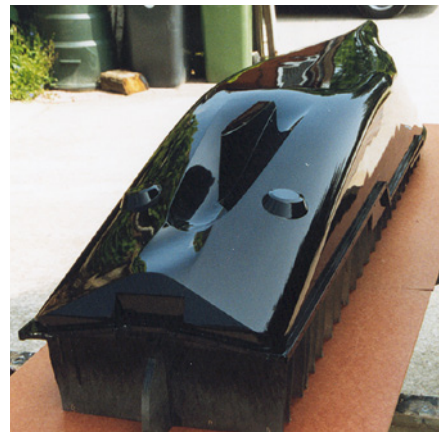
Nachdem die letzten Spachtel- und Schleifarbeiten am Polyester abgeschlossen waren, wurde der Urrumpf schwarz-glänzend lackiert, um allerletzte Unebenheiten zu erkennen und zu beseitigen – erst danach erfolgte der Negativ-Abzug
