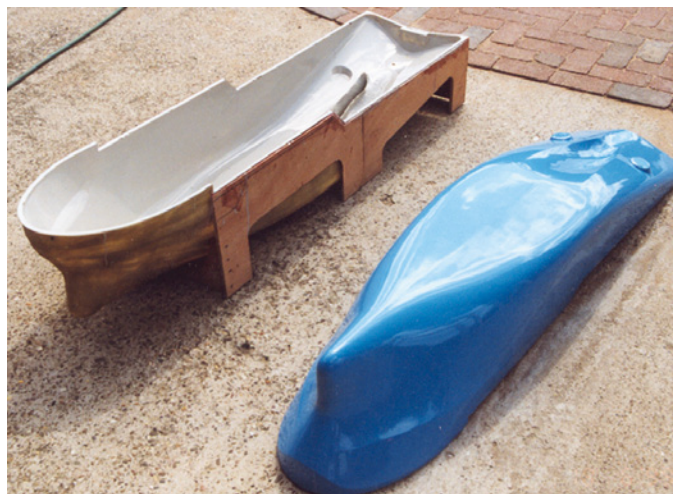
Die Negativform ist sehr stabil ausgeführt und versteift, im Verzug zu vermeiden, sowie mit fünf Löchern versehen, die das Herauslösen der Positivformen erleichterten. Die blaue Farbe ist direkt im Gelcoat eingebracht
