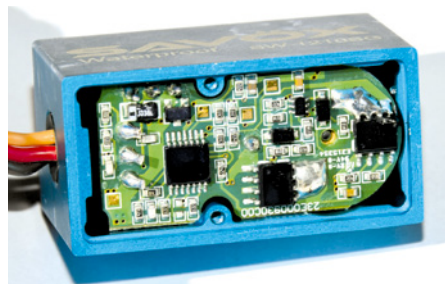
Die RC-Elektronik ist nicht gesondert geschützt – Savox vertraut ganz auf die Wasserdichtigkeit des Gehäuses
