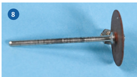
Trennscheibe zur Rahmenherstellung
