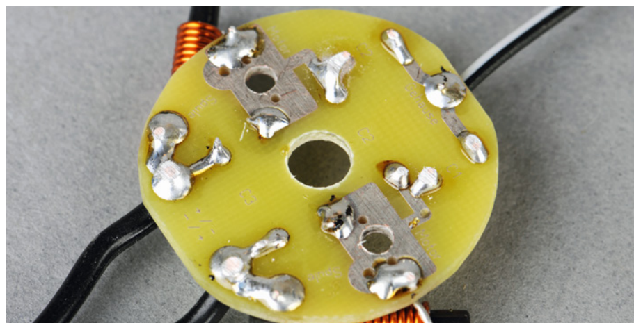
Blick auf die Rückseite, wo sich die Lötstellen befinden. Dadurch ist auch beim Anbringen am Motor eine Distanzscheibe zur Isolation erforderlich
