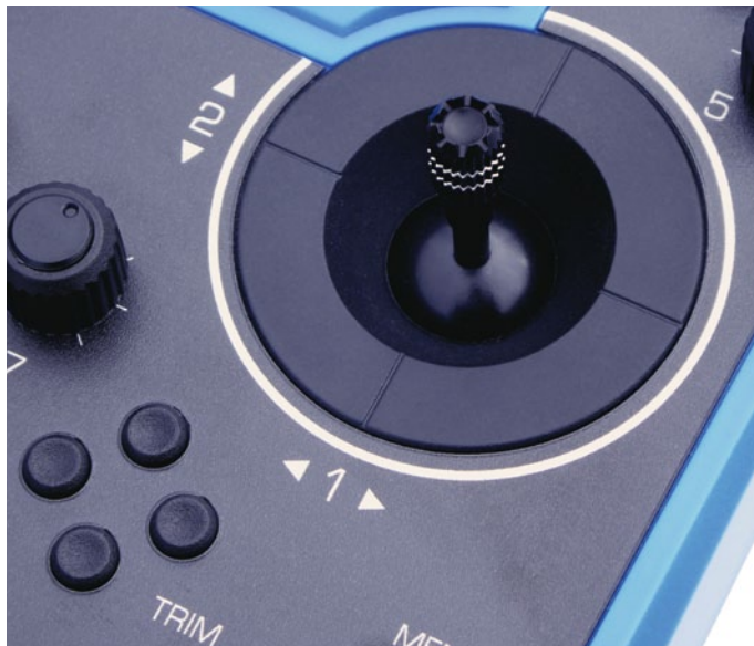
Die präzisen Steuerknüppel bestehen aus Kunststoff, die Trimmung wird durch vier Tasten realisiert
