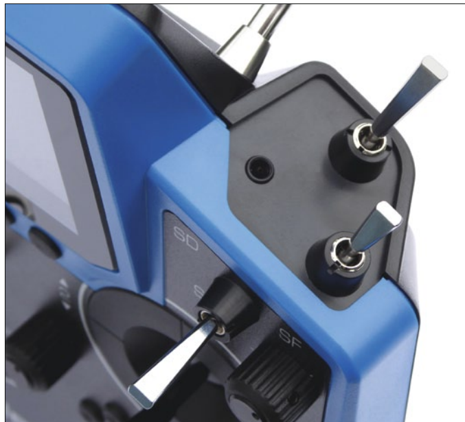
Rechts sind zwei normale, ein Tastschalter, ein weiterer Geber sowie der PPM-Anschluss platziert
