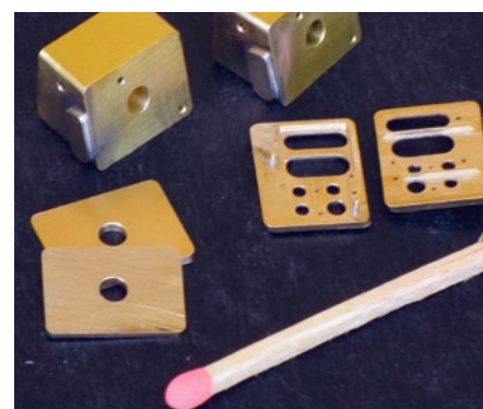
Abbildung 29) Teile für ein US-Torpedozielgerät im Maßstab 1:50
