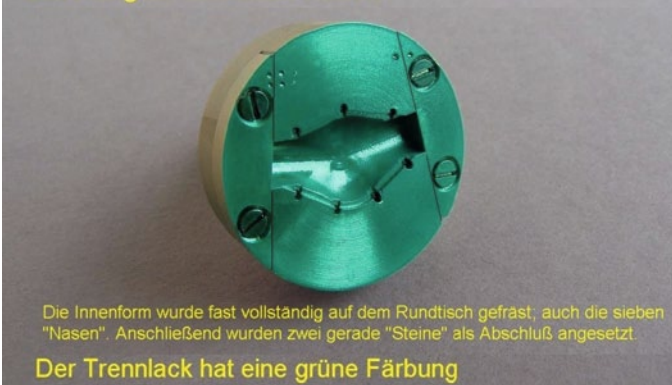
Abbildung 33) Die Form wird mit Harz mit einem kleinen „Buckel“ überfüllt und dieser per Plandreihen abgedreht. Dann werden die Steine weggenommen und man kann das Teil heraushebeln
