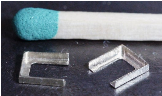
Abbildung 21) Vor dem Lackieren rundum sauber entgraten
