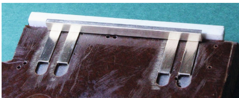
Abbildung 30) Die lange U-Schiene wird beim Löt an die weiße PVC-Kante angelegt. Danach wird das Ganze umgekehrt und die zweite U-Schiene angelötet
