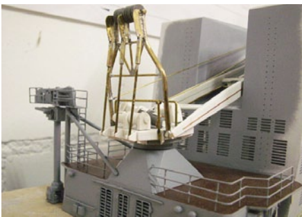
Der Kran zwischen den Kaminen entstand in klassischer Ausführung aus Messing und Polystyrol
