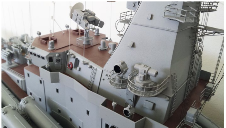
Eine Fülle an Ausrüstungsgegenständen war als Massenprodukt zu fertigen – dabei halfen Resin-Abgüsse. Viel Lötarbeit steckt in den zahlreichen Relingen
