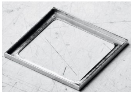
Abbildung 9) Rahmenhöhe 1,2 mm; Teil noch unverputzt
