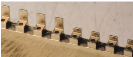
Abbildung 12) Fräsgrat mit rotierender Drahtbürste entfernt; 0,4-mm-Bohrungen
