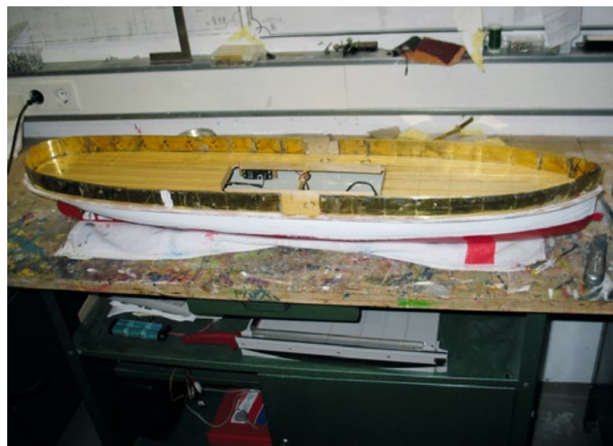
Der weitgehend fertige Rumpf mit Deck und bereits angesetztem Schanzkleid
