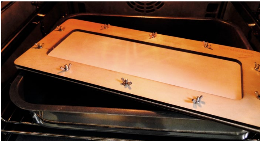
Das Erhitzen im Backofen bringt bessere Ergebnisse als der Heißluftfön
