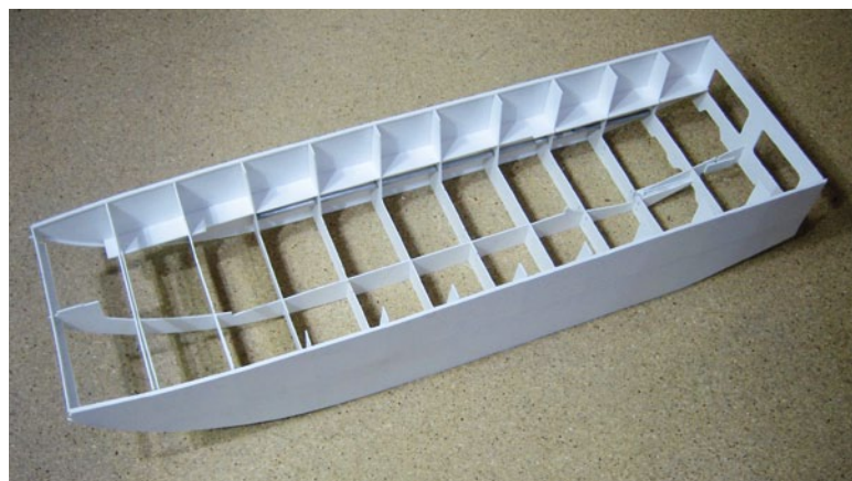
In relativ kurzer Zeit entsteht das Grundgerüst des Rumpfs
