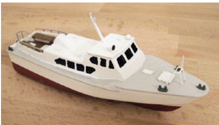
Fertiges Beiboot. Der Grundkörper wurde von einem selbst angefertigten Urmodell abgeformt
