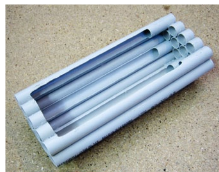
Das ausgehöhlt Röhren-Konglomerat kaschiert den Fahrakku
