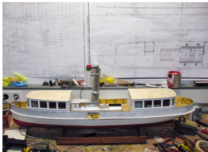
Der Rohbau nimmt immer konkretere Form an. Gut zu erkennen ist der Alu-Schornstein
