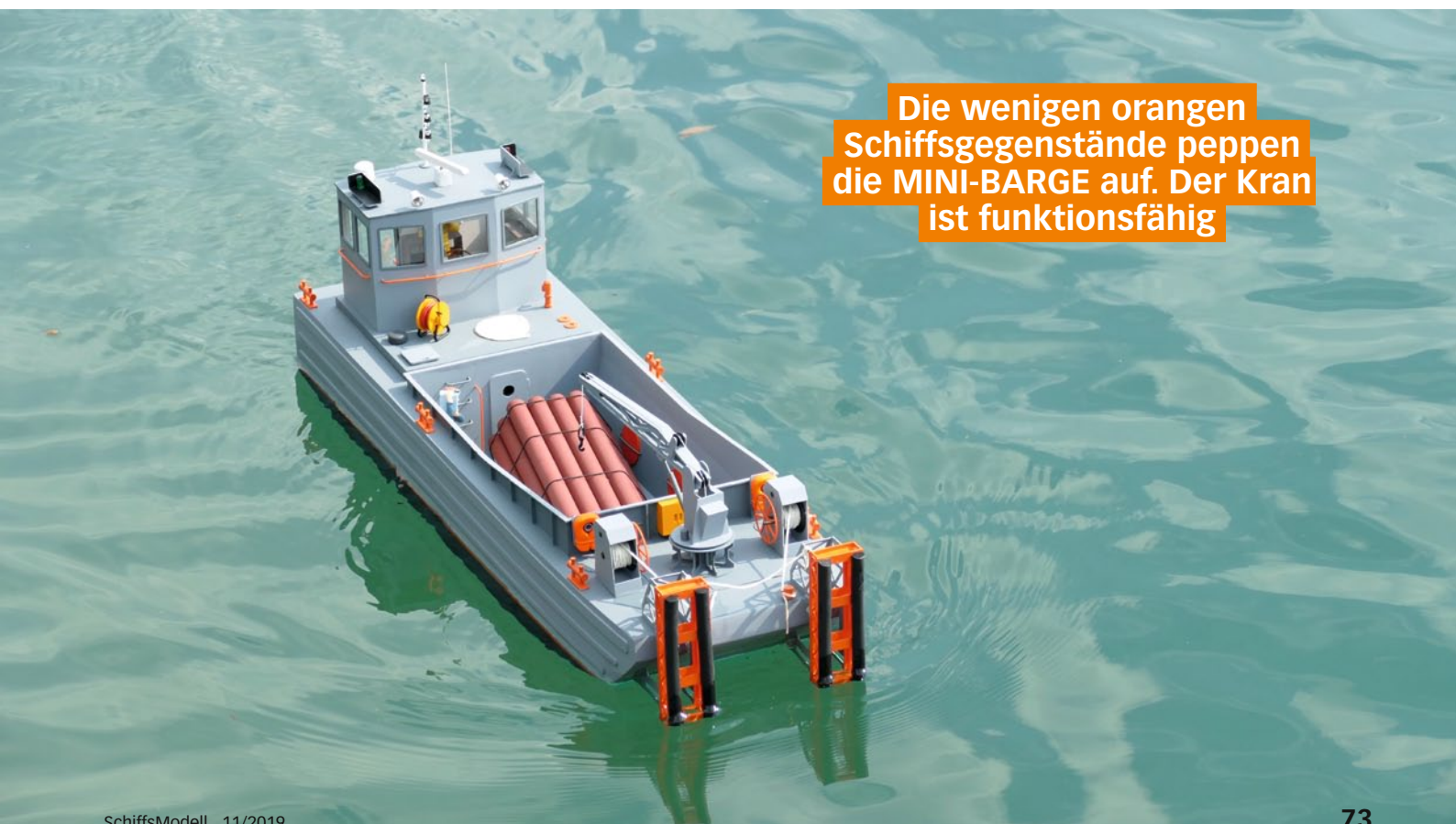
Das ausgehöhlt Röhren-Konglomerat kaschiert den Fahrakku
