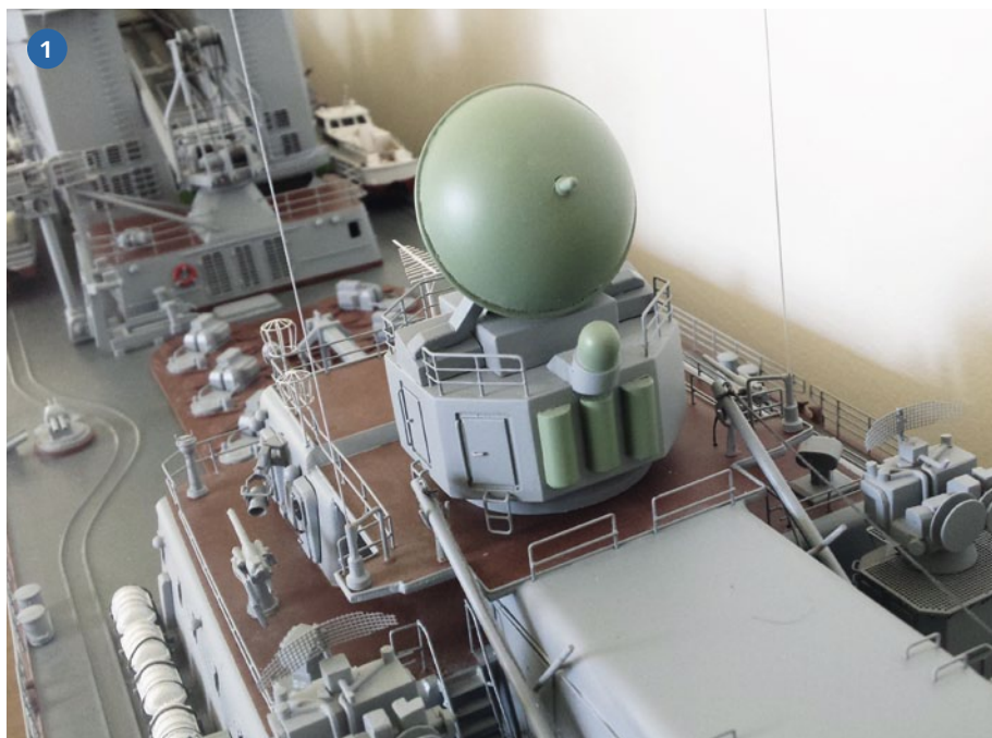
1) Fertiges Feuerleitradar auf dem Hangaraufbau. 2) Kite Screech-Radar: Der Grundkörper besteht aus Buchenholz, den Pfosten drehte ich aus PVC, die restlichen Kleinteile sind aus Messing und Polystyrol erstellt. 3) Der Feuerleitradar für die SA-N-3 bekommt seine Farbe. Einzelne Farben mischte ich aus mehreren passend zusammen
