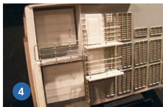
1) Der Grundkörper des Brückenaufbaus entsteht. Hier ist die Grundstruktur in Sperrholz zu sehen. 2) Der Kontrollturm für das Hubschrauberdeck entstand aus einem gefrästen PU-Klotz. 3) Die Lamellengitter sind aus dem Polystyrol-Teil des Aufbaus gefräst. 4) Der Schornstein-Körper mit all seinen Lüftungsgittern und Plattformen. 5) Blick auf den Schornstein und dem mittleren Aufbau
