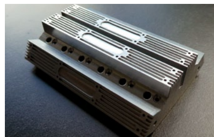
Optisches Highlight der RIVA AQUARAMA Lamborghini ist der Motor. Der Zylinderkopf entstand aus einem selbst gefrsteten Alu-Block
