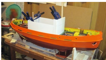
Aus Polystyrol entstanden die Aufbauten
