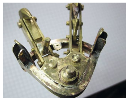
Um die Schleppvorrichtung funktionsfähig zu gestalten, kam Messing zum Einsatz
