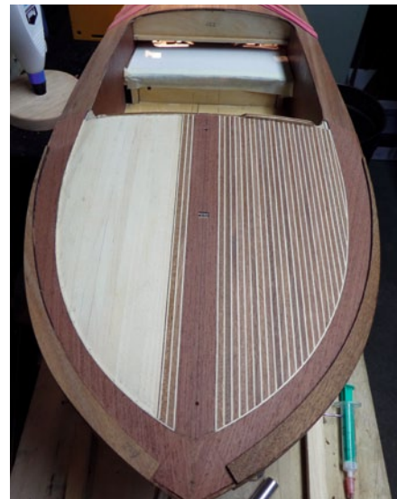
Charakteristisch für die Riva ist der Plankenaufbau auf dem Vorschiff – sie gleicht einer Intarsienarbeit
