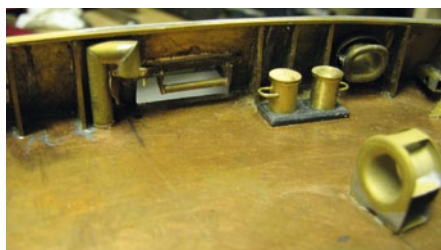
Der Festigkeit halber entstanden zahlreiche Bauteile aus Messing
