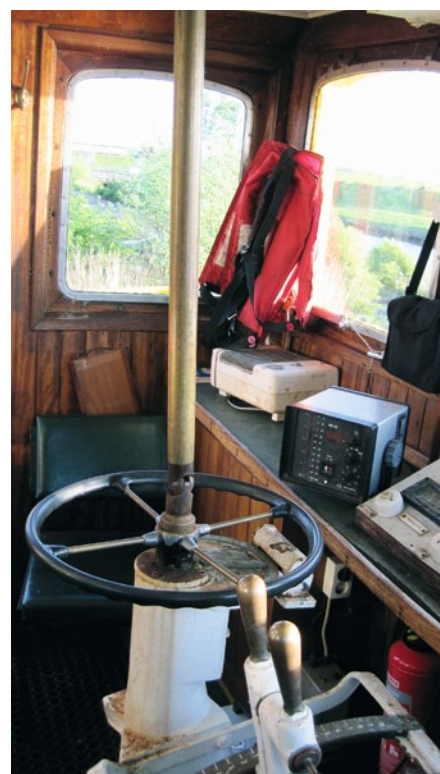
Das Steuer auf der Brücke und auf dem oberen Steuerstand sind beim Original über eine Welle verbunden – so auch im Modell
