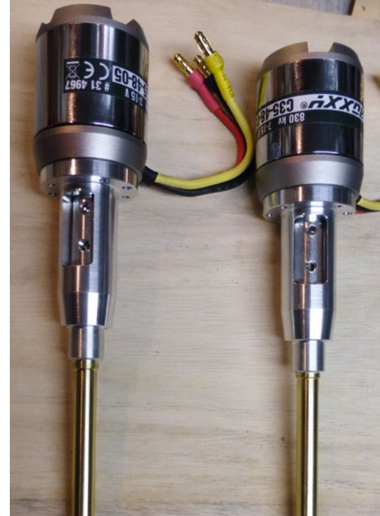
Als Antrieb dienen zwei mit 830 kv relativ langsam drehende Brushlessmotoren von roxxy – Welle und Motorhalterung sind fest verbunden
