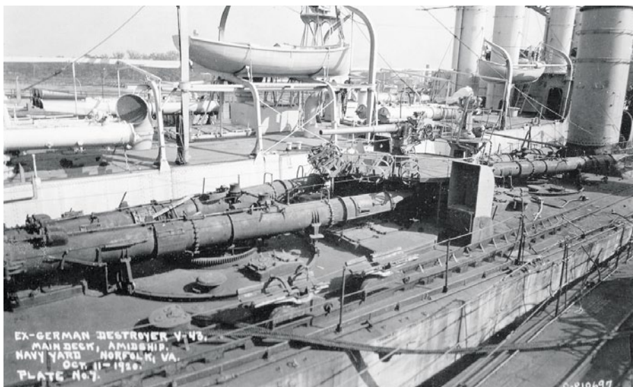
Klare Aufnahme von V 43, Ladeschienen mit zwei Torpedowagen an Steuerbord
