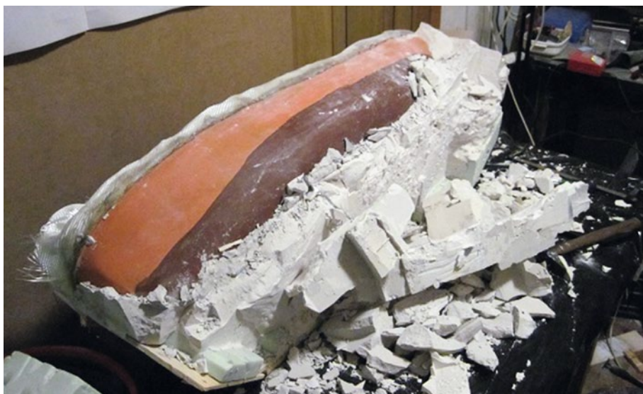
Vom fertigen Positiv-Rumpf wurde ein Gipsabdruck erstellt, um dann einen GFK-Rumpf abzuformen – leider bedingt das die Zerstörung der Form
