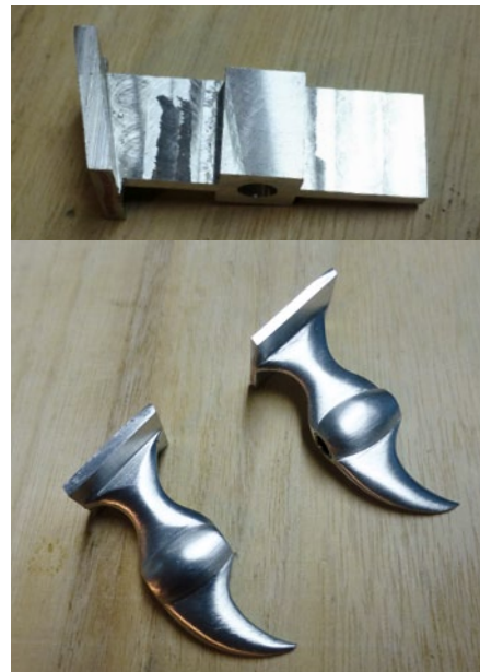
Links ein Rohbauteil für das Wellenlager und rechts die fertig geschliffenen Stützen
