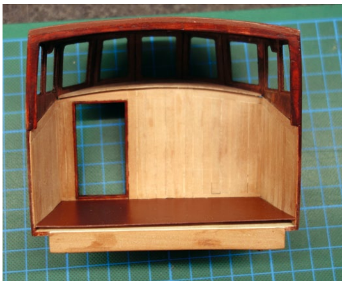
Blick auf den noch leeren Fahrstand mit der Öffnung für die Lautsprecher-Option – die ließ sich aus Gewichtsgründen leider nicht realisieren
