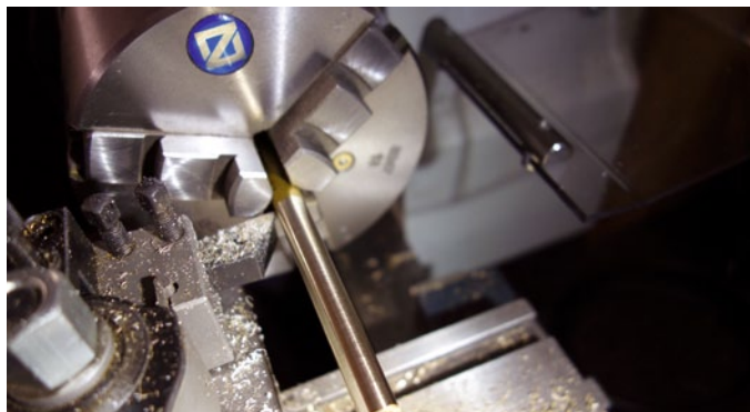
Grundmaterial für die Bullaugen ist ein Rundmessing, das abgedreht wurde
