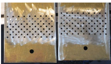
Abbildung 11) Beide 0,15-Millimeter-Bleche wurden „im Paket“ mit Pertinax-Auf- und Sperrholz-Unterlage gebohrt
