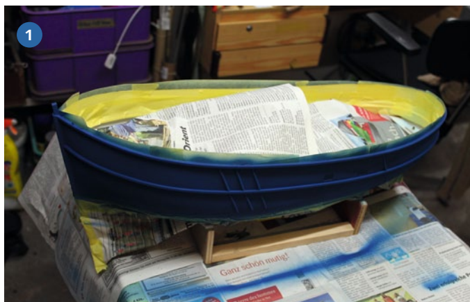
1) Im nächsten Arbeitssgang erfolgte die Lackierung des Überwasserschiffes. 2) Das Deck nach der Beplankung und Lackierung des Süllranddeckels: Man sieht die spätere Position des Hauptmastes, des Hauptschalters und des Abgasrohres
