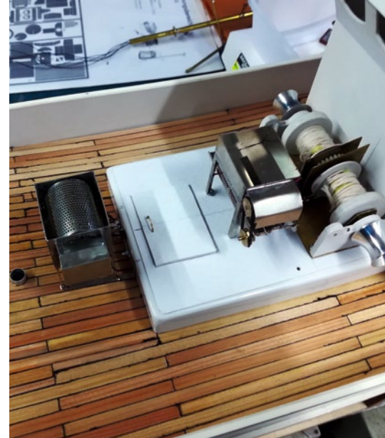
Siebtrommel, Schüttelsieb, Winde, sowie Luke des Laderaums – alles passt
