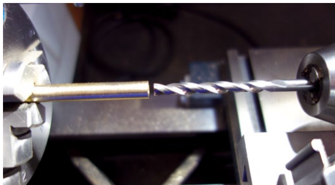
Um eine Auflage für die später einzuklebenden Bullaugenscheiben zu schaffen, ist ins Rohmaterial gebohrt worden
