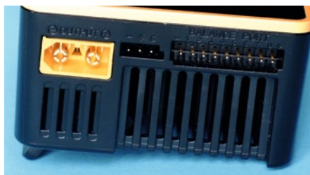
Die linke Gehäuseseite mit den Anschlüssen für Akku, Servo und Balancer
