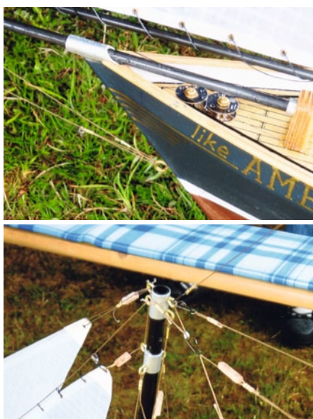
Es wurde das Schonersegel im Unterliek soweit gekürzt, damit es an einem Baum haarscharf vor dem Großmast vorbeigeführt werden kann
