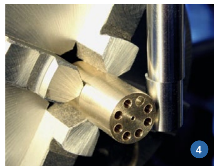
Abbildung 2) Strichabstände bei Wabeco 0,05 Millimeter. Die Striche sind schon zu breit und der Durchmesser vom Skalenring könnte viel größer sein (Eigenbau). Abbildung 4) Die Kante eines runden Teils wird im Teilkopf angefahren
