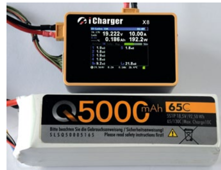
Praxistest beim X8 wurden mit einem 6s-LiPo mit 5.000 Milliamperestunden Kapazität vom Typ Quantum durchgeführt
