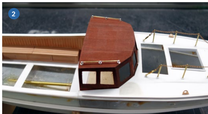
1) Die endgültige Position von Haltestange und Stützenlänge ergibt sich durchs Anpassen und Verlöten – Kreppband ist dabei eine große Hilfe. 2) Blick auf das fertige, noch unlackierte Werk
