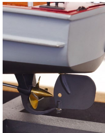
Schwenkt man das Ruderblatt um 90 Grad, kann man die Propeller-Welle durchs Loch aus dem Stevenrohr herausziehen
