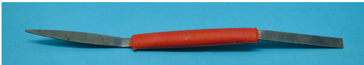
Wichtiges und ganz tolles Werkzeug, bei den professionellen Formenbauern Lanzette genannt. Gibt's in Baumärkten auch, aber unter anderen Namen
