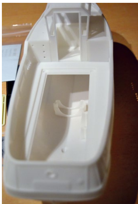
Ab Werk vorgefertigt sind auch die Motorlagerung oder die Aufnahme für das Ruderservo
