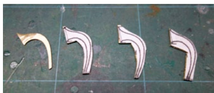
Befestigt sind die Papiervorlagen mit Uhu Alleskleber – hier zu sehen an den Ruderhacken
