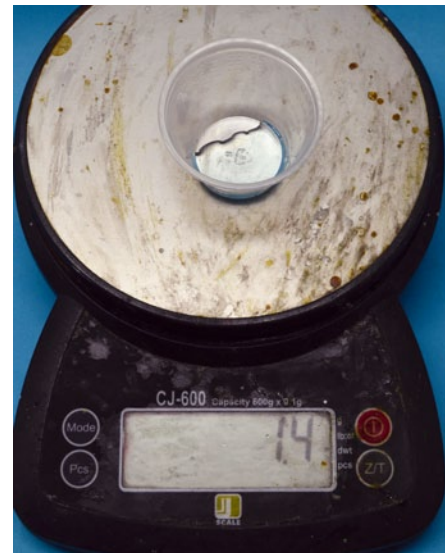
In diesem Becher sind 1,4 g abge- wogen: 1 g Harz plus 0,4 g Härter; Mischungsverhältnis also 100 zu 40 oder 10 zu 4. Und der Zustand der Waage zeugt von ihrem bedin- gungslosen Einsatz
