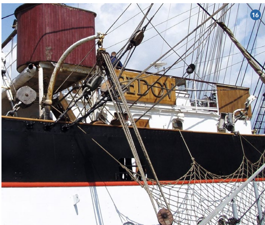
Abbildung 16) Beim russischen SSS SEDOV trägt eine schwere Talje (zwei dreischeibige Blöcke) die Gangway. Abbildung 17) Typischer Sliphaken, ein Ende ist bei (b) geschäkelt; das zu lösende Ende mit Kettenglied/Ring/Schäkel bei (a). Abbildung 18) a = Geerenhalter, b = oberes Brookauge, c = Geer (auch Mittelstander), d = ein Stander, e = holende Part der Heißtalje
