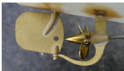
Fertig eingesetztes Ruderblatt mit der Hacke und dem daran befindlichen Lager
