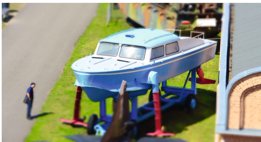
Schnellschiff WSS-12 von 1965. Das Tragflächensystem wurde vom Zivilingenieur Friedrich H. Wendel entwickelt und ist patentiert. Geeignet ist das Schiff für Fluss und Mündungsgebiete. Der Miniaturisierungseffekt passt zum Modellbauthema
