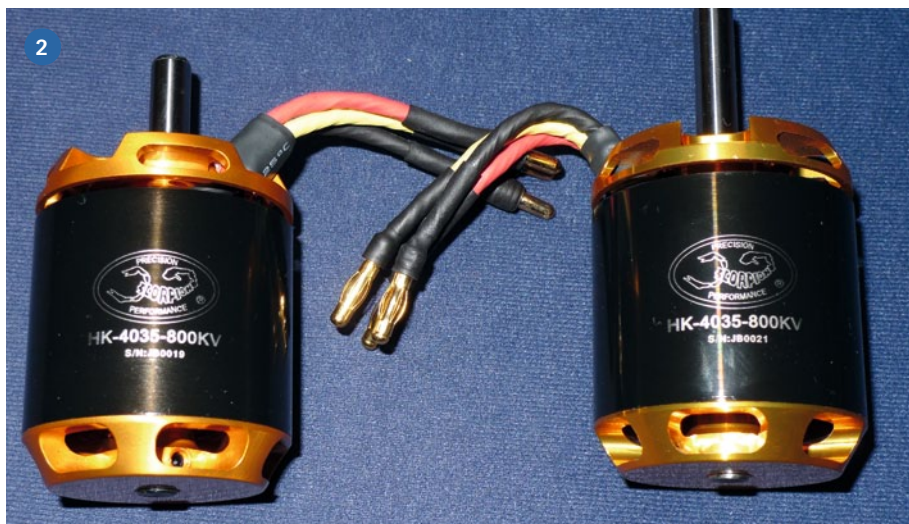
1) Die zusätzliche Kondensatorbank wird direkt in die Reglerzuleitung eingelötet. Diese ermöglicht höchste Teillastfestigkeit und optimale Leistung im Grenzbereich. 2) Das Außenläufer-Pärchen Scorpion 4035-800 sorgt für Vortrieb
