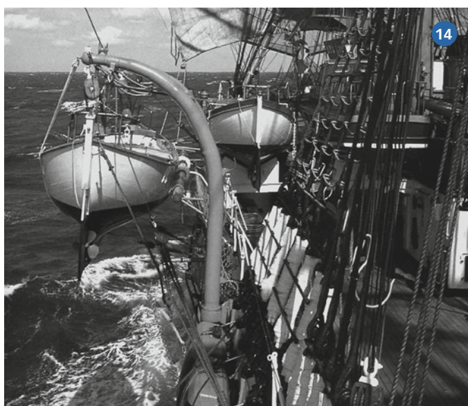
Abbildung 14) Außenbords an einem Zurrbaum gefahrenes Motorbeiboot bei AMERIGO VESPUCCI. Im Hintergrund ein Beiboot in Bootsklampen an Deck stehend. Die Zurrings sind hier Ketten. Abbildung 15) Außenbords gefahrenes Ruderbeiboot beim ex-jugoslawischen SSS JADRAN. Zwei Manntaue sind an der (durchhängenden) Geer aufgeschossen, der Zurrbaum hat nur ein Polster, auch hier die Gangway gleich in der Nähe
