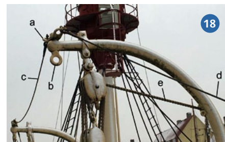
Abbildung 16) Beim russischen SSS SEDOV trägt eine schwere Talje (zwei dreischeibige Blöcke) die Gangway. Abbildung 17) Typischer Sliphaken, ein Ende ist bei (b) geschäkelt; das zu lösende Ende mit Kettenglied/Ring/Schäkel bei (a). Abbildung 18) a = Geerenhalter, b = oberes Brookauge, c = Geer (auch Mittelstander), d = ein Stander, e = holende Part der Heißtalje
