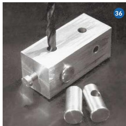
Die M4-Schraube klemmt den Pollerkopf in der Vorrichtung
