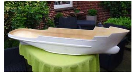
Basis des Modells bildete ein GFK-Fertigrumpf
