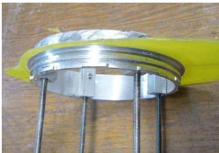
**Die Aluklötze nehmen die Gewindestangen zur Befestigung von Elektronikträgerplatten und Tank auf**
