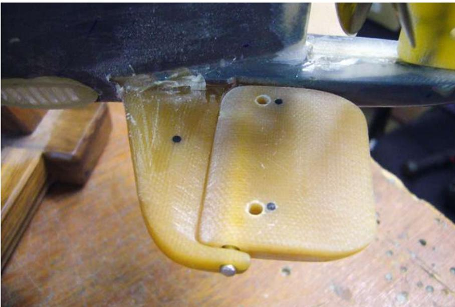
**Die Bohrungen dienen zur Arretierung des GFK-Rohlings, um ihn optimal bearbeiten zu können**
