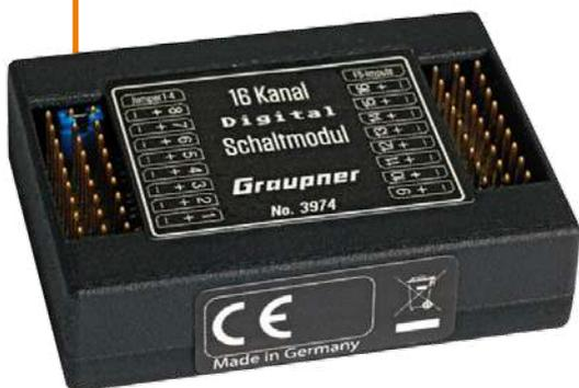
Das 16-Kanal-Digital-Schaltmodul von Graupner passt zur mz-16 HoTT und zur mz-32. Es ist SUMD 3-fähig und löst das alte Multikanal-Nautik-Modul ab. Ohne Zeitverzögerung können bis zu 16 Funktionen auf dem Touchscreen geschaltet werden. Für jeden einzelnen Kanal kann zwischen drei verschiedenen Betriebsmodi gewählt werden: Schalten (ein/aus), Blinken, Impuls (Horn oder Lichtsignal). Das Modul wird in Deutschland hergestellt und kostet 129,99 Euro. [www.graupner.de](http://www.graupner.de)
