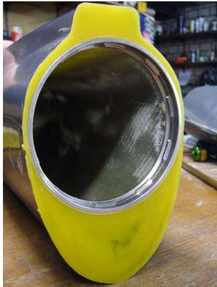
**Der Spant mit bereits integriertem Bajonettanschluss ist einbaufertig im Rumpf angepasst**
