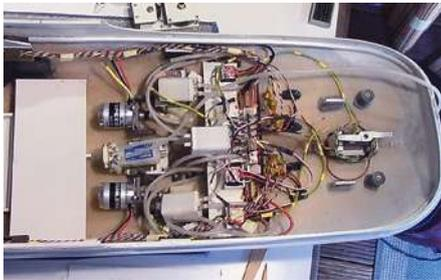
**Vier Pumpen sind im Modell eingebaut. Zwei zur Kühlung der Antriebsmotoren und zwei für die Löschmonitore**
