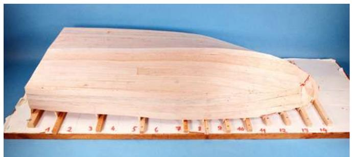
Der mit Balsaleisten beplankte Rumpf auf der Helling ist bereit zum versiegeln
