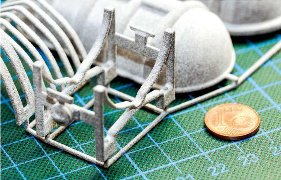
Alle zu druckenden Teile sind über kleine Verbindungsstege gedruckt, was erheblich die Produktionskosten senkt
