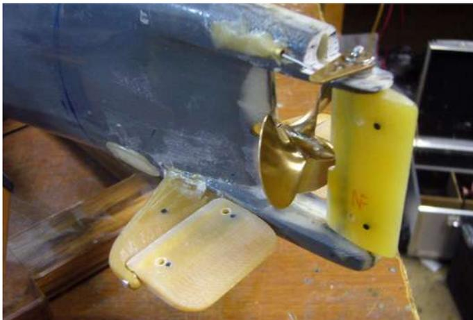
**Die Ruder sind aus dem Vollen geschliffen und entstanden aus GFK**
