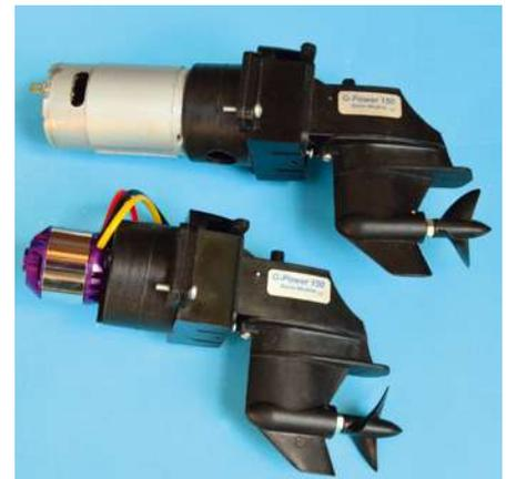
**Vergleich der Z-Antriebe Typ 150 mit 600er-Bürstenmotor und mit Außenläufer. Letzterer kam schließlich dauerhaft zum Einsatz**
