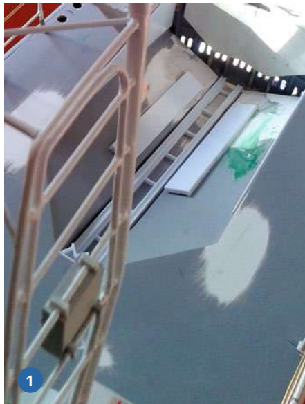
1) Heckwanne mit verschlossener Ruderöffnung. Die Heckklappe war im Auslieferungszustand etwas verzogen und musste angepasst werden. 2) Hinter der geöffneten Steuerhaustür befindet sich der Schalter für den Empfänger
