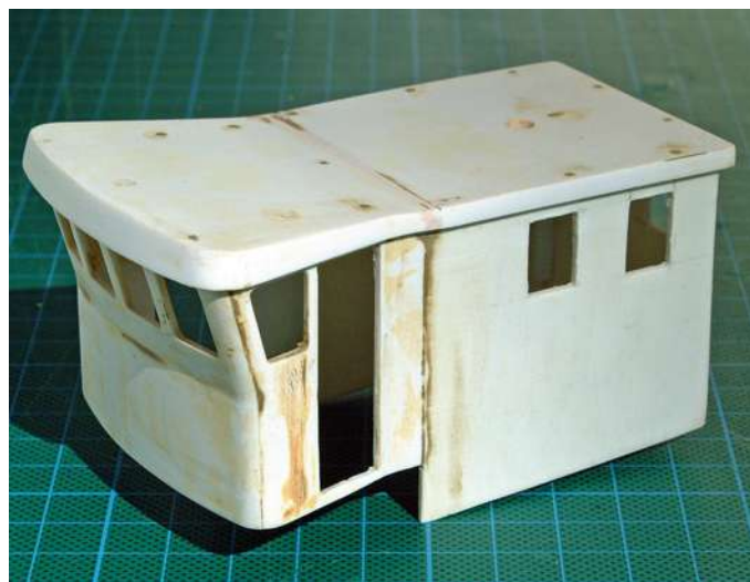
Einem Stahlkutter entsprechend erhielt das Modell ein komplett neues Deckshaus ohne Decksprung und mit eckigen Fenstern
