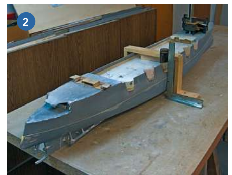
Auf das Unterteildeck ist die Lage der Oberteilspanten angezeichnet. Ein Oberteilkiel gibt den Spanten, die winklig eingeklebt werden, den ersten Halt. Danach wird mit in Epoxy getränkten Balsaleisten beplankt
