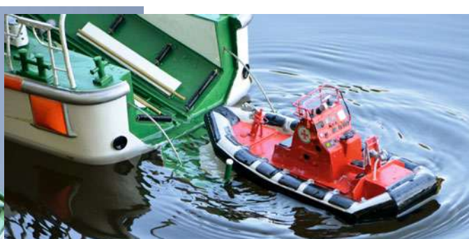
Das Herausrutschen der NOVIZE aus dem Mutterschiff funktionierte nicht auf Anhieb. Die Auslassdüse des Jets verhakte sich an der mittig angebrachten, unteren Führungsrolle. Sie wurde daraufhin entfernt und am oberen Teil der Wanne angebracht. An die seitlichen Auflagen kamen Messingstangen, auf denen das RIB reibungsvermindert aus der Wanne gleiten kann
