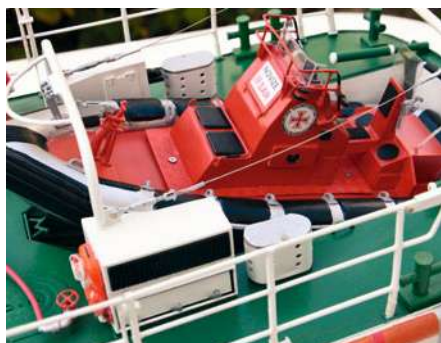
Die Heckwanne mit Festrumpf-Schlauchboot (RIB). Das RIB sollte funktionstüchtig sein, die Steuerung erfolgt mit einer separaten Kleinanlage
