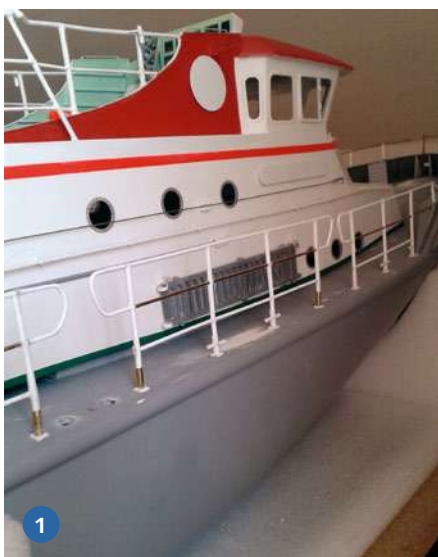
1) In Verbundbauweise ist die Reling gefertigt. 2) Auch der Mast, hier in der Rohbau-Phase, ist in Messing-/Kunststoffverbundbauweise entstanden
