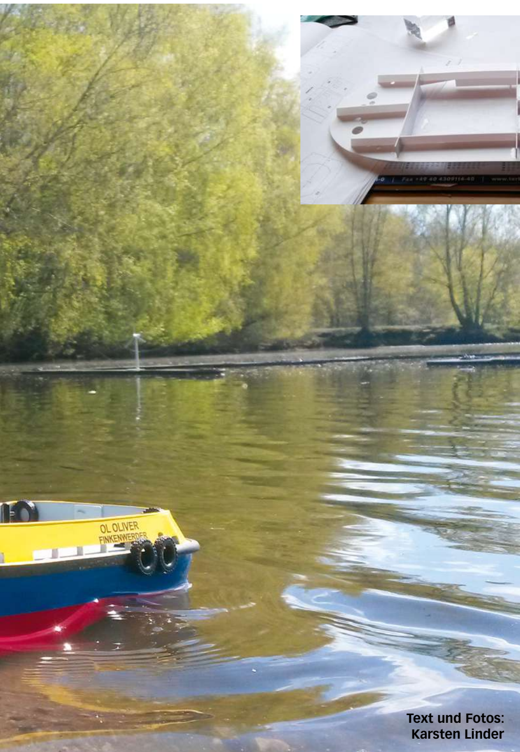
Zum Stabilisieren erhält das Arbeitsdeck eine Reihe Unterzüge, die auch die Wölbung berücksichtigen
