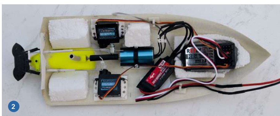
1) Das Modell verfügt über zwei verschiedene Stromkreise für Empfänger und Soundmodul. 2) In die NOVIZE sind ein Innenläufer-Brushless-Motor Turnigy 1230, Turnigy-Analogservos und ein 500-mAH-LiPo eingebaut
