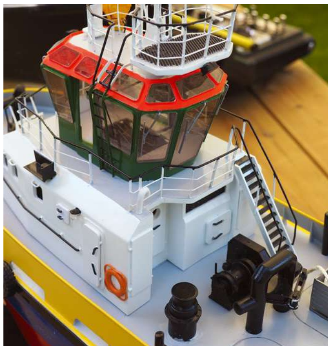
Alle schwarz lackierten Ausrüstungsgegenstände entstanden mit Hilfe eines 3D-Druckers
