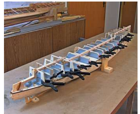
Auf das Unterteildeck ist die Lage der Oberteilspanten angezeichnet. Ein Oberteilkiel gibt den Spanten, die winklig eingeklebt werden, den ersten Halt. Danach wird mit in Epoxy getränkten Balsaleisten beplankt
