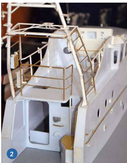
1) In Verbundbauweise ist die Reling gefertigt. 2) Auch der Mast, hier in der Rohbau-Phase, ist in Messing-/Kunststoffverbundbauweise entstanden
