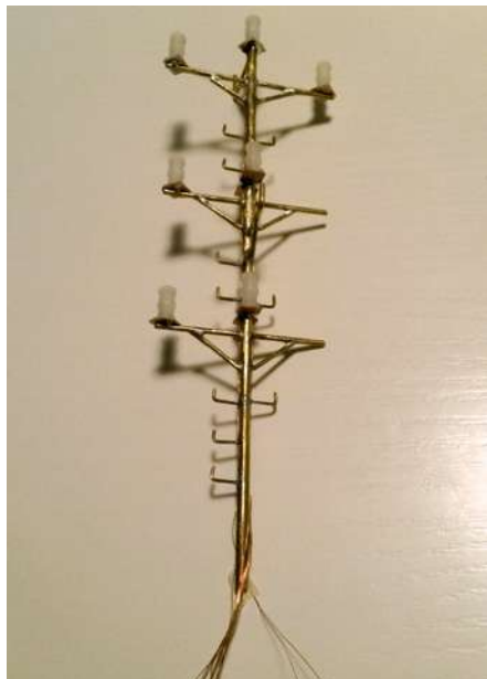
Basis des Masts ist ein Messingrohr, der als Plus-Pol dient. Bei jeder SMD-Leuchte fällt somit nur ein Kabel an
