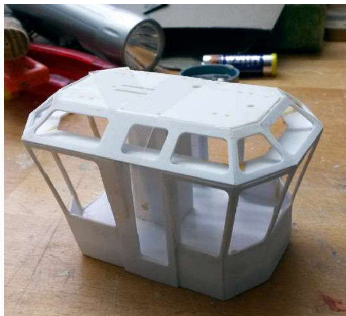
Dünne Stege, die durch Lasern möglich sind, erlauben die Wiedergabe der filigranen Brückenhaus-Konstruktion auch in 1:50
