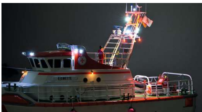
Beleuchtungstest bei Nacht. Die Decksbeleuchtung entstand in Eigenfertigung aus Kleinleuchten vom Modellbau-Kaufhaus und ABS-Teilen. Die Suchscheinwerfer des Baukasteninhalts wurden vorbildnah ergänzt
