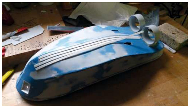
Der Rumpf der STANTUG ist im platten Bodenbereich keinesfalls glatt. Statt die Struktur der Schutzbleche in den GFK-Rumpf einzuarbeiten, sind ABS-Streifen darauf geklebt
