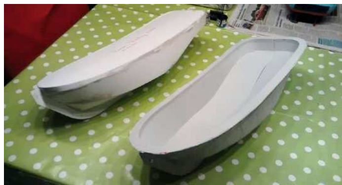
Links im Bild der Ur-Rumpf, der in Spanten- und Plattenbauweise entstand- Daneben das zweiteilige Negativ
