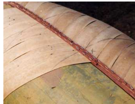
Um Halt im Kielbereich zu finden, dient eine „Tackerleiste“ zur Fixierung der Furnierstreifen
