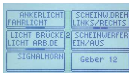
In dieser Geberübersicht eines Beispielsmodells ist auf Ebene 1 und 2 eine Reihe von Funktionen übersichtlich angelegt. Die Doppelbelegung erweitert den Funktionsumfang
