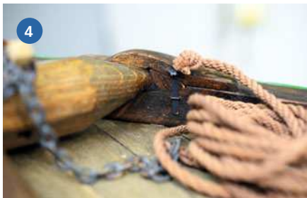
3+4) Der Ankerspill ist aus einem Kantholz gehobelt und an den Enden zugespitzt. So lässt sich die Lagerung im Boeisel herstellen
