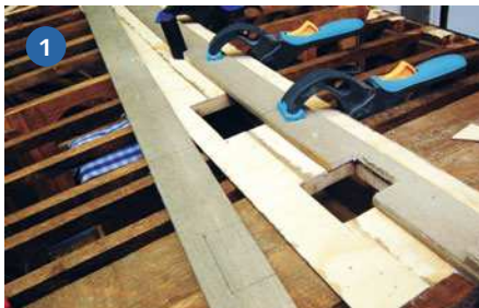
1+2) Auf das zunächst einzupassende Sperrholzdeck wird das eigentliche Deck aufgesetzt. Die untere Schicht sorgt bereits für Dichtigkeit
