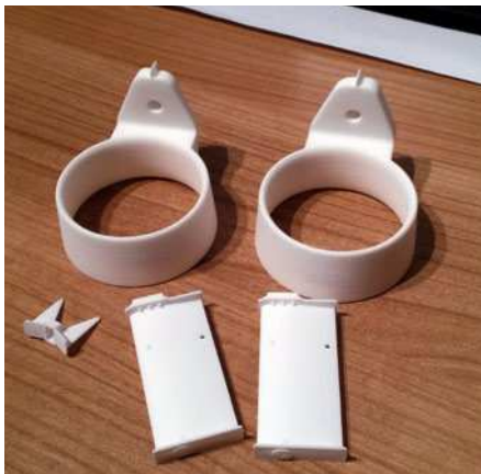
Die fertig gedruckten Kortdüsen und Ruder ersparen einem viel Bauaufwand. Allerdings ist die Oberfläche der Druckteile sehr rau, was man später auch immer erkennen kann
