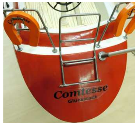
Die Badeleiter am Heck kann zum Baden abgelassen werden
