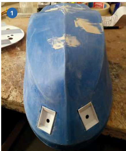
1) Die Ankertaschen sind aus gelaserten Polystyrol-Teilen zusammengesetzt und eingepasst. Die wenigen Spachtelstellen am Rumpf zeigen, dass es der zweite Abzug mit besserer Qualität ist. 2) Dem eigentlichen Beschenkten wurde das Schicksal zuteil, den ersten Rumpf in seinem Baukasten zu haben, der einiger Ausbesserungen bedurfte. Einkomponentenspachtel macht die Arbeit „kurzweilig“
