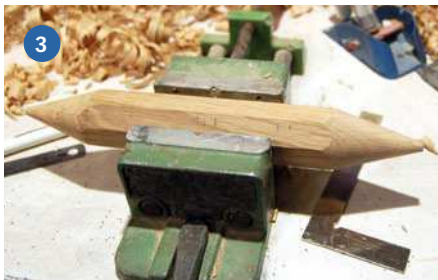
3+4) Der Ankerspill ist aus einem Kantholz gehobelt und an den Enden zugespitzt. So lässt sich die Lagerung im Boeisel herstellen
