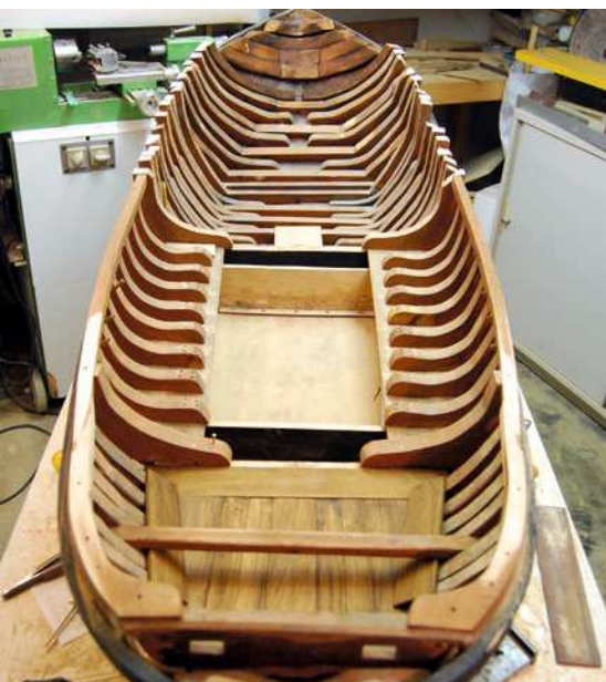
Stück für Stück ließen sich die Mallsanten entfernen, bis der Rumpf an sich fertig „gespant“ war
