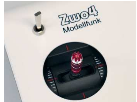
Die Kreuzknüppel sind von sehr guter Qualität. Der obere Schalter dient zum Wechseln zwischen Ebene 1 und 2
