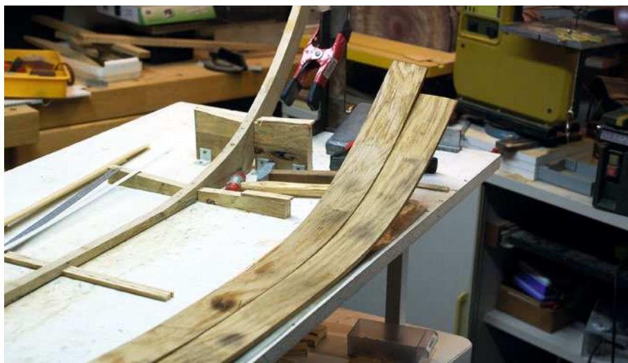
Die Planken sind entsprechend dem Verlauf vorzuformen
