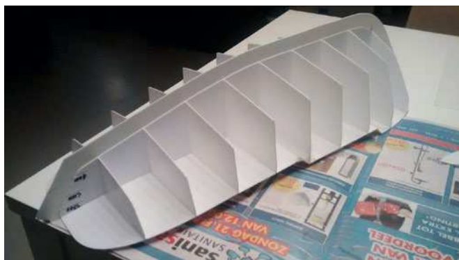
Trotz aller Vorarbeiten am PC, beispielsweise dem Anfertigen der Spanten, war beim Rumpfbau konventionelle Handarbeit erforderlich. Auf dieser Basis entstand der Ur-Rumpf
