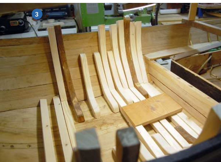
1) Schritt für Schritt, mit vielen Zwingen und mit Hilfe der Berghölzer lässt sich die Beplankung anbringen. 2) Wesentlicher Bestandteil der Kwak ist die Bünne, die beim Modell später die Winden-Technik aufnimmt. 3+4) Nachdem der Rumpf eigentlich fertig ist, werden die „eigentlichen“ Spanten eingepasst und gesetzt. Zahlreiche Spanten wurden mit Beize abgedunkelt, um Eiche zu imitieren
