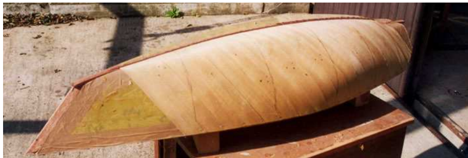
Diagonal verlegte Furnierstreifen bilden die unterste Schicht. Damit das Furnier hält, ist es getackert
