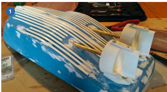
1) Hochwertige Eigenbau-Wellen-Anlagen sorgen für Langlebigkeit. 2) Wechselseitig schritt der Bau beider Modelle voran. Wichtig war/ist ein Lackauftrag Grundierung. Diese verschloss bei den 3D-gedruckten Kortdüsen kleinste Oberflächenperforationen
