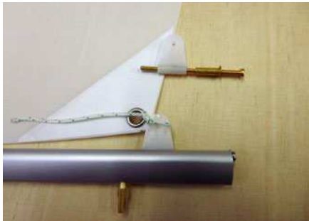
Das Einstellen des Segelbauchs erfolgt über feinfühlig einstellbare Rutscher
