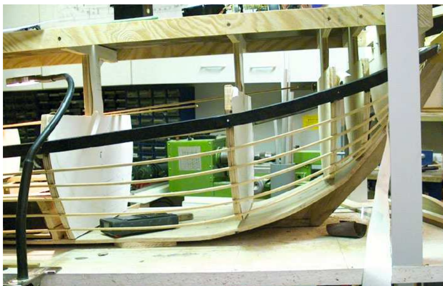
Umgekehrte Bauweise mit Mallspanten – hier ist die Helling quasi oben
