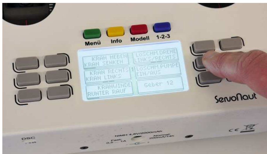
Die Steuerung von Funktionen bei der HS16 erfolgt über die grauen Taster, „Geber“ genannt
