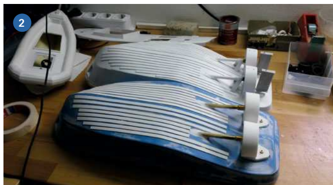
1) Hochwertige Eigenbau-Wellen-Anlagen sorgen für Langlebigkeit. 2) Wechselseitig schritt der Bau beider Modelle voran. Wichtig war/ist ein Lackauftrag Grundierung. Diese verschloss bei den 3D-gedruckten Kortdüsen kleinste Oberflächenperforationen
