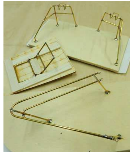
Die Reling ist richtiger Modellbau. Sie ist weich in einer Vorrichtung gelötet und wird noch lackiert
