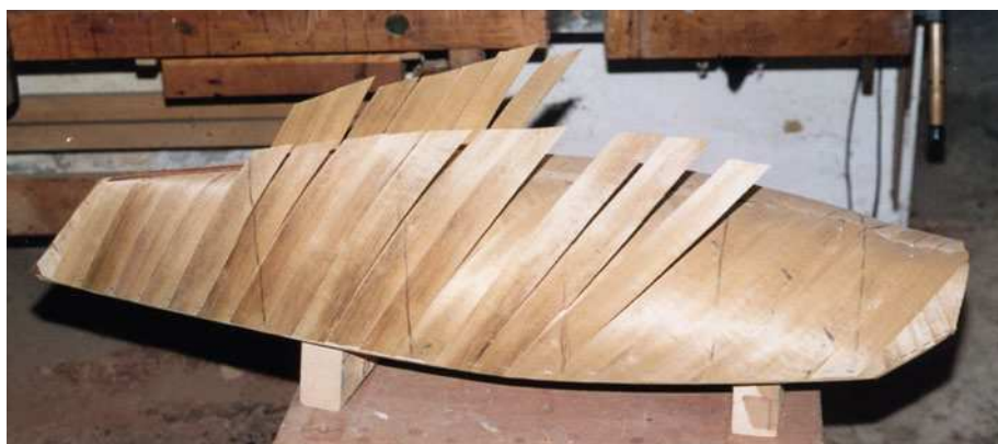
Ist die erste Furnierschicht aufgetragen und im Vakuumverfahren einmal mit Epoxid-Harz gefestigt worden, folgt die zweite Lage Furnierstreifen – sie ist abschließend ebenfalls mit Epoxy zu festigen
