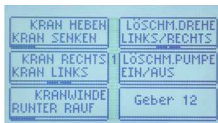
In dieser Geberübersicht eines Beispielsmodells ist auf Ebene 1 und 2 eine Reihe von Funktionen übersichtlich angelegt. Die Doppelbelegung erweitert den Funktionsumfang
