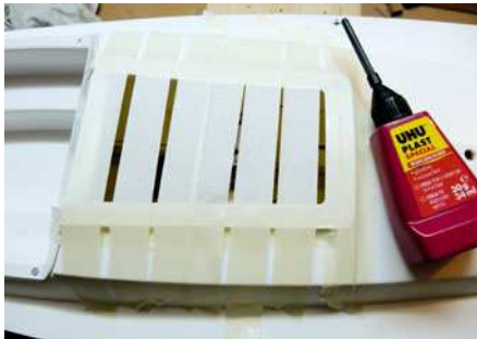
Der Rahmen des Schiebeluks wird mit Klebeband zum Trocknen des Kunststoffklebers gesichert
