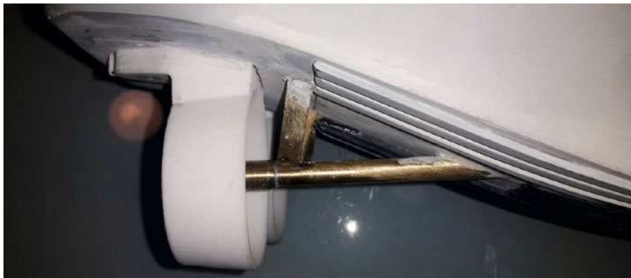
Abgestützt sind die Wellen stabil arretiert und die passend auf die Kortdüse zugeschliffenen Schiffsschrauben können dadurch nicht innerhalb dieser anlaufen
