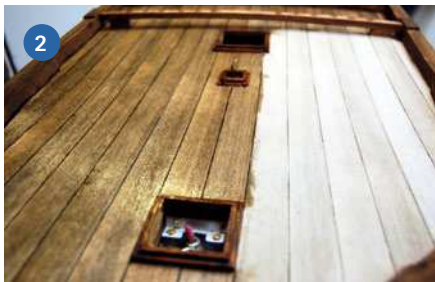
1+2) Auf das zunächst einzupassende Sperrholzdeck wird das eigentliche Deck aufgesetzt. Die untere Schicht sorgt bereits für Dichtigkeit
