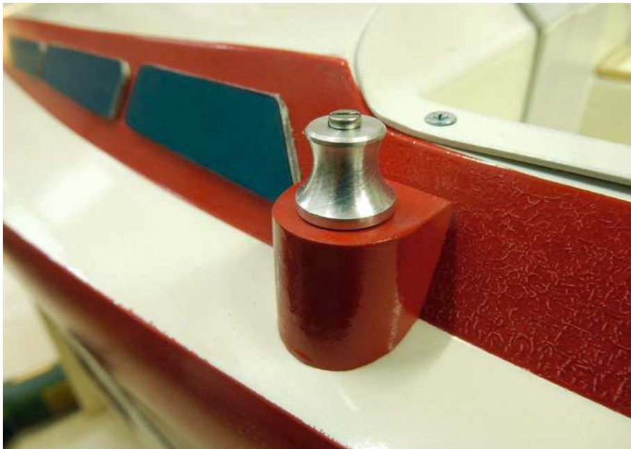
Die Winschenpodeste entstehen aus mehrlagig verleimtem Sperrholz
