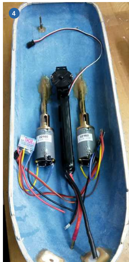
1) Hochwertige Eigenbau-Wellen-Anlagen sorgen für Langlebigkeit. 2) Wechselseitig schritt der Bau beider Modelle voran. Wichtig war/ist ein Lackauftrag Grundierung. Diese verschloss bei den 3D-gedruckten Kortdüsen kleinste Oberflächenperforationen
