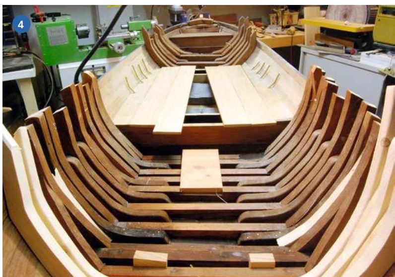
1) Schritt für Schritt, mit vielen Zwingen und mit Hilfe der Berghölzer lässt sich die Beplankung anbringen. 2) Wesentlicher Bestandteil der Kwak ist die Bünne, die beim Modell später die Winden-Technik aufnimmt. 3+4) Nachdem der Rumpf eigentlich fertig ist, werden die „eigentlichen“ Spanten eingepasst und gesetzt. Zahlreiche Spanten wurden mit Beize abgedunkelt, um Eiche zu imitieren
