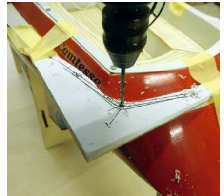
Als Bohrschablone dient die Lötschablone für den Heckkorb
