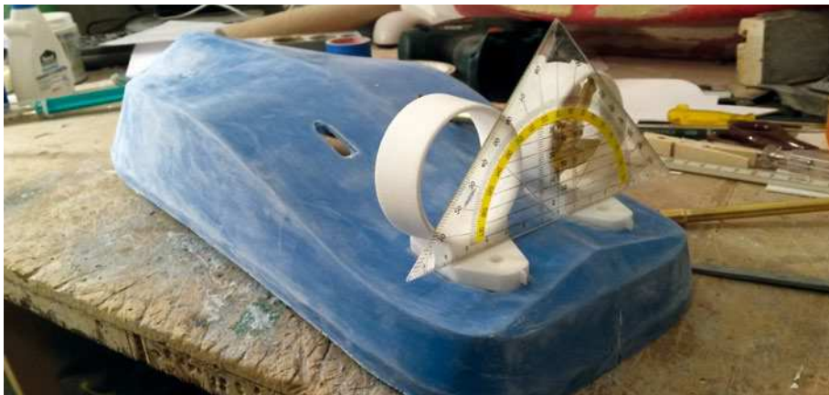
Einpassen der Kortdüsen in Bezug auf die Schiffswellen. Alles exakt auszurichten, ist bedeutend für die späteren Fahreigenschaften
