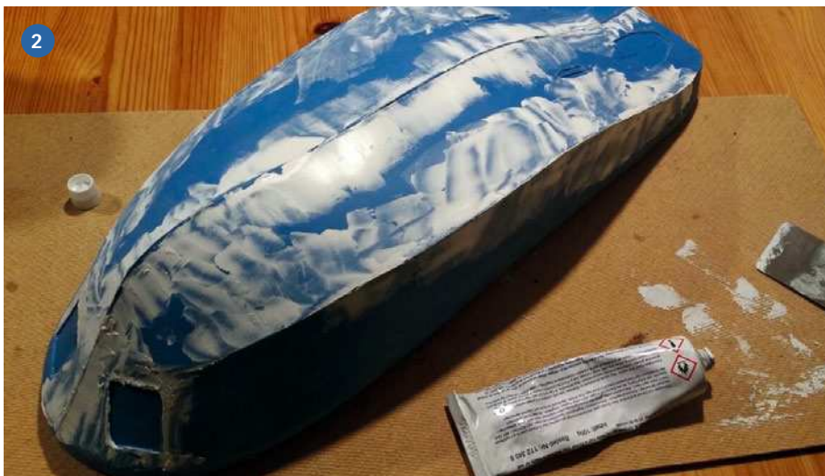
1) Die Ankertaschen sind aus gelaserten Polystyrol-Teilen zusammengesetzt und eingepasst. Die wenigen Spachtelstellen am Rumpf zeigen, dass es der zweite Abzug mit besserer Qualität ist. 2) Dem eigentlichen Beschenkten wurde das Schicksal zuteil, den ersten Rumpf in seinem Baukasten zu haben, der einiger Ausbesserungen bedurfte. Einkomponentenspachtel macht die Arbeit „kurzweilig“
