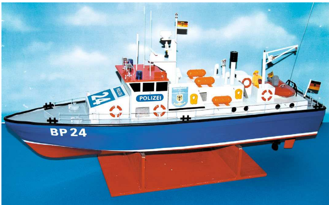
Die Backbordseite des fertigen Polizeiboots BP 24. Deutlich sind die seitlich der hinteren Aufbauten anzubringenden Schwimmwesten, Rettungsringe und Rettungsinseln zu erkennen
