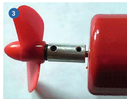
1) Als Motoren werden Bilge-Tauchpumpen eingesetzt, die für den Einsatz in Booten konzipiert sind. 2) Der Regler für den Bürstenmotor. 3) Schiffsschraube an Bilge-Motor
