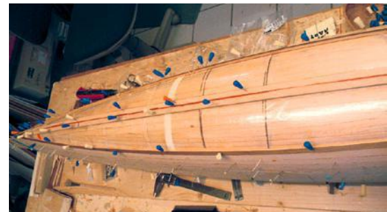
Um die eigentliche Rumpfschale zu bauen, wird die Urform mit Folie bespannt und darauf die ersten, Orientierung gebenden Zedernholzplanken mit Nadeln fixiert
