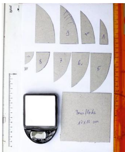
Alle Spanten wurden zum Maßnehmen und eventuellen Korrigieren zunächst auf Pappe übertragen. Mit ihnen ließ sich auch der Verdrängungsschwerpunkt ermitteln
