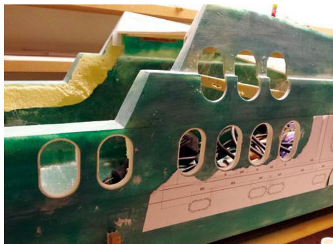
Ausfräsen der Löcher und einkleben der Fensterzargen
