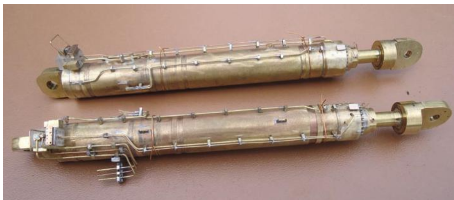
Zum optischen Hingucker werden die aus Blechen gebauten Zylinder erst durch die Hydraulikleitungen
