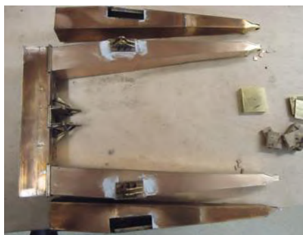
Aus verschiedenen starken Bronzeblechen, die auf Kante verlötet wurden, entstand ein A-Frame mit diesen verwinkelten Vierkanten
