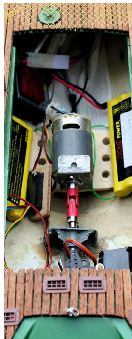
Als Motor wurde der alte Motor aus der PAUL DENKER eingebaut sowie ein 9,6-Volt-Akku
