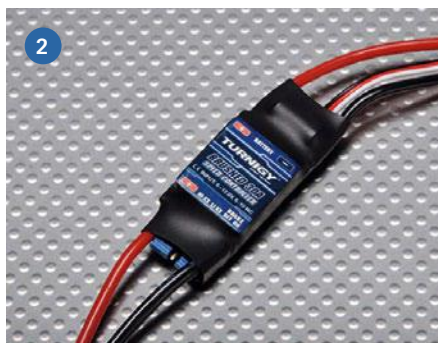
1) Als Motoren werden Bilge-Tauchpumpen eingesetzt, die für den Einsatz in Booten konzipiert sind. 2) Der Regler für den Bürstenmotor. 3) Schiffsschraube an Bilge-Motor
