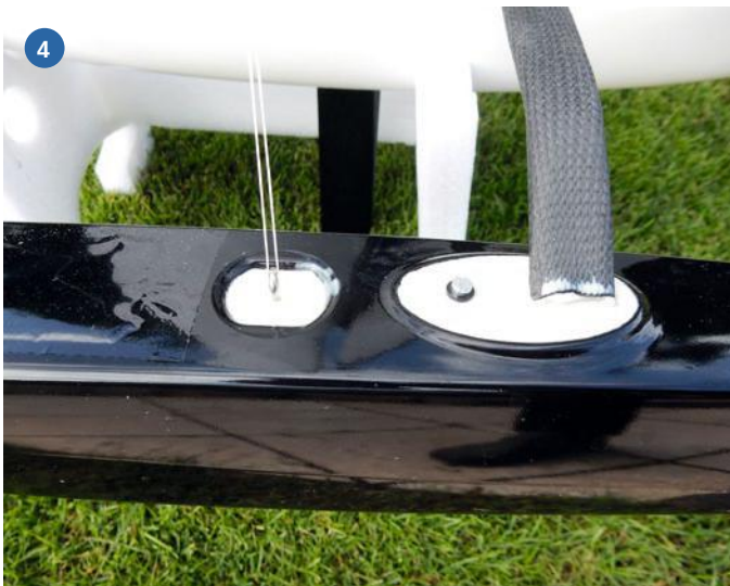
1) Der Mast wird 30 mm erhöht, damit das Großsegel ganz auf geht ... 2) ... deshalb muss auch das Vorstag verlängert werden. 3) Aus diesem Grund muss auch der Mast mit Wanten abgespannt werden ... 4) ... die auf den Seitenschwimmern angreifen
