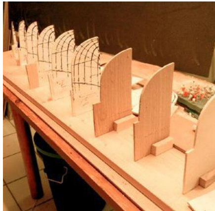
In konventioneller Überkopfbauweise entstand das Spantengerüst auf einer Bauhelling
