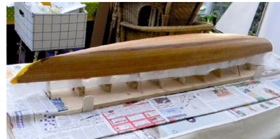
Der fertig mit Zedernholzleisten beplankte Rumpf ist im nächsten Schritt außen mit einer Lage GFK-Gewebe zu belegen. Erst nach dessen Aushärten kann man die Schale von der Urform nehmen
