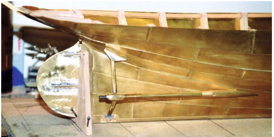
Alle Platten an der SCHAARHÖRN sind gesetzt. Als nächstes steht das Polieren, Versiegeln und Lackieren an
