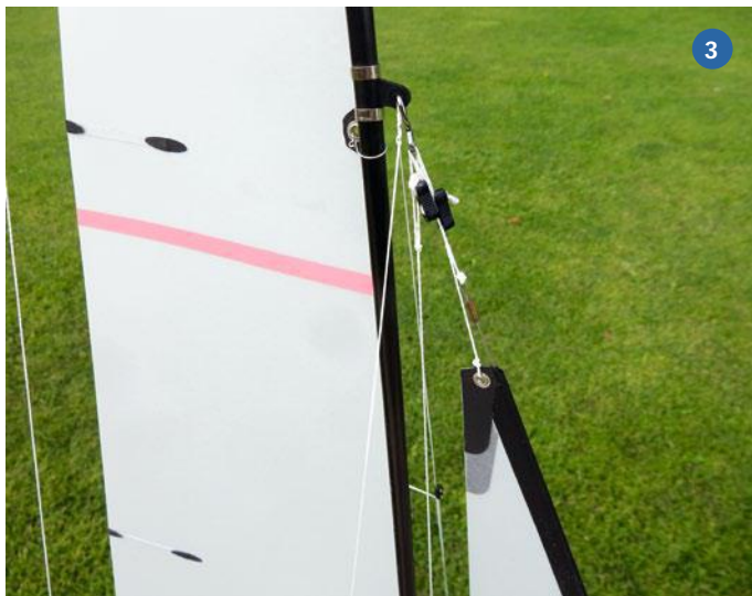
1) Der Mast wird 30 mm erhöht, damit das Großsegel ganz auf geht ... 2) ... deshalb muss auch das Vorstag verlängert werden. 3) Aus diesem Grund muss auch der Mast mit Wanten abgespannt werden ... 4) ... die auf den Seitenschwimmern angreifen
