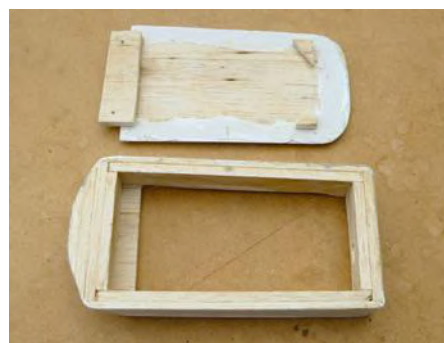
Basis des Kabinenhauses und abnehmbaren Dachs sind Balsaleisten, die passend zu verschleifen waren
