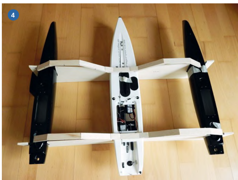
1) Aus Balsaholz entsteht der Kern der Beams, ... 2) ... der an den Ecken verstärkt wird ... 3) ... und nach dem Schleifen mit einem CFK-Schlauch bezogen wird, ... 4) ... aber davor werden die Rohlinge mittels Schablonen angepasst
