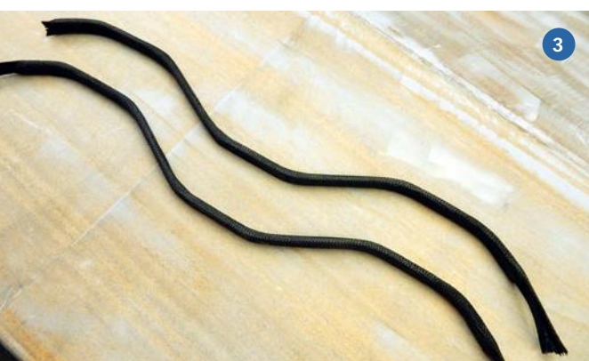
1) Aus Balsaholz entsteht der Kern der Beams, ... 2) ... der an den Ecken verstärkt wird ... 3) ... und nach dem Schleifen mit einem CFK-Schlauch bezogen wird, ... 4) ... aber davor werden die Rohlinge mittels Schablonen angepasst
