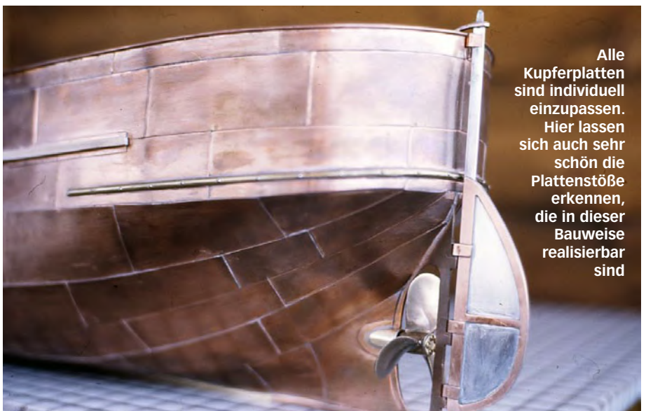
Alle Platten an der SCHAARHÖRN sind gesetzt. Als nächstes steht das Polieren, Versiegeln und Lackieren an
