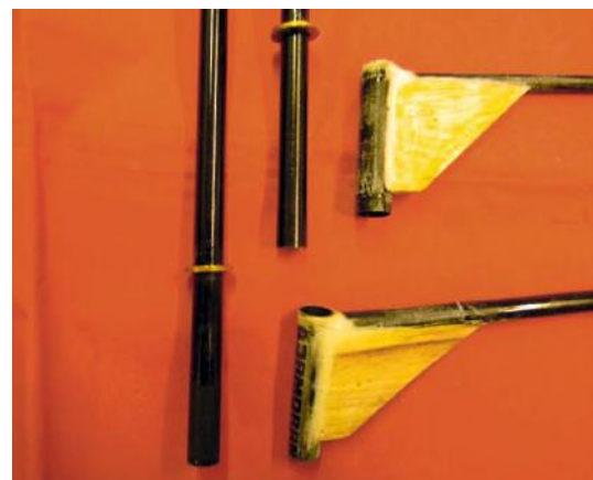
Verstärkungsdreiecke an den Masten geben den Bäumen nicht nur Halt, sondern tragen auch das CFK-Rohr-Lager. Ein Messingring am Mast hält den Baum auf Position
