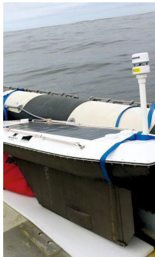
Die SAILBUOYS haben einen großen Kiel, um auf See nicht zu kentern. Selbst stürmischer Wellengang kann ihnen nichts anhaben
