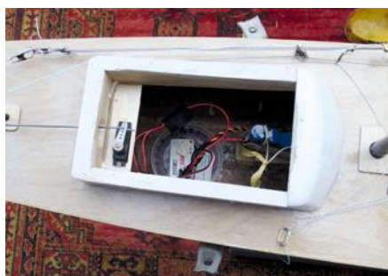
Zugang zum Rumpffinneren über die Luke. Die Schoten sind alle außen geführt, um ohne Umstände Anpassungen vornehmen zu können
