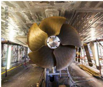
Ab Schiff fünf der Serie besteht der Propeller aus Messing
