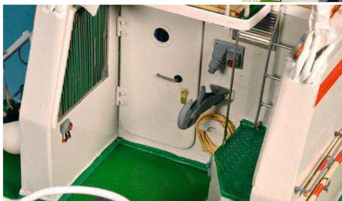
Neben der Tür zum Rettungsraum befindet sich eine trapezförmige mit Lamellen abgedeckte Öffnung. An der Rückwand des Deckshaus ist außerdem ein recht kräftiger Schlepphaken mit Fernauslösung angebracht ebenso wie die Leiter zum Aufstieg zum Peildeck
