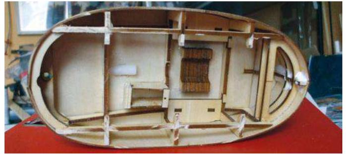
Rohbau mit Motorhalterung, Welle, Ruderkocker und Servo-Halterung
