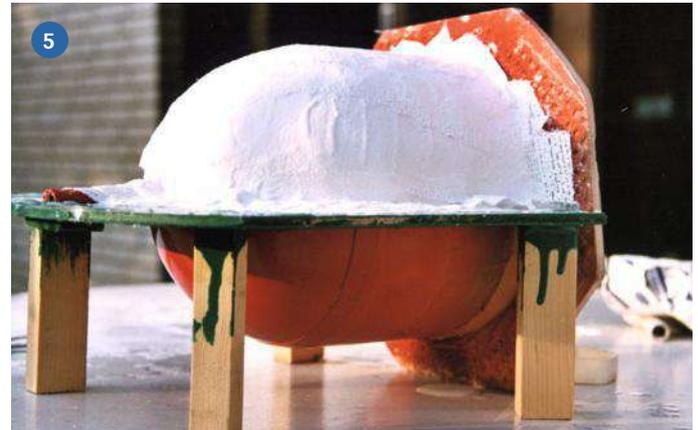
1) Von diesen beiden Urformen für ein U-Boot-Modell soll mit Hilfe von Gips-Negativen ein GFK-Abzug erstellt werden. 2) Da mit zwei Halbschalenformen gearbeitet wird, ist zunächst eine Trennschicht zu bauen. 3) Exakt in der Mitte befindet sich die Trennstelle. 4) Ganz wichtig beim Abformen mit Gips ist eine saubere, mit Trennwachs behandelte Oberfläche. Im Trennbrett eingelassen sind Zentrierkugeln. 5) Die erste Hälfte ist mit Gips bedeckt und muss nun komplett aushärten
