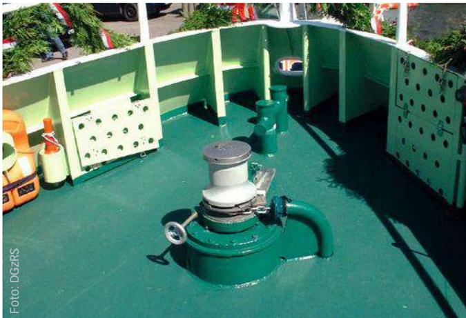
Auf dem Vorschiff des Originals sind Taue und Bergungsnetze in den Staukästen auf der Innenseite des Schanzkleids untergebracht
