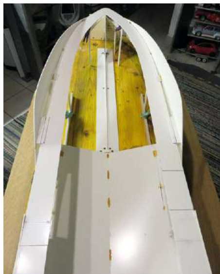
Die Form des späteren Sonnendecks bestimmt maßgeblich auch die oberen Befestigungspunkte der Rumpflplatten
