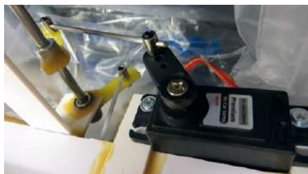
Servoantrieb für die beiden Klappen auf dem Vordeck neben dem Pool
