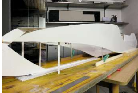
Hier gut zu erkennen ist die Stützkonstruktion, die einen Verzug-freien Bau der Seitenteile ermöglicht
