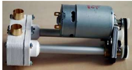
Das gesamte Bugstrahlruder zusammengebaut
