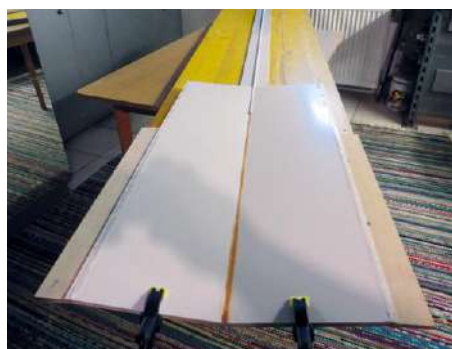
Auf dem Tisch liegt eine waagrecht ausgerichtete Mehrschichtplatte, auf der mittels Holzkonstruktion die spätere V-Form des Rumpfs montiert ist. Die ersten beiden 800 Millimeter langen und 2 Millimeter starken ABS-Platten liegen schon in der Form
