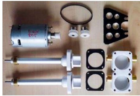
Einzelteile der Bugstrahlruder. Oben der Motor mit Zahnriemenscheibe, die zwei Zahnriemenscheiben und der Zahnriemen. Daneben eine 5-Millimeter-Aluplate zur Befestigung der Komponenten. Links unten die zwei Stevenrohre mit dem Rotor und dem oberen Deckel. Daneben zwei Gummidichtungen und die beiden unteren Gehäuse
