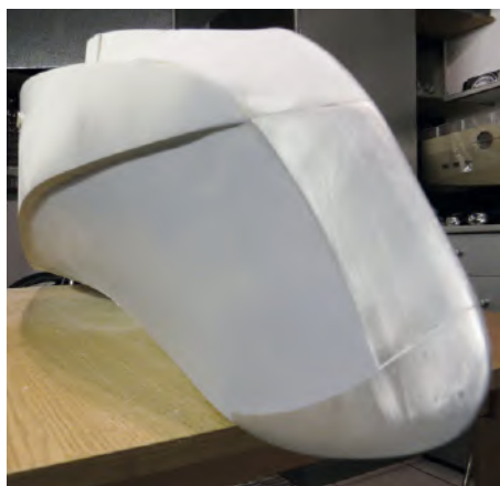
Der zweite Steven besteht aus zwei Elementen, die relativ viel vom Bug umschließen
