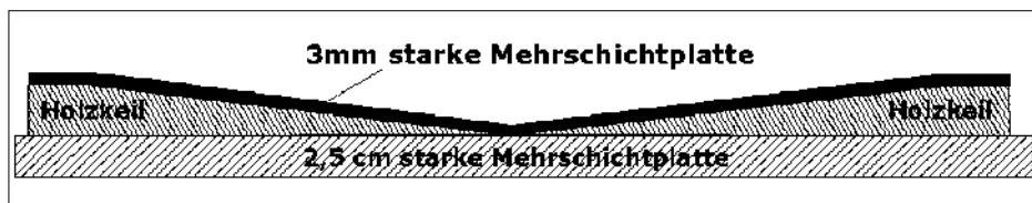
Zeichnung 2: Prinzipskizze zum hinteren Rumpfaufbau
