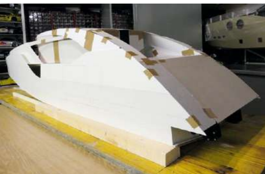
Mit Hilfe von Pappschablonen ließ sich die endgültige Optik des Aufbaus finden
