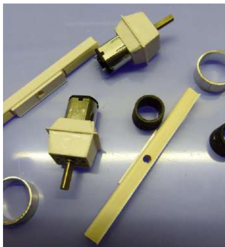
Abbildung 8) Die Motoren wurden in Gummi-hülsen gesteckt
