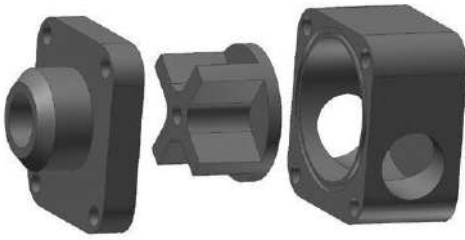
Die 3D-CAD-Zeichnungen: Links der Deckel, in der Mitte der Rotor und rechts das Unterteil
