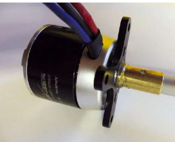
Motorhalterung mit Messingübergang auf die Alu-Stevenrohre.
