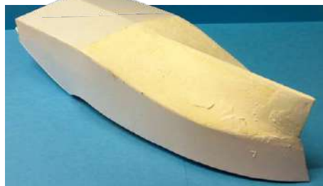
Bug und Rumpfspitze waren durch Anpassen und Schleifen herauszuarbeiten
