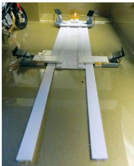
Aus Polystyrol wurde auch die Tender-Aufnahme gebaut. Diese lässt sich über einen Bowdenzug ein- und ausfahren, um den Tender auszusetzen
