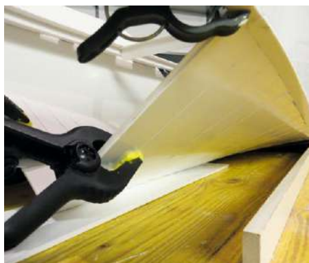
Aufgrund der Rumpfform war die Einarbeitung einer Spritzwasser-abweisenden Kante erforderlich
