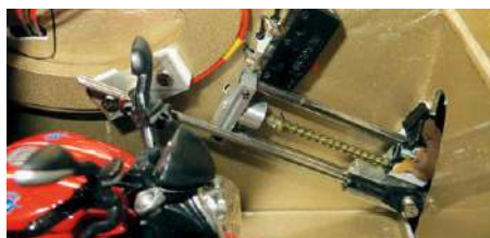
Eingebauter Spindelantrieb für die Heckklappe der PALMER JOHNSON
