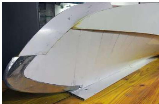
Der mit Aluminium verstärkte Steven ist ein Wesensmerkmal der SKY und später sichtbar gestaltet
