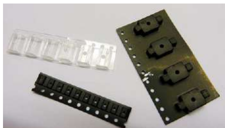
Abbildung 9) Das Verpackungsmaterial der LED konnte sehr gut als Schalter verwendet werden
