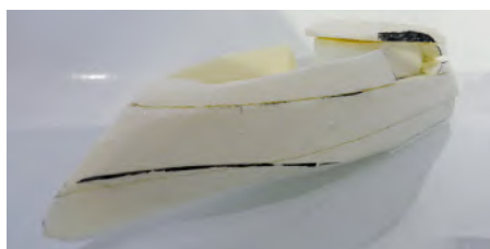
Zur Beurteilung der Yacht im eigentlichen Element, nahm das Styrodur-Modell in der Badewanne Platz
