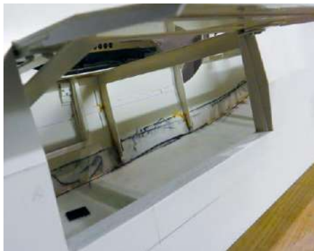
Die Tendergaragen waren wegen des Beachclubs seitlich in die Rumpfwand zu integrieren
