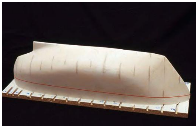
Nach einigen Malen Spachteln und Schleifen stellt sich ein zum Abformen bereiter Rumpf ein
