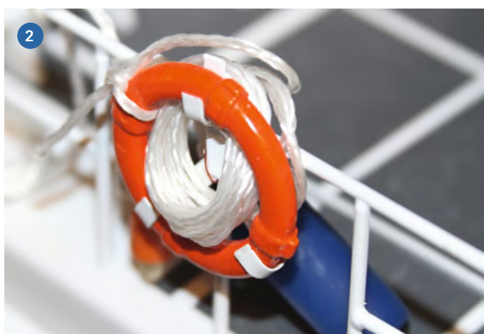
1) Der Graupner-Bausatz stellt eine solide und gute Grundlage für den Aufbau eines Modells nach selbst gewähltem Vorbild dar. 2) Filigraner als der Baukastenbeschlag sieht die Rettungsring-Aufnahme im Eigenbau aus – der ist einfach an die Messingreling gelötet. 3) Die Handläufe am Aufbau sind doppelt ausgeführt
