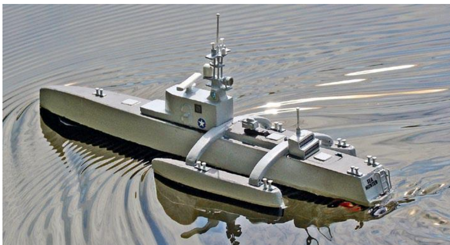
SEAHUNTER von backbord aus gesehen. Charakteristisch sind die Trimaran-Ausleger, die eine Auslegung als Langläufer gestatten
