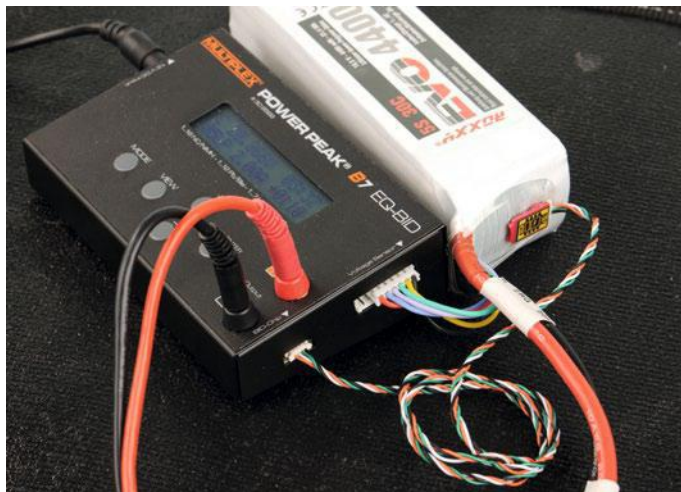
Am Ladegerät B7 angeschlossen sind der BID-Chip des Akkus, das Balancerkabel und das Ladekabel. Mit dem Druck auf „Start“ kann der sichere Ladevorgang beginnen
