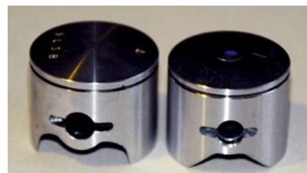
Links der Kolben Zenoah G320 PUM und rechts der Kolben des G290 PUM. Die Modifikation ist auf den ersten Blick erkennbar
