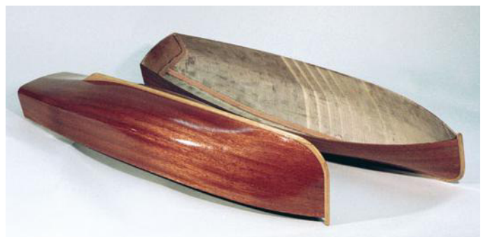
Aufwändig, jedoch sehr effektiv ist die diagonale Beplankung mit dünnen Holzstreifen
