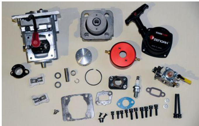
Zerlegt in seine Einzelteile lässt sich der Zenoah G320 PUM genauer analysieren
