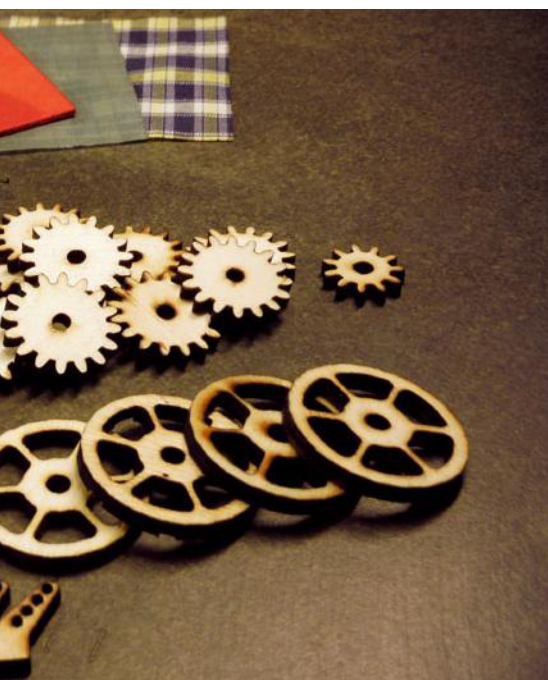
Abbildung 7: Vergleich der Schnittkante an Balsaholz und Sperrholz – man erkennt den unterschiedlichen Grad der Verkohlung
