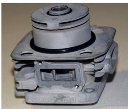
Die Verschlüsse für die Überstromkanäle sind beim Zenoah G320 PUM abnehmbar
