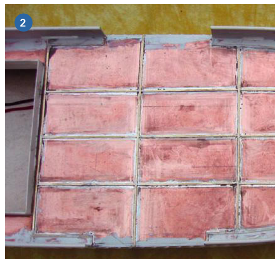
1) Zum Einsatz kommen bei der VLIESTROOM zwei 12 Volt-Gefeg-Motoren von Conrad Electronic. 2) Sämtliche Decks wurden aus Bronzeblech gefertigt, so kann sich auch bei Hitze nichts verziehen
