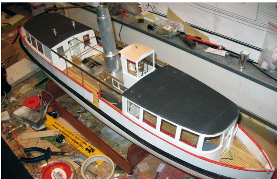
Steuerhaus in Holzbauweise und der Mittelaufbau aus blech verkleiden die Dampfmaschinenanlage
