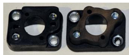
Der Isolator ist etwas breiter geworden, die Vergaserbefestigung hat jedoch weiterhin die gleichen Abmessungen
