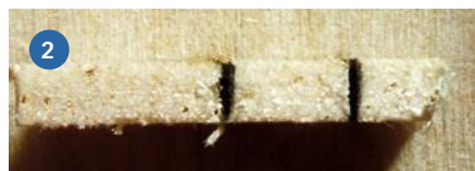
Abbildung 1) Der Abstandssensor erzeugt kleine Messfehler, wenn das von ihm emittierte Licht an zwei unterschiedlichen Ebenen reflektiert wird. Abbildung 2) Schnittkante im Querschnitt – die Flanken sind nahezu senkrecht, hier am Beispiel eines 1 Millimeter starken Balsabrettchens. Abbildung 3) Die Fokussierung gelingt leicht mit einer Blendenlamelle, die zur Sicherheit an einem Griffchen befestigt ist
