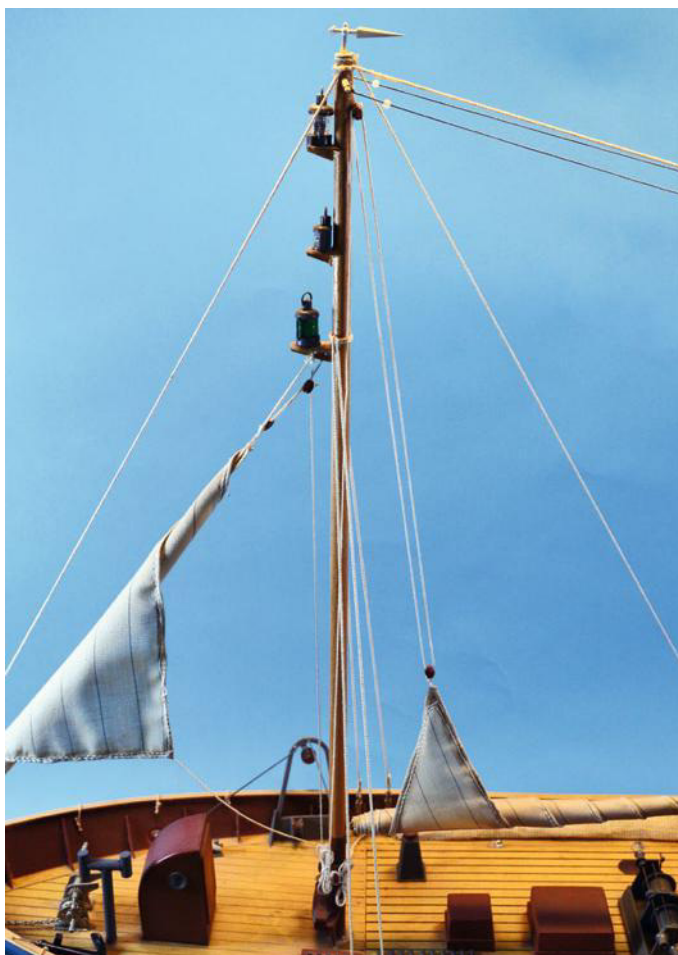
Die Mastlichter kennzeichnen den Fahrzustand des Kutters, etwa „Schleppen“, „Fahrt mit Maschine“ oder „vor Anker“
