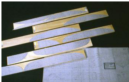
Baut man den Rumpf auf Basis des Wasserlinienrisses, sind die einzelnen Schichten auf entsprechend dicke Bretter zu kleben
