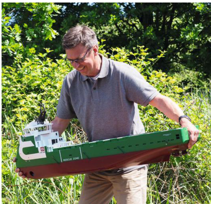
Im Maßstab 1:75 gebaut ist die BORBON MONSOON von Olaf Schulze noch gut ins Wasser einzusetzen. Der Versorger für Bohrseln entstand auf einem selbst gebauten GFK-Rumpf und die Aufbauten sind aus Phosphor-Bronzeblech
