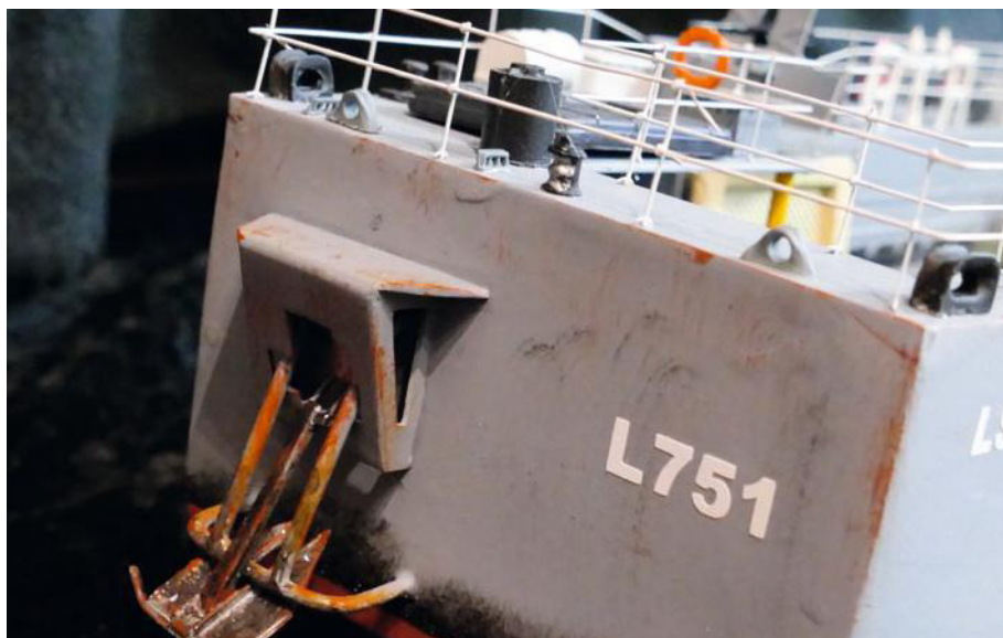
Typisch für ein Landungsboot ist der Heckanker, über den sich das Schiff nach dem Anlanden auch wieder ins Tiefwasser ziehen kann
