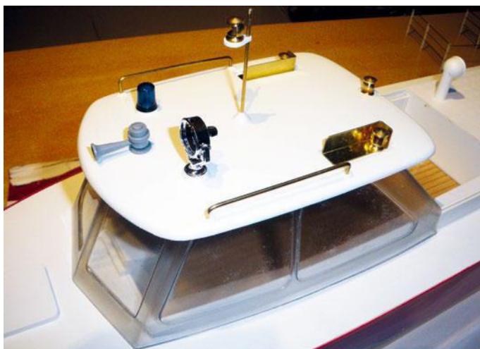
Die Beleuchtungselemente und andere Kleinteile werden probenhalber schon vor dem Lackieren des Deckshauses angebracht
