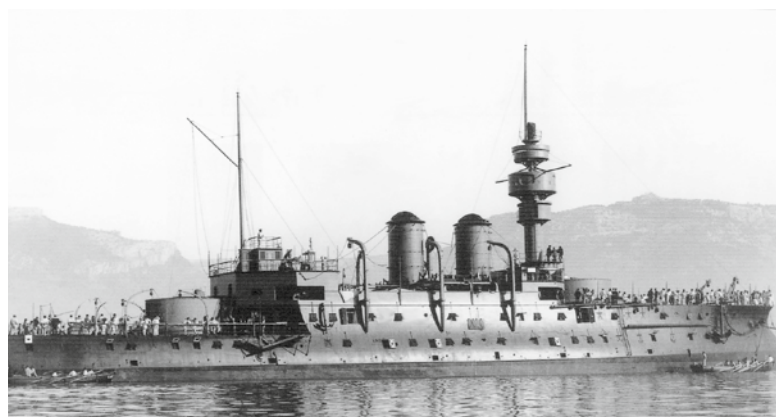
Abbildung 5: Der dunkle Streifen über der Konstruktionswasserlinie bei BOUVINES zeigt die Höhe des Gürtelpanzers an. Die kleine Hütte vor dem hinteren Mast ist eine Admiralskammer. Die Beiboot-Barkunen neben dem Gefechtsmast sind nach vorn umgelegt; die großen Bootsdavits nach innen geschwenkt
