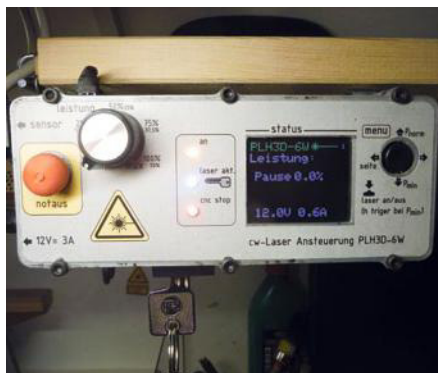
Abbildung 7: Startzustand des Laser-Treibers – nach dem Einschalten steht er immer zur Sicherheit in Standby
