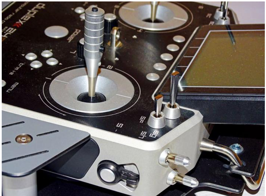
Die ausgebaute rechte Seite: Links der Knüppel mit den beiden Tasten, in der Mitte die beiden Dreipositions-Schalter, rechts unten die beiden Sicherheits-Schalter
