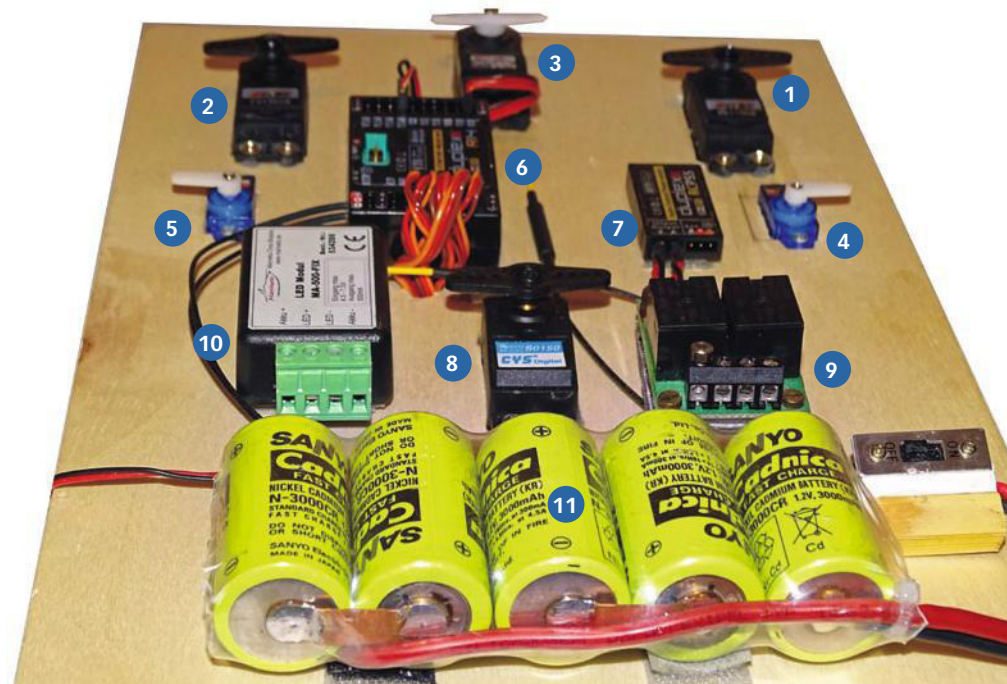
Die mit RC-Technik bestückte Sperrholzplatte für die Trockenübungen beziehungsweise Programmierung der wichtigsten Funktionen
