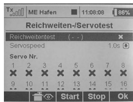
Ein sicherheitsrelevantes Feature ist das Menü „Reichweiten-/Servotest“
