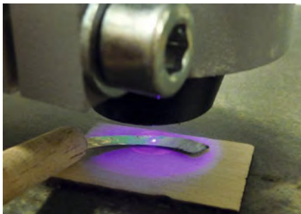
Abbildung 9: Das Fokussieren auf einer Blendenlamelle – zur besseren Handhabung ist sie an einem Griff befestigt
