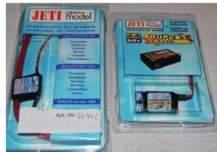
Der Jeti-Expander E4 (rechts auf dem Bild) erweitert die Anschlussmöglichkeiten um vier Sensoren – links ein Stromsensor
