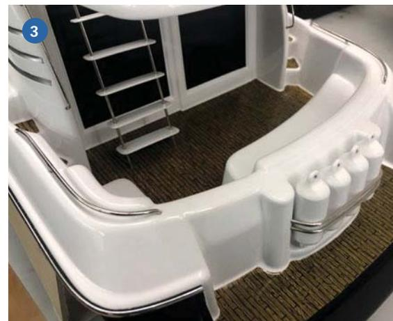
1) Beim exakt winkligen Ausrichten der Reling hilft eine Schablone und sorgt somit für Maßhaltigkeit. 2) Die Verarbeitung der Scheibe – hilfreich ist, etwas Überstand zu lassen. 3) Das Aufkleben der Folie für die Holzdeck-Imitation ist mit etwas Gefühl umzusetzen. Schön sind ansprechende Details wie die Fender
