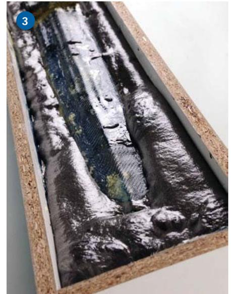
1) Das Urmodell ist mit Feinschicht bestrichen und für den Laminataufbau bereit. 2) Feinschicht, Kupplungsschicht, Glasgewebe auflegen sind erledigt, doch die lange Form wäre für sich genommen etwas labil, muss also stabilisiert werden. 3) Mit zunehmender Queldauer umschließt der Quikset Pro-Schaum die Negativform und macht sie zur stabilen Einheit bei extrem geringem Gewicht
