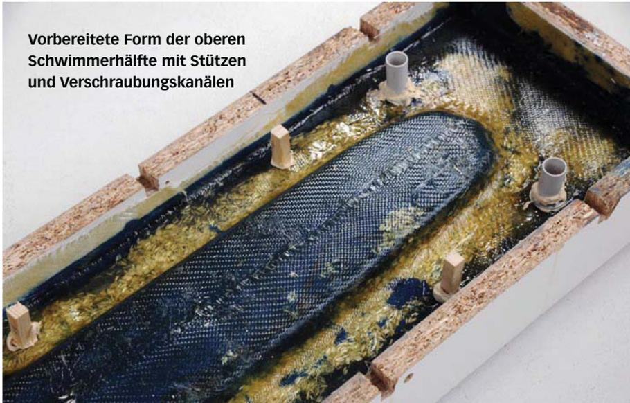
Vorbereitete Form der oberen Schwimmerhälfte mit Stützen und Verschraubungskanälen
