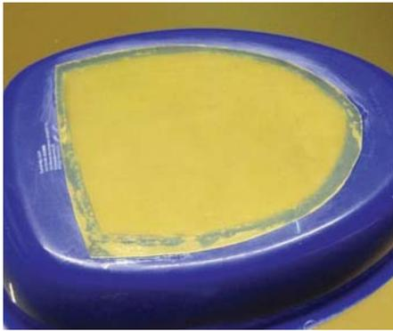
Das Loch im Boden habe ich mit einer GFK-Platte verschlossen. Sekundenkleber reagiert hervorragend mit dem Polyethylen des Rumpfs
