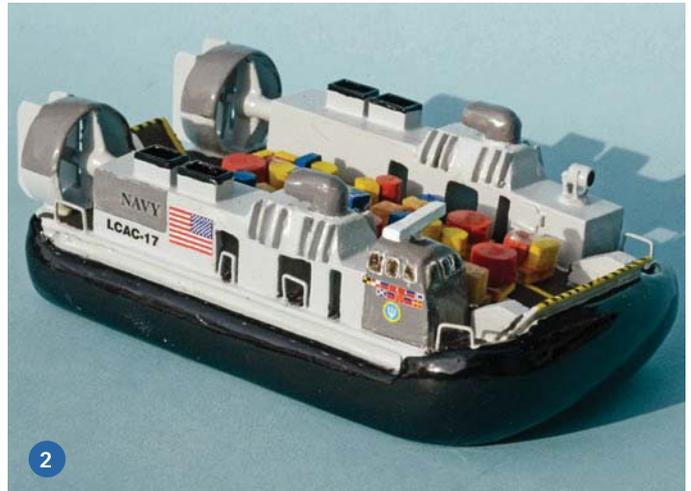
1) LCAC-08 (links, Maßstab 1:175) mit Einschraubenantrieb und Ruder sowie LCAC-17 (rechts) mit servolosem Zweischraubenantrieb im direkten, visuellen Vergleich. Auch die Ladung ist eine andere. 2) Modell der LCAC-17 von Steuerbord vorne. Die US-amerikanische Fahne ist aus Papier angefertigt worden
