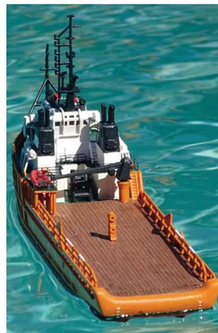
Ein Highlight des Modells ist das Echtholzdeck. Auf dem Achterdeck wird dazu ein dünnes Holzfunier aus Zeder eingefügt. Auf dieses wird die Struktur von Holzleisten aufgezeichnet
