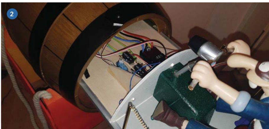
1) Ein schönes Party-Bierfass aus Plastik dient Werner als Gefährt. 2) Im Fass sind zwei Aluschienen eingelassen, auf denen das RC-Brett gleitet und an dem die Rückplatte befestigt ist. 3) Oberhalb des Zapfrohrs ist ein zweites Rohr mit gelber LED eingelassen, aus dem Wasser spritzen kann. 4) Eine klassische Ruderanlage sorgt für Richtungswechsel
