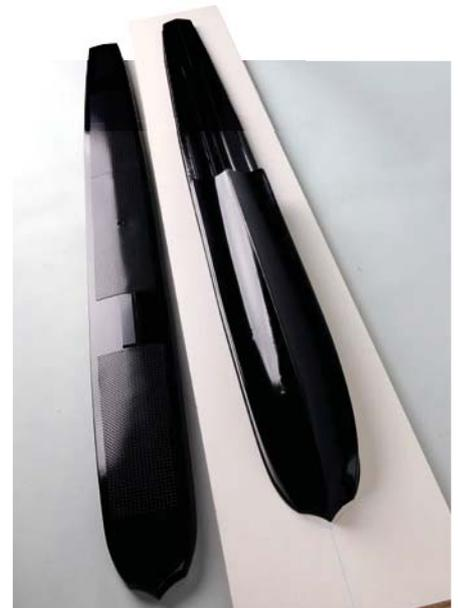
Die Urmodelle des (geteilten) Schwimmers, wobei die untere Hälfte (rechts) bereits auf einem Brett befestigt und zum Erstellen einer Negativform bereit ist
