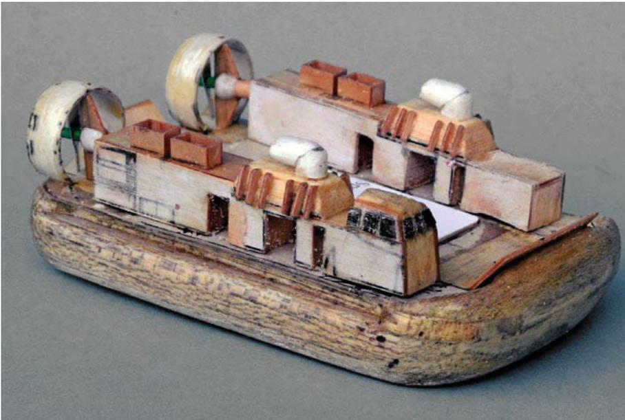
**So sieht das Rohmodell vom Steuerbord aus. Allein der Maßstab macht das Modell zu etwas Besonderem. Es ist eine reine Balsa/Sperrholz-Konstruktion**
