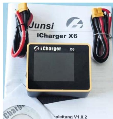
Der X6-Lader wird mit zwei Kabeln mit XT60-Stecker und deutscher Bedienungsanleitung geliefert
