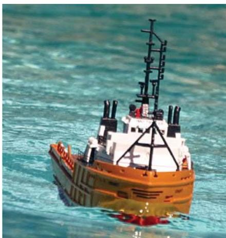
Bei dem Modell kommen ein Sechskanal-Empfänger von Spektrum, zwei N20-Mikromotoren und ein 4,8 Volt-1.900 Milliamperestunden-Akku zum Einsatz. Durch das kleine, aber starke Antriebspaket sind Fahrzeiten von bis zu drei Stunden möglich
