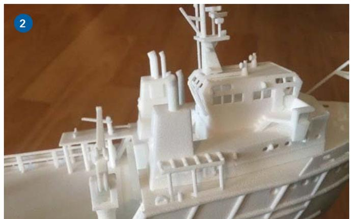
1) Der Aufbau ist abnehmbar und besteht aus poliertem Nylon. Er verfügt über eine Wandstärke von 1 Millimeter, ist dabei gleichzeitig leicht und doch stabil. 2) Mit einer Vielzahl an Besagteilen wird das Modell ergänzt – Mast, Scheinwerfer, Winden und weitere Teile. Die meisten Besagteile sind in Harz ausgeführt, das feinere Strukturen bei besseren Oberflächen erlaubt
