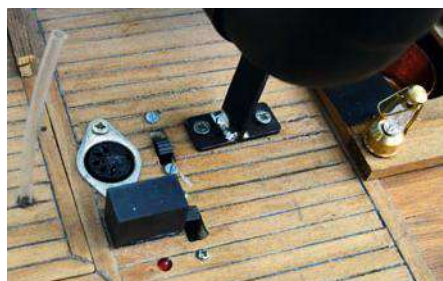
Zum nötigen Equipment gehört die Buchse (Diodenbuchse), die die elektrische Verbindung vom Rumpf zu den Aufbauten herstellt (Beleuchtung, Lautsprecher) und das Kunststoffröhrchen als Antennendurchführung
