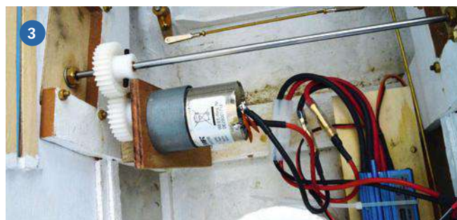
1) Von Nahem betrachtet erkennt man den Zylinder mitsamt Schiebsteuerung. 2) Eine Besonderheit beim Antrieb von Mississippi-Raddampfern sind die feststehenden Schaufeln. 3) Statt Dampf treibt dieser Elektrofahrmotor mit Fahrregler das Modell an
