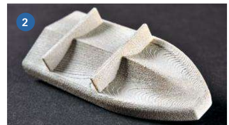
1+2) Beschlagteile aus dem 3D-Drucker hört sich vielversprechend an und kann es auch sein. Bei der CAPE ST. GEORGE erfordern diese Teile allerdings viel Nacharbeit, wie die Nahaufnahmen zeigen. Das verwendete Polyamid ist leider nicht schleifbar, sondern muss grundiert werden
