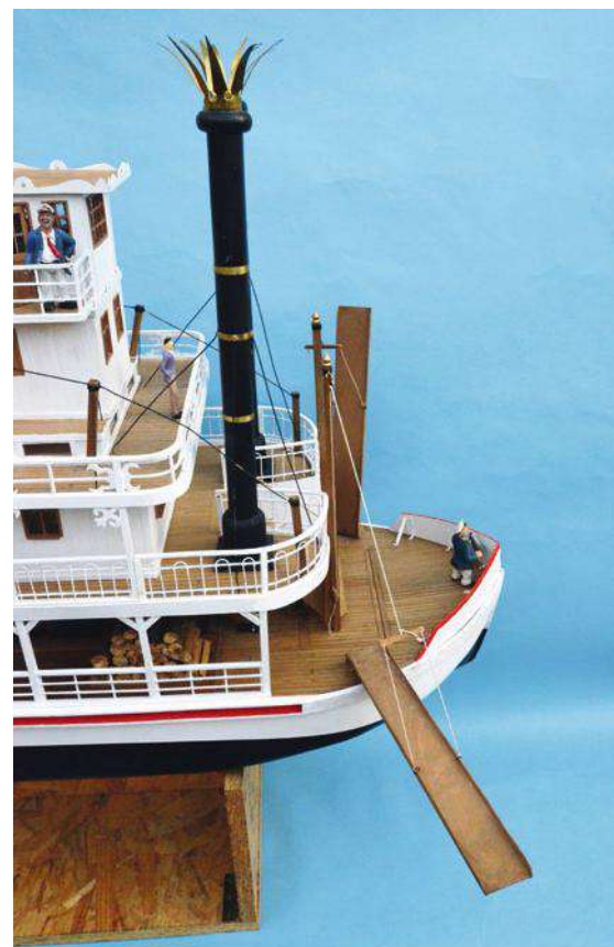
Der Laufsteg lässt sich mithilfe einer Feder und einer Motorwinde jederzeit hoch oder runter klappen
