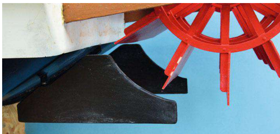
Unterhalb des Schaufelrads ist die Doppelruderkonstruktion angebracht
