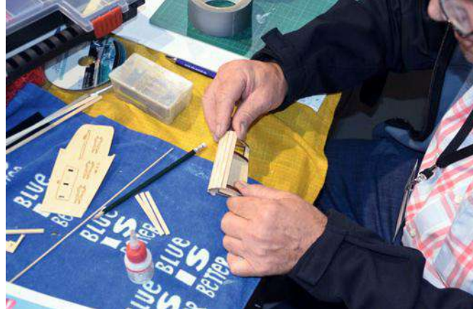
Die Einzelteile des Kielbretts werden sorgfältig verleimt
