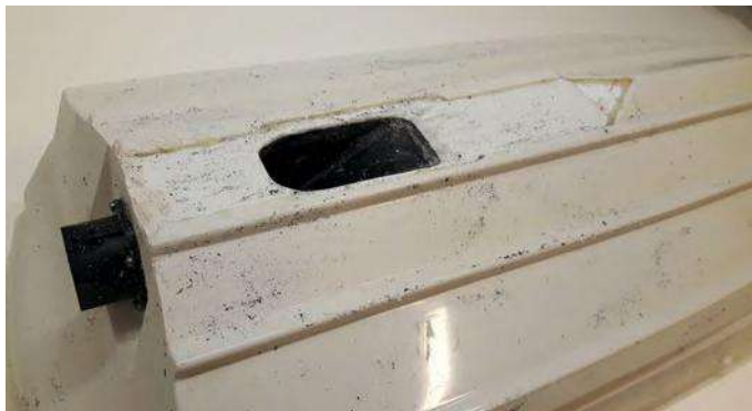
Glatte, saubere Übergänge gewährleisten einen verlustarmen Betrieb des Jets
