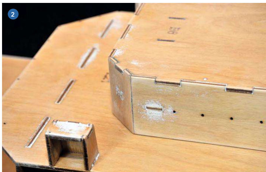
1+2) Alle Verzinkungen müssen sauber verspachtelt und geschliffen werden. Jede kleine Lunke würde sonst nach dem Grundieren, aber spätestens beim Lackieren unschön auffallen und den Gesamteindruck trüben
