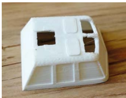
Typisch für 3D-Druck-Teile ist die raue, teils grobe Oberfläche, die bei diesen Teilen allerdings sehr deutlich ausfiel
