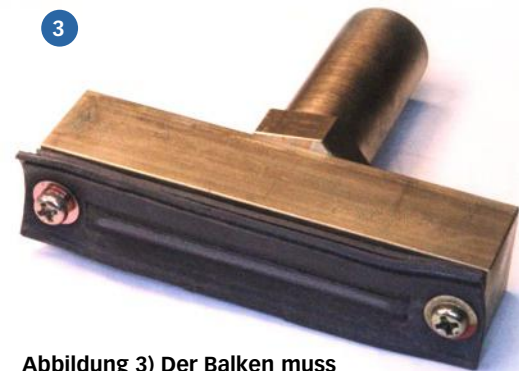
Abbildung 3) Der Balken muss eine entsprechende Dicke haben
