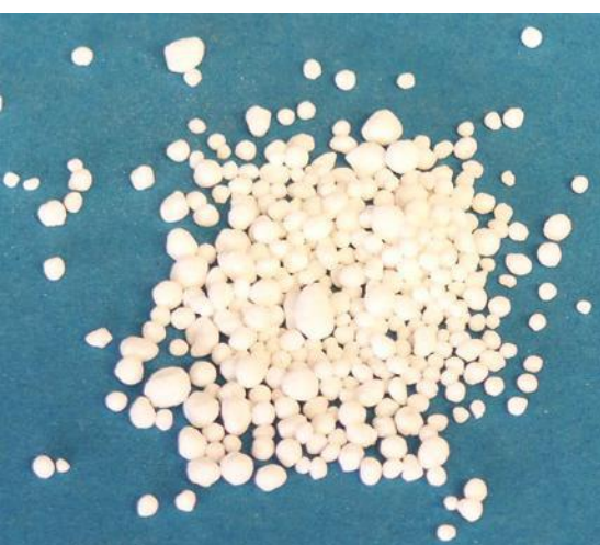
0,5 bis 5 Millimeter große sind die Glashohlkugeln PyroBubbles
