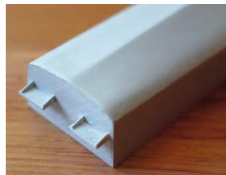
Schön, dass der Heckspiegel bereits dran war, doch der Rumpf war zu lang geraten und musste gekürzt werden
