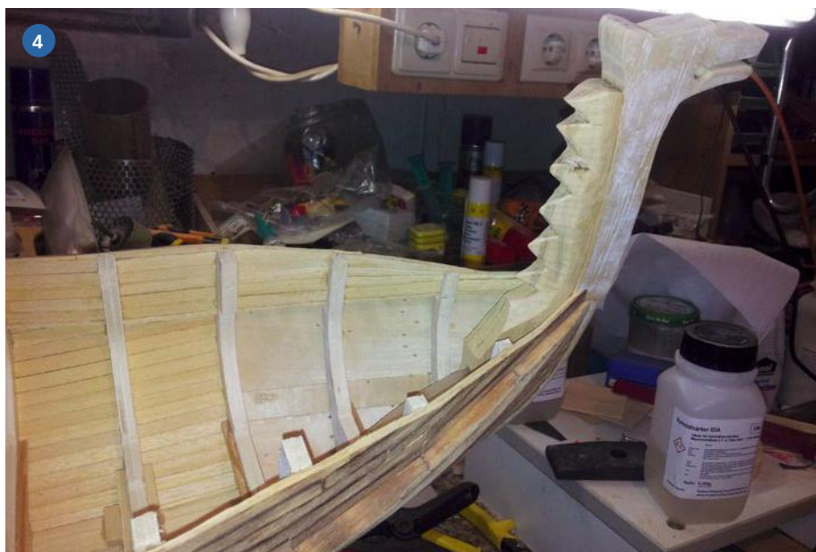
1) Der Bau erfolgte klassisch auf einer Helling. 2) Das Musterstück für die Klinkerbeplankung. Unterhalb ist eine gerade Beplankung und darauf kleben die Klinkerplanken. 3) Um die typische Klinkeroptik zu erzielen, ist etwas Aufwand zu betreiben. 4) Besonders beim Drachenkopf lohnt sich etwas Mühe
