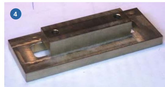
Abbildung 4) Von unten lassen sich die M4-Schrauben eindrehen
