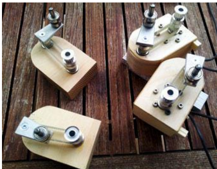
Teile der ersten Rudermechanik, die aber nicht funktionierte
