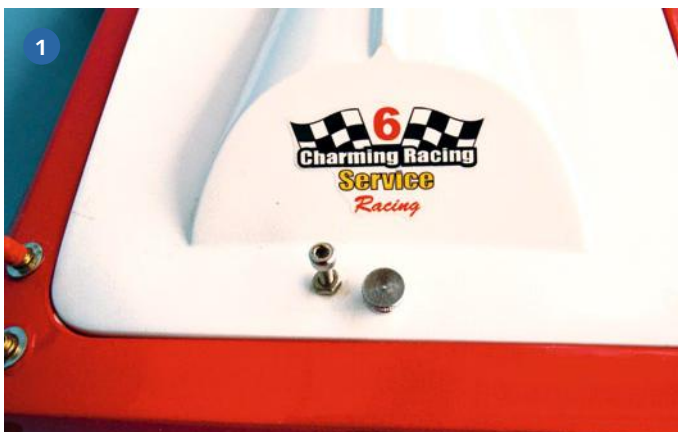
1) Bereits eingelassene Rändelschraube zur Deckelbefestigung an der Rückseite. 2) Der Kurzschlussstecker ist in Eigenleistung eingebaut worden. Praktisch ist die mit einem Gummistöpsel gedichtete Entwässerungsbohrung
