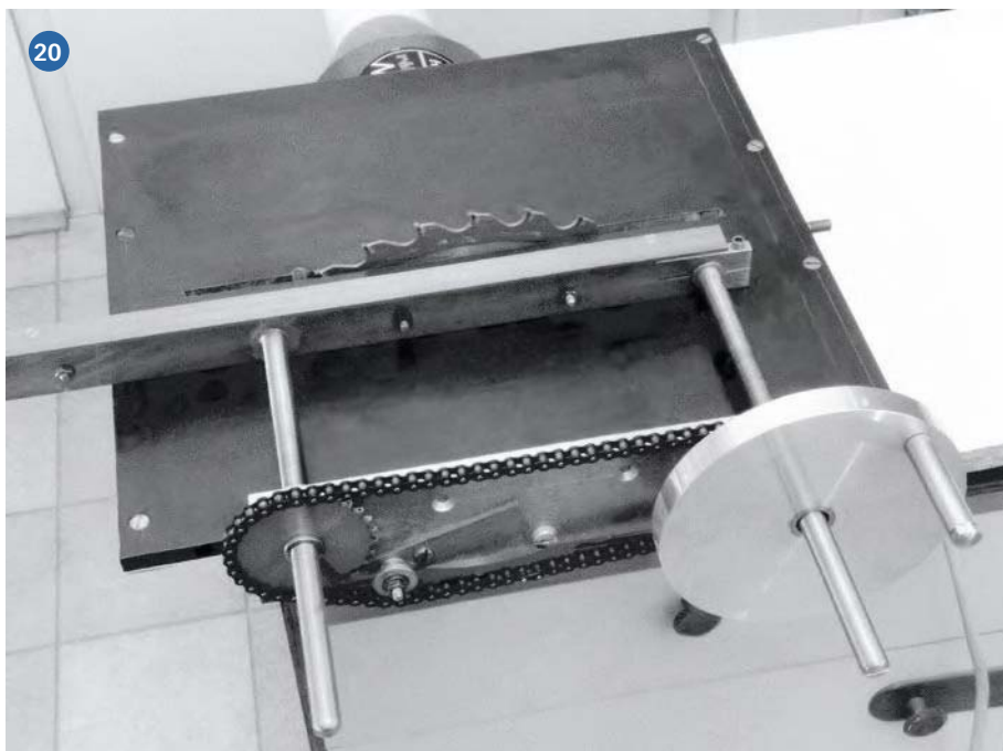
Abbildung 20) Für die Spannung der Kette läuft diese über ein kleines Spannrade unten.
