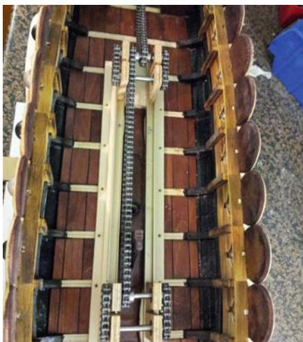
Eine Hauptantriebskette dreht vier kleine Ketten-„Ovale“, die die Exzenterbewegung ermöglichen
