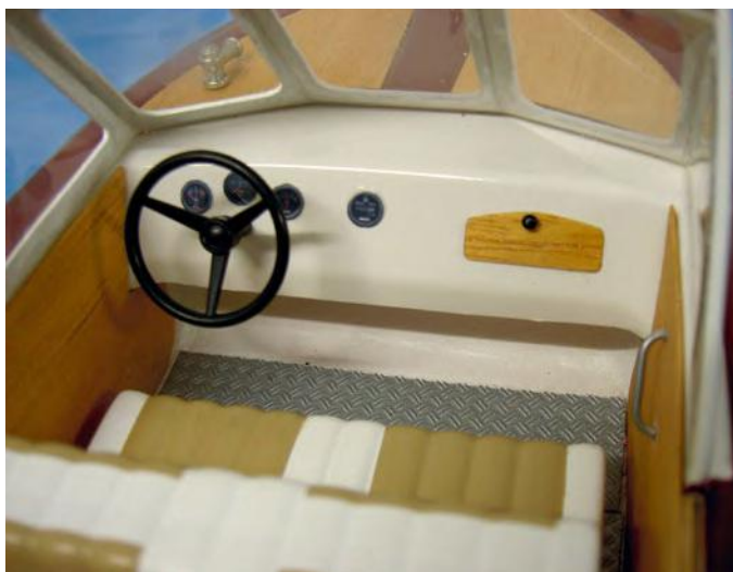
Ausgekleidet mit Furnieren – gut zu erkennen ist der erweiterte Fußraum, die erst einen Einsatz der Puppe im Maßstab 1:16 gestattet
