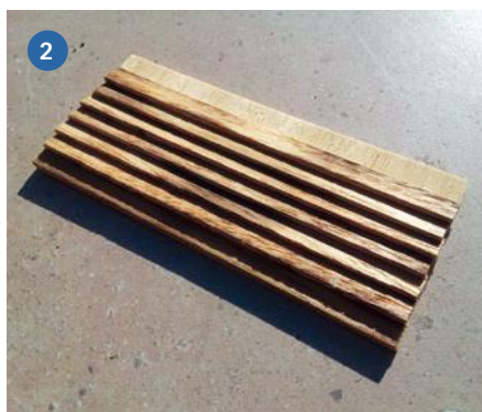
1) Der Bau erfolgte klassisch auf einer Helling. 2) Das Musterstück für die Klinkerbeplankung. Unterhalb ist eine gerade Beplankung und darauf kleben die Klinkerplanken. 3) Um die typische Klinkeroptik zu erzielen, ist etwas Aufwand zu betreiben. 4) Besonders beim Drachenkopf lohnt sich etwas Mühe
