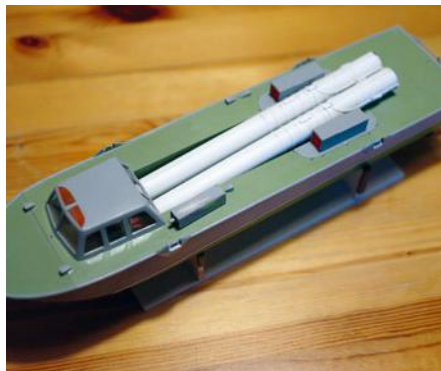
Aus Polystyrolrohren und -profilen entstanden die Torpedorohre mit Anbauten
