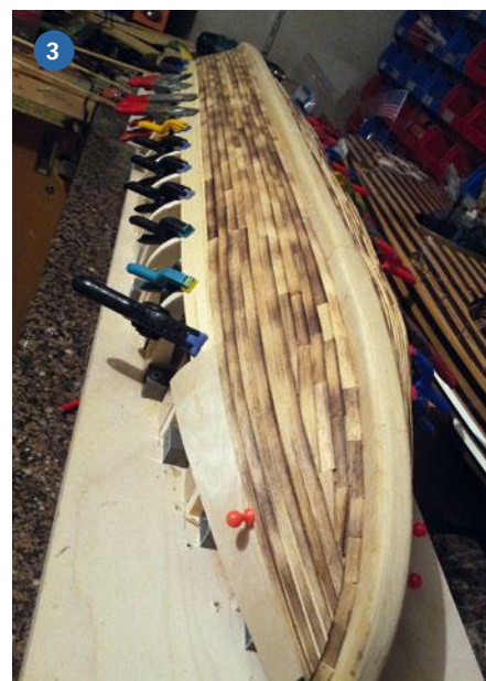
1) Der Bau erfolgte klassisch auf einer Helling. 2) Das Musterstück für die Klinkerbeplankung. Unterhalb ist eine gerade Beplankung und darauf kleben die Klinkerplanken. 3) Um die typische Klinkeroptik zu erzielen, ist etwas Aufwand zu betreiben. 4) Besonders beim Drachenkopf lohnt sich etwas Mühe
