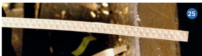
Abbildung 23) Das rechte Ende einer Prägebank mit einem eingelegten Folien-Streifen. Abbildung 24) Die Zahl 1,1 bedeutet 1,1 mm (Mitten-)Abstand der Nieten. Abbildung 25) Nicht optimal belichtet, doch man erkennt die Genauigkeit. Abbildung 26) Die farbige Seite wird an das Deckshaus geklebt. Abbildung 27) Schön, was man mit Koordinaten-Bohren erreichen kann
