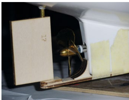
Ruder und Hacke sind fest zu montieren. Die Schraube ist zusätzlich zu erwerben
