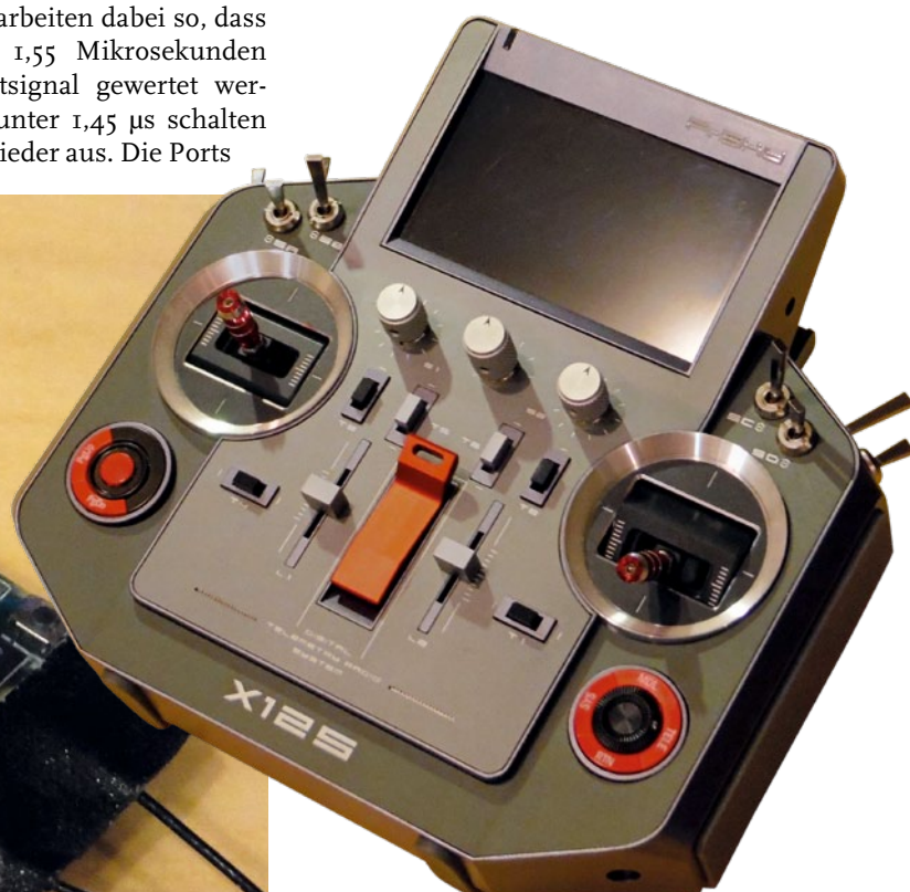
Von FrSky gibt es mittlerweile eine Reihe Fernsteuerungen, die bis 32 Kanäle bieten, wie hier beispielhaft die Horus X12S
