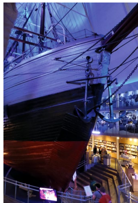
Die massiv verstärkte Bugpartie der FRAM
