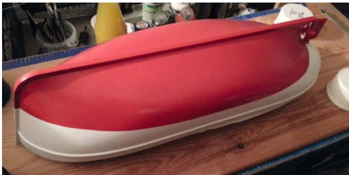
Das Unterwasserschiff ist bereits lackiert. Jetzt steht das Aufzeichnen der weißen Wasserlinie sowie der weißen Schürze an
