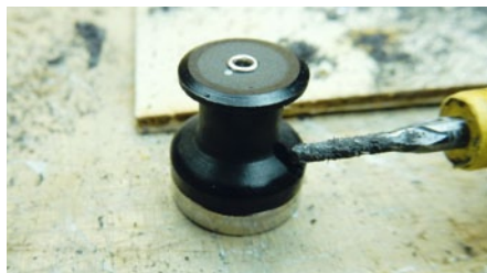
Die Winschen – hier die am Modell verwendeten und von CAP Marquettes bezogenen Ausführungen – werden durchbohrt und ausgehöhlt
