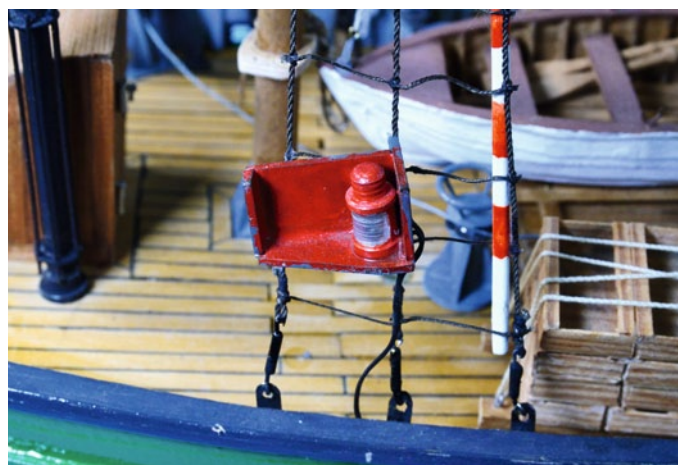
Wanten des Hauptmasts mit befestigtem Positionslicht. Dort eingehängt ist ein langstieliger Fanghaken
