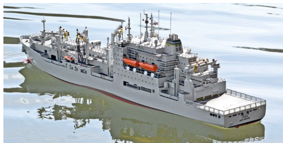
Das Modell im Maßstab 1:200 hat trotz allem eine stattliche Länge von knapp über einem Meter. Die hohen Aufbauten bringen es dank guter Trimmung und tiefem Schwerpunkt nicht aus dem Gleichgewicht
