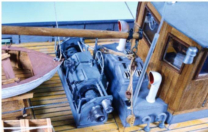
Die Netzwinde mit etwas aufgespultem Drahtseil. Dahinter zu erkennen sind Luken mit Oberlichter, Schwanenhals-lüfter, Festmacher für den Kurrbaum und einige Details mehr
