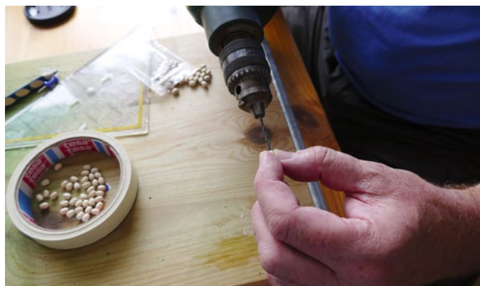
Durch die Netz-Rollen ist die Netz-Kette zu führen. Leider mussten alle Rollen nachträglich aufgebohrt werden
