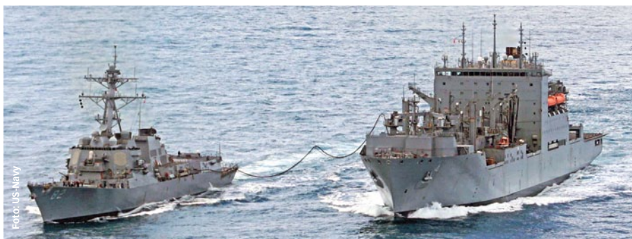
AKE-4 bei der Treibstoffübergabe an einen Zerstörer – gut zu erkennen an dem über das Rigg laufende Trageil mit Schlauch
