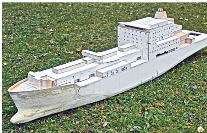
Das erstmals geschliffene Modell. Hier bereits mit den fortgeschrittenen Aufbauten von Deck- und Brückenhaut
