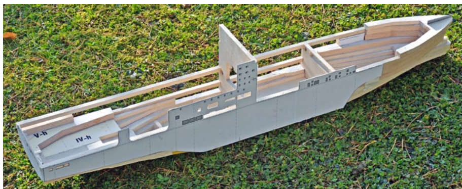
Hilfreich beim exakten Herausarbeiten der Konturen und Größen sind die aufs Holz geklebten Planbereiche – das Ganze ähnelt einer Schablonenbauweise
