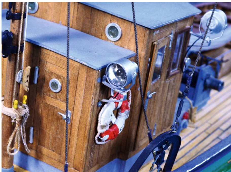
Hinter der Tür befindet sich der Abort, der sich natürlich auch vorbildgetreu einrichten ließe. Zahlreiche Lichter und Scheinwerfer des Modells sind übrigens funktionsfähig mit LED
