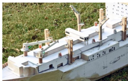
Aus Sperr- und Kiefernholz, teilweise etwas Balsa, entstehen die Kräne, Versorgungstürme und Übergabestationen
