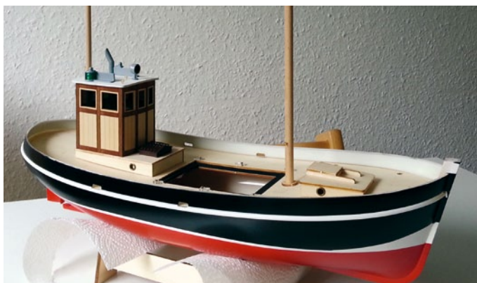
Über die große Wartungsluke hat man Zugang zu Akku, Motor und RC-Komponenten
