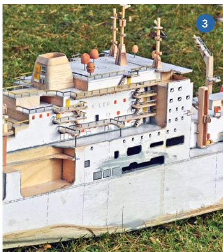
1) Das weitgehend rohbaufertige Modell ist bereits mit zahlreichen Ausrüstungsgegenständen ausgestattet. 2) Die Rolltore des Heli-Hangars sind durch Pappe nachgebildet. Bei den Öffnungen im Heckspiegel ist an eine gute Abdichtung zu denken. 3) Das fast fertige Rohbaumodell von achtern. Zu beachten ist die Relling aus Heftklammern und aufgelegten Kartonstreifen. Die Radome sind gedreht, der Schornstein aus Balsa. 4) Aus einem Holzblock sind die für diesen Schiffstyp bekannten Freifallrettungsboote entstanden. Wenige Details reichen zur ergänzenden Ausgestaltung
