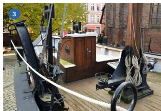
1) Das Original eines 17-Meter-Kutters vor dem Stralsunder Meeresmuseum. 2) Blick auf das Deck des Originals. Gut zu sehen das Scherbrett angelehnt am Netzgalgen. 3) Der Niedergang auf der Back des Originals. 4) Die Netzwinde auf dem Original. Betrieben wurde sie über einen Riemen, der am Antriebsmotor gekoppelt war
