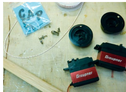
Die kuggelgelagerten Blöcke werden an einer Leiste im Bug montiert, die Schot wird später mit einem Hutgummi gespannt
