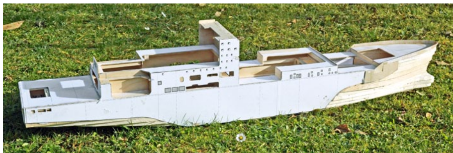
Das an den Seiten beplankte Modell noch im Rohbau und vor dem Schleifen. Gut erkennen lassen sich die großen zugänglichen Bereiche
