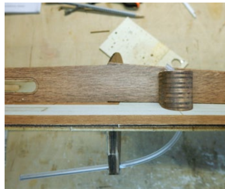
Die Winschenpodeste entstehen nach Plan, werden nach dem Beizen durchbohrt und an Deck montiert
