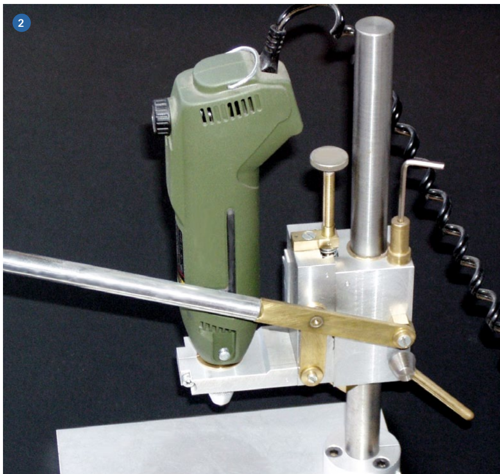
Für den Spannhals braucht es eine geschlitzte Klemmbuchse. Die Schwalbenschwanz-Führung muss immer gut gefettet sein
