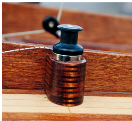
Nach der Bearbeitung auf dem Podest montierte Winsch
