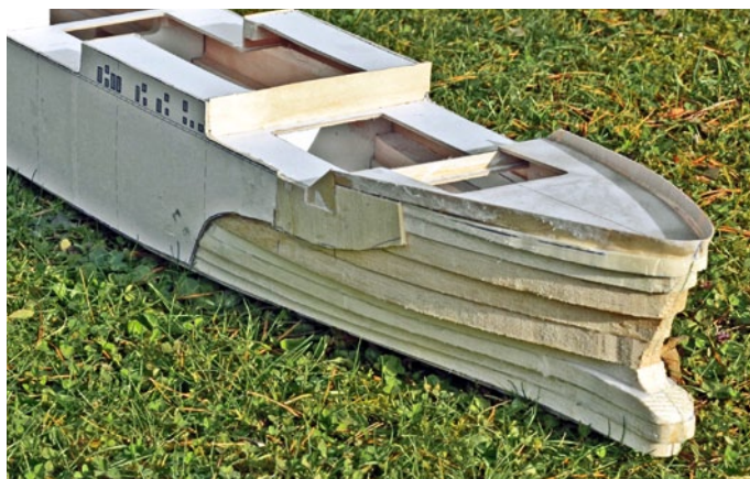
Besonders am Bug wird die Schichtbauweise offensichtlich. Bei dieser Schiffsform führt sie am schnellsten zum fertigen Rumpf
