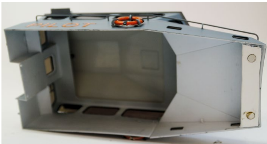
Die Magnete halten den vorderen Bereich des Aufbaus
