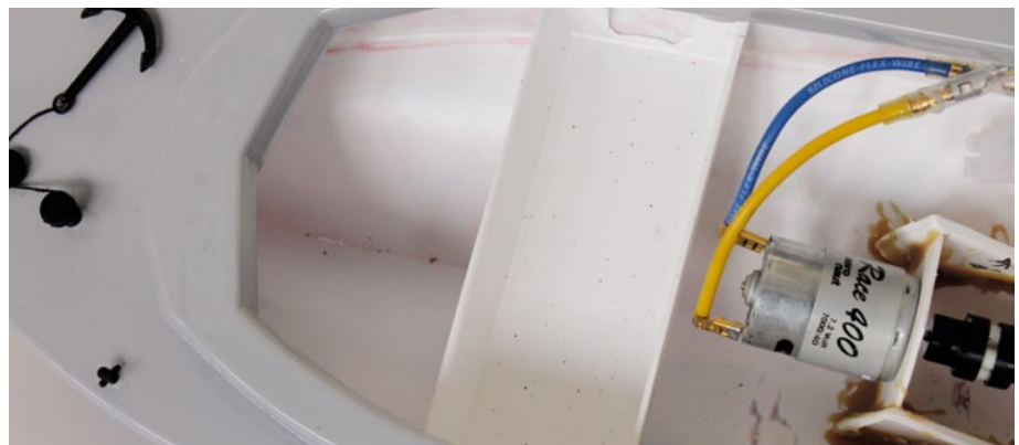
Bei der Akkuhalterung sollte man darauf achten, diese nicht zu weit vorne zu platzieren. Ansonsten passen handelsübliche NiMH-Packs nicht mehr hinein
