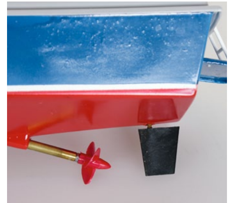
Stevenrohr mit Welle und Schraube gehören ebenso zum Lieferumfang wie das Ruder
