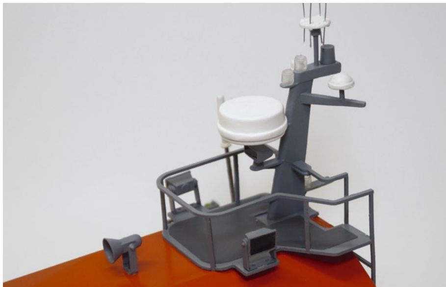
Die Kontur der Mastplattform stammt ebenfalls aus dem Schneideplotter
