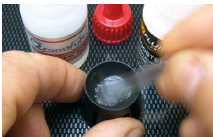
Die Mischung sollte eher dünnflüssig wirken. Nach etwa zwei bis drei Minuten beginnt der Gelierprozess
