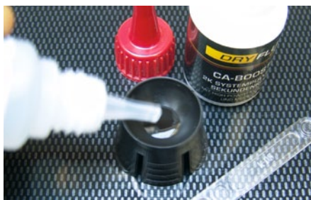
Zuerst die benötigte Menge Sekundenkleber in den Mischbehälter geben
