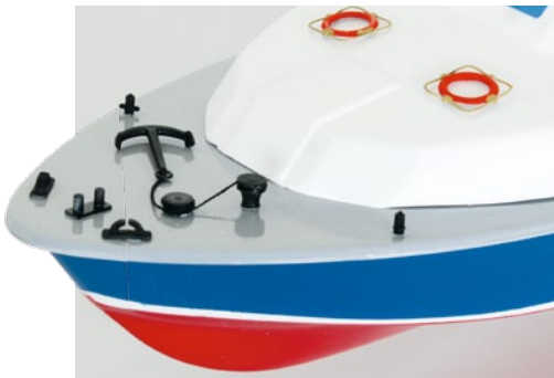
Auf dem Vorschiff haben Anker und Windenkonstruktion sowie Poller Platz genommen. Diese Teile wurden in Schwarz lackiert
