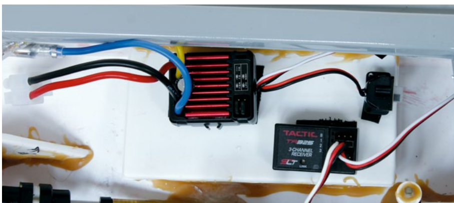
Auf der Plattform für den Regler haben ein Quicrun-Controller sowie ein 2,4-Gigahertz-Empfänger von Tactic Platz genommen
