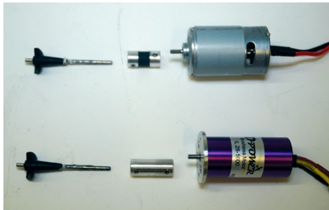
Oben: der Original-Motor. Unten: der Austauschmotor mit höherer Drehzahl und Geschwindigkeit
