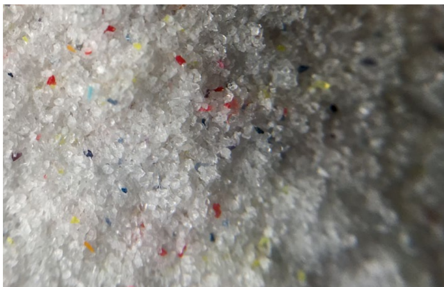
Die Makroaufnahme verdeutlicht, dass es sich bei CA-Booster nicht um Kugeln handelt. Laut Hersteller sind es Polymer-Kunststoffe und Glasfasern, die hervorragend mit Cyanacrylat harmonieren und Brücken bauen können
