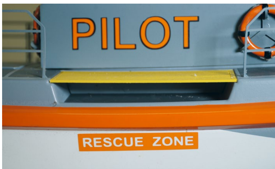
Für den Schriftzug kommt orangene und schwarze Folie zum Einsatz. Die orange Ebene ist minimal kleiner und wird auf die schwarze geklebt – das wertet die Schrift auf
