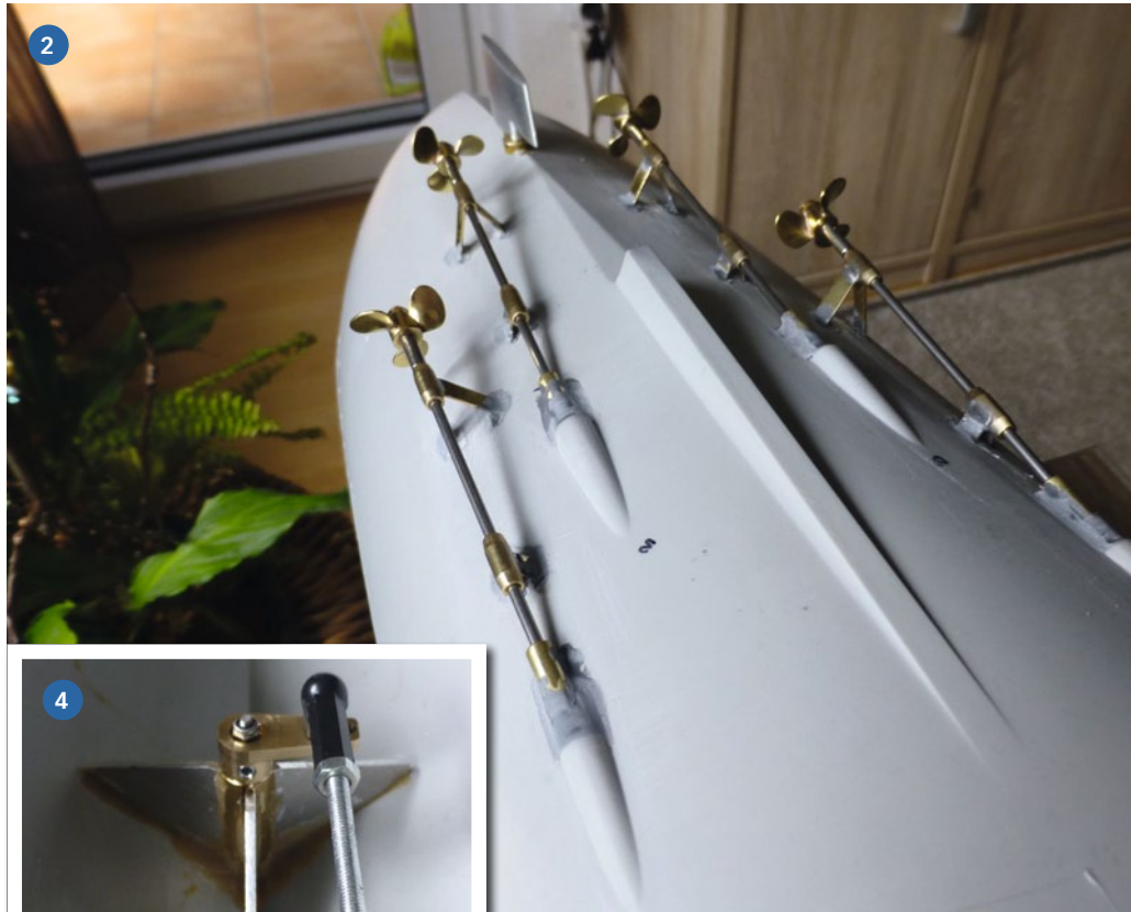
1) Konfektionierte Wellenanlage: Hinter den Kugellagern befinden sich die O-Ringe zur Abdichtung. 2) Die Verklebung der Wellenstützen erfolgt noch vor dem Schleifen. 3) Prinzipskizze des vergrößerten Ruderblatts 4) Sichere Lagerung des Ruderkokers im Schiffsrumpf
