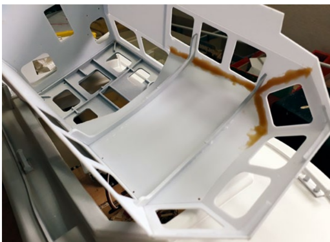
Die sich ergebenden Nuten durch die „gefaltete“ Bauweise werden der Stabilität wegen mit Stabilit Express versteift
