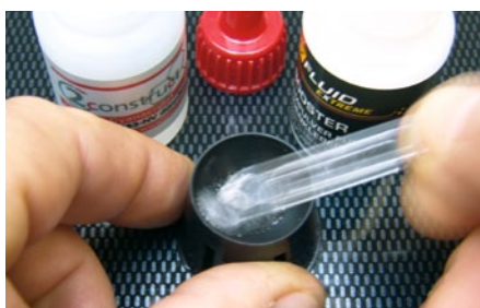
Nun das Klebstoffgel zügig mit dem Rührstäbchen auf die saubere und fettfreie Klebestelle auftragen. Bereits nach etwa fünf Minuten beginnt – je nach Viskosität des Sekundenklebers – der Aushärteprozess
