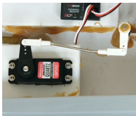
Für die Lenkung ist ein stellstarkes Digital-Servo aus dem Sortiment von Ripmax verbaut
