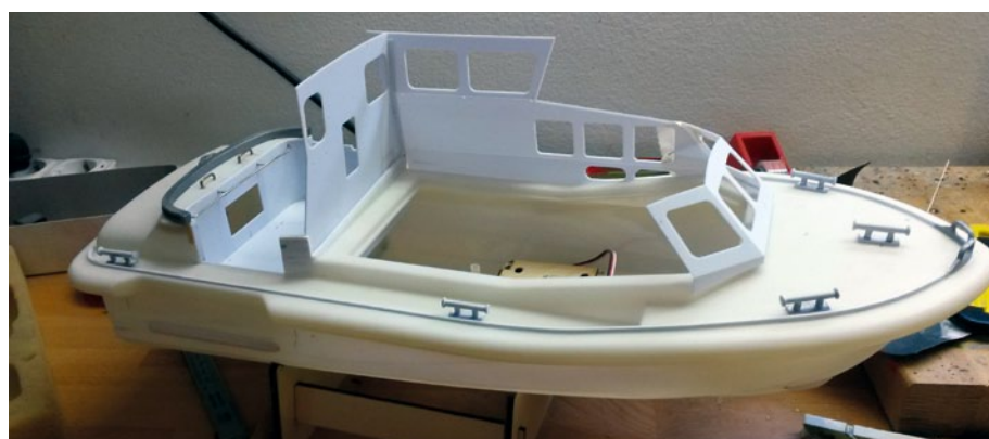
Mit dem Aufbau sollte man erst nach Fertigstellung der Plicht beginnen, da diese bestimmte Anpassungen vorgibt
