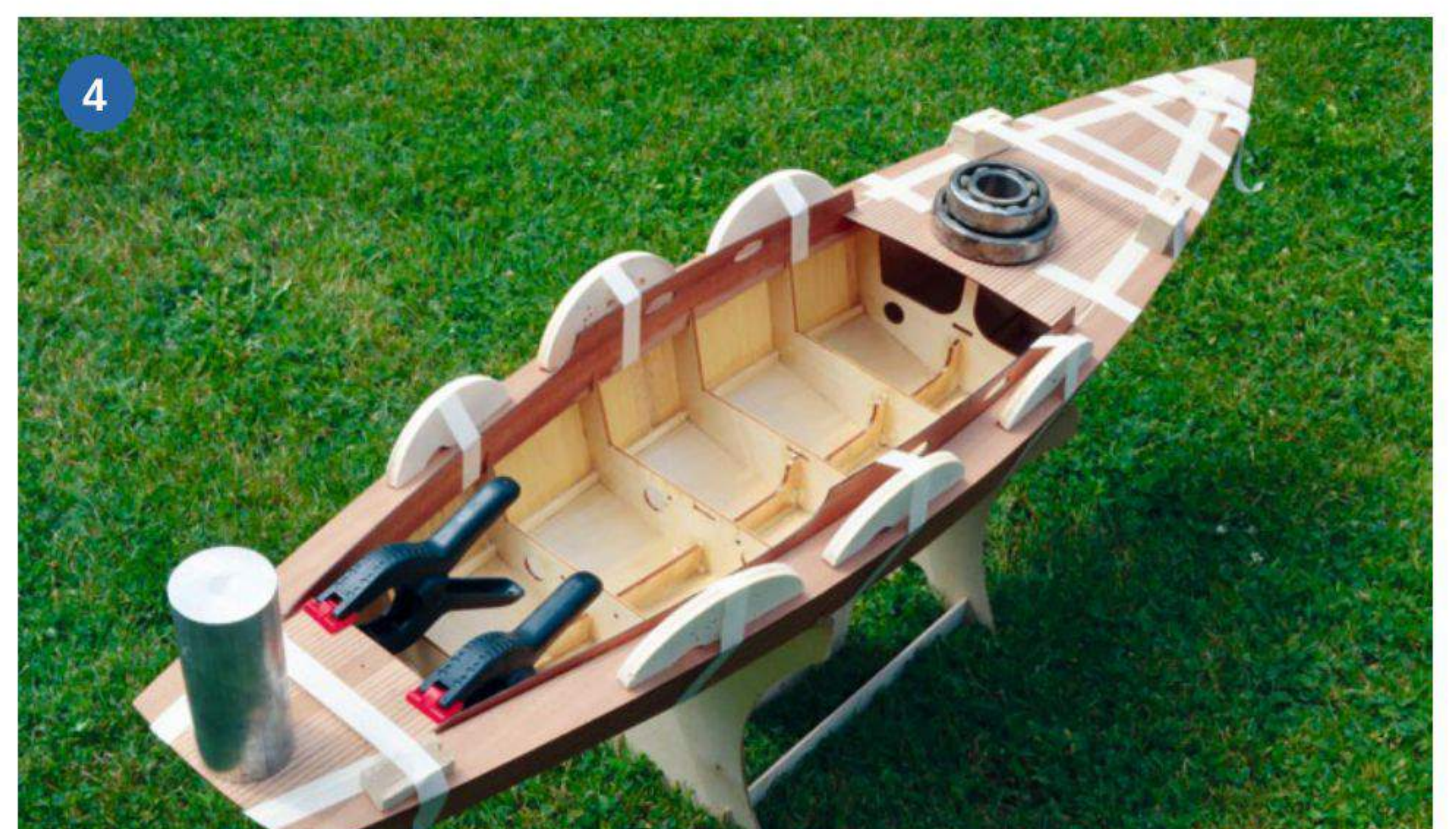
1) Ein äußerst stabiler und schicker Rumpf ist entstanden. 2) Die zusätzlich eingebrachten Längsgurte bestehen aus zweifach verleimten Balsaleisten. 3) Die Kajütwände werden eingesetzt und mit den Stringern aus Kiefernleisten verklebt. 4) Um das Deck fest mit dem Rumpf verkleben zu können, sind einige Hilfsmittel nötig
