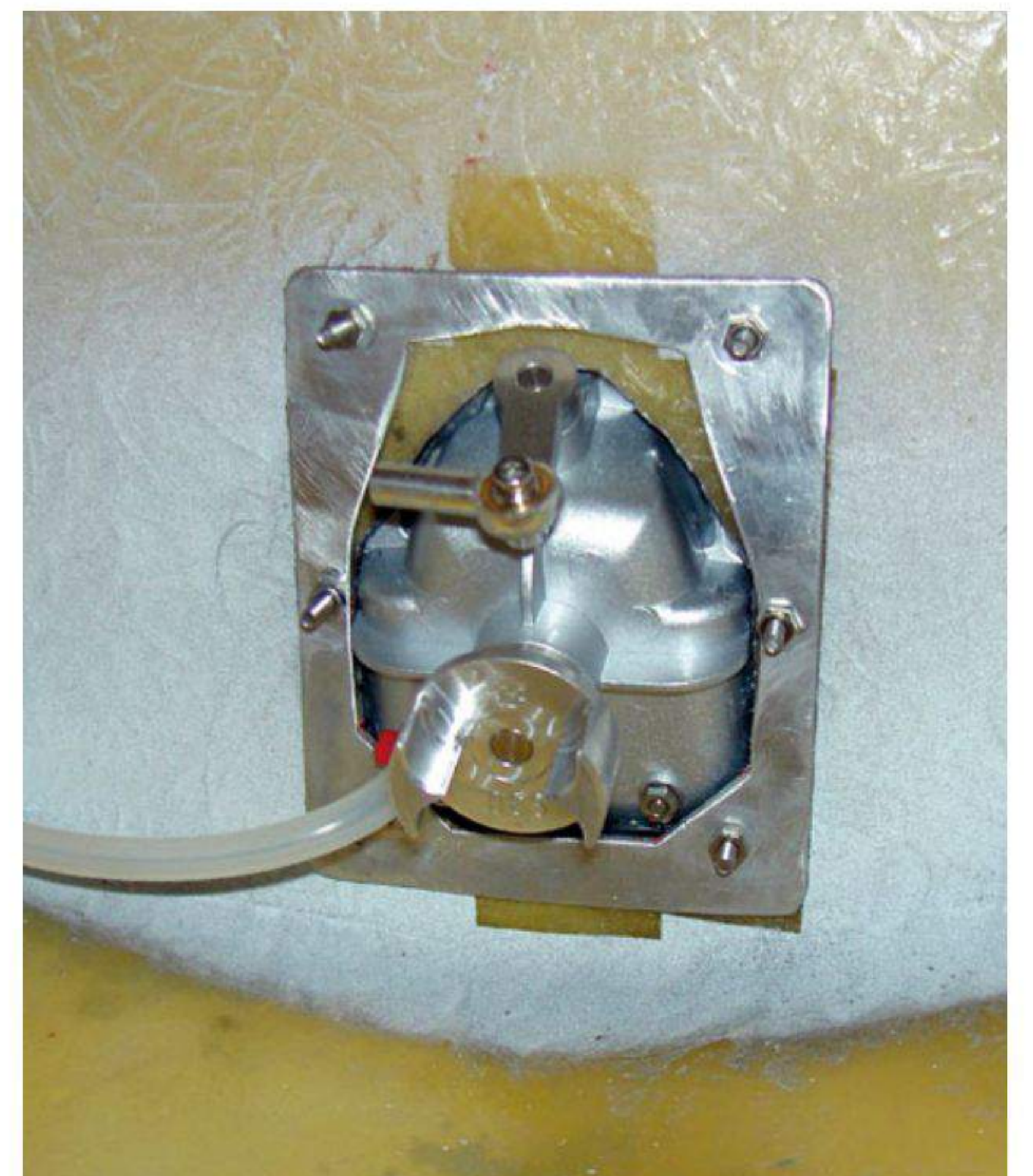
Probeweises Anpassen: Z-Antrieb von innen mit Konterflansch und Klauenkupplung
