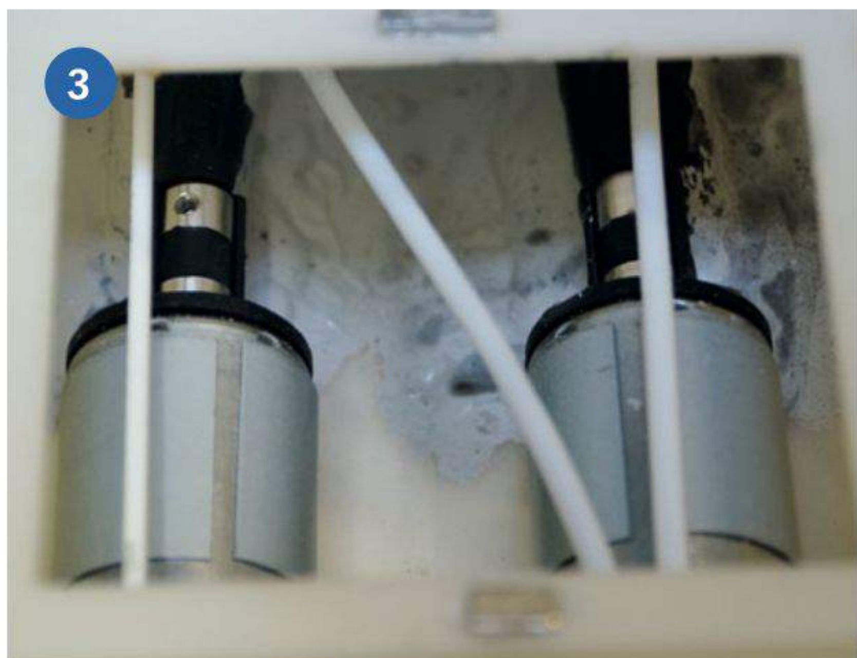
1) Die Handläufe bestehen aus einem Stück und passen exakt an vorgegebener Stelle. 2) Alle Fenster sind von hinten mit einem Plastikkleber fixiert. 3) Ein wenig Geduld erfordert der Einbau der beiden Jetantriebe, die im Betrieb für sehr gute Fahrleistungen sorgen. 4) Auf einem Brett fixierte Beschlagteile lassen sich so optimal lackieren
