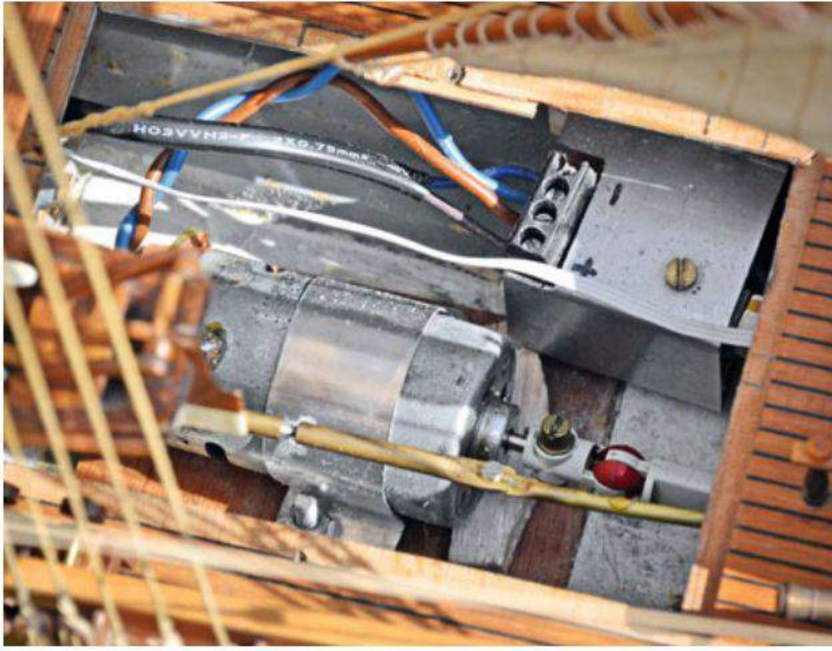
Im Rumpf wurde ein kraftvoller 5-Pol-Motor verbaut
