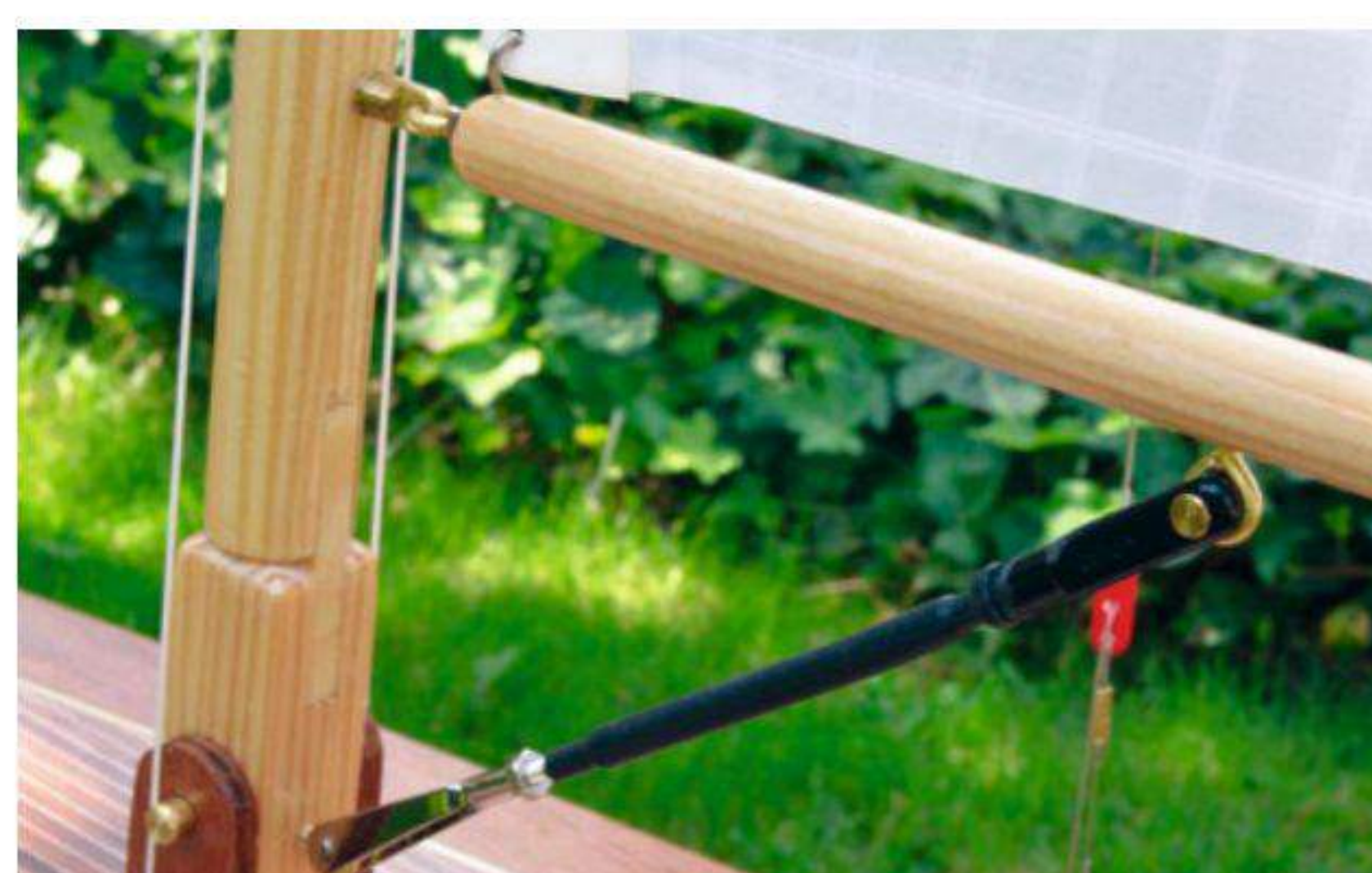
Das abgeänderte Baumlager und der starre Baumniederholer
