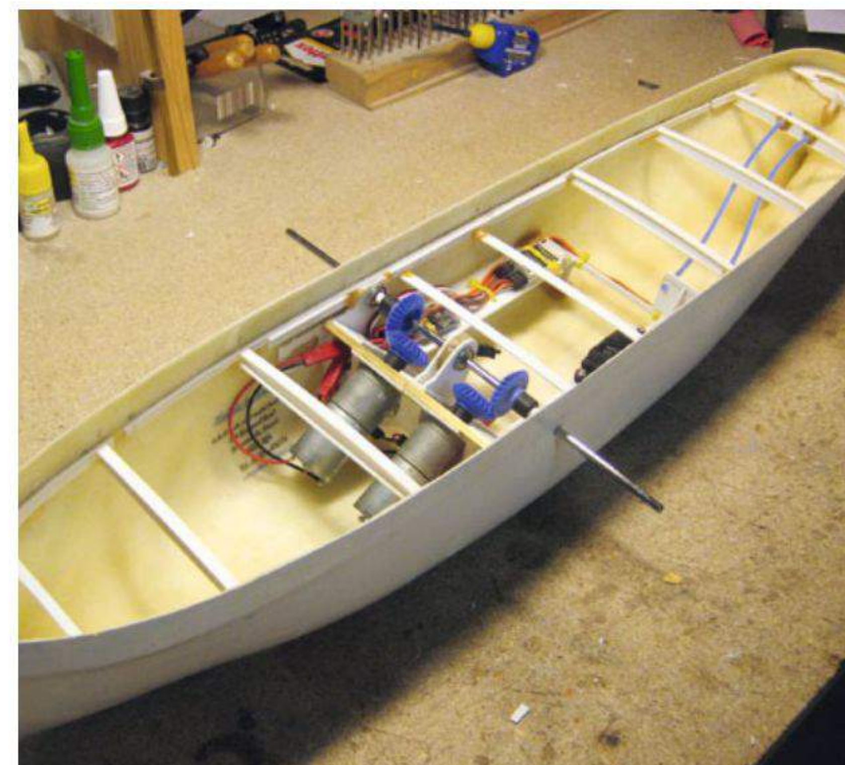
Das Technikgerüst fertig eingebaut im GFK-Rumpf mit herausragenden Antriebswellen
