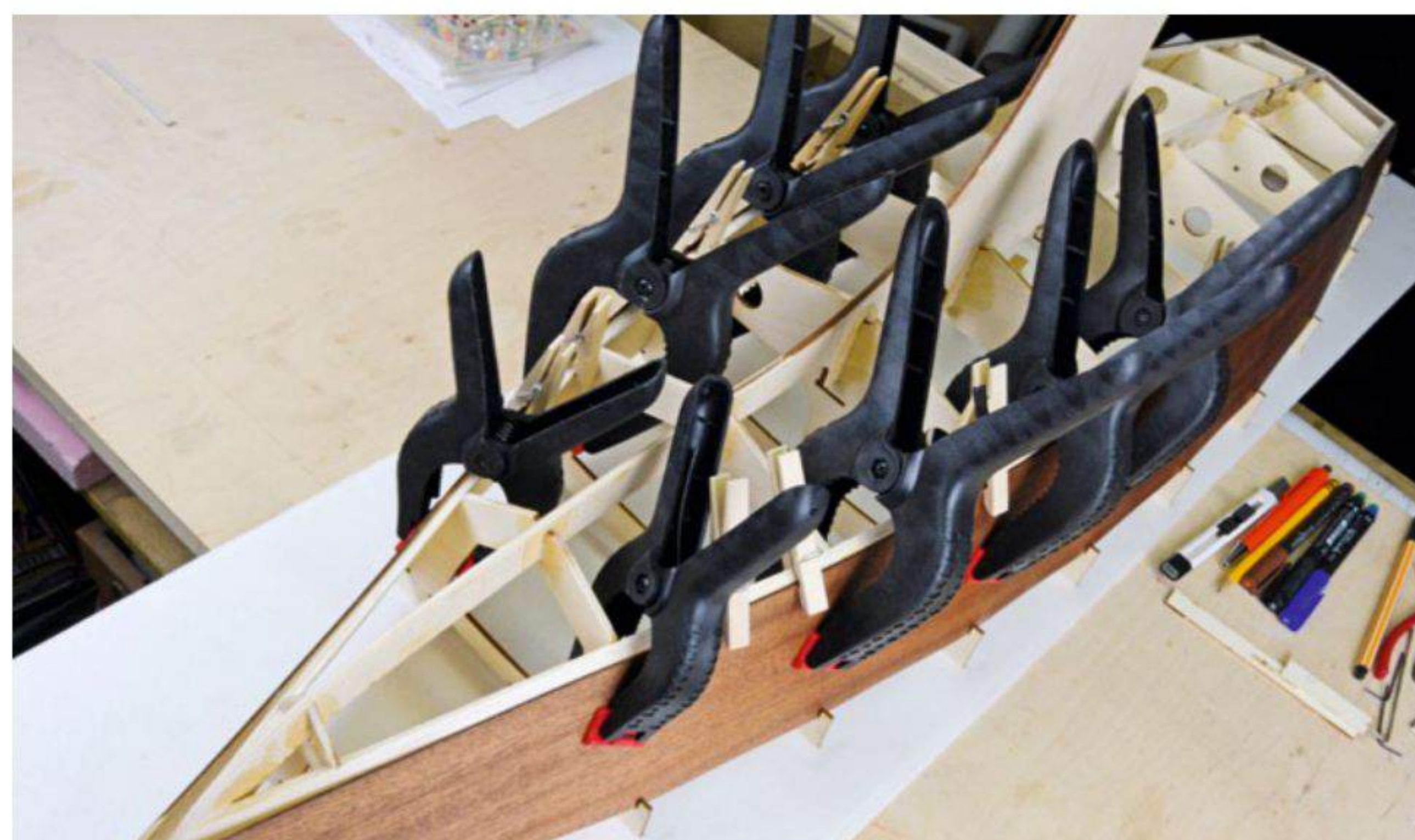
Die Rumpfteile mit Mahagonioberfläche werden angepasst
