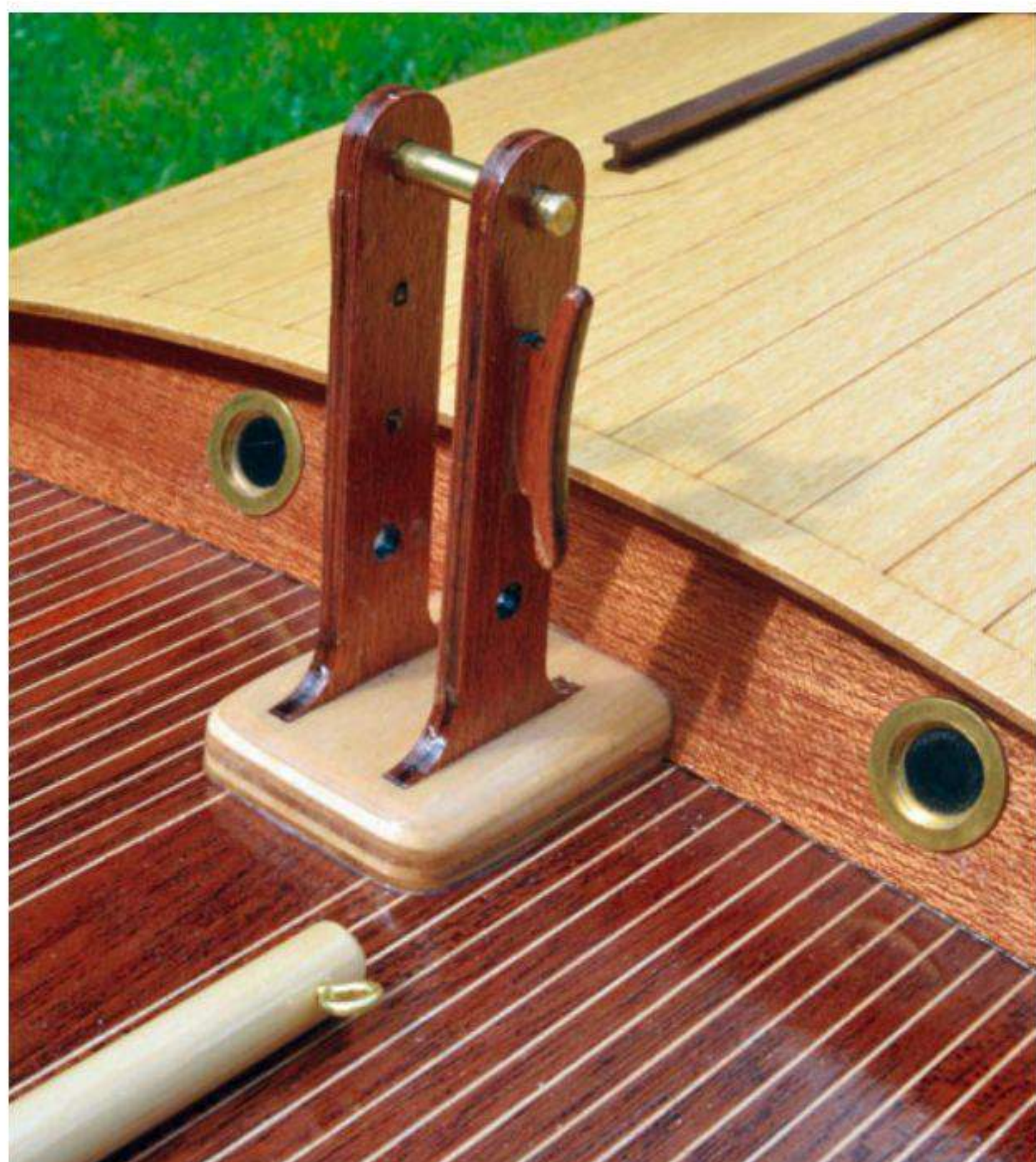
Die Mastbacken samt Belegklampen sind fest mit dem Maststuhl verklebt
