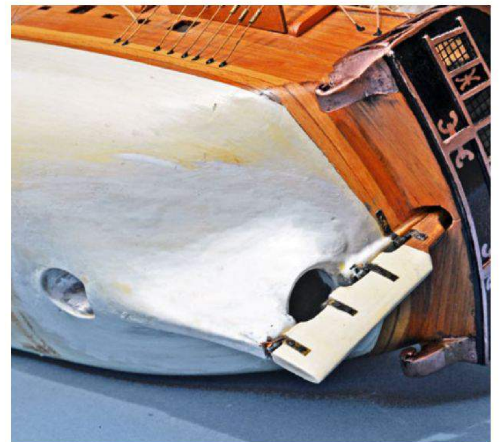
Der Jet saugt das Wasser von unten an und stößt es vor dem Ruder wieder aus
