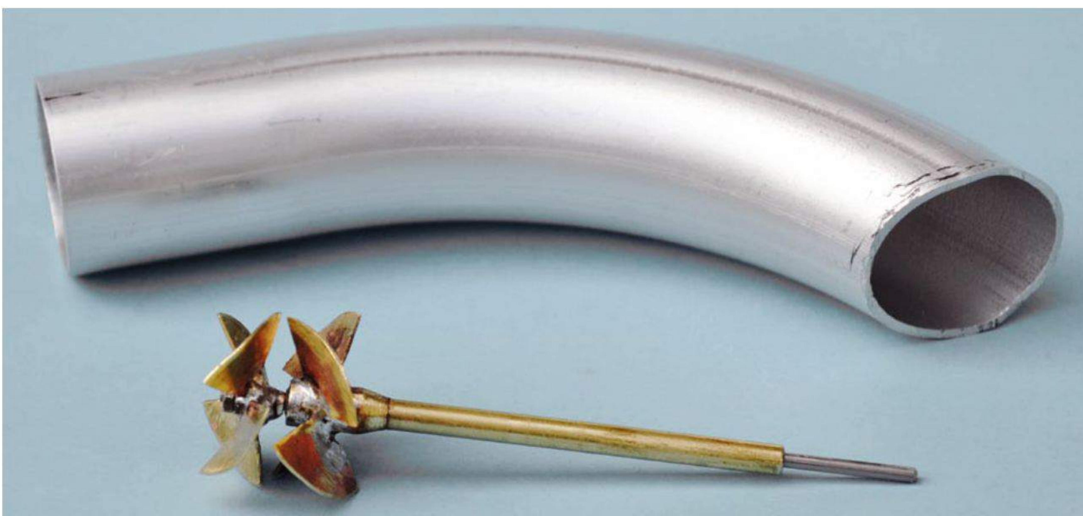
Die Einzelteile des Flautenschiebers. Hauptbauteil sind der 90-Grad-Alu-Krümmers und das Stevenrohr mit selbstgebaute Stator sowie Propeller
