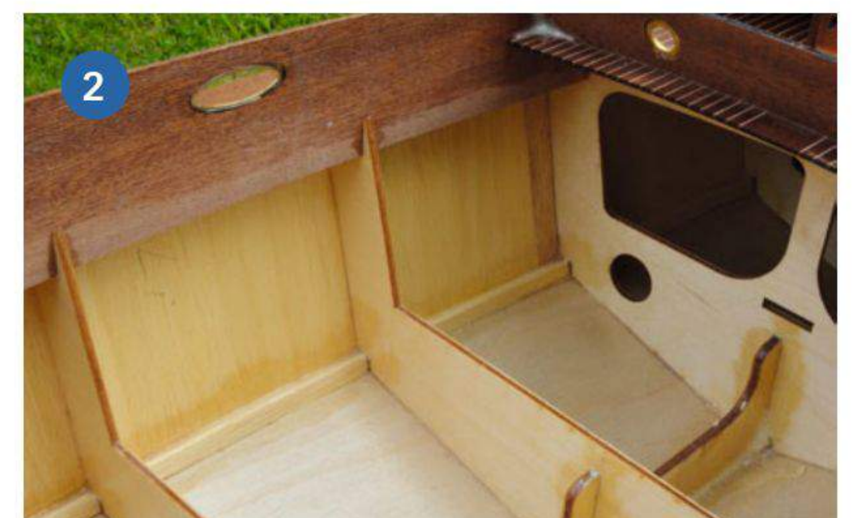
1) Ein äußerst stabiler und schicker Rumpf ist entstanden. 2) Die zusätzlich eingebrachten Längsgurte bestehen aus zweifach verleimten Balsaleisten. 3) Die Kajütwände werden eingesetzt und mit den Stringern aus Kiefernleisten verklebt. 4) Um das Deck fest mit dem Rumpf verkleben zu können, sind einige Hilfsmittel nötig
