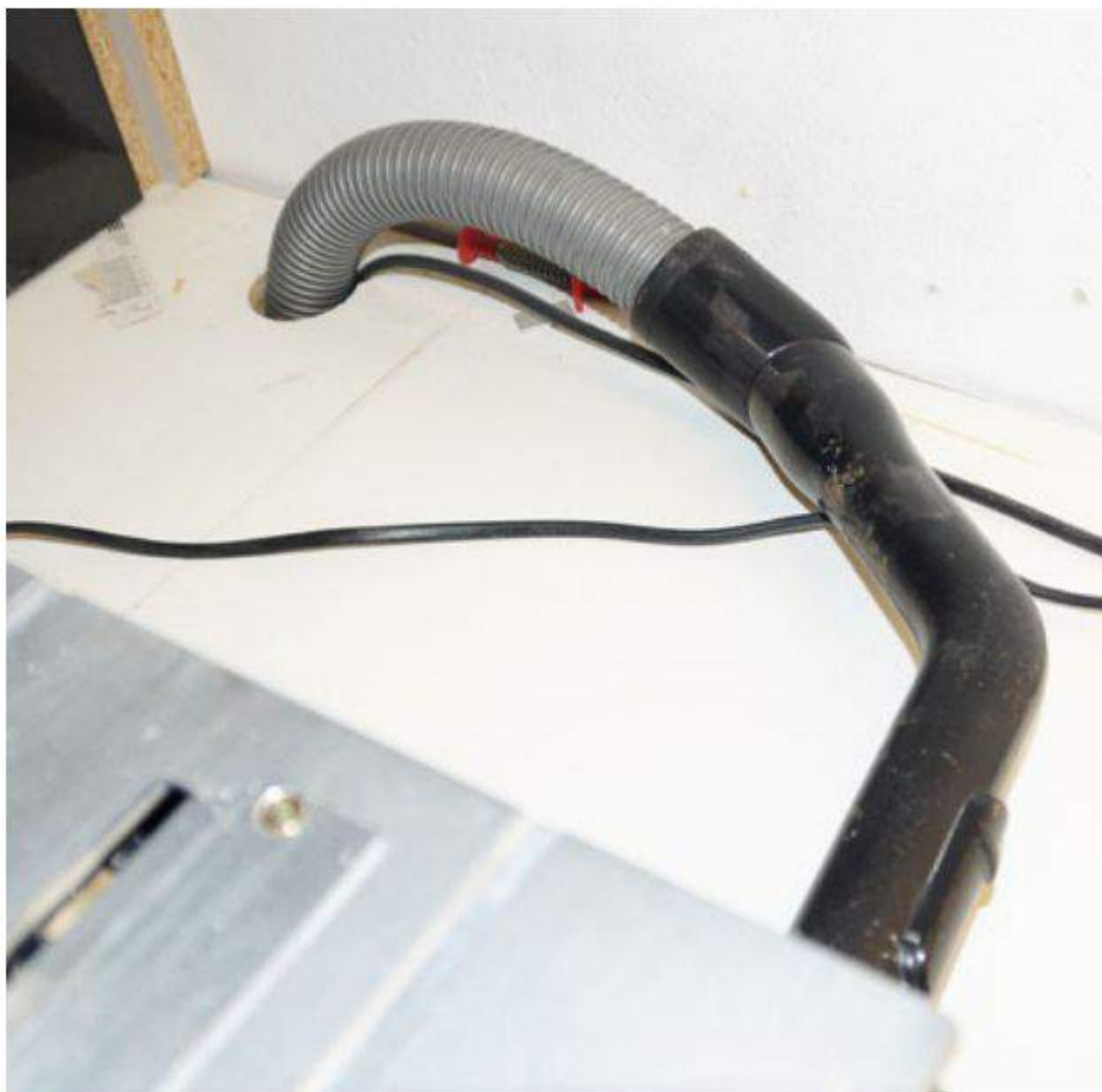
Der Schlauch zur Absaugung führt nach hinten und liegt so vorne nicht im Weg
