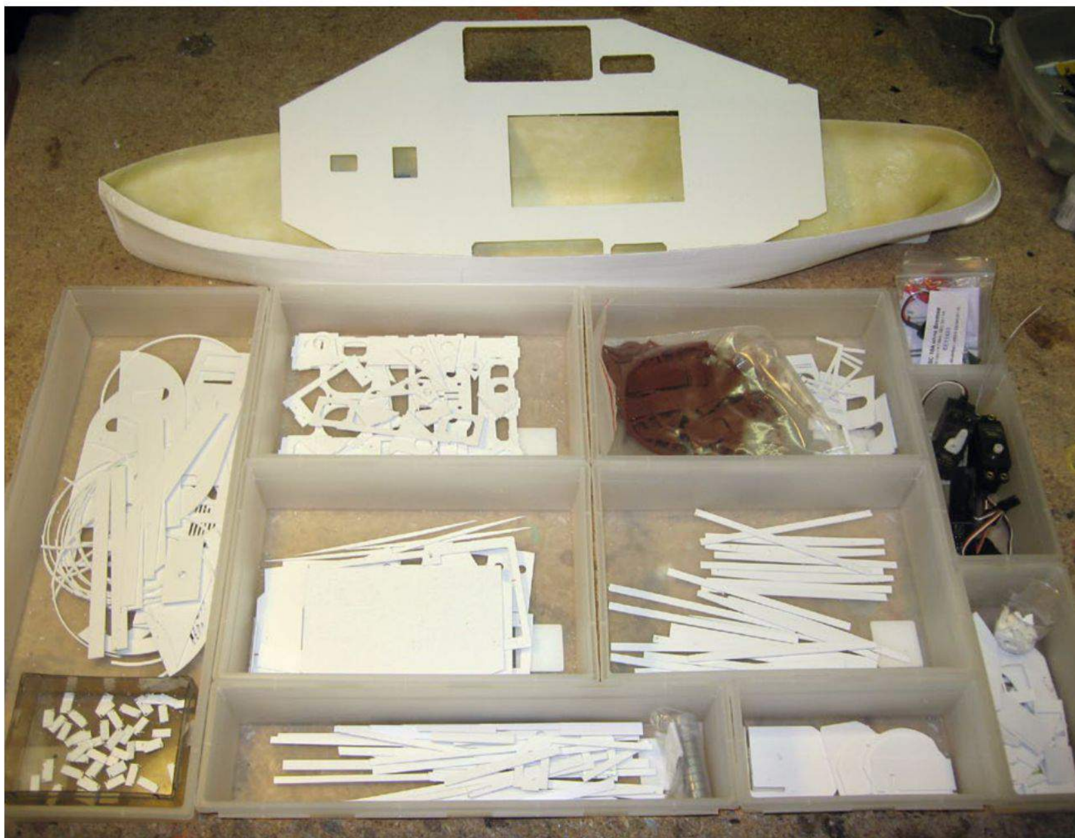
Die bei Häger Modellbau bestellten Frästeile sowie selbst hergestellte Polystyrol-Profile liegen sortiert bereit
