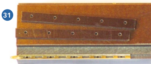
29) Man fräst (oder auch dreht) möglichst viel in einer Einspannung 30) Koordinaten-Bohren auch hier, wegen exakter Abstände 31) Unten liegt eine Wange auf dem Vorrichtung-Rohling
