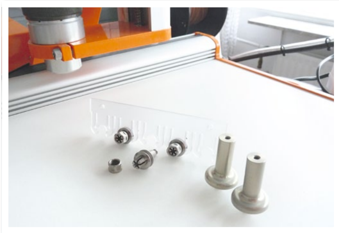
Die Wechselstation mit (je nach Software) bis zu 20 Werkzeugen sollten in der hinteren rechten Ecke der Maschine platziert werden, da sie dort am wenigsten stört. Zum Lieferumfang gehört eine Halterung für fünf Adapter, wobei zwei davon ebenfalls zum Set gehören (im 1/8-Zoll-Format)
