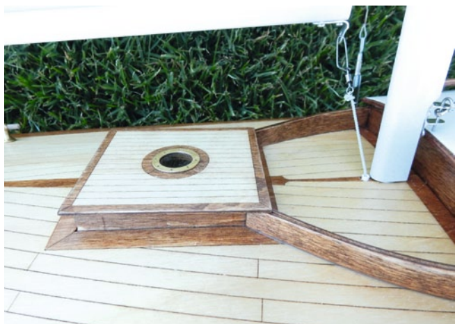
Die Luke auf dem Vordeck lässt sich für Kontrollzwecke öffnen
