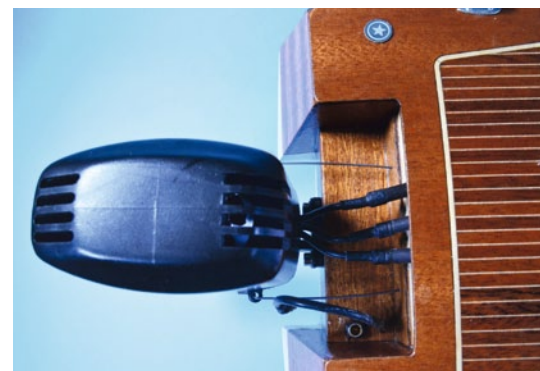
Neben dem Motor befindet sich am Heck der Not-aus-Stecker
