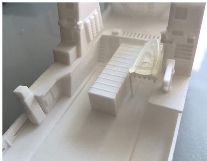
1) Montage des Beiboothalters mittels einer Steckverbindung. Auch so etwas kann digital ausprobiert werden, bevor das Modell gedruckt wird 2) Hier der fertig installierte Beiboothalter auf dem rohen gedruckten Deck
