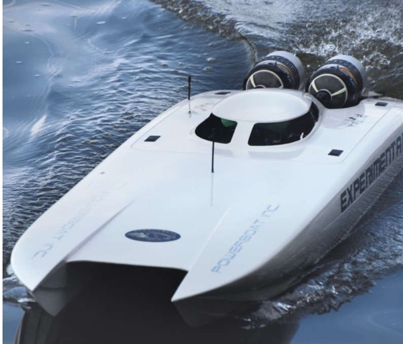
Die EXPERIMENTAL MYSTIC von Dr. Matthias Gneuß wird direkt über zwei Strahltriebwerke angetrieben. Besonders die Geräuschkulisse dieses Modells ist atemberaubend
