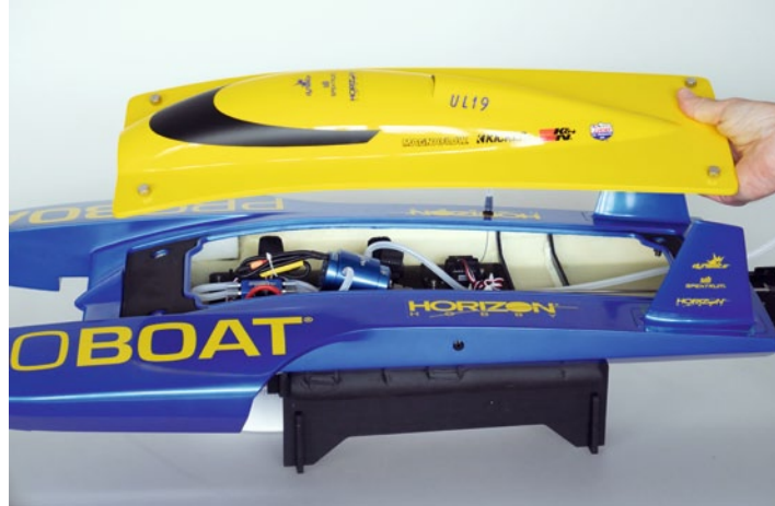
Mit vier Rändelschrauben lässt sich der große GFK-Deckel auf dem Rumpf befestigen
