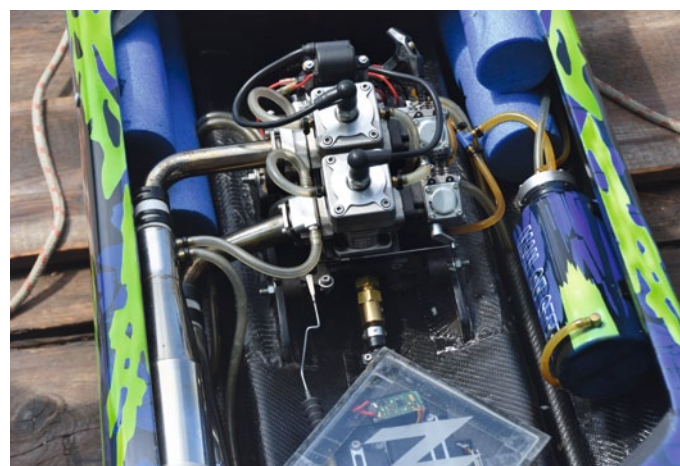
SKATER mit einem gekoppelten RCMK-Motor. Wenn man genauer hinschaut, so ist sogar der Treibstofftank im Bootsdesign lackiert
