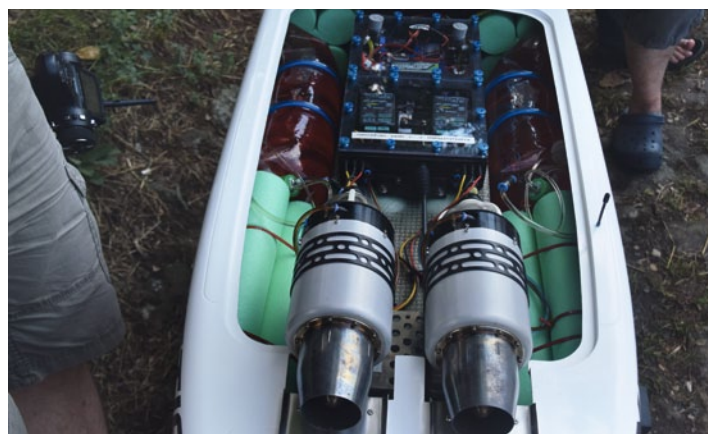
Zwei große Kraftstofftanks, eine RC-Box und viele Auftriebskörper für den Ernstfall. Ansonsten ist in der EXPERIMENTAL MYSTIC nicht viel mehr vorhanden
