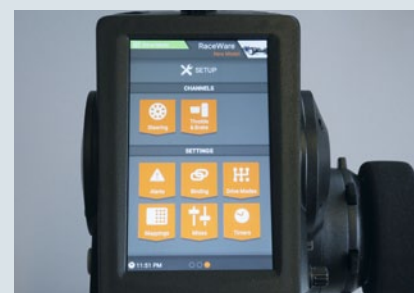
Farbdisplay, Touchscreen, Android-basiertes Betriebssystem und eine sehr umfangreiche Race-Ware sind in der DX6R implementiert
