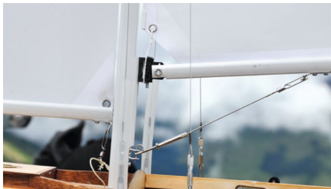
Der Baumniederholer stammt nicht aus dem Baukasten. Mast und Bäume sind weiß lackiert, was sehr edel wirkt
