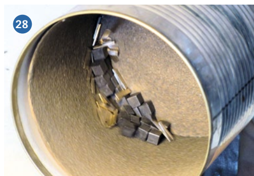
27) Exakter kann man die Teile anders nicht fertigen 28) Schon jahrelang im Gebrauch: meine Entgratungs-Trommel. Die Büchse hängt mit dem Boden an einem kleinen Getriebemotor
