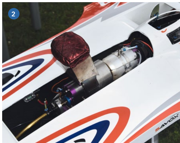
1) Bei Powerbooten aus der Elektrofraktion wirkt es im Rumpfinnen richtig leer und aufgeräumt 2) Damit in den Abgaskamin keine Fremdkörper gelangen, ist dieser abgedeckt
