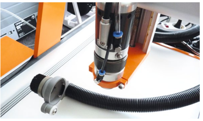
Einige Zusatzgeräte, wie die Staubabsaugung, lassen sich zusammen mit dem WZW nicht mehr unbedingt einsetzen, da die Wechselfunktion dadurch gestört wäre
