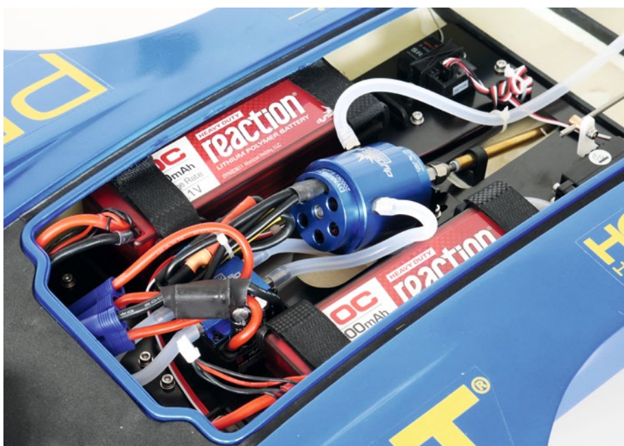
Für beide 3s-LiPos ist eine EC5-Steckverbindung zum Regler vorgefertigt
