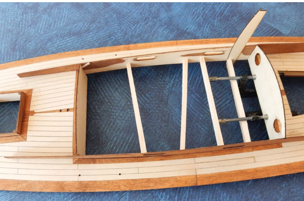
Die Kajütseitenwand wird zum Verkleben mit Spreizhölzern in Position gehalten
