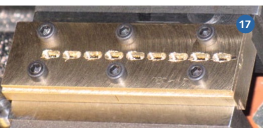
Eine Alternative wäre, die U-Schienen zu fräsen
