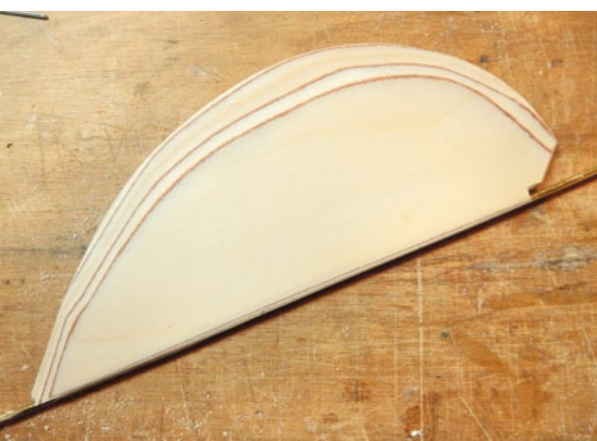
Das Ruderblatt wird aus dem Vollen geschliffen
