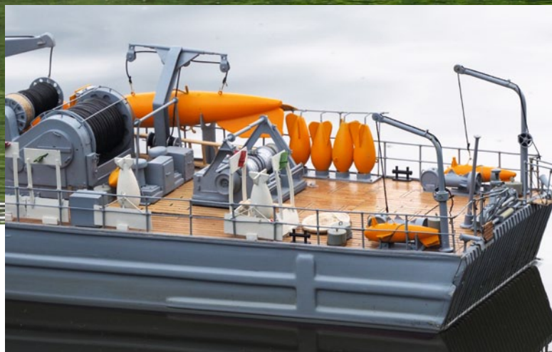
Back des Räumboots MARS aus der WEGA-Klasse mit den typischen Ausrüstungsgegenständen zur Kampfmittelräumung
