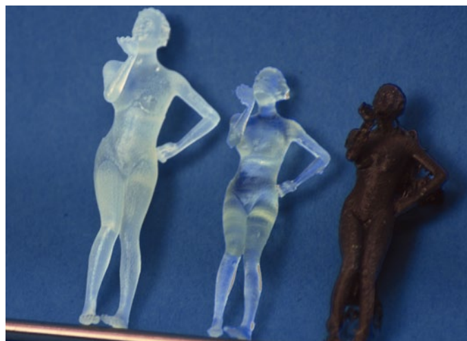
Vergleich der beiden in Auftrag gegebenen Figuren Frosted Ultra Detail von shapeways (links) und Clear Acrylic Resin von creabis (mitte) mit der selbst gedruckten PLA-Figur
