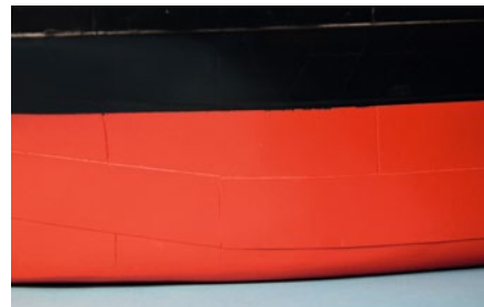
Die Plattengänge an der Rumpfaußenhaut
