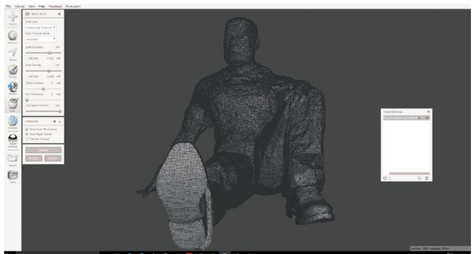
Sind wirklich hunderte Dreiecke nur für die Schuhsohle notwendig? Reduzieren hilft beim späteren Druck
