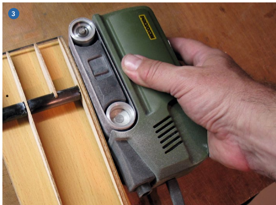
1) Das Wechseln von Schleifbänder gelingt aufgrund des Federspannmechanismus einfach und schnell. 2) Den Anpressblock (schwarz) sollte man im Betrieb regelmäßig reinigen, um Riffenbildung vorzubeugen. 3) Der BBS/E liegt sehr gut in der Hand und lässt sich flüssig übers Material führen. Um nicht zu viel Material abzutragen, ist wenig Anpressdruck ratsam
