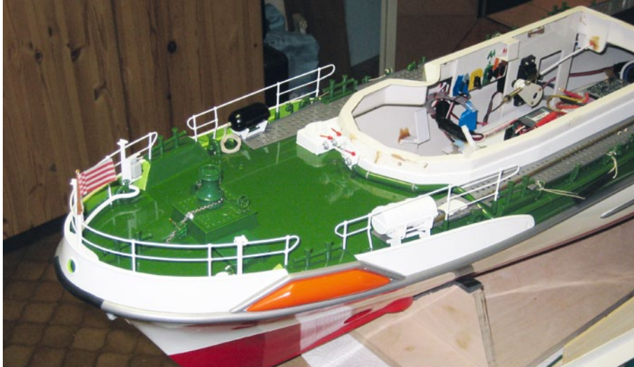
Basis für die orangenen Fender war ein Balsastück, das nach dem Zuschleifen abgeformt und abgegossen wurde
