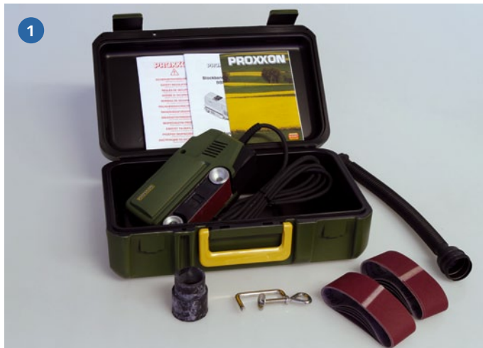
1) Im praktischen Hartschalenkoffer zum Blockbandschleifer lässt sich auch Zubehör gut unterbringen. 2) Praktisch ist der mitgelieferte Staubsaugeranschluss. Da dieser im Handbetrieb gerne abrutscht, ist er allerdings mehr für den stationären Einsatz geeignet
