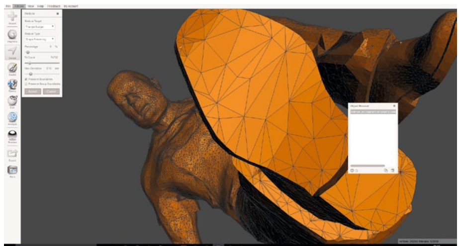
So sieht die Figur nach der Reduzierung der Polygone aus
