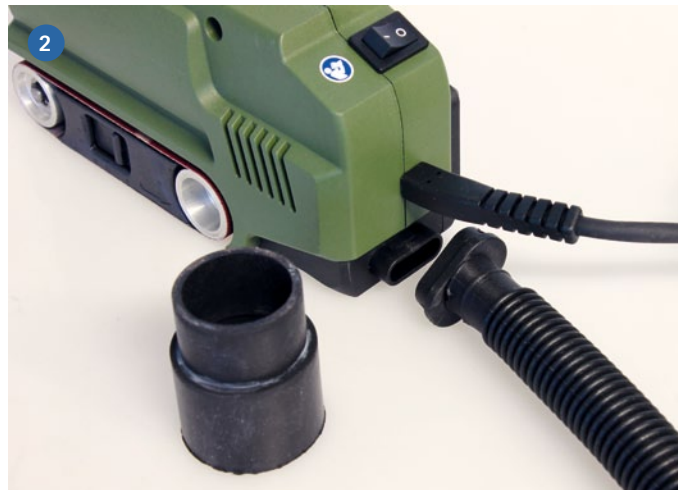
1) Im praktischen Hartschalenkoffer zum Blockbandschleifer lässt sich auch Zubehör gut unterbringen. 2) Praktisch ist der mitgelieferte Staubsaugeranschluss. Da dieser im Handbetrieb gerne abrutscht, ist er allerdings mehr für den stationären Einsatz geeignet
