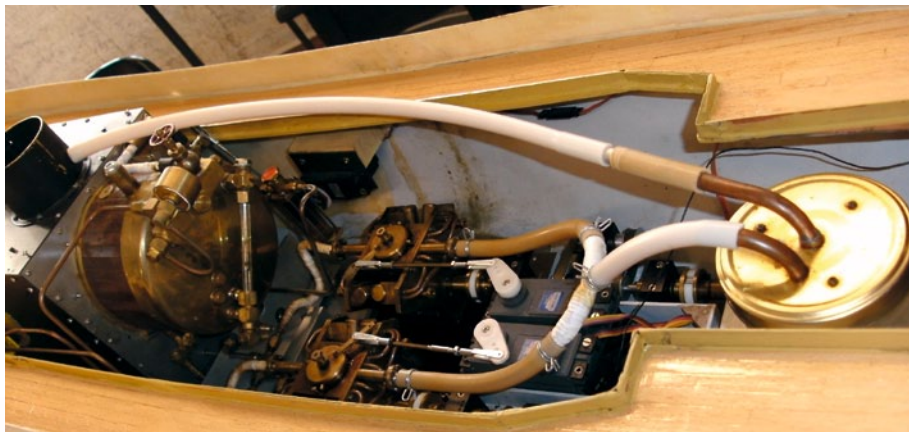
Silikonschläuche leiten den Abdampf zum Kondensator
