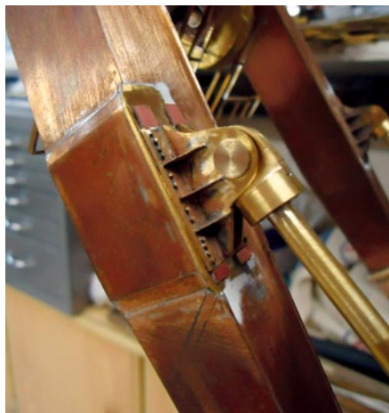
Messing wiederum ist das Material der Wahl, wenn es um die Umsetzung von Befestigungspunkten oder Rollen, wie hier beim A-Frame, geht
