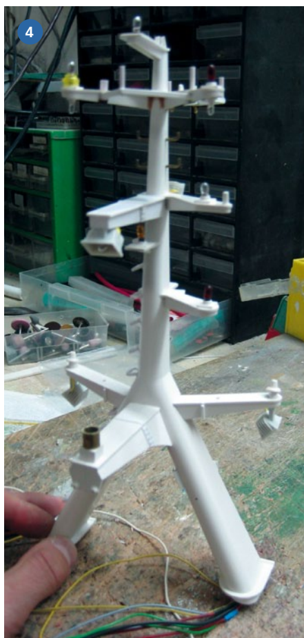
1) Fotos vom Original halfen bei einer möglichst vorbildgetreuen Ausrüstung wie hier am Ankerspill. 2+3) Größere Umbauten am Aufbau bezogen sich auf eine Reihe Einzelteile wie den Scheiben, Halterungen, Fenstern, Luken, Klappen, Handläufe und mehr. Vom Original übernommene Maße halfen bei der vorbildgetreuen Umsetzung. 4) Von Umbauten blieb auch der Mast nicht verschont. So stammen einige Leuchtkörper beispielsweise aus dem Lego-Sortiment. 5) Ohne Fotos vom Vorbild wäre beispielsweise der Bau von einzelnen Details wie den Wandverstärkungen gar nicht möglich gewesen
