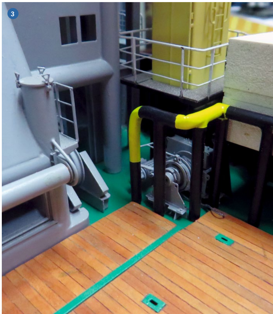
1) Aus 7 Millimeter dicken Messingrohren entstand das Grundgerüst des Kruzifix 2+3) Eine Fülle an Arbeitswinden findet sich auf dem Schiff, so wie hier eine Tuggerwinde, die man schon suchen muss
