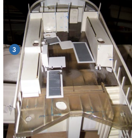
1) Fotos vom Original halfen bei einer möglichst vorbildgetreuen Ausrüstung wie hier am Ankerspill. 2+3) Größere Umbauten am Aufbau bezogen sich auf eine Reihe Einzelteile wie den Scheiben, Halterungen, Fenstern, Luken, Klappen, Handläufe und mehr. Vom Original übernommene Maße halfen bei der vorbildgetreuen Umsetzung. 4) Von Umbauten blieb auch der Mast nicht verschont. So stammen einige Leuchtkörper beispielsweise aus dem Lego-Sortiment. 5) Ohne Fotos vom Vorbild wäre beispielsweise der Bau von einzelnen Details wie den Wandverstärkungen gar nicht möglich gewesen
