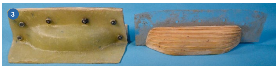
1) Links und rechts vom Hauptmast auf dem Vordeck sind zwei wichtige Zugänge zum Schiffsinneren verborgen. 2) Die Schiffsmitte mit dem Deckshaus und der Brücke. 3) Teilbare Form und Urmodell der Rettungsboote
