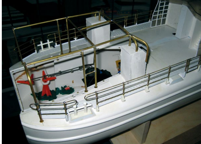
Aufgrund der Wannenform sind die Ruderanlenkungen im Heck gar nicht so tiefgehend eingebaut
