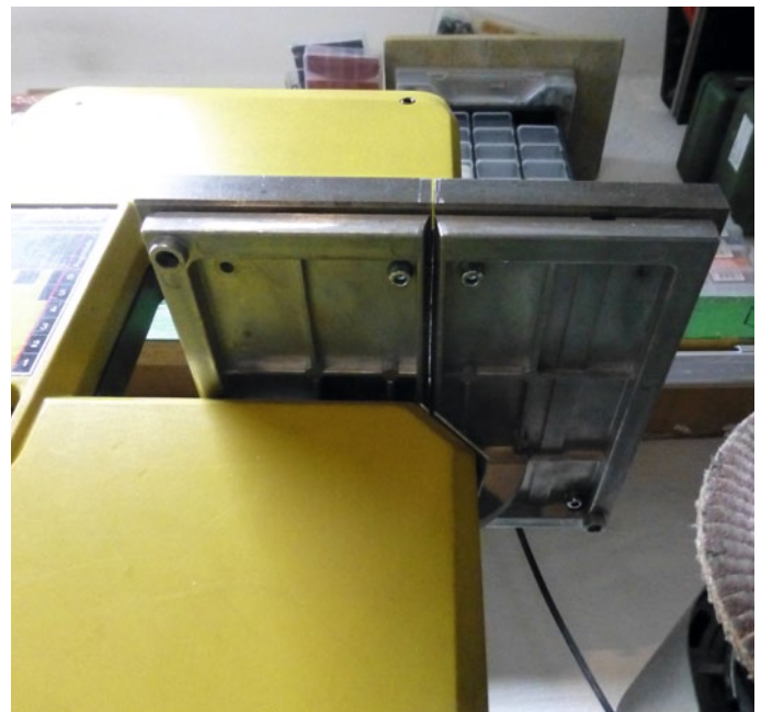
Schrauben fixieren die Platte. Die Maßnahme reduziert die Geräuscentwicklung
