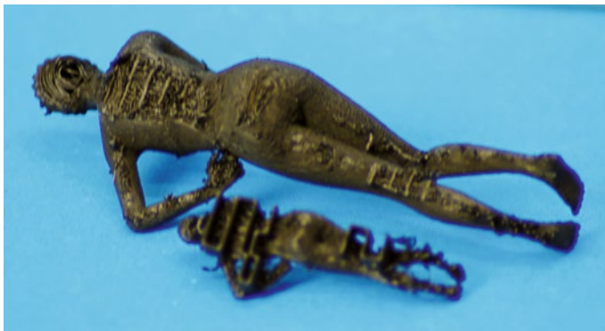
Die Auflagefläche der gedruckten Figuren – hier ist im Nachgang noch einiges an Schleifarbeit fällig
