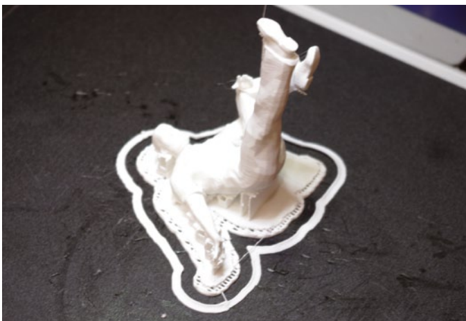
Druck in weißem PLA mit Raft (Fundament) auf BuildTak, einer Art Dauerfolie auf dem Druckbett
