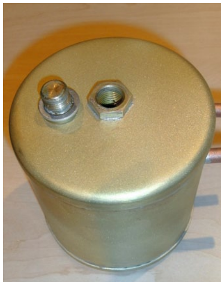
Der zunächst verbaute Test-Glaskondensator wurde durch diesen großvolumigen Kondensatbehälter ersetzt
