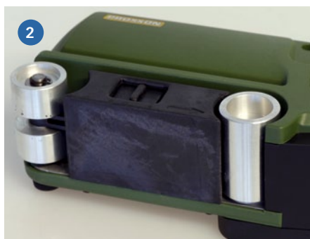
1) Das Wechseln von Schleifbänder gelingt aufgrund des Federspannmechanismus einfach und schnell. 2) Den Anpressblock (schwarz) sollte man im Betrieb regelmäßig reinigen, um Riffenbildung vorzubeugen. 3) Der BBS/E liegt sehr gut in der Hand und lässt sich flüssig übers Material führen. Um nicht zu viel Material abzutragen, ist wenig Anpressdruck ratsam
