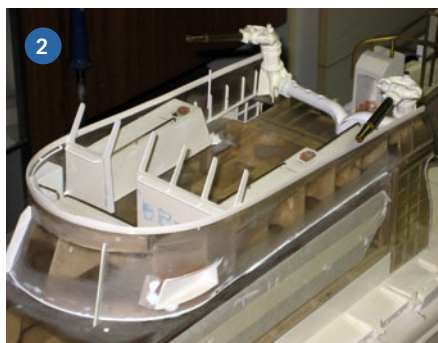
1) Fotos vom Original halfen bei einer möglichst vorbildgetreuen Ausrüstung wie hier am Ankerspill. 2+3) Größere Umbauten am Aufbau bezogen sich auf eine Reihe Einzelteile wie den Scheiben, Halterungen, Fenstern, Luken, Klappen, Handläufe und mehr. Vom Original übernommene Maße halfen bei der vorbildgetreuen Umsetzung. 4) Von Umbauten blieb auch der Mast nicht verschont. So stammen einige Leuchtkörper beispielsweise aus dem Lego-Sortiment. 5) Ohne Fotos vom Vorbild wäre beispielsweise der Bau von einzelnen Details wie den Wandverstärkungen gar nicht möglich gewesen
