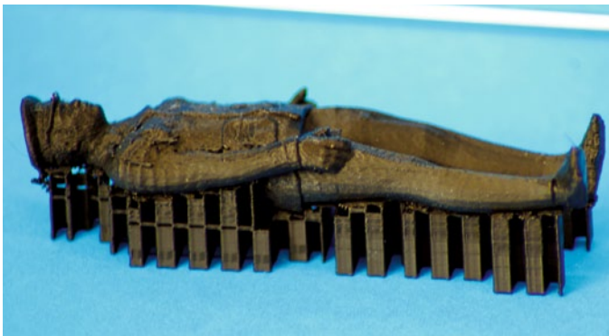
Wie ein Bett aus Stützstrukturen aussehen kann, demonstriert diese Abbildung. Hier wurde eine sehr gute Druckqualität erzielt
