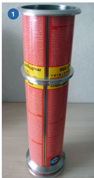
1) Der Kamin entstand aus leeren Gaskartuschen, die mit Alu-Teilen ergänzt wurden. 2) Kamin mit Mittelring, Kaminsockel und Abspannung auf dem fertigen Schiff
