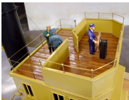
Maßstäblich passende Figuren sorgen für etwas mehr Leben auf dem Schiff. Die Kommandobrücke ist ebenfalls mit Buchenleisten beplankt
