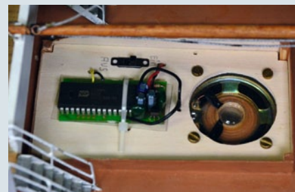
Unter der hinteren Luke auf dem Vordeck sitzt das Modul zur Geräuscherzeugung, abgedeckt durch eine Persenning
