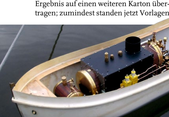
Das war der Ausgangspunkt: Die Dampf- und Wellenanlage sind installiert und eine umlaufende Decksauflage eingebaut
