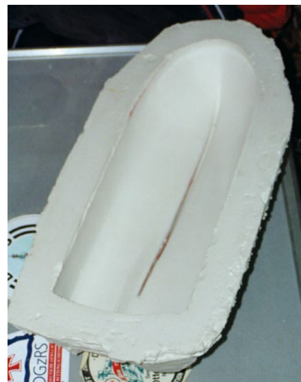
In der Gips-Form ließ sich ein GFK- Abzug des Rumpfs erstellen
