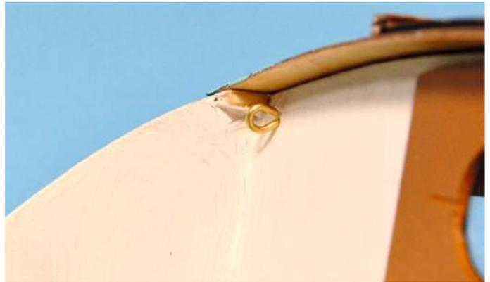
**Befestigungsstifte unter dem Kabinendach – vorn rechts unter dem Positionslicht und an der Kabinenrückwand jeweils in der oberen Ecke – sichern den Aufbau**
