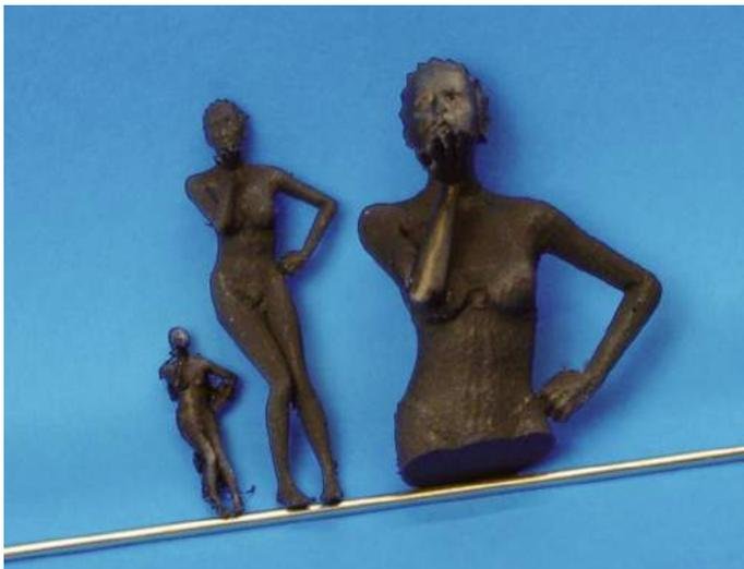
Ohne Nachbearbeitung direkt aus dem 3D-Drucker (von links nach rechts): Figur im Maßstab 1:40, im Maßstab 1:20 und Oberkörper im Maßstab 1:10
