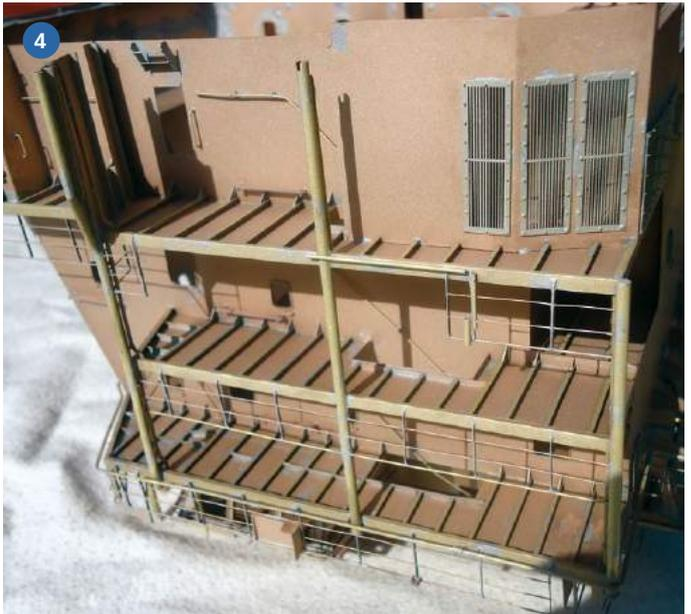
1) Aus 0,3- und 0,4-Millimeter-Bronzeblech entstanden die Aufbauten. Links unten im Bild ist die Baumethode für die Fensterrahmen zu sehen. 2) Weitgehend fertig gestellter Aufbau mit Fensterrahmen, aber noch ohne Details. 3) Vor dem Lackieren ist der Aufbau einmal komplett zu reinigen und von Rückständen, beispielsweise durchs Lötens zu befreien. 4) Unter den Decks sind Winkel als Unterzüge gelötet
