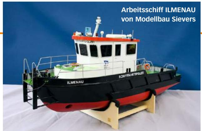
entstandenen Originals ist im Maßstab 1:20 gehalten, hat eine Länge von 622 Millimeter und eine Breite von 180 Millimeter. Der Bausatz besteht aus einem GFK-Rumpf, Aufbauten und Deck aus gefrästen Polystyrol, diversen Resin- und Fertigteilen, dem Bauplan mit einer Bauanleitung, der kompletten Beschriftung und einem Antriebsset bestehend aus Welle, Schraube und Ruder mit -bock und -arm. Der Preis: 250,- Euro. [www.modellbau-sievers.de](http://www.modellbau-sievers.de)
