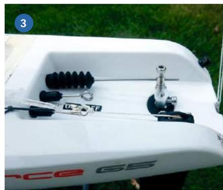
1) Der Mastfuß lässt keine Trimmwünsche offen. 2) Die Ösen auf dem Vordeck sind vertieft angebracht, damit sich die Schot nicht verfangen kann. 3) Das Cockpit beherbergt die Ruderanlenkung, die Schotführung und den wasserdichten Schalter
