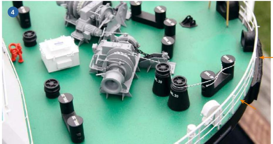
1) Aus in Leisten geschnittenen Birnbaumleisten entstand die Beplankung des Arbeitsdecks. 2) Im 40-Fuß-Container untergebracht ist ein Teil der RC-Technik des Modells. 3) Gegenstände wie Luken, Kästen, Lüfter in allen möglichen Varianten flankieren die Cargorail. 4) Fallen auf dem Backdeck zunächst Ankerwinde, Kettenstopper, Umlenkrollen, Poller und Lukeneinstiege auf, sei besonders auf die im Handlauf der Reling integrierte Selbstschutzanlage hingewiesen
