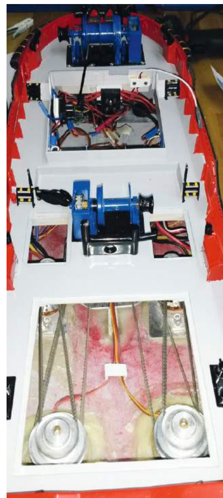
Alle Teile werden montiert und die Steuereinheit getestet
