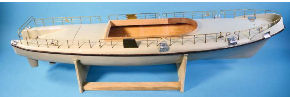
Der Decksaufbau beginnt mit dem Anpassen der Reling
