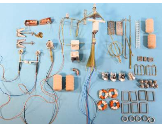
Zahlreiche Kleinteile entstanden aus Holz, Messing, Alu, Druckguss oder ABS und nur wenige sind Fertigteile
