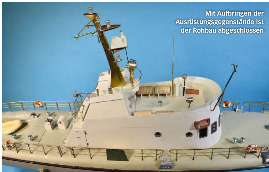
Deckshaus mit Fahrstand – der unfertige Zustand lässt erkennen, dass ein Messmodell Pate stand
