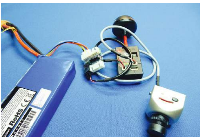
Der Spannungsregler zum Anschluss der Kamera an einen 2s-LiPo liegt dem Sendemodul bei
