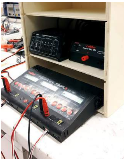
In den Seitenwänden sind Nuten zur Unterteilung beziehungsweise als Ein/Ausschub eingelassen
