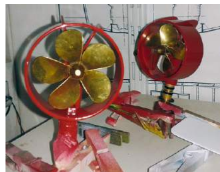
Die Schottel bekommen Farbe, in ihnen tun zwei 50-Millimeter-Messingpropeller ihren Dienst
