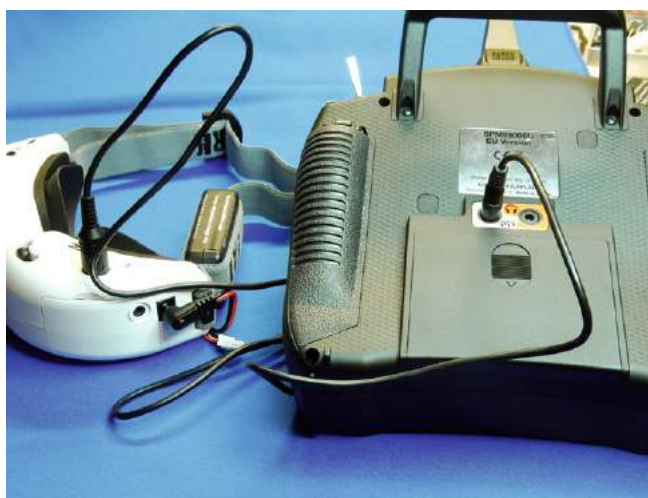
Mit dem Headtracker-Kabel wird die Brille an die Schüler-Buchse des Spektrum Senders angeschlossen
