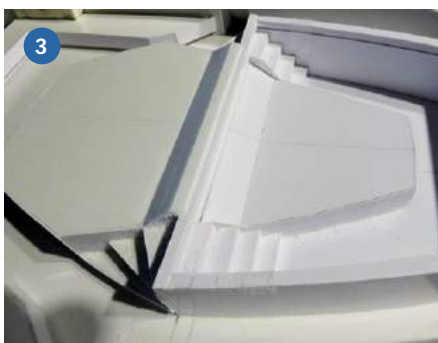
1) Wie sich nach der ersten Probefahrt zeigte, war der vordere Steven aus Alu noch einmal neu zu gestalten und auszutauschen. 2) Mit Hilfe von Pappschablonen ließ sich die endgültige Optik des Aufbaus finden. 3) Im Rohbau befindliches vorderes Sonnendeck: Links die Sitzgruppe mit Sonnenliege, rechts der Pool. 4) Leuchtmittel sorgen für echte Yachtstimmung auf dem abendlichen Sonnendeck
