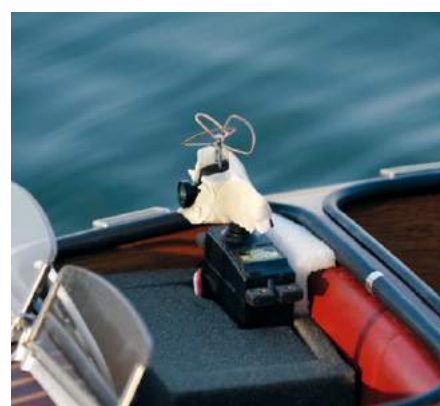
Fahrt mit der Kamera auf einem Servo montiert
