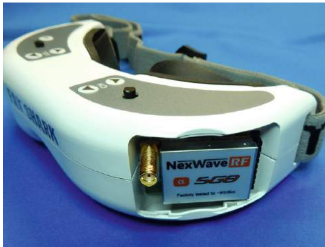
Das 5,8-Gigahertz-Modul muss nachgerüstet werden
