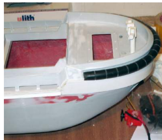
Charakteristisch für Hafenschlepper sind die schützenden Bugfender, die aus Kabelisolierungen entstanden
