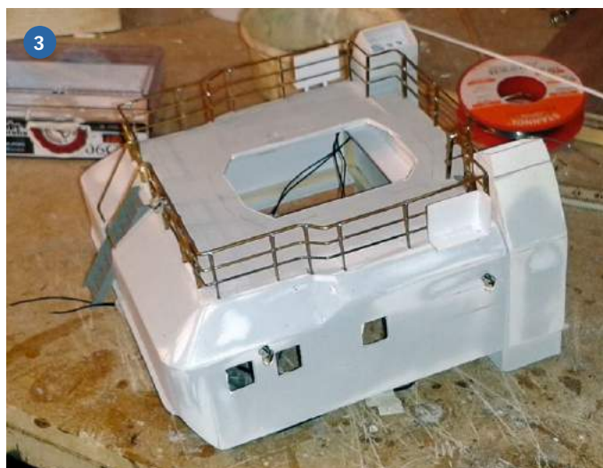
1) Rumpf, Schanz und Aufbau sind fertig und wurden das erste Mal grundiert, um zu erkennen wo noch Makel zu beseitigen sind. 2) Viel Lötarbeit steckt in dem Mast. Die Verkabelung der vielen SMD erfolgte leider außerhalb. 3) Die Reling aus Ätzteilen und 0,8 und 0,5 Millimeter Messing-Draht
