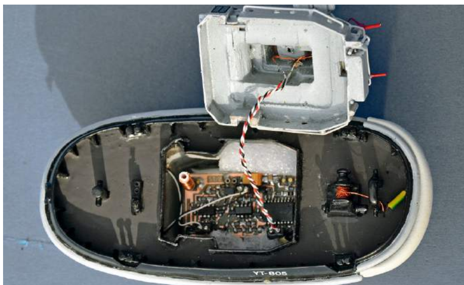
Das Innere des Modells mit Empfängerplatine über dem nicht sichtbaren LiPo.
