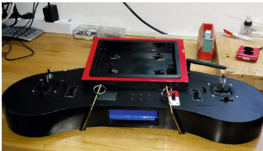
Das Kommandopult: In der Mitte die weite Auslage mit Einbaurahmen für den Bildschirm
