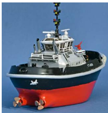
Heckblick der SEMINOLE mit Motoren in Wellenhosen mit aufgesetzten Dreiblattpropellern
