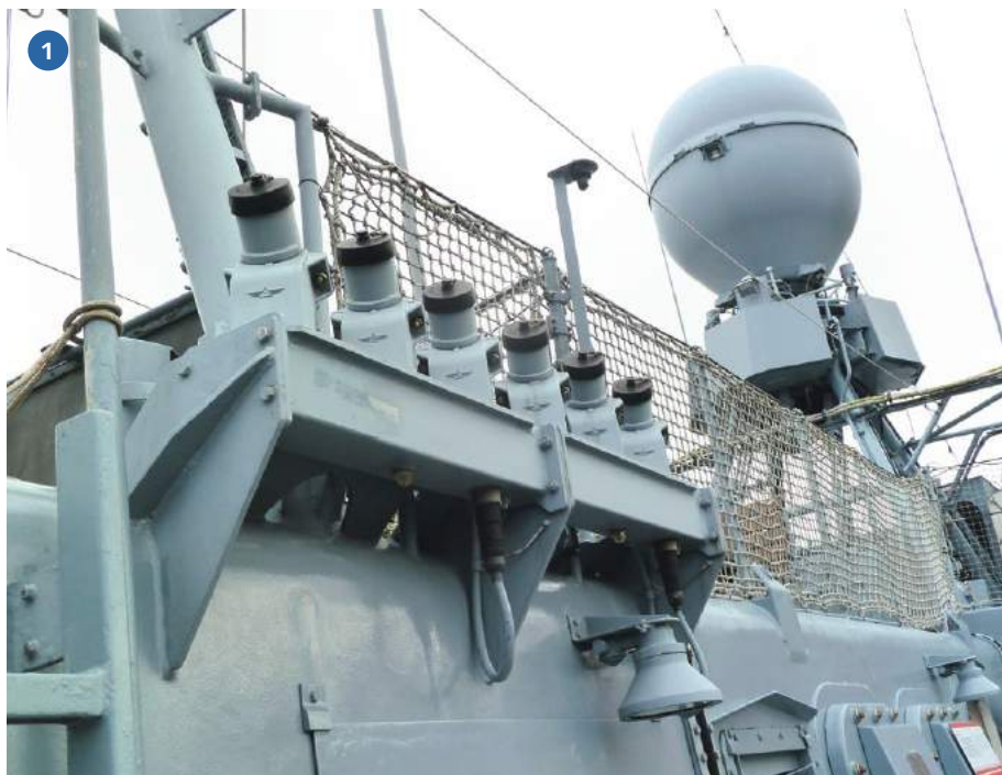
1) Einer der zwei Täuschkörperwurfanlagen. Sie dienen zur Täuschung und Ablenkung von Infrarot- und radargesteuerten Flugkörpern. 2) Einer der Startcontainer der Flugkörper wurde aufgeschnitten und mit einer Raketenattrappe ausstaffiert. 3) Die GEPARD war auch zum Minenlegen ausgerüstet. Verschiedene Minentypen sind auf dem Achterdeck zu betrachten
