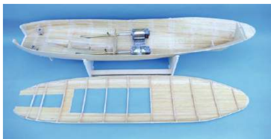
Rumpf und Deck konnten nach dem Bau getrennt werden, um den Antriebseinbau vorzunehmen
