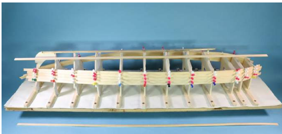
Der Rumpf entstand in konventioneller Rundpantebauweise
