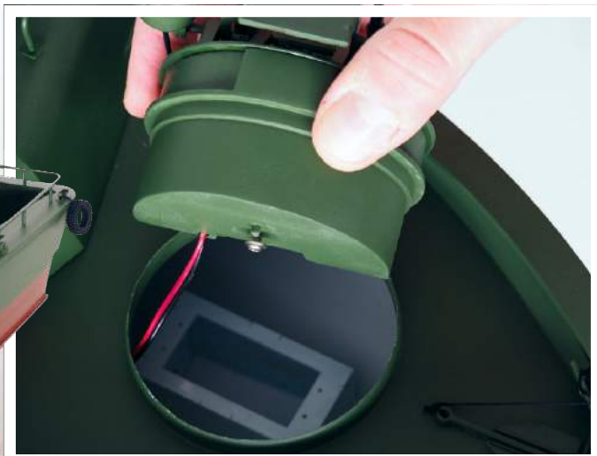
Der vordere Geschützturm lässt sich nachträglich drehbar machen. Für das erforderliche Schwenkservo ist eine Halterung im Rumpf eingelassen
