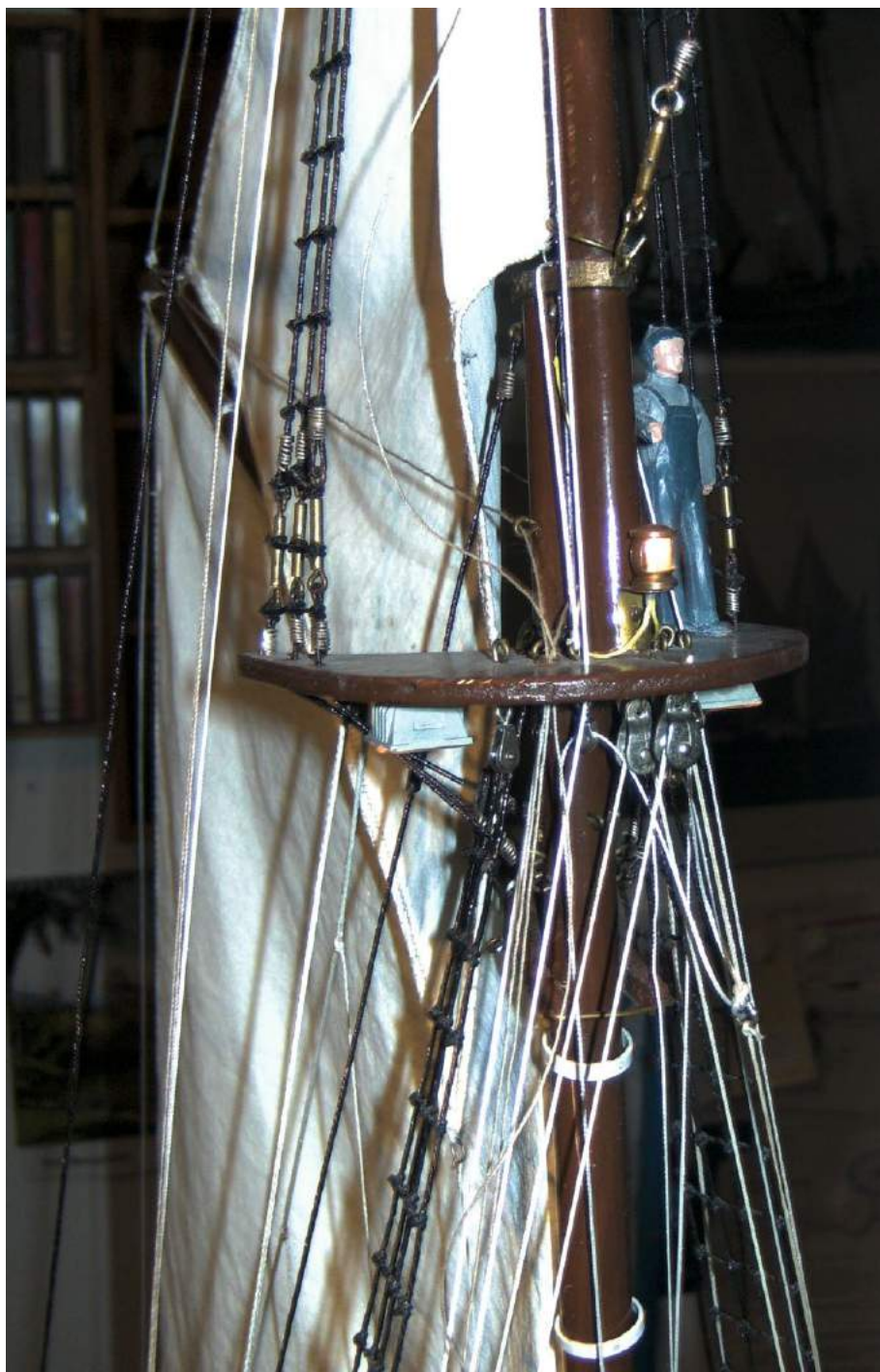
Der Besan-Mars mit Dampferlicht. Die Beleuchtung wird abhängig vom Fahrzustand geschaltet
