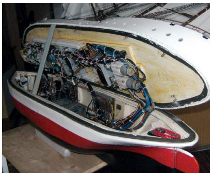
Bei geöffnetem Deck gelangt man an die geballte Technik. Zahlreiche Winden übernehmen die Segelverstellung
