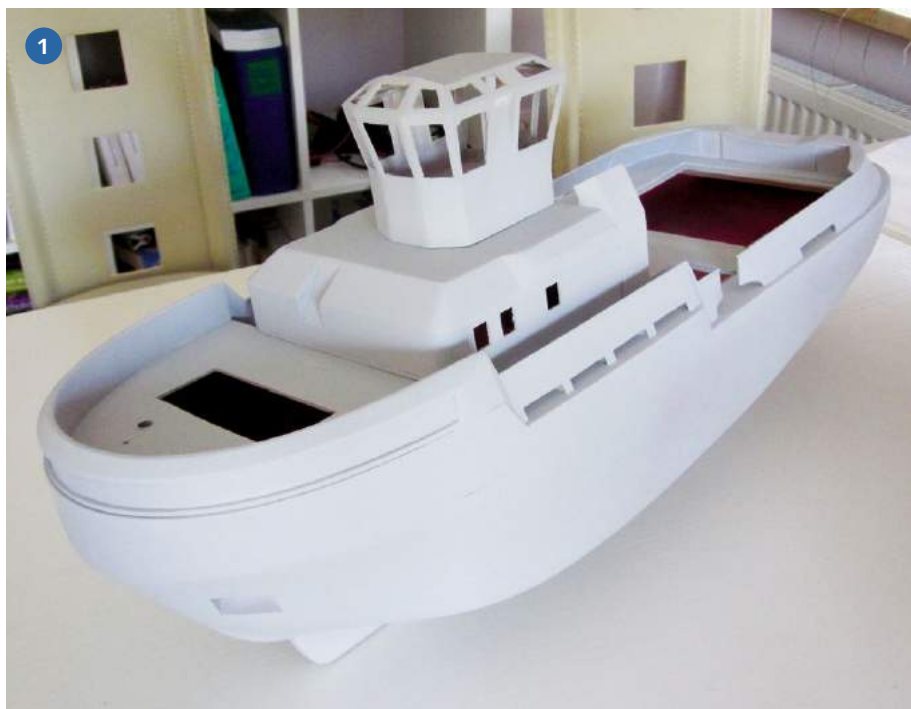
1) Rumpf, Schanz und Aufbau sind fertig und wurden das erste Mal grundiert, um zu erkennen wo noch Makel zu beseitigen sind. 2) Viel Lötarbeit steckt in dem Mast. Die Verkabelung der vielen SMD erfolgte leider außerhalb. 3) Die Reling aus Ätzteilen und 0,8 und 0,5 Millimeter Messing-Draht
