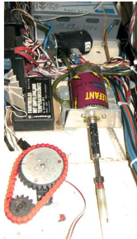
Der Fahrmotor und dahinter die Lenzpumpe. Sie tritt Sensor-gesteuert in Aktion, wenn zu viel Wasser ins Schiffsinne eingedrungen ist
