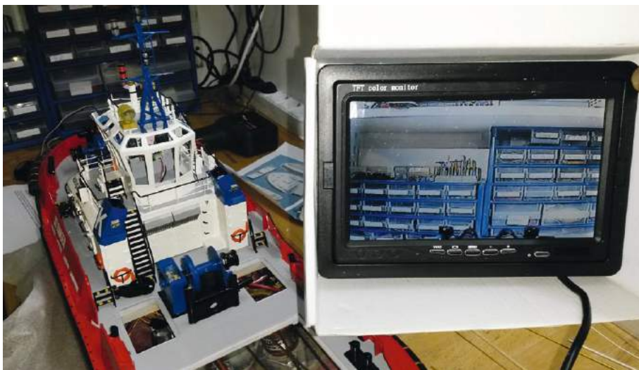
Die Kamera der FPV-Anlage liefert klare und gute Bilder
