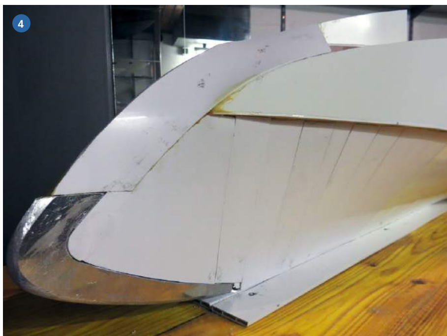
1) Die Form des späteren Sonnendecks bestimmt maßgeblich auch die oberen Befestigungspunkte der Rumpfplatten. 2) Der vordere Teil wird schrittweise mit 50 Millimeter breiten ABS-Streifen ausgekleidet. 3) Aufgrund der Rumpfform war die Einarbeitung einer Spritzwasser-abweisenden Kante erforderlich. 4) Der mit Aluminium verstärkte Steven ist ein Wesensmerkmal der SKY und später sichtbar gestaltet
