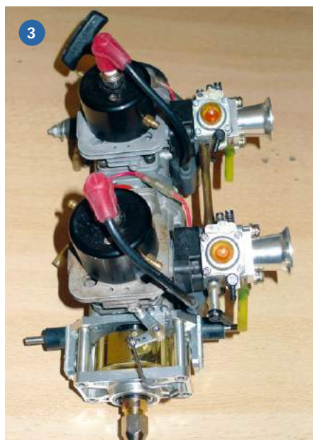
1) Natürlich geht es im Innenraum etwas enger zu, dennoch passt in den 1.310 Millimeter langen Rumpf alles hinein. 2) Die sportlich-elegante CHAPARAL wartet nur darauf, endlich ins Wasser gelassen zu werden. 3) Den Zauber-Zweizylinder erfüllen die beiden Zenoah-Motoren, jedoch würde sich ein größeres Boot zu ihrer unproblematischen Leistungsentfaltung anbieten
