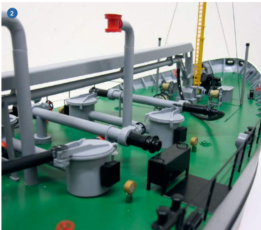
1) Verschiedene Teile wurden aus Polystyrol-Platten ausgeschnitten und in Kleinstarbeit zusammengefügt. 2) Die Rohre an Deck sind ebenfalls aus Polystyrol gefertigt, anschließend wurden sie lackiert
