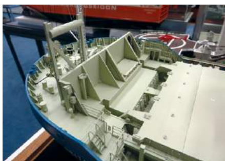
Über 2 Meter hohe Wellenbrecher halten überkommendes Wasser effektiv vom Überspülen des Decks ab
