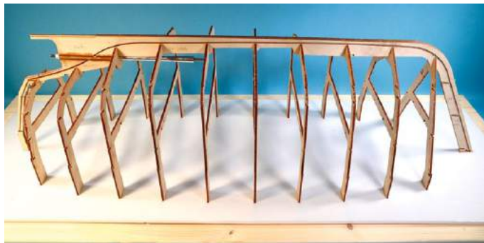
Die Spanten wurden auf der Helling aufgesetzt
