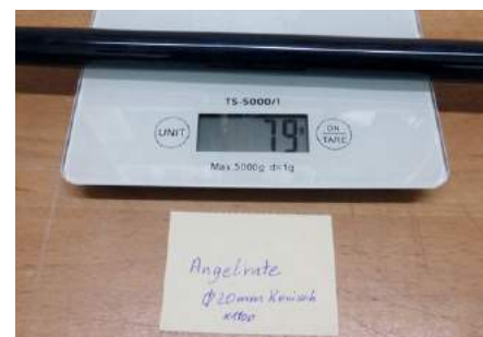
Die konische Angelrute mit 20 Millimeter Durchmesser wiegt 79 Gramm und war das Richtmaß für den Holzmast
