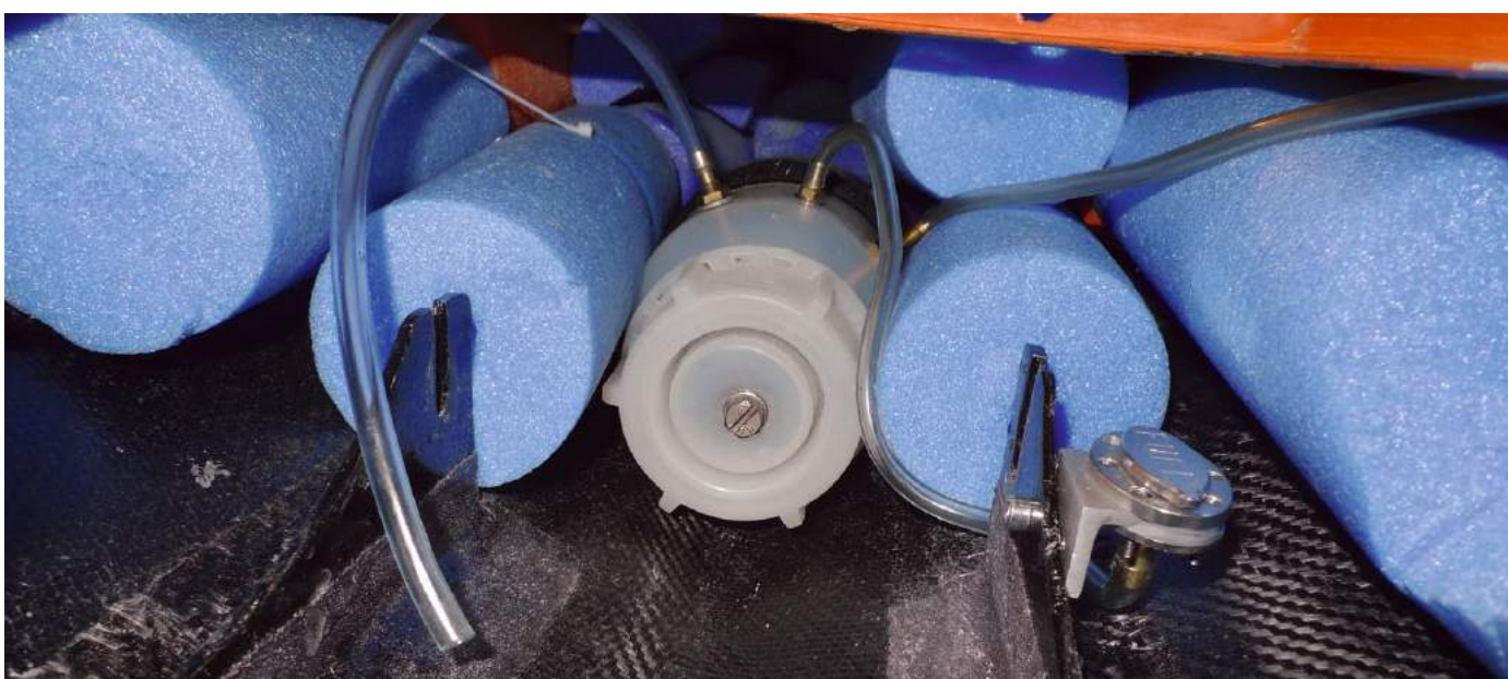
Der 1-Liter-Tank versorgt die beiden Zylinder und ist komplett von Schwammnudeln umgeben, damit der Rumpf bei einer Flutung nicht sinkt
