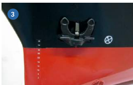
1) Details wie diese Rettungsinsel runden das Gesamtbild der HEIDE ab. 2) Sicherheit geht vor: So findet sich an Deck natürlich auch ein Hydrant. 3) Die Anker lassen sich dank der Winde lichten und senken. 4) Eine Service-Öffnung erleichtert den Zugang
