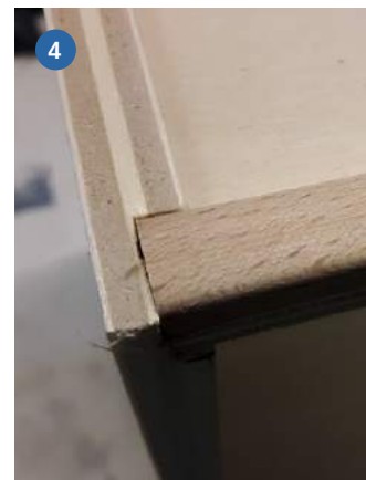
1) Abdeckplatte und Rückwand sind bereits in den Nuten der Seitenwand mit Leim eingesetzt. Rechts daneben liegt die Bodenplatte zum Einsetzen bereit. 2) Kleine Holzfüße sichern Boxen beim Stapeln gegen Verrutschen. 3+4) Unter der Bodenplatte sind stabile Buchenholzleisten verklebt. Der Nuten-Überstand wurde hierfür entfernt
