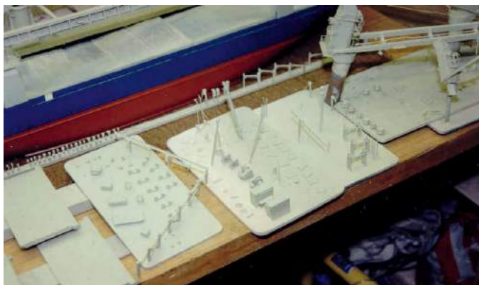
Die Bauweise in Gruppen gestattet nicht nur das gleichzeitige Lackieren, sondern auch das zügige „Aufstecken“ fertiger Teile
