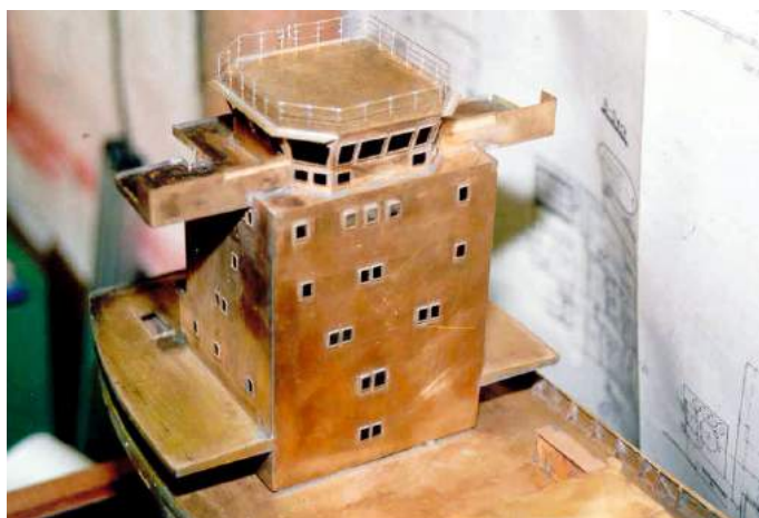
Bronzeblech in 0,2 bis 0,3 Millimeter Stärke war bei der CONTI BRITANIA das Material der Wahl
