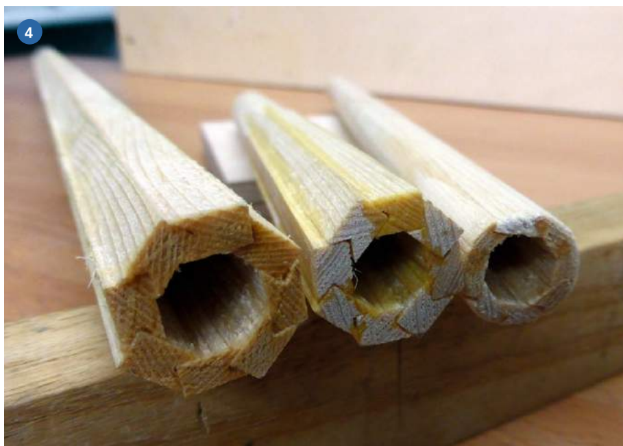
1) In der Vorrichtung lässt sich der Rundlauf am besten prüfen. 2) Die Mastaufnahme auf dem 10 Pieds. 3) Der Ehrgeiz zum Bau eines zweiten, mit 16 Millimeter etwas dünnerem Masts war geweckt. Dieser wiegt nur 57 Gramm. 4) Größenvergleich zwischen 18 und 16 mm vor und nach der Bearbeitung. 5) Mein Lieblingswerkzeug beim Verrunden und konisch Anspitzen ist der Balsahobel
