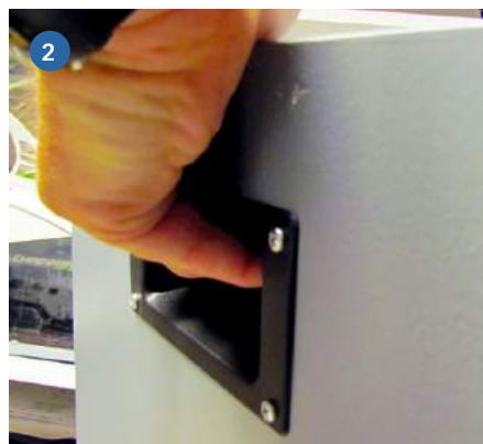
1) Mit einer Schablone lassen sich maßgenaue Öffnungen für Griffeneinsätze erstellen. 2) Große Boxen erhielten seitlich eingelassene Griffe, da diese sicheres Tragen garantieren. 3) Alle verwendeten Griffe stammen aus dem Musik-Zubehör. Sie ragen wenig auf und sind daher zum Stapeln gut geeignet
