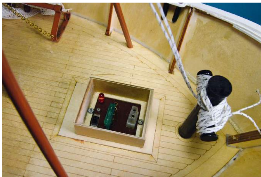
Der Einbau von Ladebuchse und Sicherung erfolgte unter dem Niedergang
