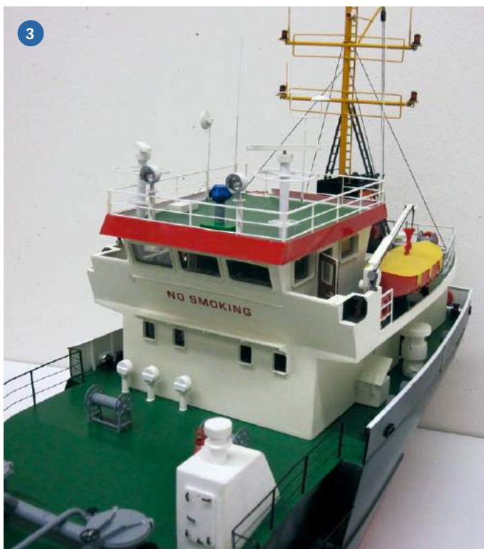
1) Der Rumpf stammt aus einem anderen Baukasten. Hier war zunächst noch ein Bugwulst vorhanden, der entfernt wurde. 2) Das Modell verfügt über eine funktionstüchtige Ankerwinde, die sich unter Deck befindet. 3) Das Deckshaus besteht zum größten Teil aus Polystyrol unterschiedlichster Dicke. 4) Die Relingen sind aus Metalldraht und ruhen auf Messingstützen
