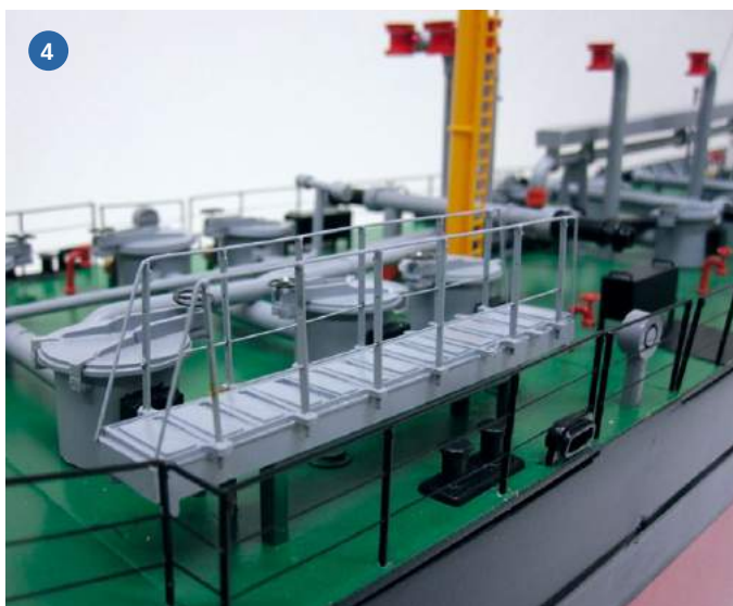
1) Der Rumpf stammt aus einem anderen Baukasten. Hier war zunächst noch ein Bugwulst vorhanden, der entfernt wurde. 2) Das Modell verfügt über eine funktionstüchtige Ankerwinde, die sich unter Deck befindet. 3) Das Deckshaus besteht zum größten Teil aus Polystyrol unterschiedlichster Dicke. 4) Die Relingen sind aus Metalldraht und ruhen auf Messingstützen
