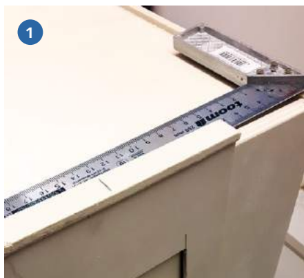
1) Mit einer Schablone lassen sich maßgenaue Öffnungen für Griffeneinsätze erstellen. 2) Große Boxen erhielten seitlich eingelassene Griffe, da diese sicheres Tragen garantieren. 3) Alle verwendeten Griffe stammen aus dem Musik-Zubehör. Sie ragen wenig auf und sind daher zum Stapeln gut geeignet
