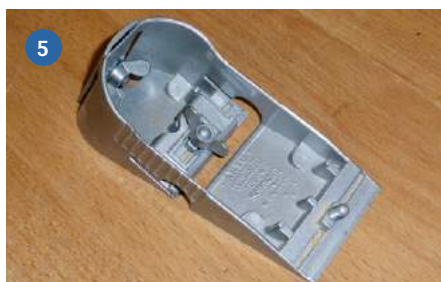
1) In der Vorrichtung lässt sich der Rundlauf am besten prüfen. 2) Die Mastaufnahme auf dem 10 Pieds. 3) Der Ehrgeiz zum Bau eines zweiten, mit 16 Millimeter etwas dünnerem Masts war geweckt. Dieser wiegt nur 57 Gramm. 4) Größenvergleich zwischen 18 und 16 mm vor und nach der Bearbeitung. 5) Mein Lieblingswerkzeug beim Verrunden und konisch Anspitzen ist der Balsahobel
