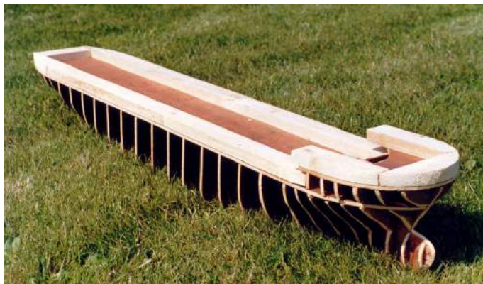
Aufgrund der Positiv-Negativ-Positiv-Bauweise konnte das Urmodell aus groben Materialien aufgebaut werden
