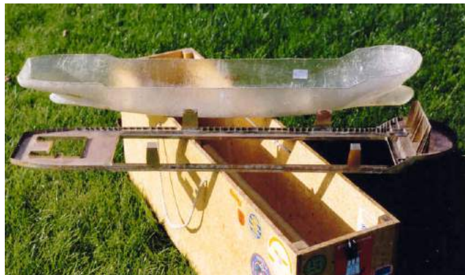
Der Polyesterrumpf ist relativ dünn, dafür aber leicht geraten – davor liegt der Decksaufbau
