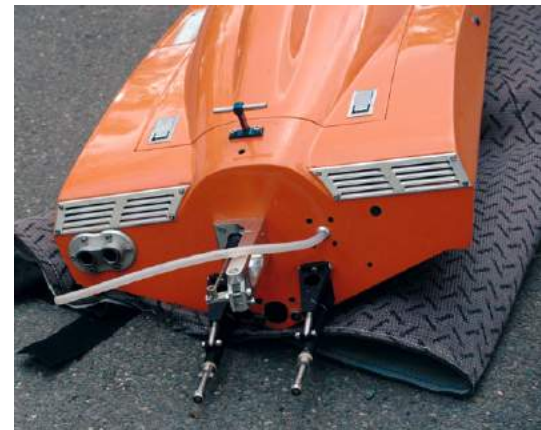
Durch den Umbau auf Doppelschraubenantrieb war auch die Keilruderanlage in die Mitte zu versetzen
