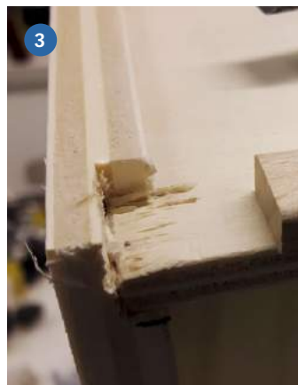
1) Abdeckplatte und Rückwand sind bereits in den Nuten der Seitenwand mit Leim eingesetzt. Rechts daneben liegt die Bodenplatte zum Einsetzen bereit. 2) Kleine Holzfüße sichern Boxen beim Stapeln gegen Verrutschen. 3+4) Unter der Bodenplatte sind stabile Buchenholzleisten verklebt. Der Nuten-Überstand wurde hierfür entfernt
