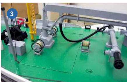
1) Details wie diese Rettungsinsel runden das Gesamtbild der HEIDE ab. 2) Sicherheit geht vor: So findet sich an Deck natürlich auch ein Hydrant. 3) Die Anker lassen sich dank der Winde lichten und senken. 4) Eine Service-Öffnung erleichtert den Zugang
