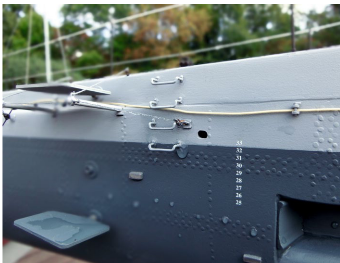
Vordere Tiefenruder mit Mündungskappen. Die Tiefgangsmarken sind im Letraset-Verfahren hergestellt, die die Firma Print&Proof als Auftragsarbeit produzierte
