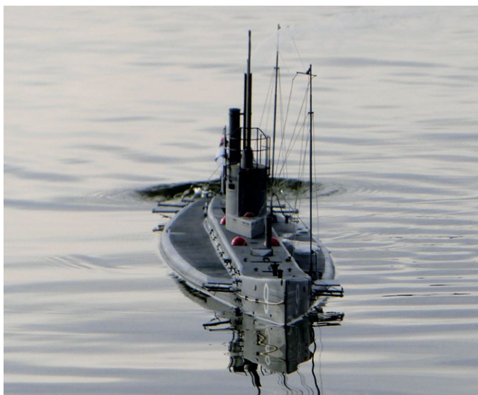
Vom kreisförmigen Rumpfquerschnitt der Einhüllenboote ist U9 mit seinem Zweihüllenkonzept weit entfernt
