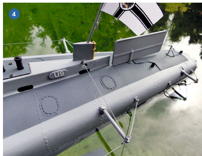
1) Heck und Technikgerüst mit den beiden Kolbentanks. 2) Vor der großen Ausfahrt ist U9 auszutrimmen, damit die Wasserlage in Normal- und Unterwasserfahrt stimmt. 3) Im Vergleich mit modernen U-Booten bietet die SM U9 noch reichlich Gelegenheiten vorbildgetreue Details umzusetzen. 4) Auf dem Achterschiff ist auch oberhalb ein Seitenruder platziert – die Ingenieure glaubten damals, es sei nötig
