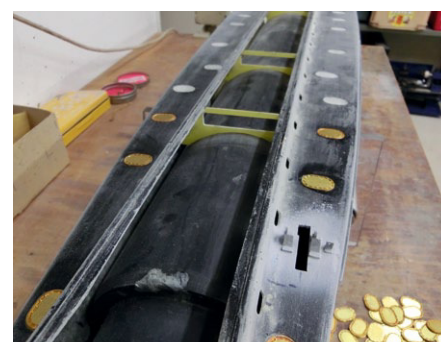
Mannlochdeckel, die der besseren Optik wegen Ätzteile sind, für die gefrästen Vertiefungen
