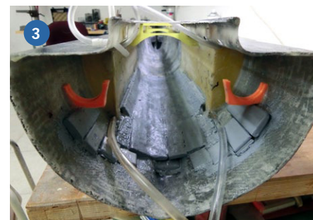
1) Aufgeklebte Maske zum Bohren und Feilen der Flutschlitze. 2) Blick ins Heck mit Durchführungen – die Schraubbefestigungen sind bereits angebracht. 3) Blick in den Vorderteil mit Trimm tanks rechts und links, den Pumpenaufnahmen und den Gewichten, die sich der Rumpfform anpassen
