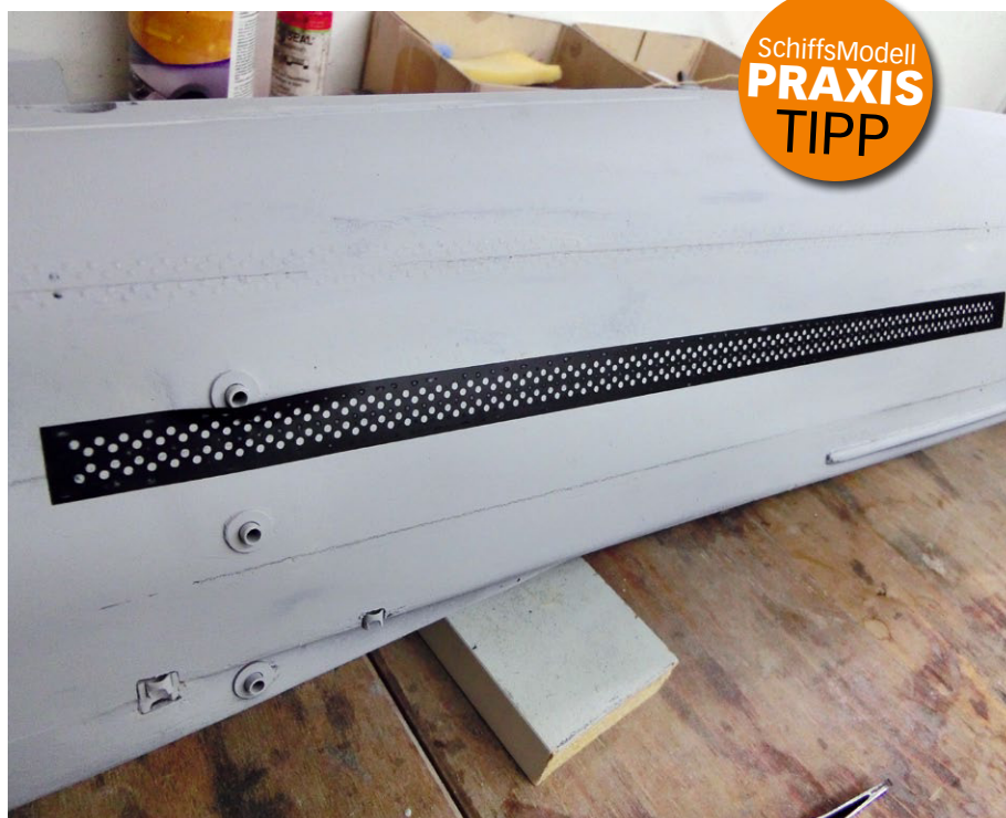
Mit Hilfe dieses aufgeklebten Lochstreifens lassen sich hervorragend Nietenreihen aus wasserfestem Weißleim auf das Boot aufbringen. Obwohl es eine zeitraubende Arbeit ist, lohnt es sich
