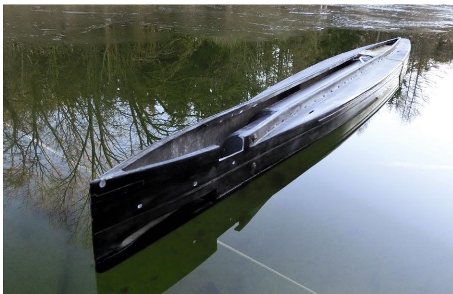
Erstes Probeschwimmen des Rumpfs im frühen Baustadium
