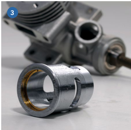
1) Vergaser des Enya-Motors. 2) Der abgenommene Zylinderkopf lässt den Blick in den Zylinder mit Laufbuchse zu. 3) Die Laufbuchse des 11CX kennzeichnet Präzision vom Feinsten. 4+5) Blick auf Kurbelwellenlager mit Pleuel, einmal im Motor und ausgebaut
