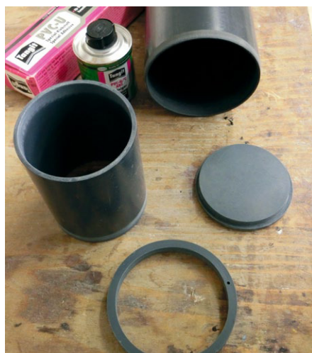
PVC-Rohre und -Deckel für den Druckkörper. Mit 110 Millimeter Durchmesser passen sie optimal in den Rumpf
