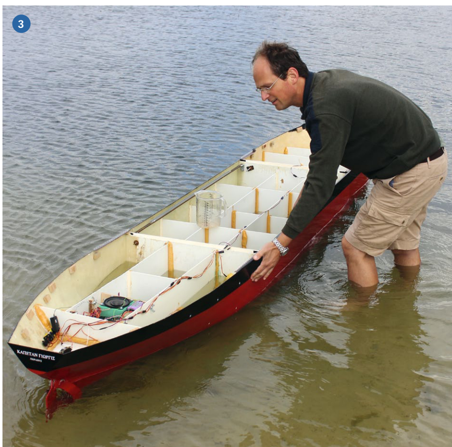
1) Die Form für die Backbordseite wird von der CNC-Fräse bearbeitet. So entstand der Rumpf. 2) Der Rohbau des Schiffs berührt zum ersten Mal das Wasser. 3) Das Schiff mit seinem Reeder (Autor) ohne Decks. Gut zu erkennen sind die Ballasttanks
