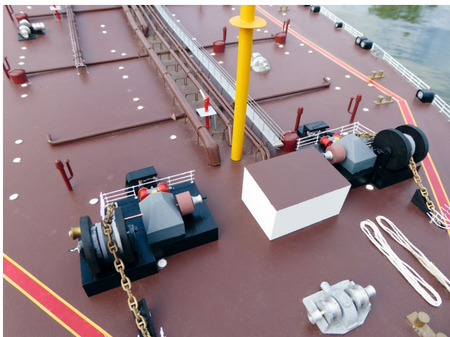
Blick auf die Ankerwinden auf dem Vorschiff für die (im Original) 28 Tonnen schweren Anker
