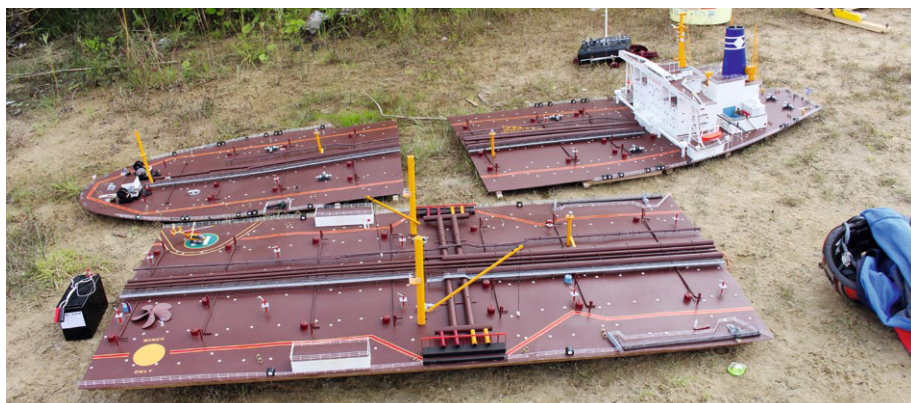
Um das Modell aus dem Wasser zu holen, werden die Decks abgenommen
