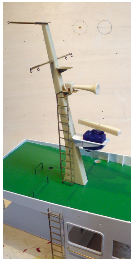
Am Mast wurde statt des statischen Radarbalkens dank eines alten Mini Servo eine drehbare Version realisiert
