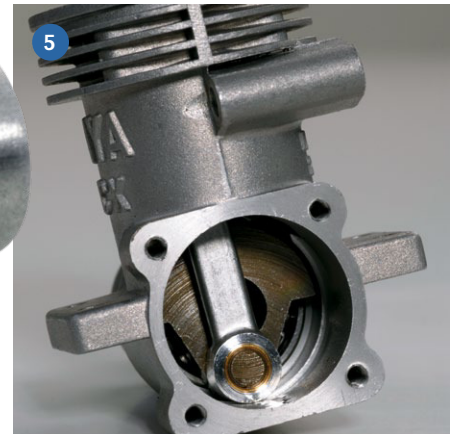
1) Vergaser des Enya-Motors. 2) Der abgenommene Zylinderkopf lässt den Blick in den Zylinder mit Laufbuchse zu. 3) Die Laufbuchse des 11CX kennzeichnet Präzision vom Feinsten. 4+5) Blick auf Kurbelwellenlager mit Pleuel, einmal im Motor und ausgebaut
