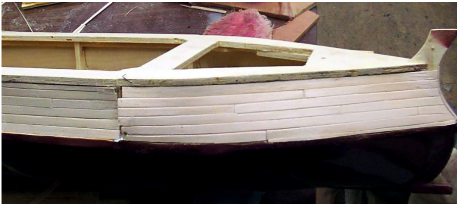
Mit Balsabeplankung entsteht das Überwasserschiff
