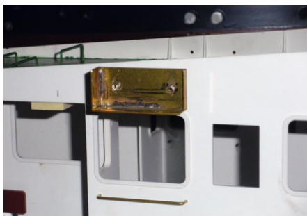
Die Lampenborde für die Positionsleuchten aus Messing
