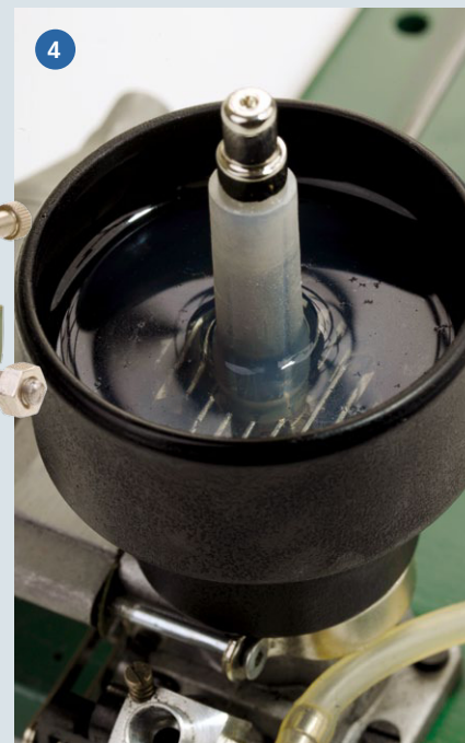
1) Bauteile für den 30-Milliliter-Wassertopf. 2) Verlängerung für die Zündkerze. 3) Auf dem Motor-Kühlkopf befestigter Wassertopf. 4) Die Wassermenge reicht für 30 Minuten Betrieb
