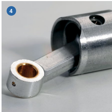
1) Vergaser des Enya-Motors. 2) Der abgenommene Zylinderkopf lässt den Blick in den Zylinder mit Laufbuchse zu. 3) Die Laufbuchse des 11CX kennzeichnet Präzision vom Feinsten. 4+5) Blick auf Kurbelwellenlager mit Pleuel, einmal im Motor und ausgebaut
