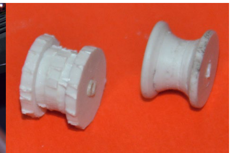
Die Spillköpfe bestehen aus fünf ABS-Scheiben, die mit Hilfe einer Bohrmaschine und einer Feile in Form geschliffen werden
