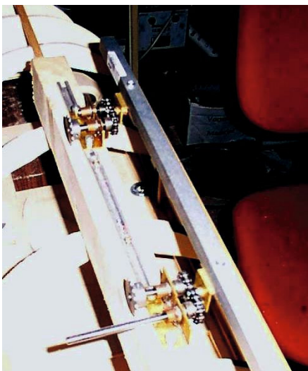
Der erste Versuch des Antriebs mit Ketten
