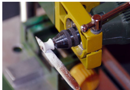
Die Spillköpfe bestehen aus fünf ABS-Scheiben, die mit Hilfe einer Bohrmaschine und einer Feile in Form geschliffen werden
