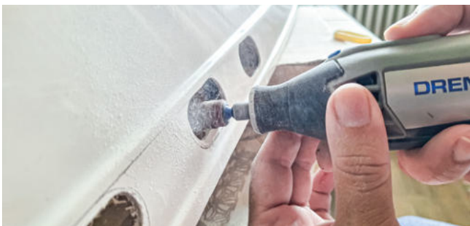
Die Öffnungen für die Bullaugen von Marinetic Yachtmodell werden mit dem Dremel passgenau in den Rumpf geschliffen
