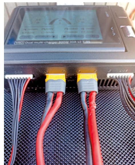
Auf der Vorderseite sind die beiden XT60-Ausgänge, optionale Anschlüsse für zwei Temperaturfühler sowie die Balancer-Slots
