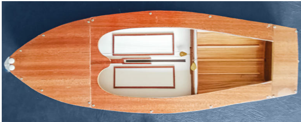
Abb. 11: Das dreiteilige Deck aus 1-mm-Mahagoni-Sperrholz, verschraubt und mit Abdichtung zum Rumpf hin – die Elektronik bleibt trocken
