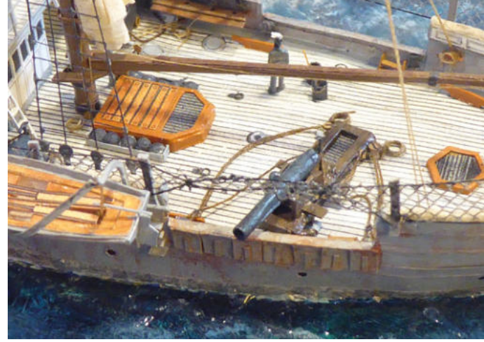
Auf den starken und mannshohen Schanzkleidern sind Hängemattkästen aufgesetzt. Zum Schutz gegen Enterungen sind Netze gespannt
