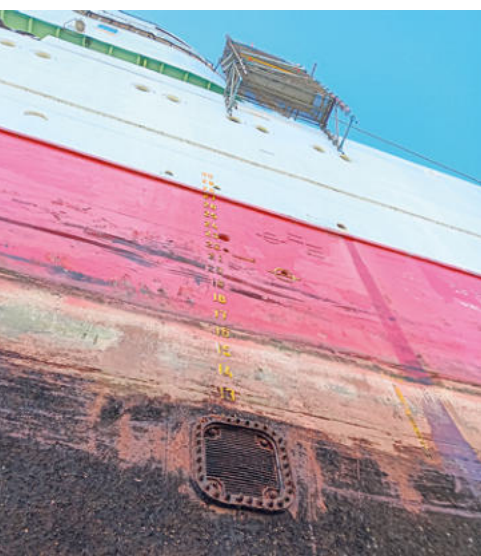
▲ Details am Unterwasserschiff: Zu den zahlreichen Öffnungen gehört diese hier hinter dem Fangsieb zum Hochsauger, der u.a. zum Befüllen des Schwimmbades am Bootsdeck dient
