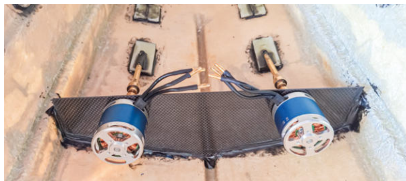
Der Motorspant ist so eingeklebt, dass Motoren und Antriebswellen sauber fluchten. Die Form des Spants wurde mit einer Konturenlehre abgenommen
