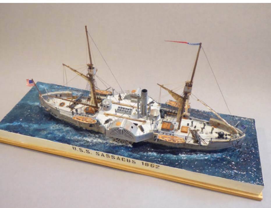
Das Schiff konnte in beide Richtungen fahren. Zwei spitze Enden mit je einem Ruder und zwei Steuerhäuser in der Schiffsmittle zeichnen die Konstruktion aus
