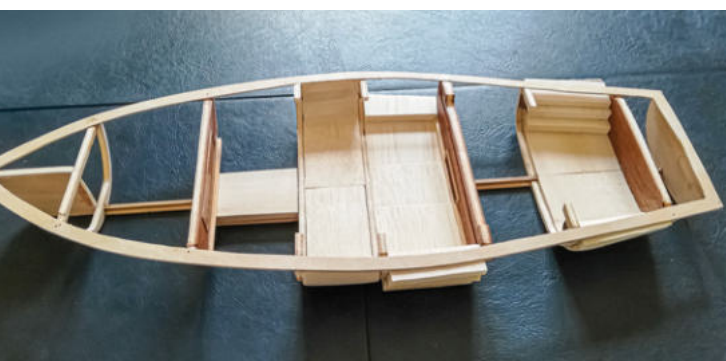
Abb. 5: Zwischen den Spanten eingeklebte Balsaholzblöcke, größtenteils schon in die endgültige Rumpfform geschliffen
