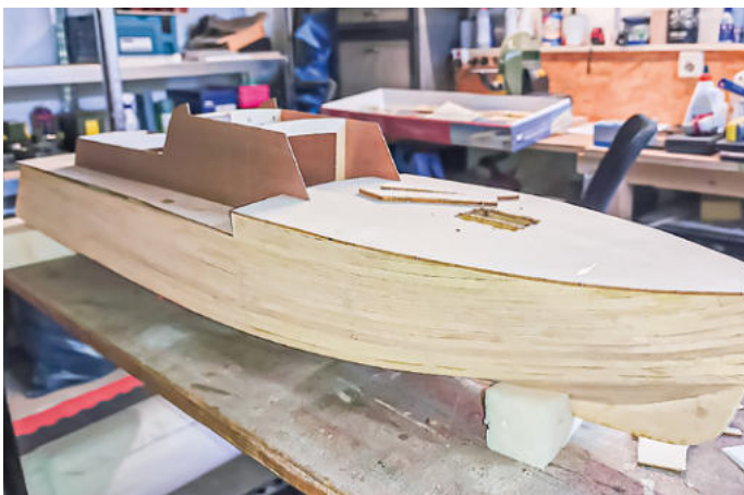
Probesitzen: Der Aufbau wird vor der Verklebung auf Passgenauigkeit geprüft
