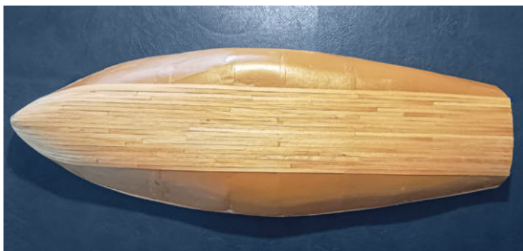
Abb. 7: Die Seiten noch unbeplankt: Gut zu erkennen ist der vorbereitete Untergrund, der farblich an die Beplankung angepasst wurde
