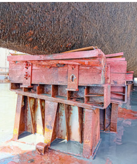
Das ist ein Pallen, der nach dem Dockplan des Schiffes auf dem Dockboden aufgebaut wurde. Das Schiff ruht nun auf ihm
