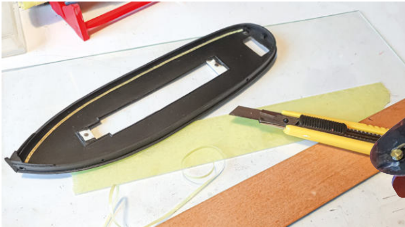
Mit Messer und Lineal zugeschnittene, schmale Klebebandstreifen dienen später zum sauberen Abkleben beim Lackieren
