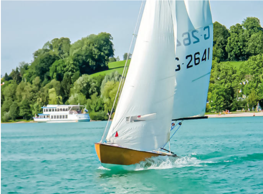
Abb. 1: Der Korsar ist eine Zweimannjolle, die 1958 vom Konstrukteur Ernst Lehfeld entwickelt wurde
