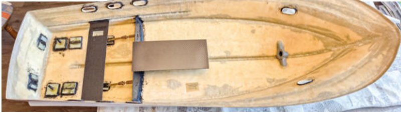
Der Ausbau der Rumpfschale ist soweit abgeschlossen. Alle erforderlichen Komponenten sind verklebt. Abschließend wird der Rumpf innen mit Topcoat versiegelt
