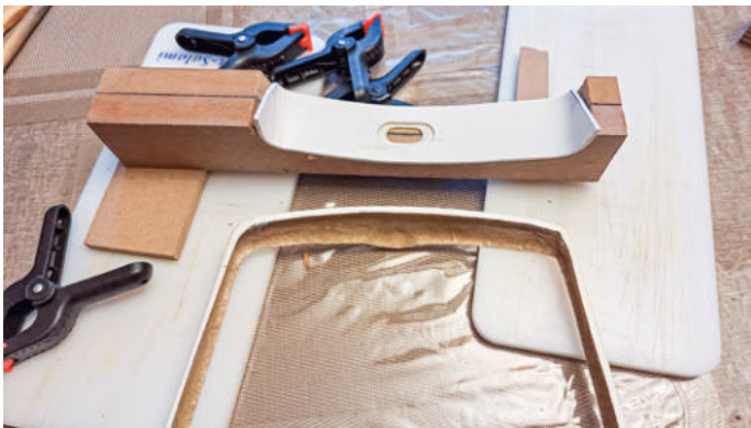
Für den Targabügel werden die 3-mm-ABS-Teile unter Erwärmung in einer MDF-Form passgenau gebogen
