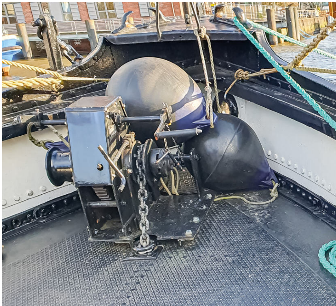
Die Ankerwinde des Originals wurde offensichtlich noch von Hand bedient
