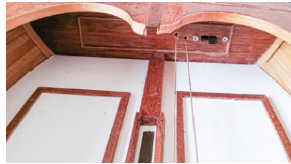
Abb. 10: Sichtbare Schotführung für Großsegel und Fock im mittleren Teil des Bootes
