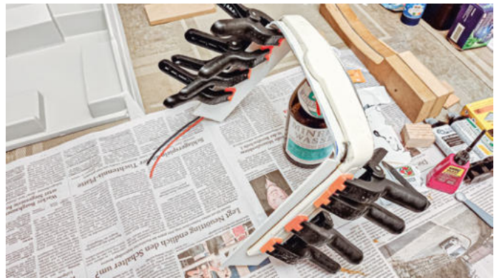
Der Targabügel wird mit den ABS-Teilen zu einem Körper zusammengefügt
