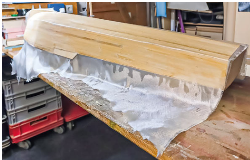
Glasfasergewebe gibt dem Rumpf zusätzliche Stabilität und Dichtigkeit
