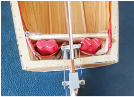
Abb. 8: Enger Stauraum im Heck: Mini-Servo zur Ruderbetätigung und Akkus teilen sich den knappen Platz im hinteren Bereich
