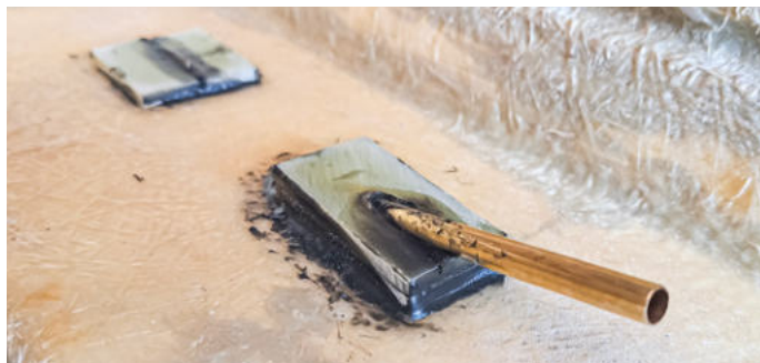
Zur Verstärkung der Stevenrohrdurchführung wird ein 10 mm dicker GFK-Klotz im passenden Winkel durchbohrt und von innen an die Rumpfdurchführung geklebt
