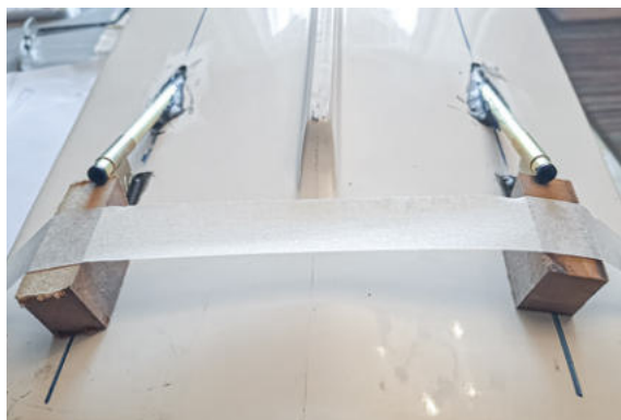
Die Stevenrohre werden mit GFK-Kleber im Rumpf verklebt
