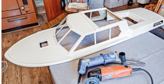
Die erste Tätigkeit war das Ausschneiden der Decksöffnungen mit dem Multimaster
