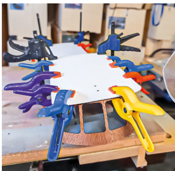
Die Dächer werden aufgeklebt – der Aufbau nimmt Gestalt an
