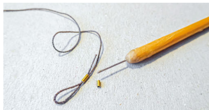
Das Auge der Schleppleine entstand mit Hilfe eines Stückes Messingrohr
