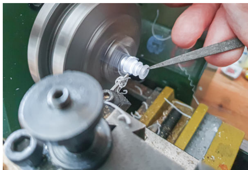
Mit Feile und 45-Grad-Senker wurden die Kanten etwas abgerundet
