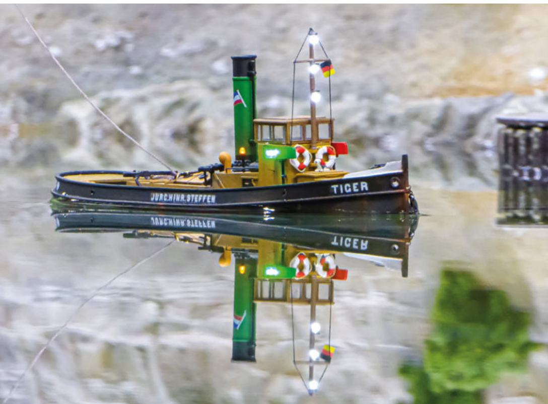
Die Lichterführung ist gut zu erkennen. Der große Tiefgang des Modells ist auf zwei Akkuzellen und eingedrungenes Wasser zurückzuführen
