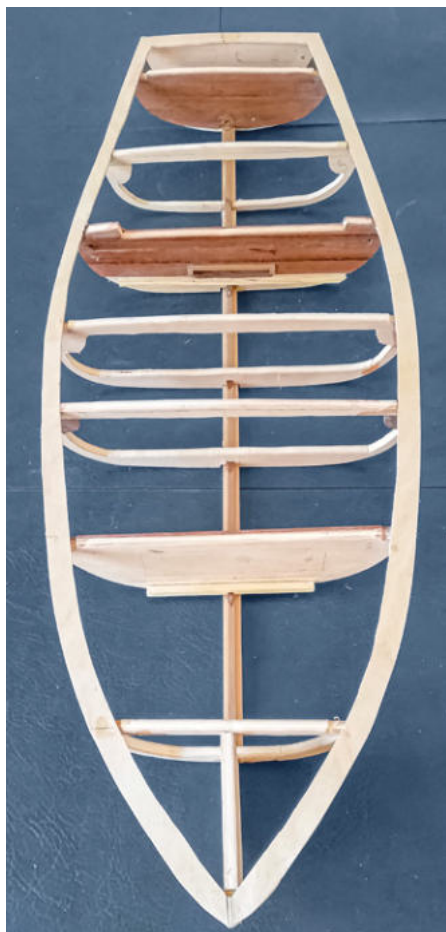
Abb. 4: Das filigrane Grundgerüst aus 6-mm-Sperrholzspanten – der erste Schritt zum maßstabsgetreuen Rumpf in 1:8
