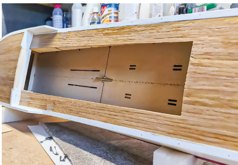
Das Deck in Eichenfurnier – aufwändig beplankt und geschliffen
