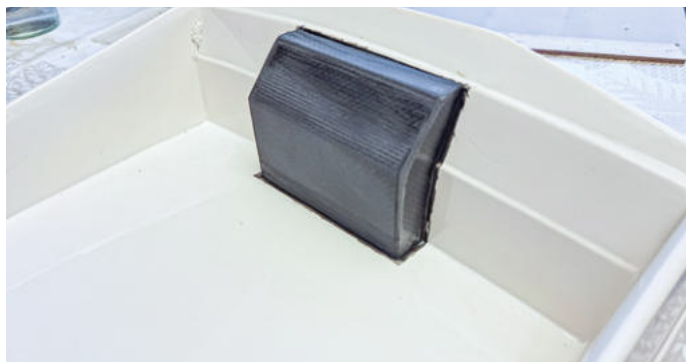
Der Ausbau der Flybridge begann mit dem Anfertigen der Steuerkonsole aus Carbon
