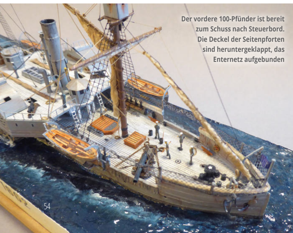
Das Schiff konnte in beide Richtungen fahren. Zwei spitze Enden mit je einem Ruder und zwei Steuerhäuser in der Schiffsmittle zeichnen die Konstruktion aus
