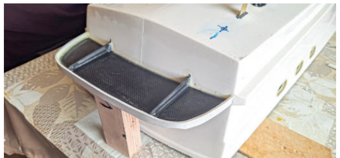
Die Badeplattform ist in der Verlängerung zur unteren Scheuerleiste mit dem Rumpf verklebt
