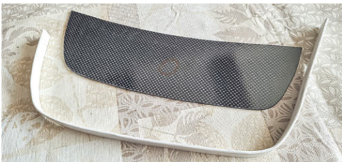
Die Badeplattform aus 2-mm-Carbon und die vorgebogene Fußreling aus ABS können verklebt werden
