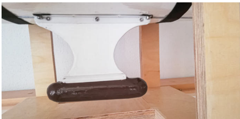
Abb. 14: Das selbstgebaute Kielgewicht: Eine aus gewässertem Sperrholz geformte Röhre, gefüllt mit verzinkten Unterlegscheiben und beidseitig mit Balsa-Pfropfen verschlossen
