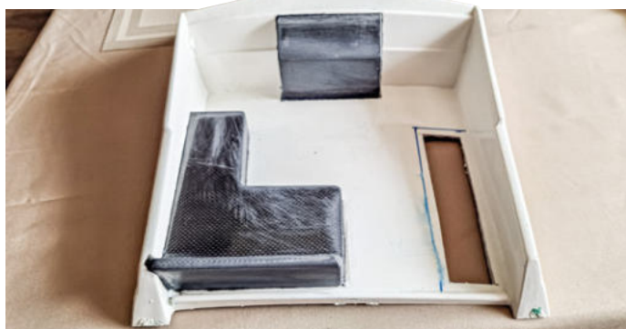
Um Gewicht zu sparen, wurde das GFK im Bereich der aufgebauten Sitzgruppen ausgeschnitten
