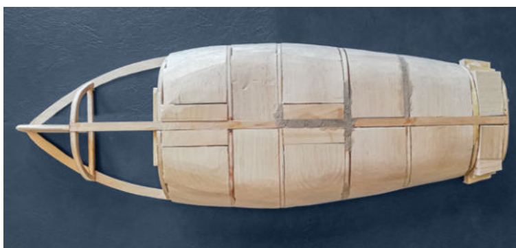
Abb. 5: Zwischen den Spanten eingeklebte Balsaholzblöcke, größtenteils schon in die endgültige Rumpfform geschliffen
