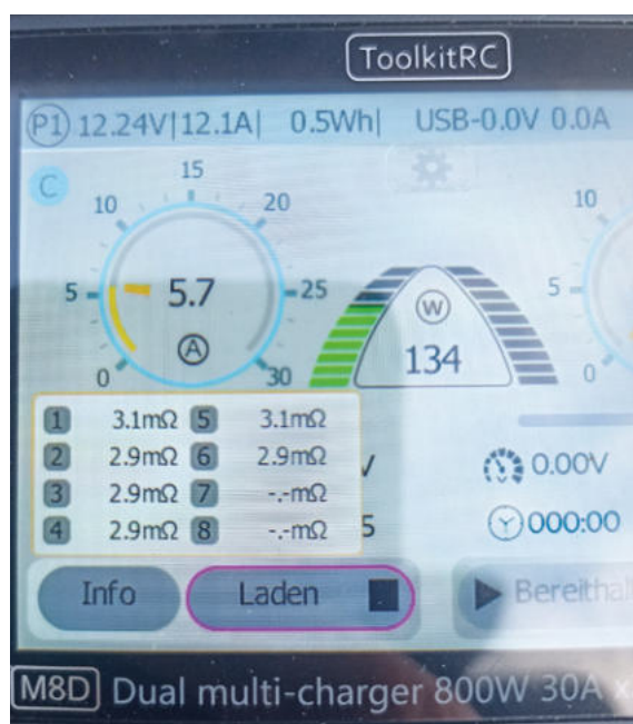
Im kleinen Infocfeld werden neben den Einzelspannungen auch die Innenwiderstände angezeigt
