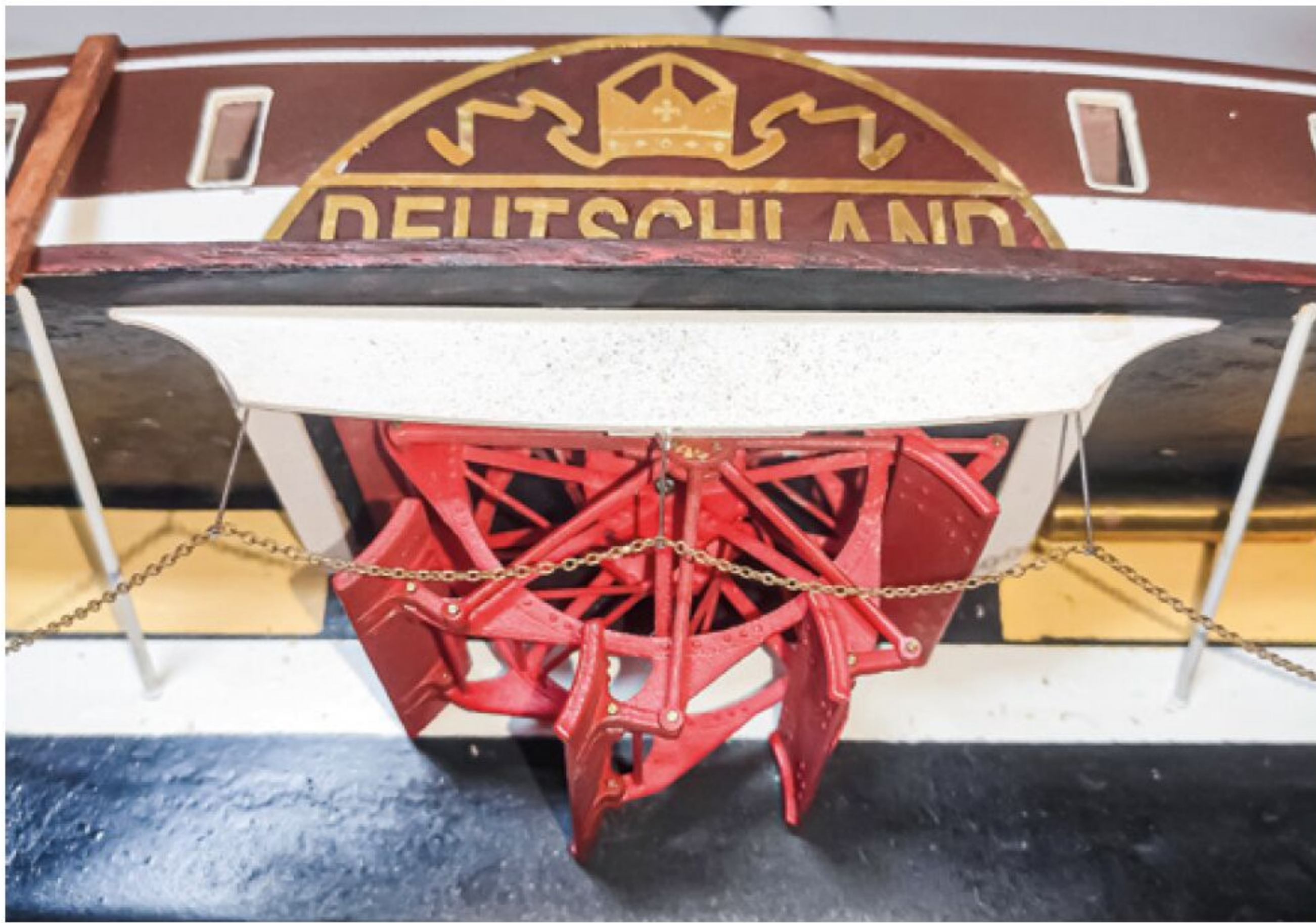
Die Räder von Sachsenberg haben keinen äußeren Ring
