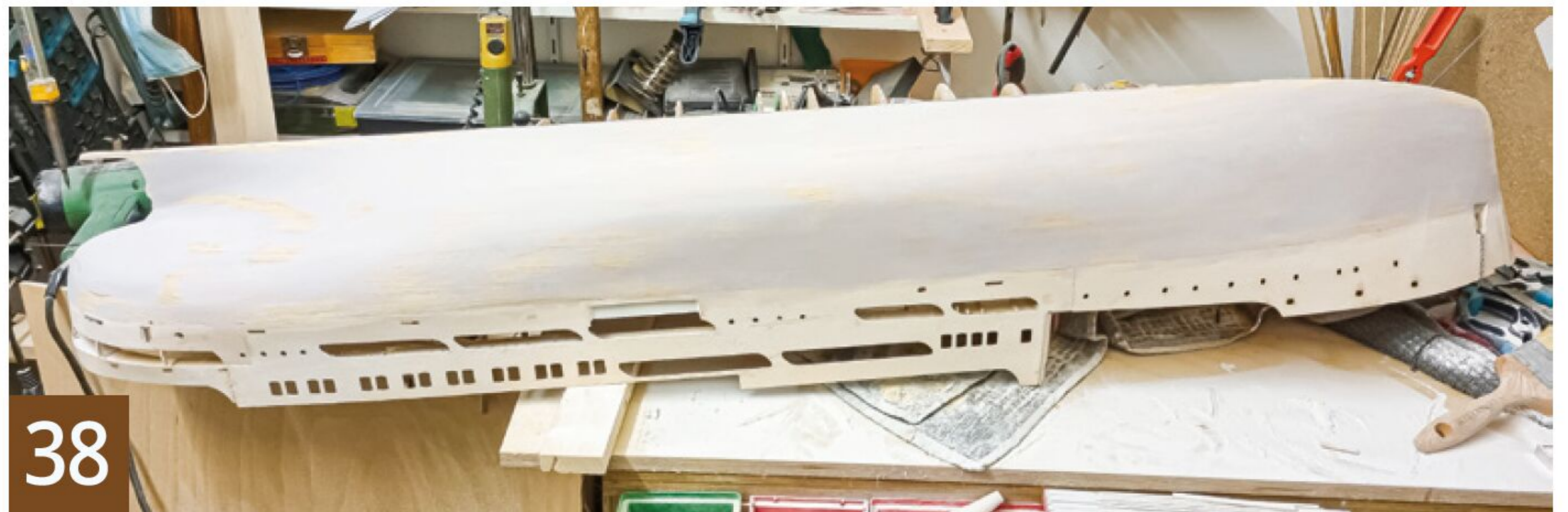
Nach dem Schleifen: glatte, laminierfertige Oberfläche
