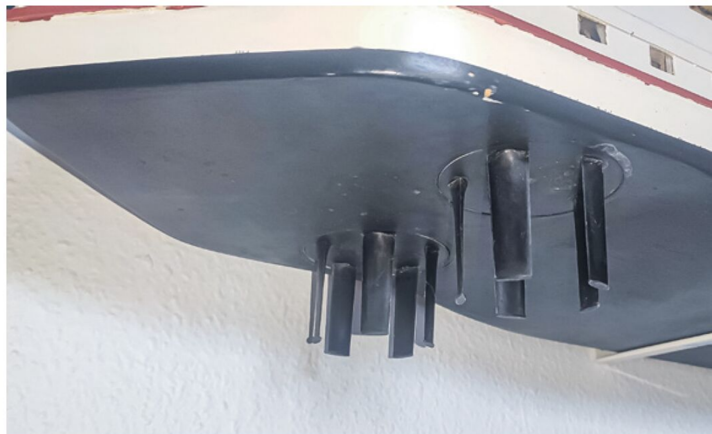
Die Köln wird mit zwei Voith-Schneider-Propellern am Heck angetrieben
