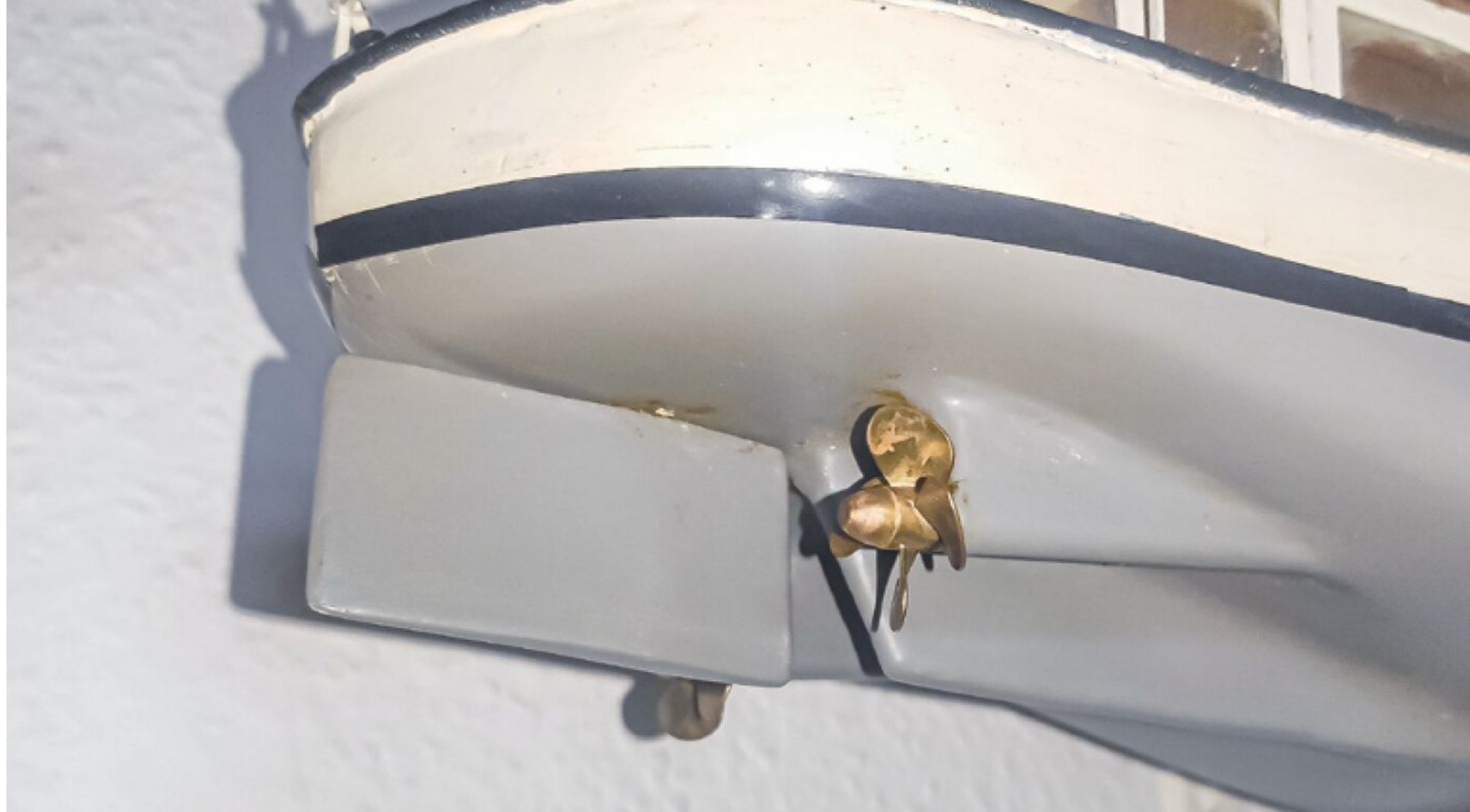
Die Beethoven fährt mit zwei Propellern und einem großen Ruderblatt
