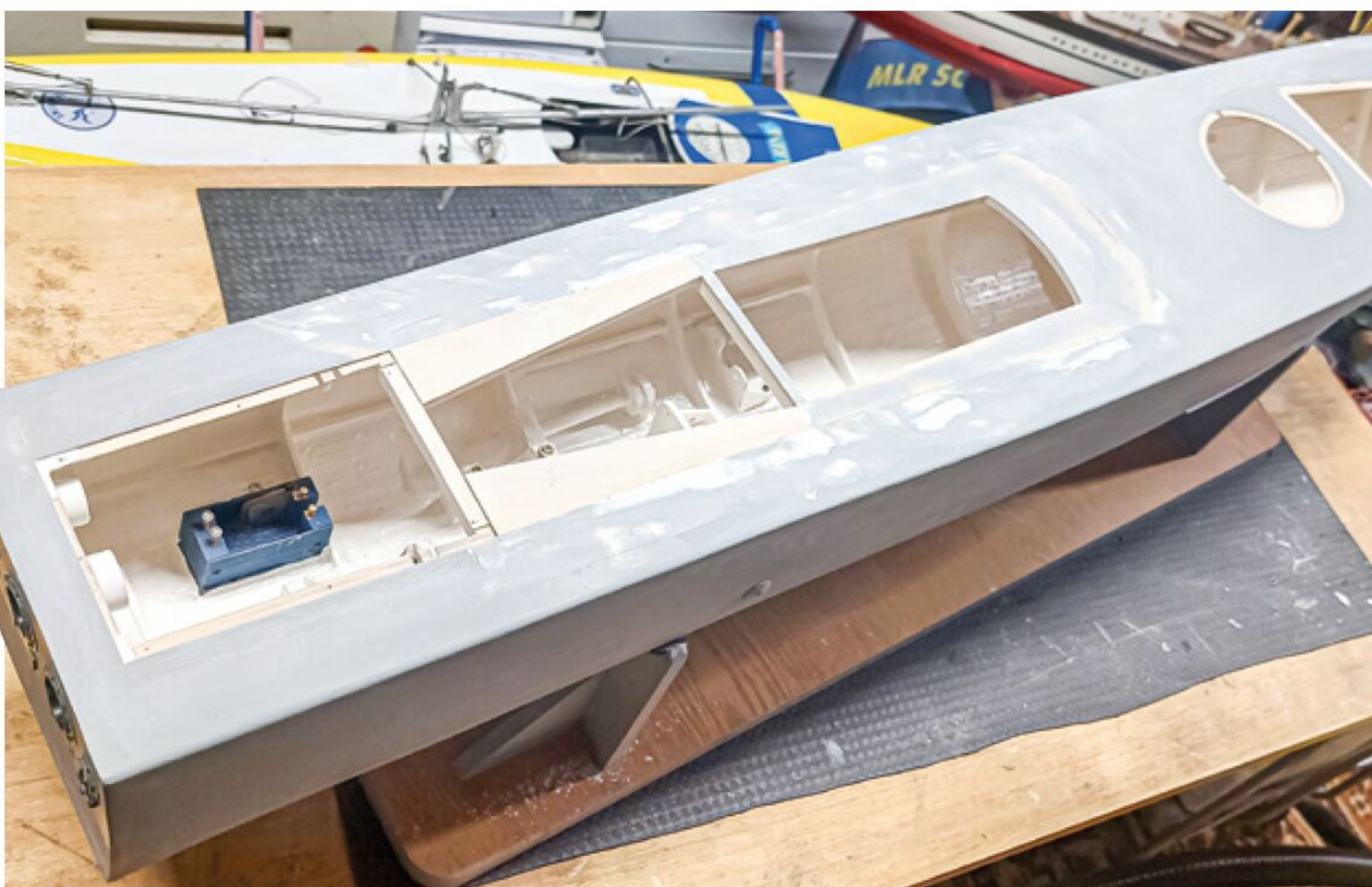
Das Oberdeckdeck mit allen zugänglichen Service- und Montagezugängen
