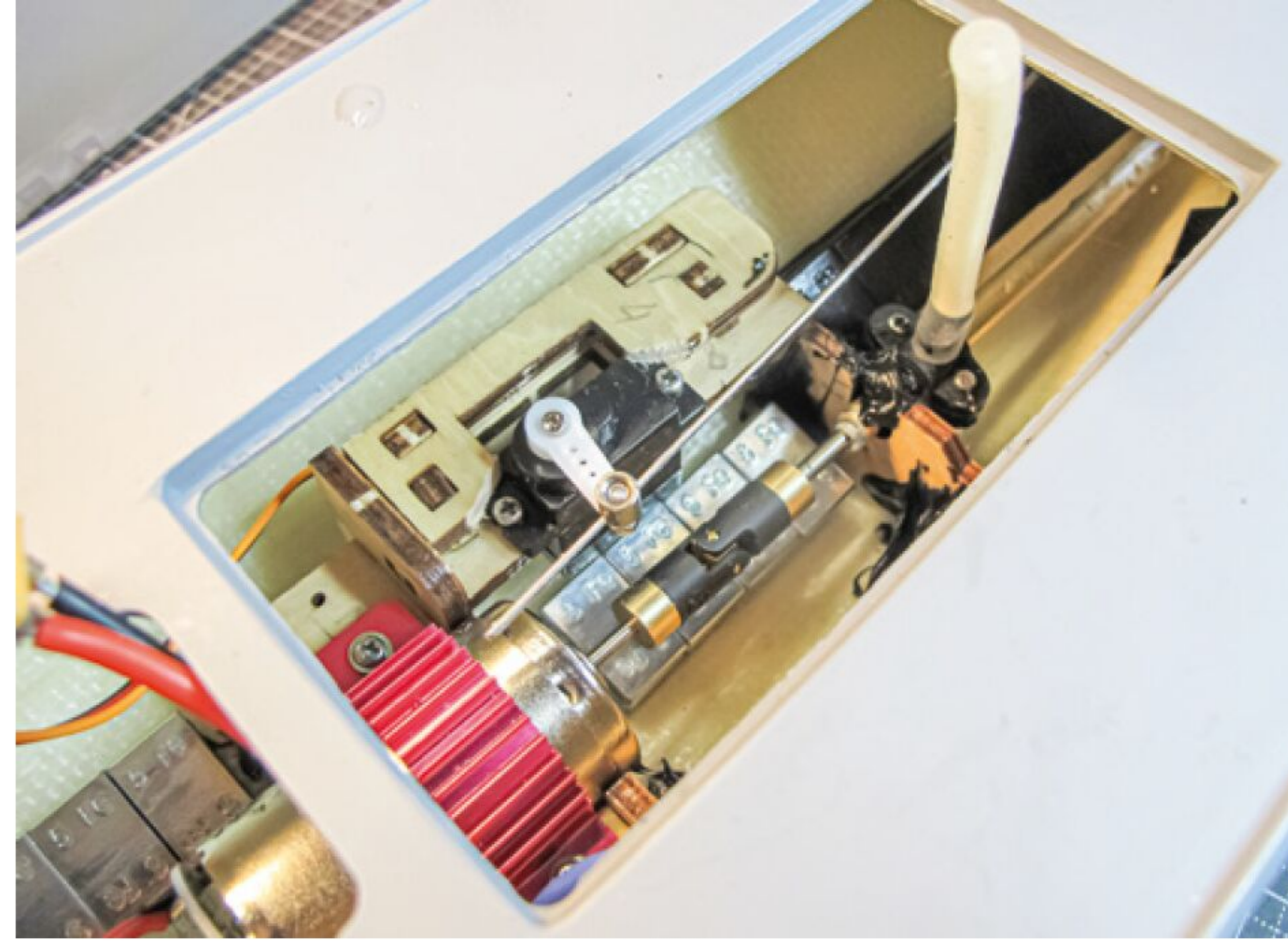
Der im Rumpf fertig installierte Technikträger
