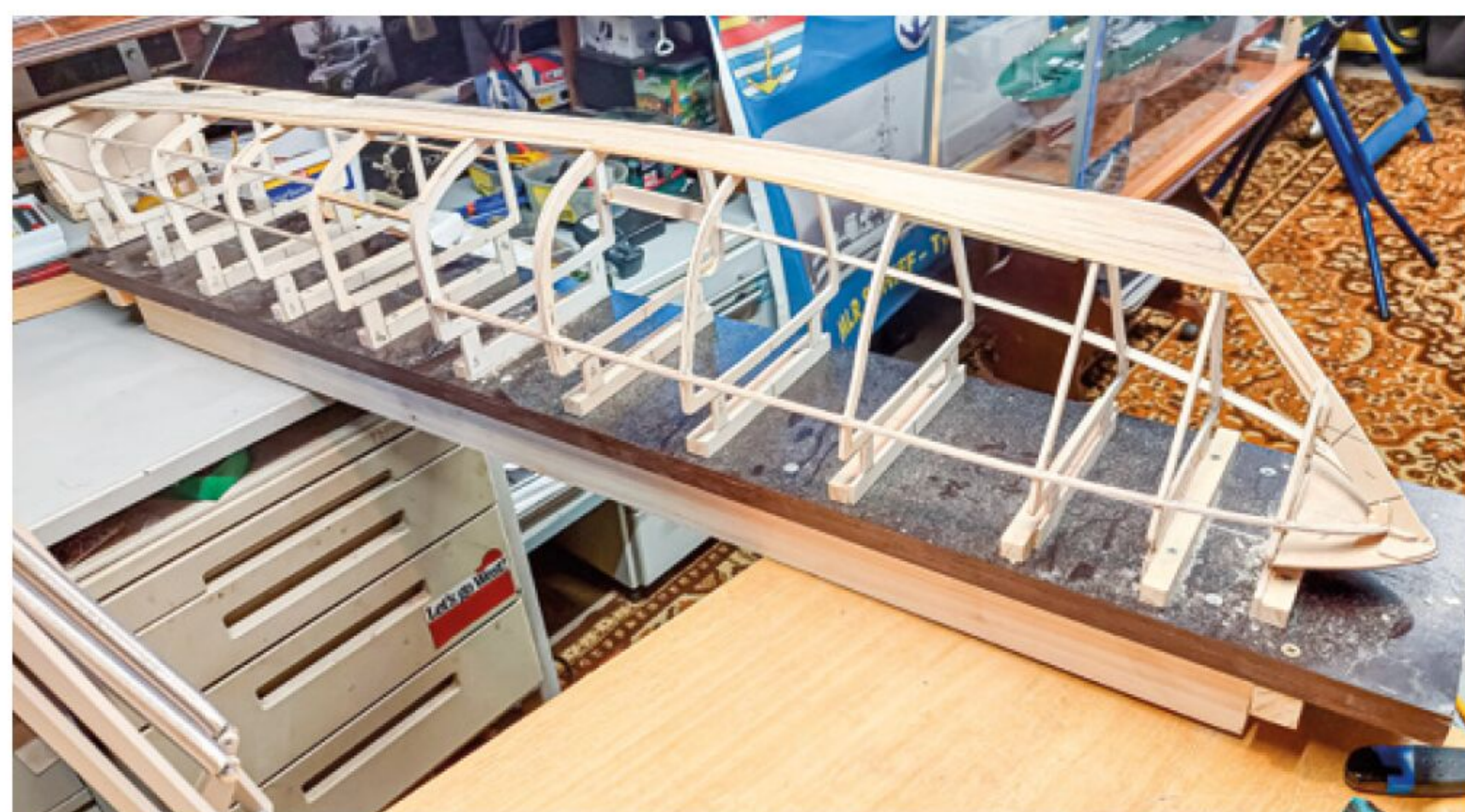
▲ Aufbau der 4 mm starken ausgesägten Spanten mit beginnender Beplankung ▲
