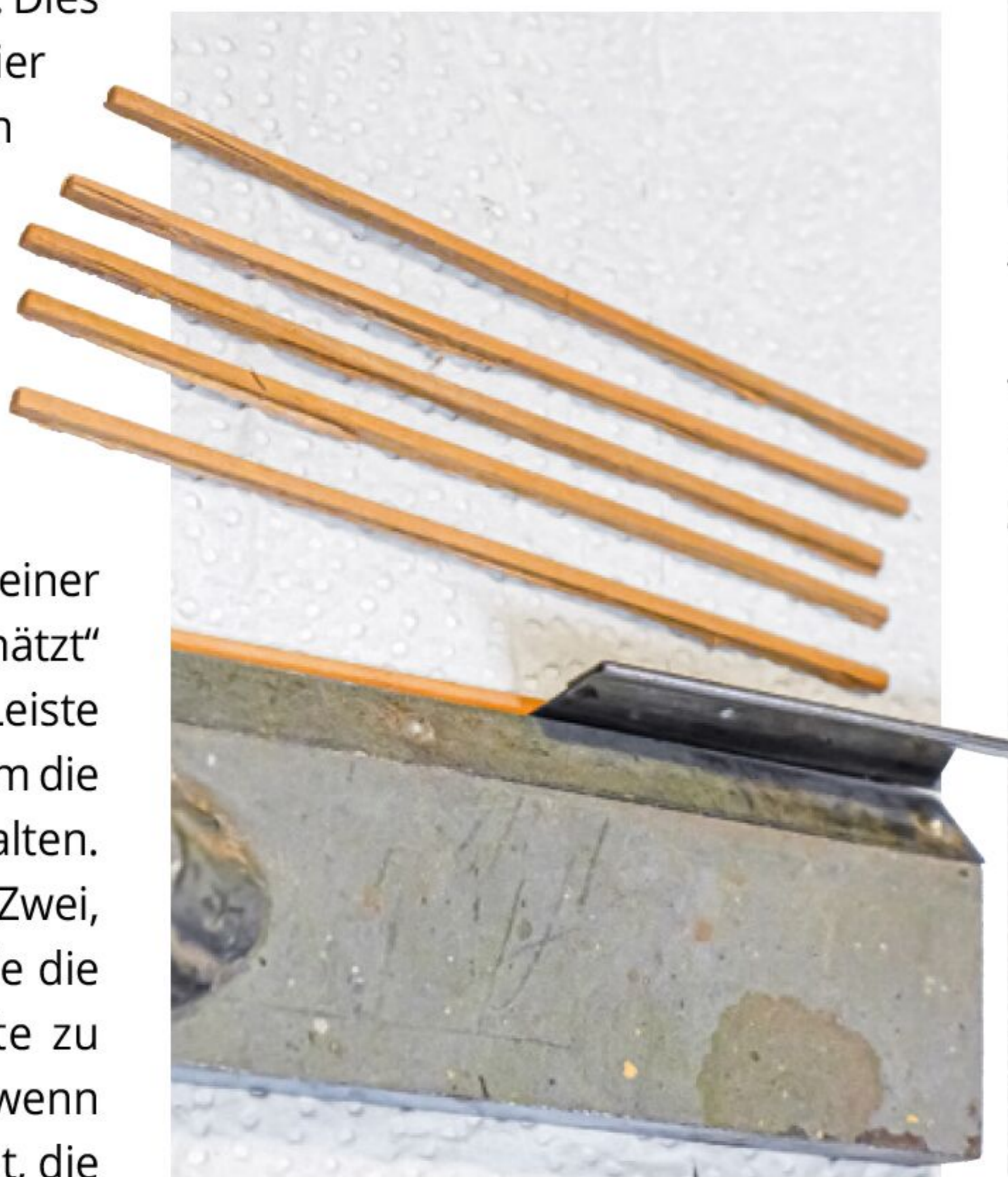
Einzelne Leisten werden gesägt. Die ungenaue Schnittkante muss nachgearbeitet werden
