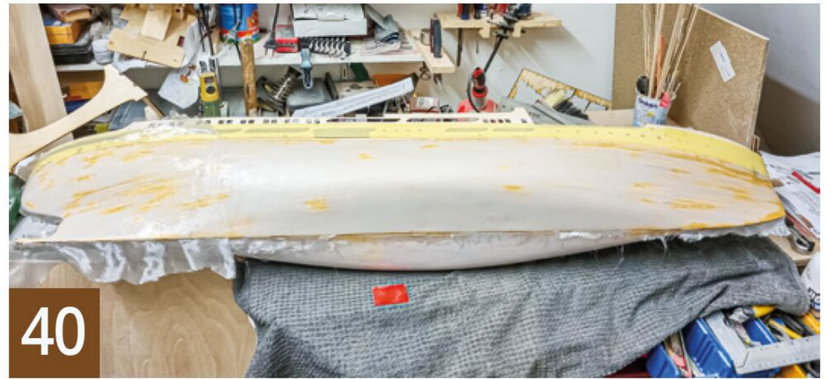
Der Rumpf wird laminiert
