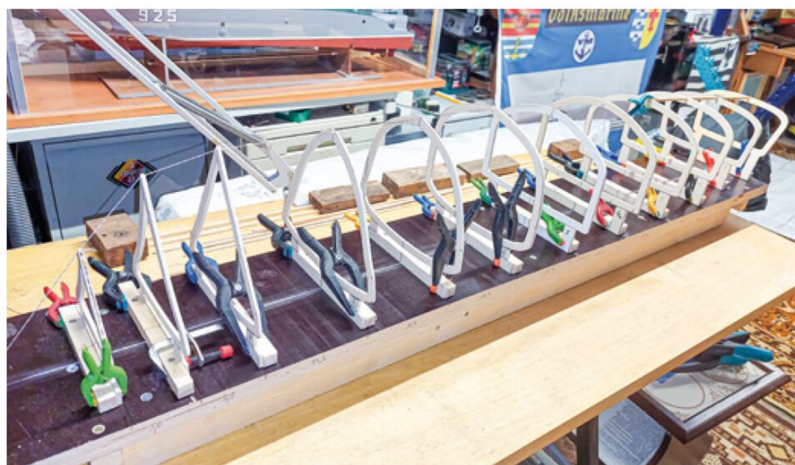
▲ Aufbau der 4 mm starken ausgesägten Spanten mit beginnender Beplankung ▲
