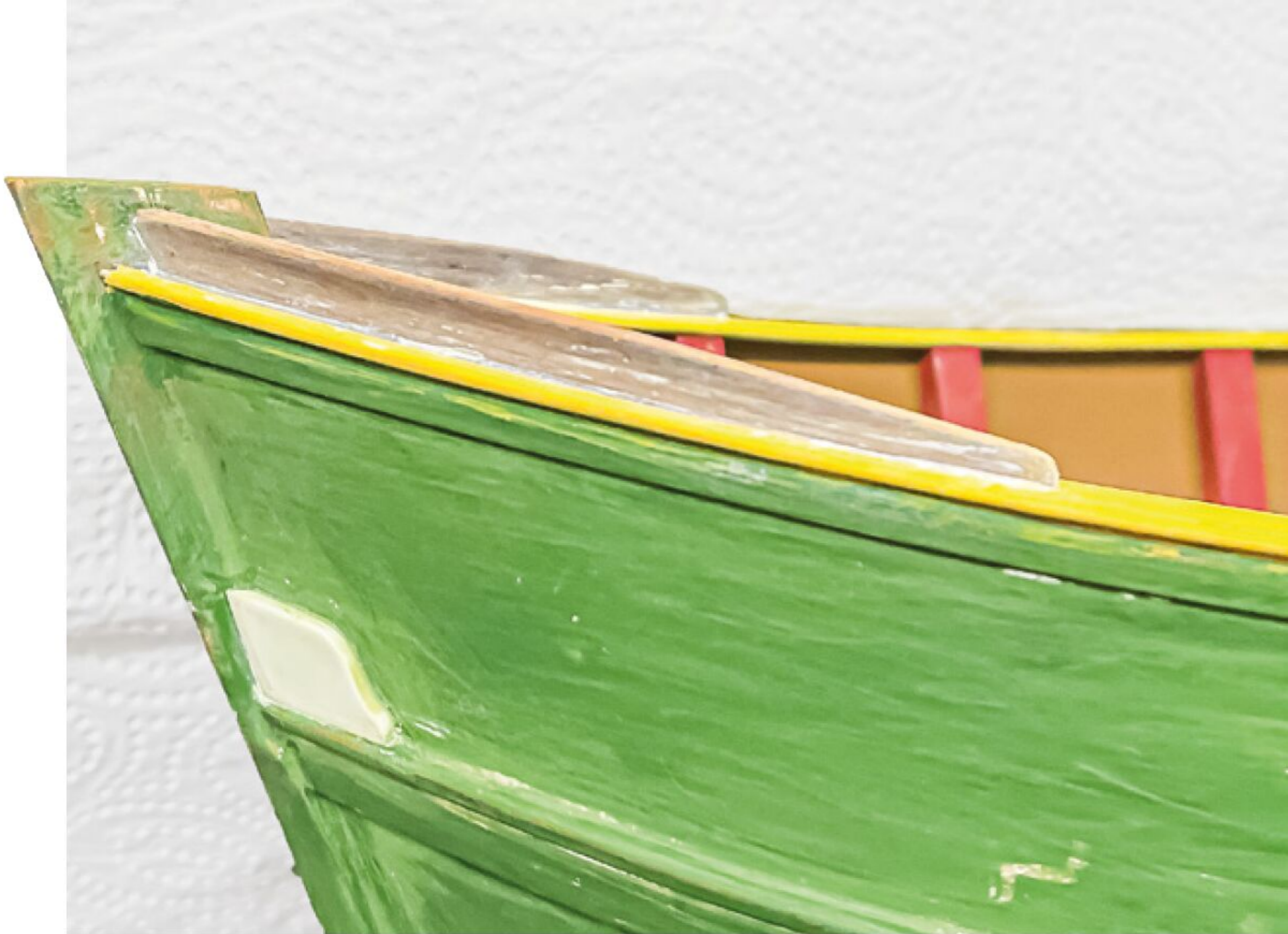
Verwendung der verjüngten Leisten als Wellenbrecher auf einem Modellschiff
