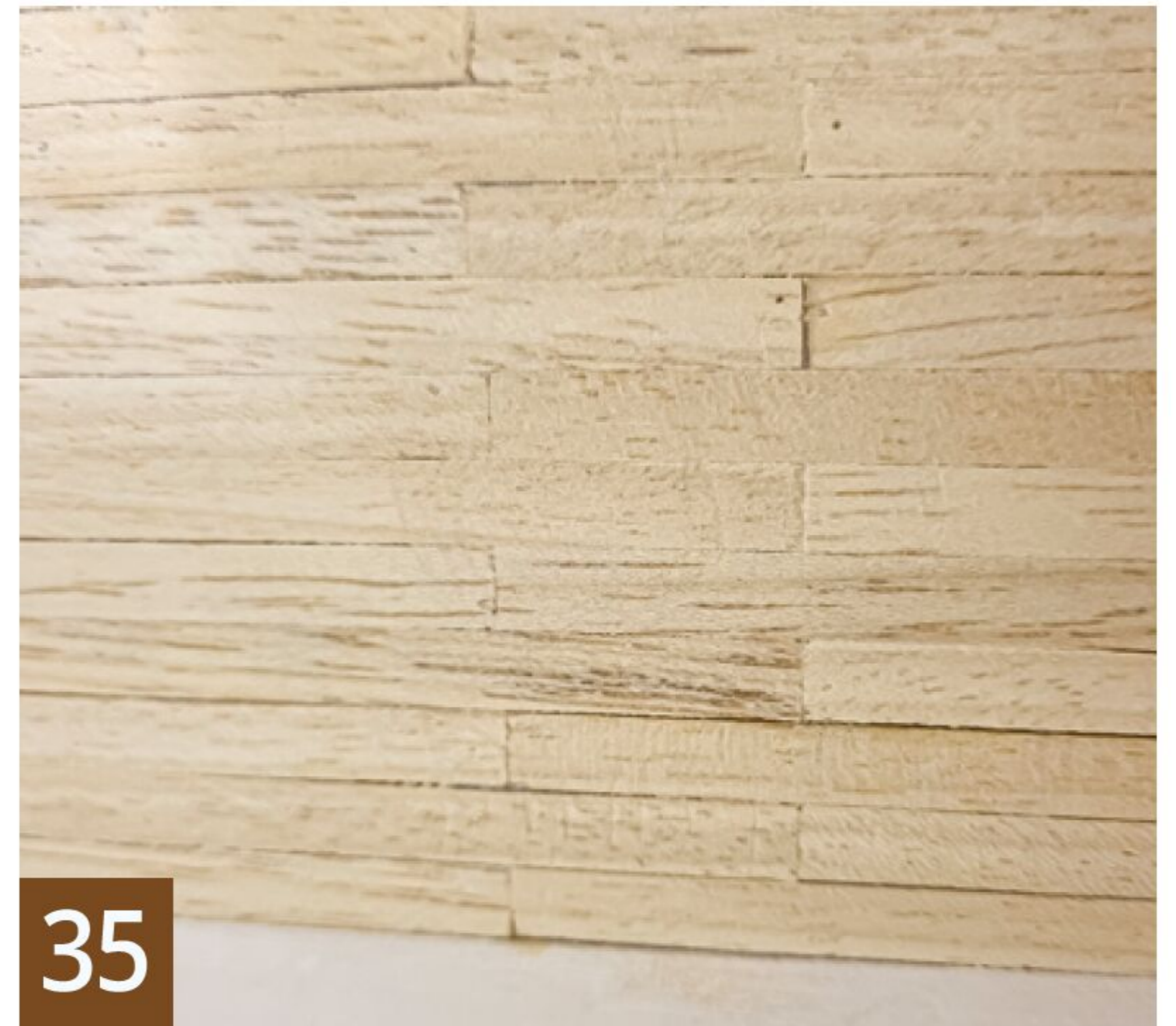
Rumpfbeplankung mit versetzten Stößen
