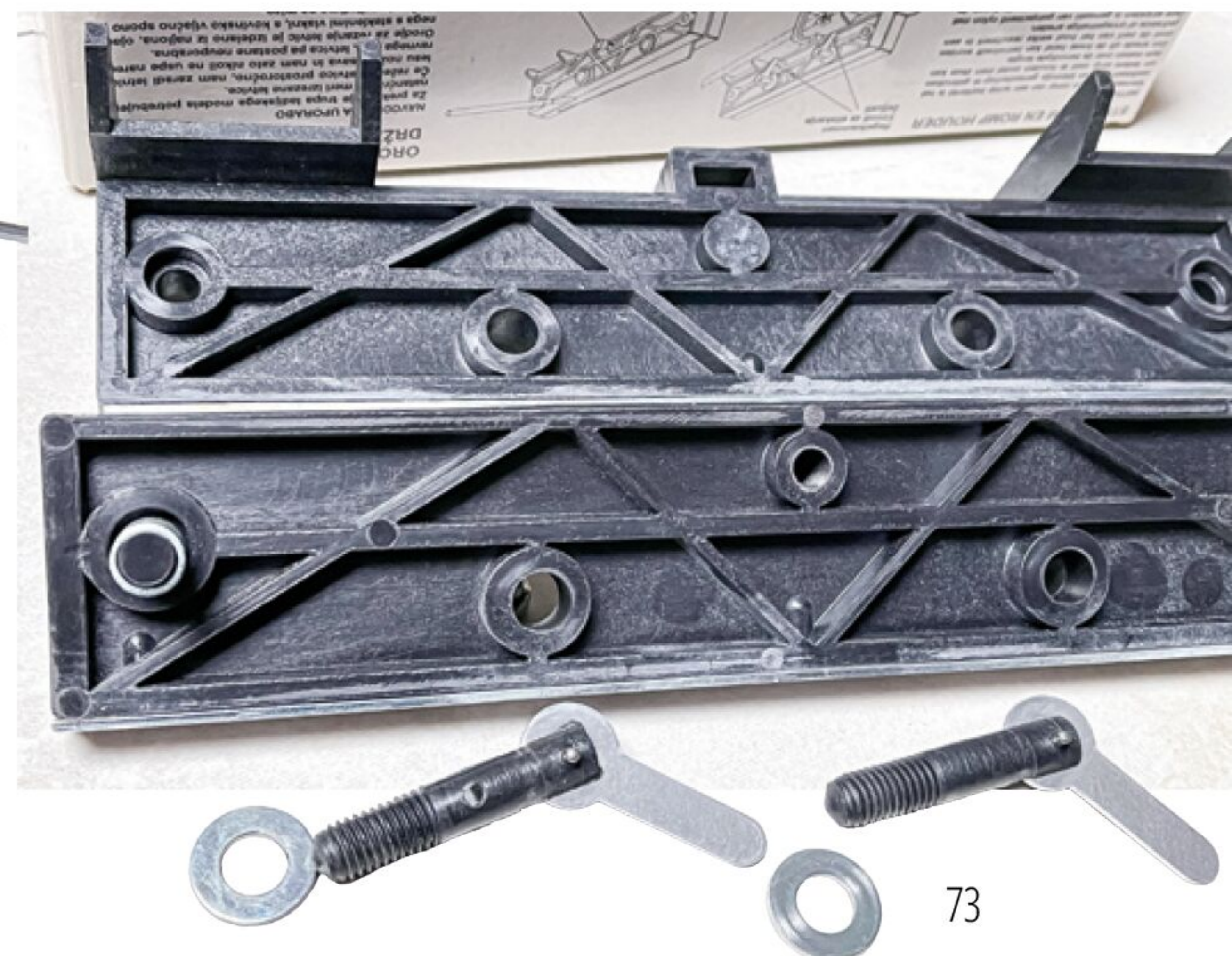
▼ Leistenboy zerlegt, links auf dem Führungsstift eine der beiden Spiralfedern
