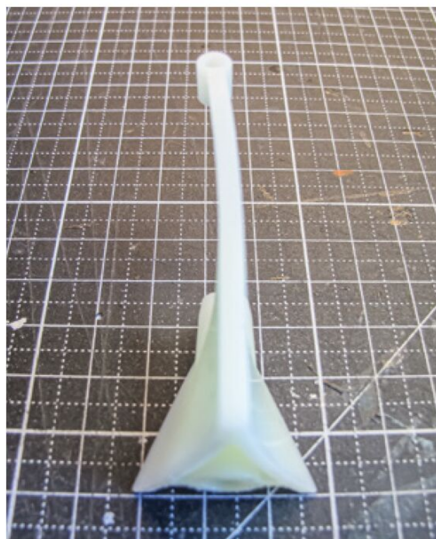
Das Heckteil mit Ruderlager war etwas verzogen, ließ sich aber einfach richten
