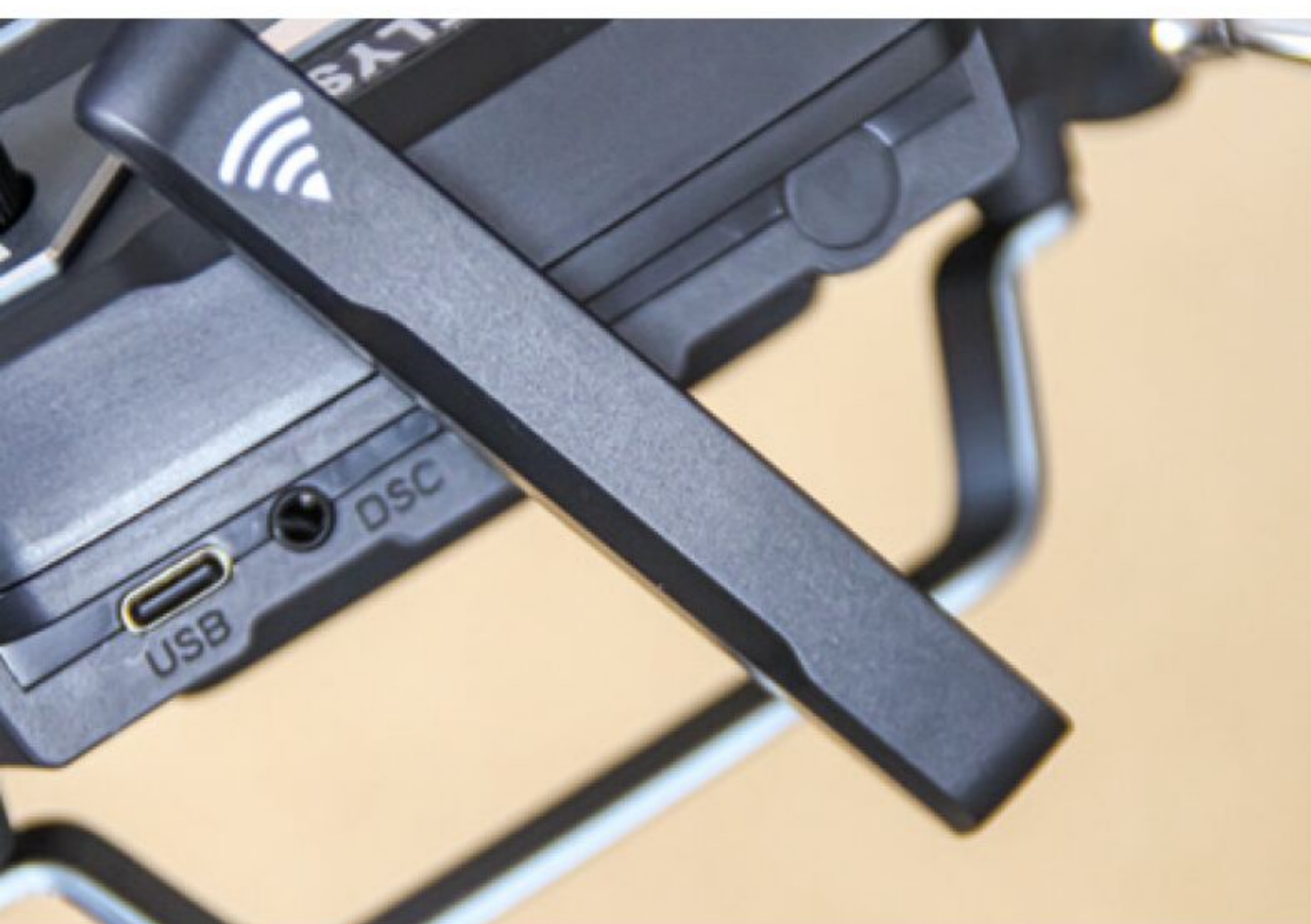
Die Klappantenne kann je nach Modell (Flug oder bodengebunden) ausgerichtet werden
