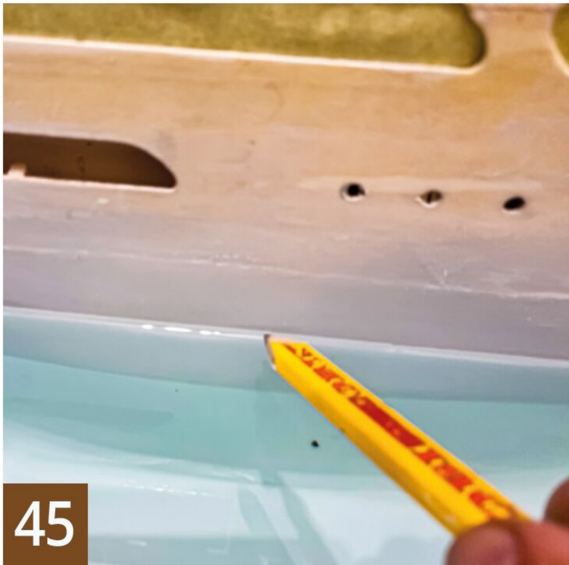
Nach dem Austrimmen wird die Wasserlinie markiert
