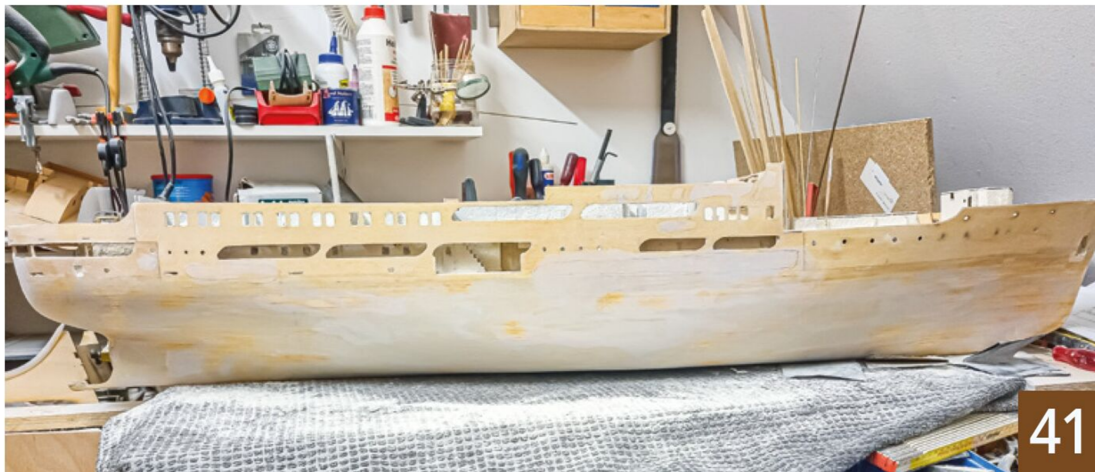
Rumpf nach stundenlangem Nassschliff
