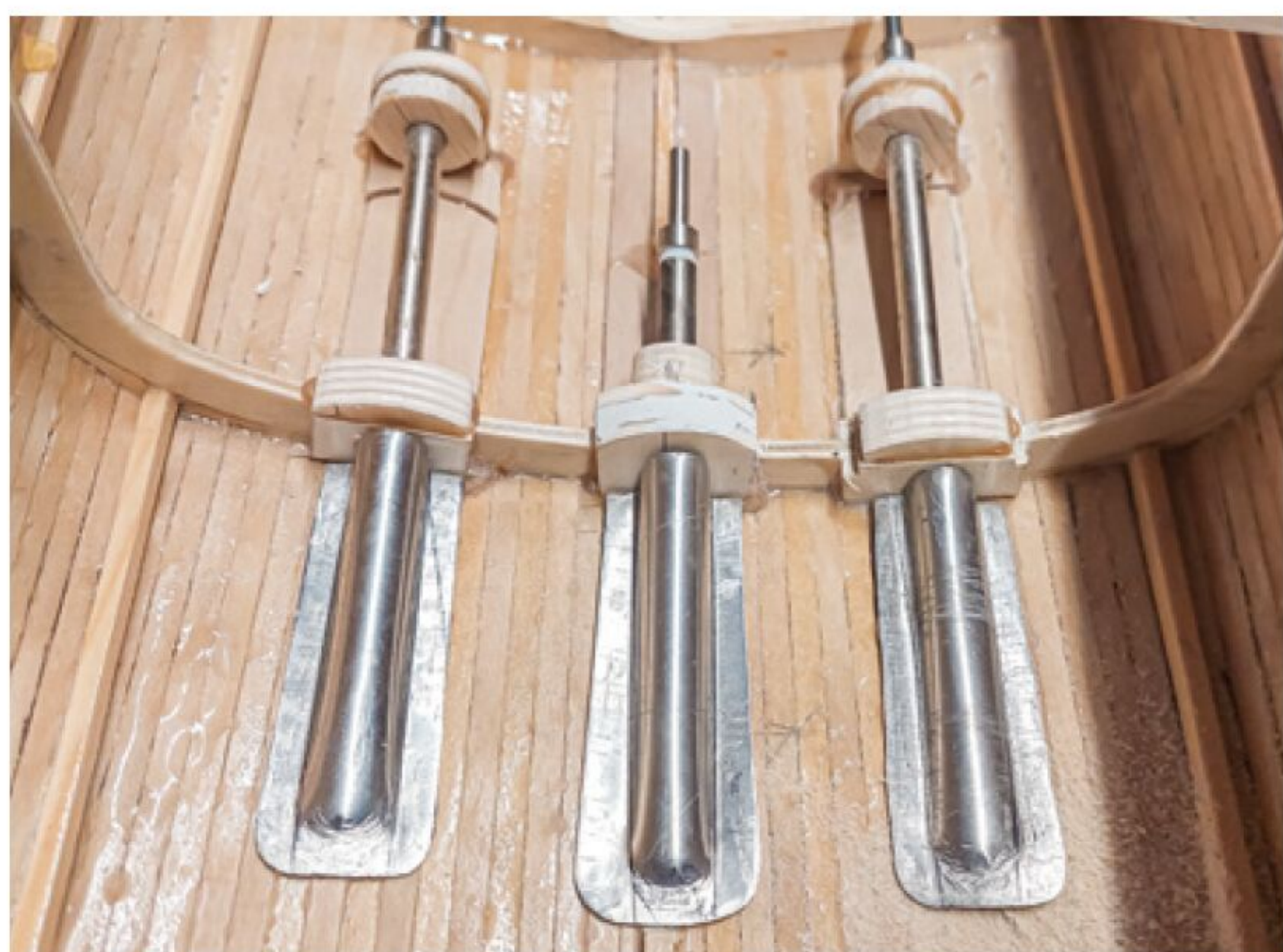
Einbau der drei Antriebswellen
