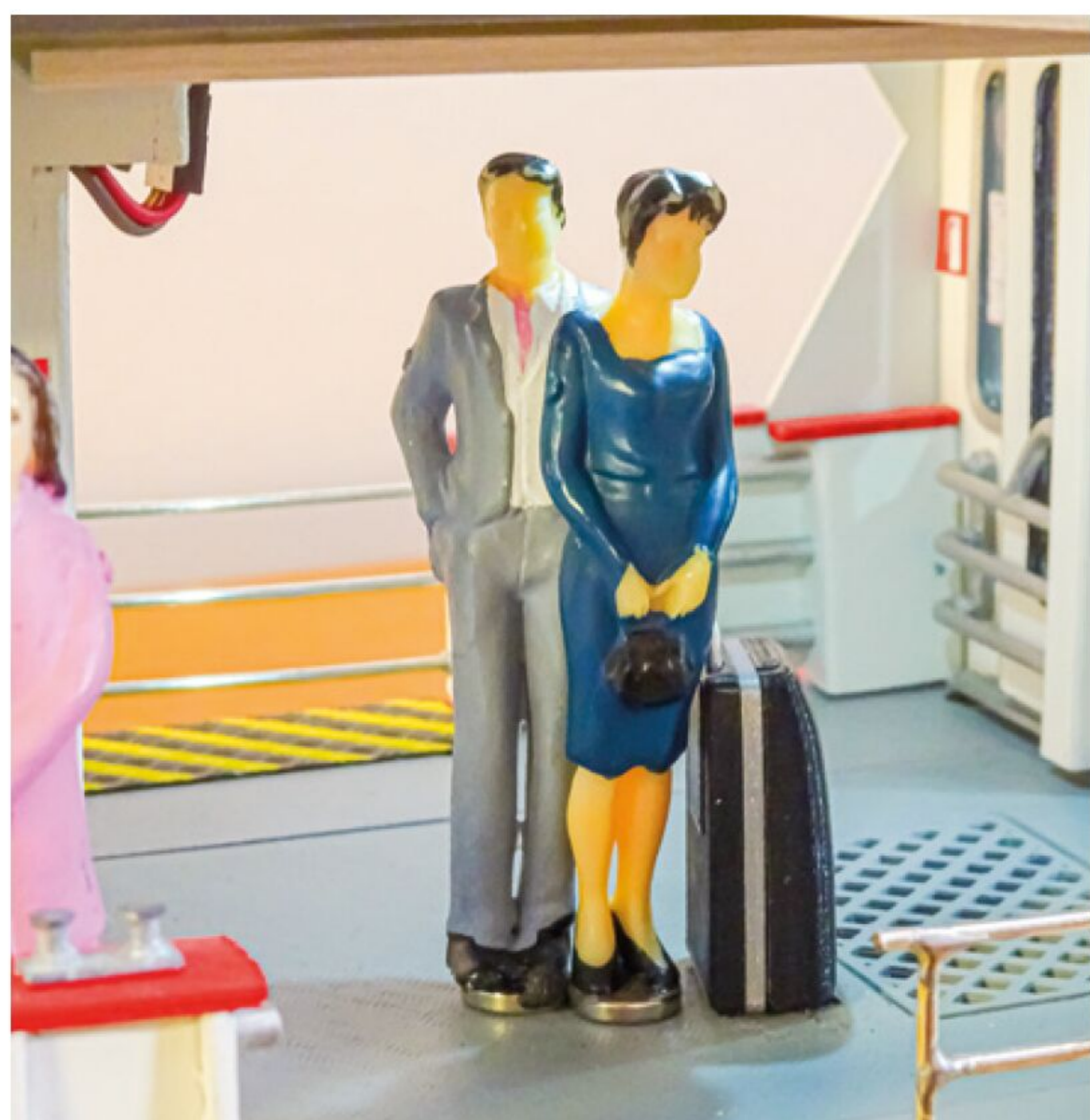
Bild 13: Über den Touristenkoffer wird das Boot ein- und ausgeschaltet
