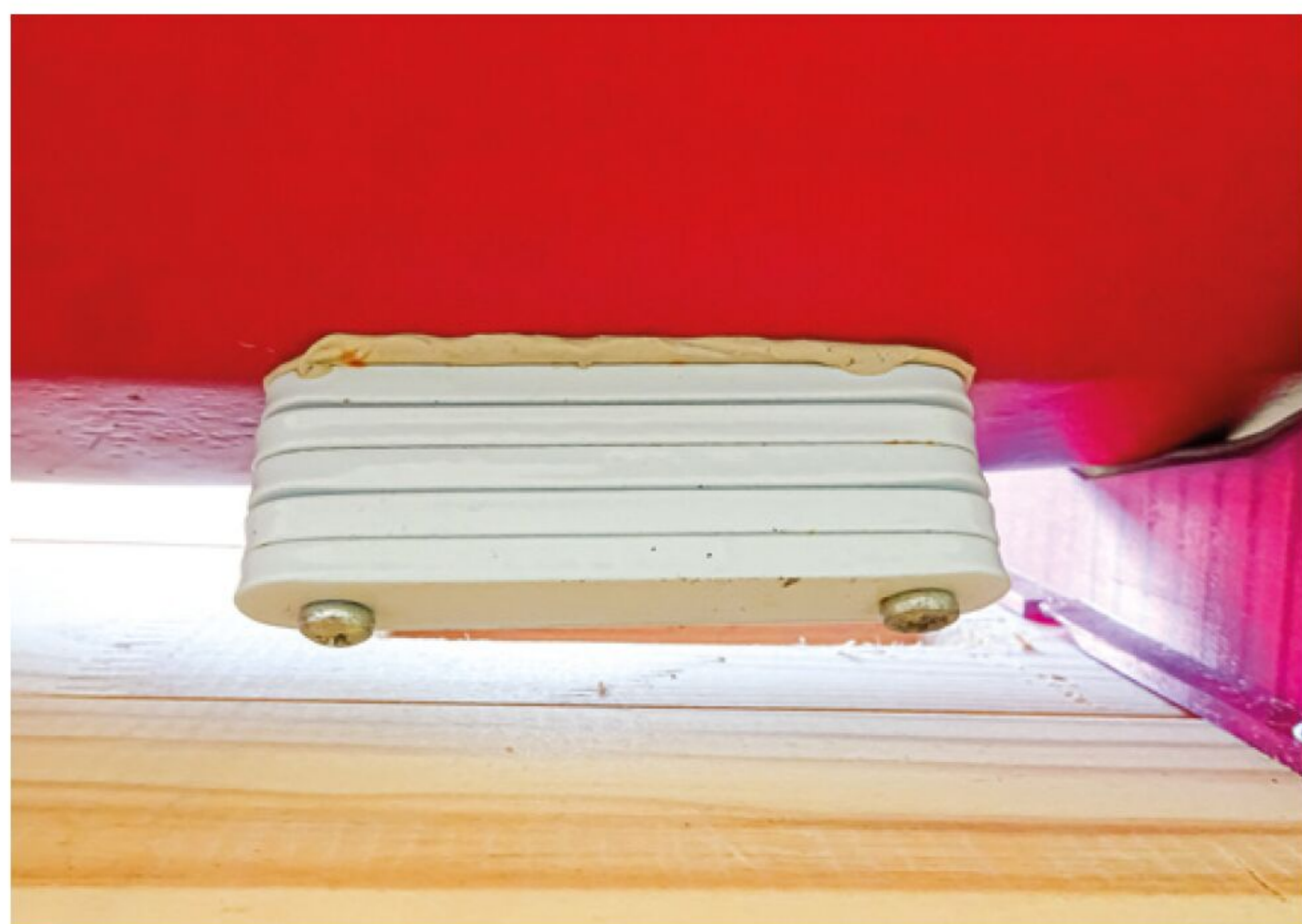
Bild 15: Externer Kiel aus Ballast-Platten
