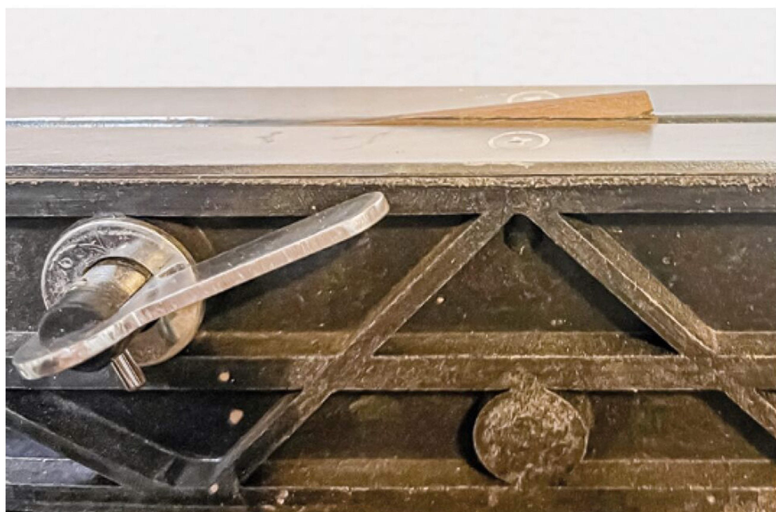
Zum Verjüngen wird die Leiste schräg eingespannt, zur Orientierung dient der Bleistiftstrich – man erkennt gut, dass der Bolzen des Schnellspanners am Herausfallen ist
