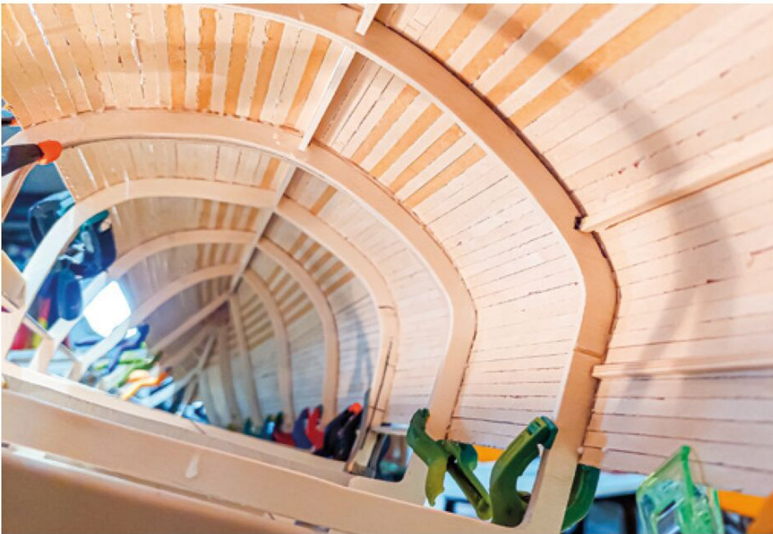
Die Beplankung des Rumpfes, vom Bootsinneren gut erkennbar
