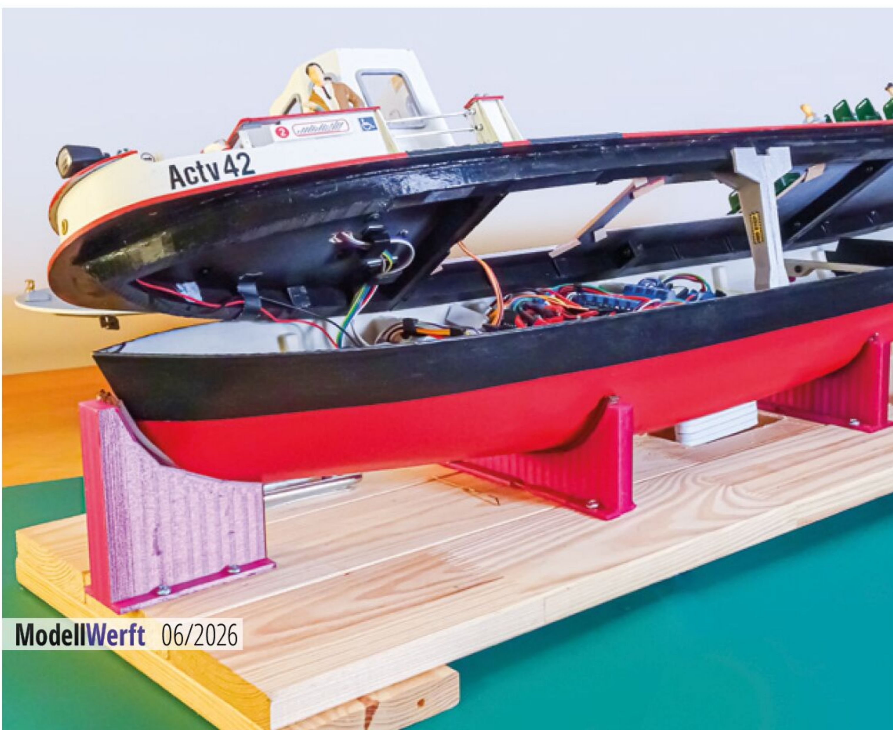
▲▼ Bild 25: Die Originalzugänge der Version 1, wie sie im Bausatz vorgesehen sind (oben). Durch das im Ganzen abnehmbare Deck bietet die Rumpfversion 2.0 (unten) hervorragende Zugänglichkeit
