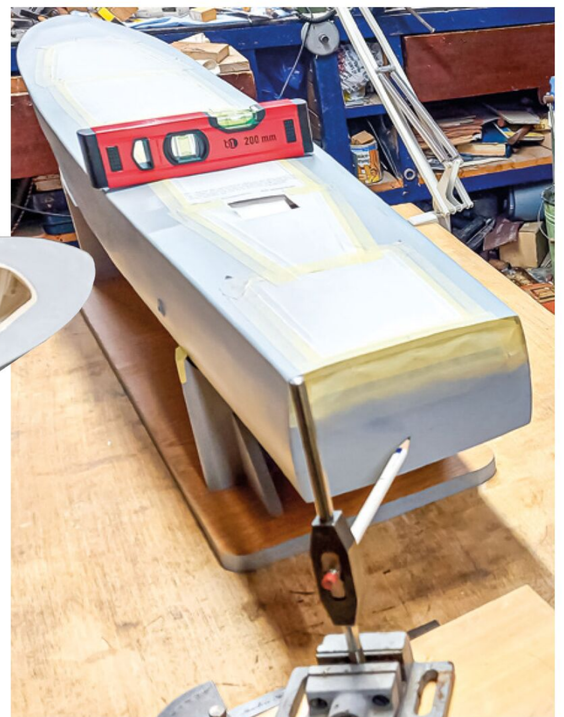
Markieren der Wasserlinie laut Zeichnung
