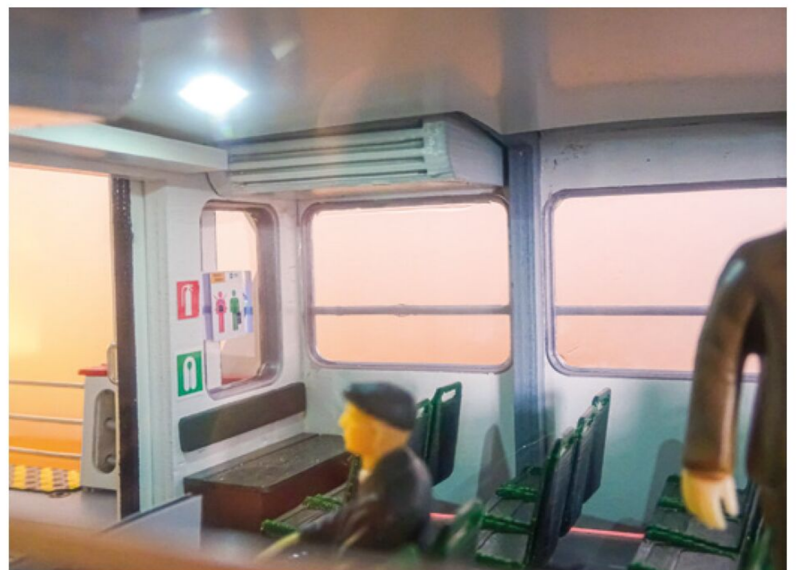
Bild 10: Nicht ganz vorbildgetreu: Die Klimaanlage als Versteck für die Beleuchtungsverdrahtung
