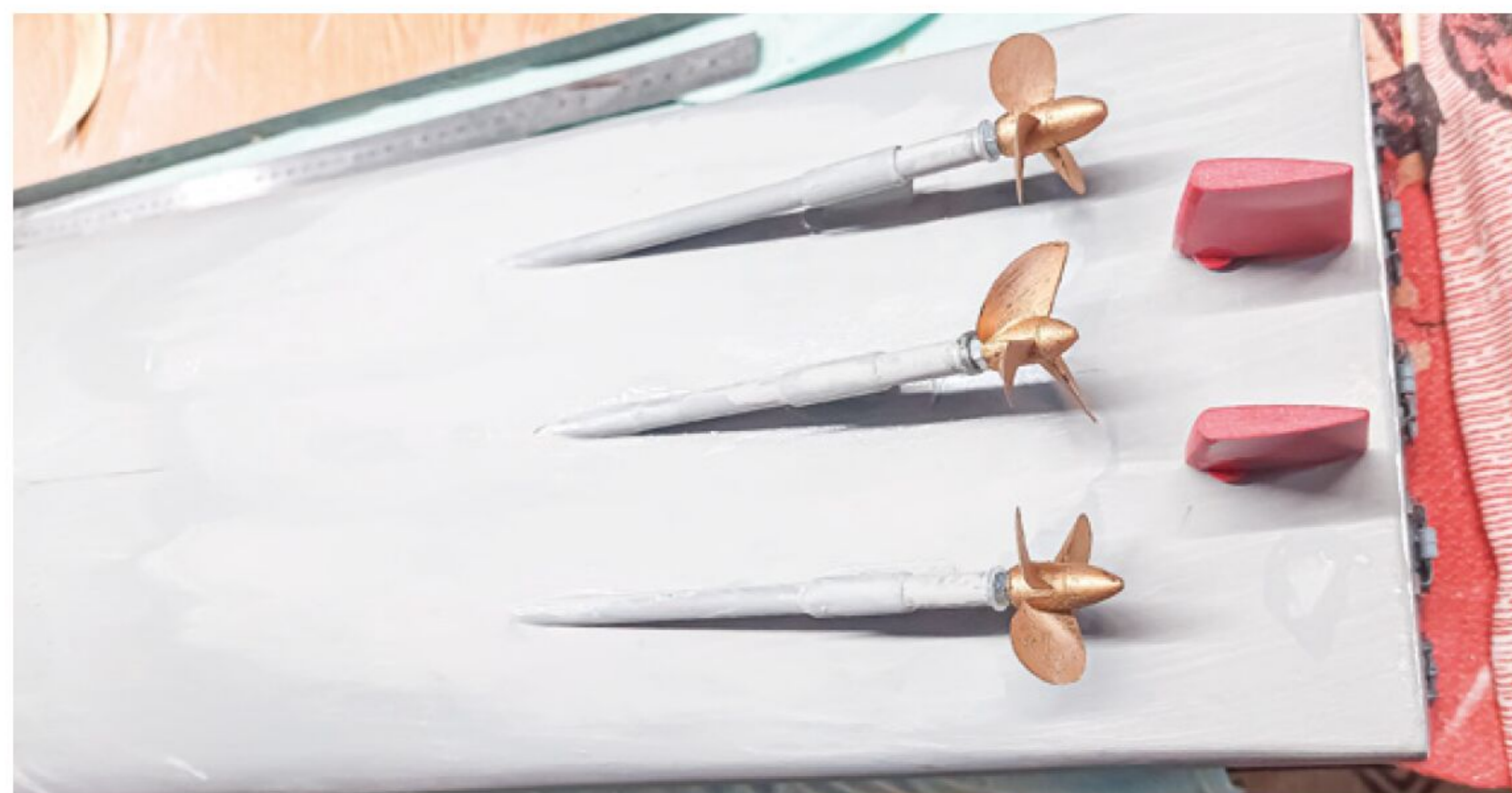
Anordnung der Ruderblätter und der Schiffsschrauben auf der Rumpfunterseite
