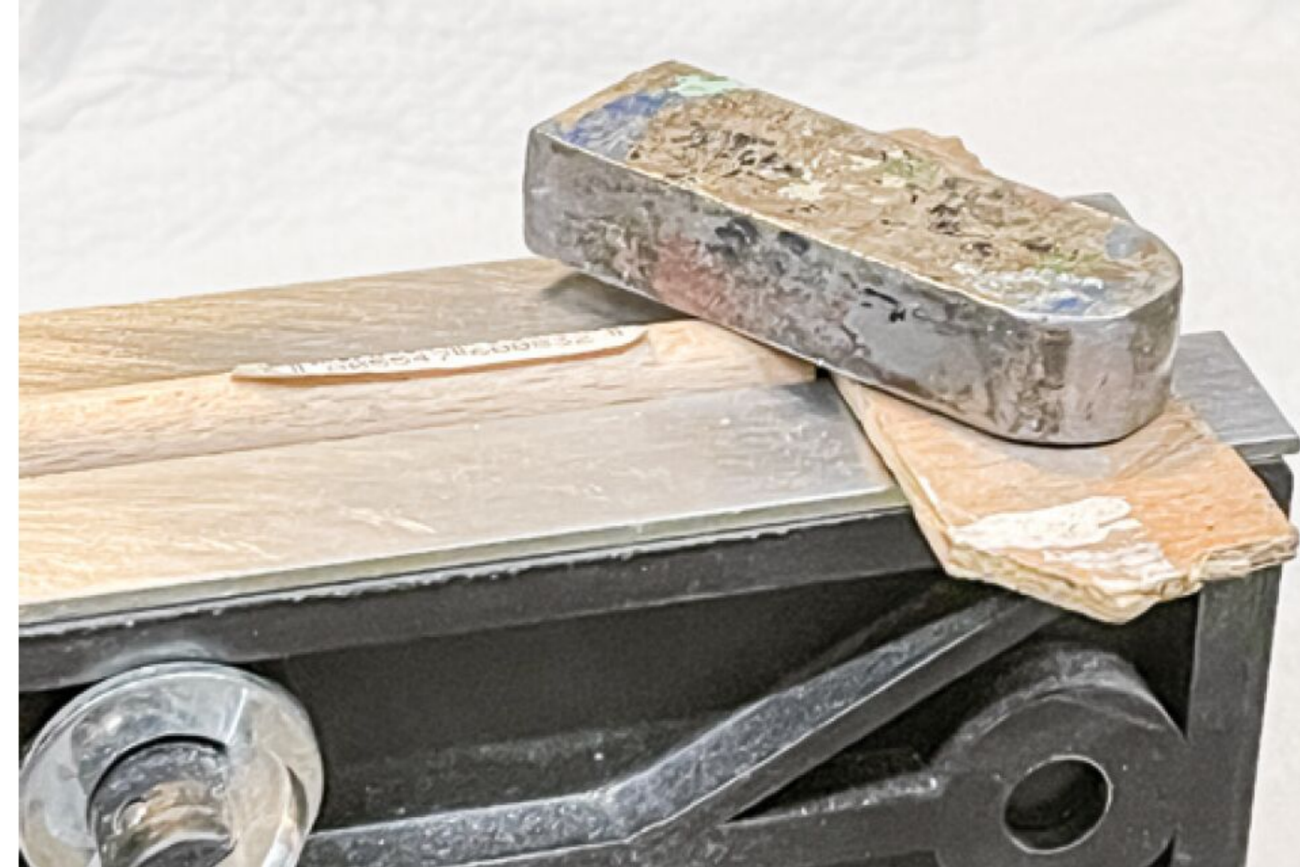
Schräg eingespanntes Rundholz mit Abstandshalter (Brettchen)
