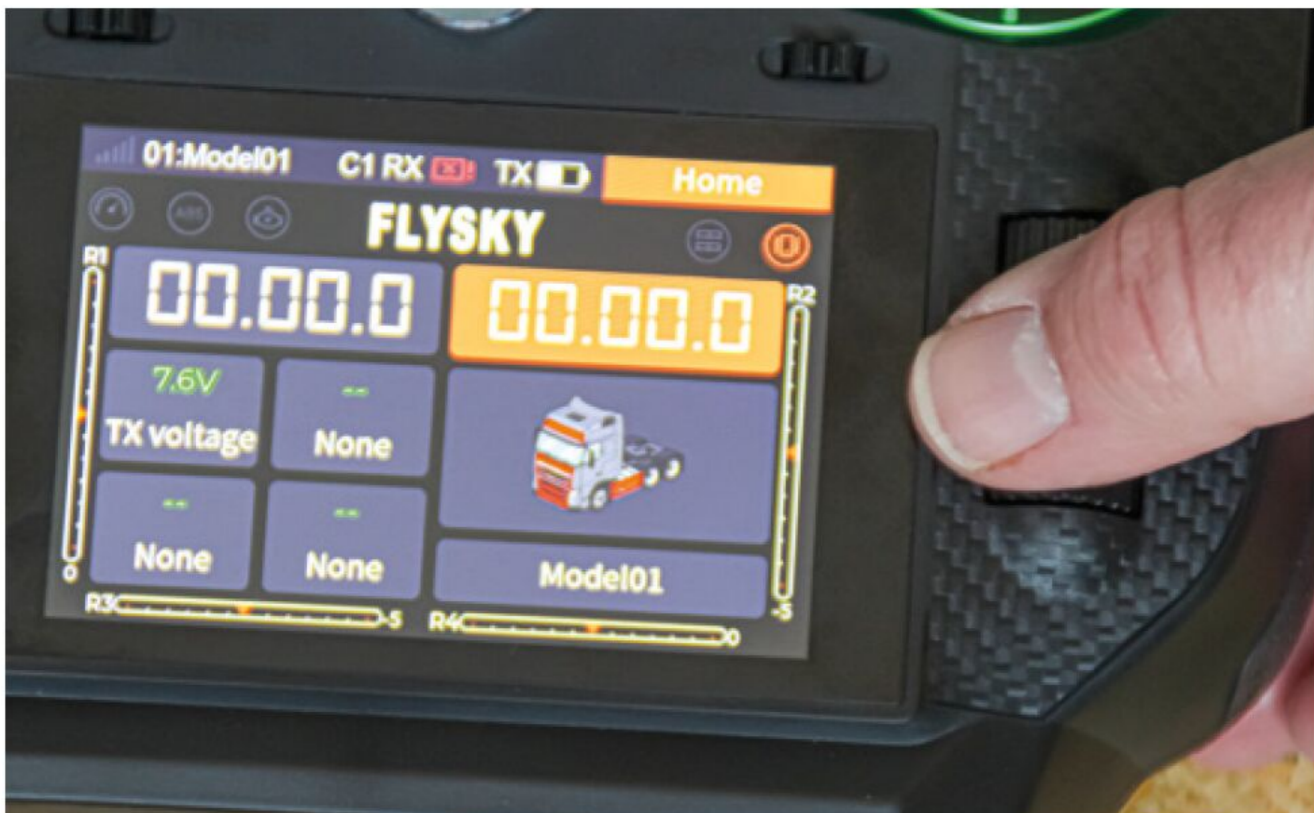
Auf dem Farbdisplay werden die jeweiligen Punkte klar dargestellt, ausgewählt wird mittels Walze rechts daneben
