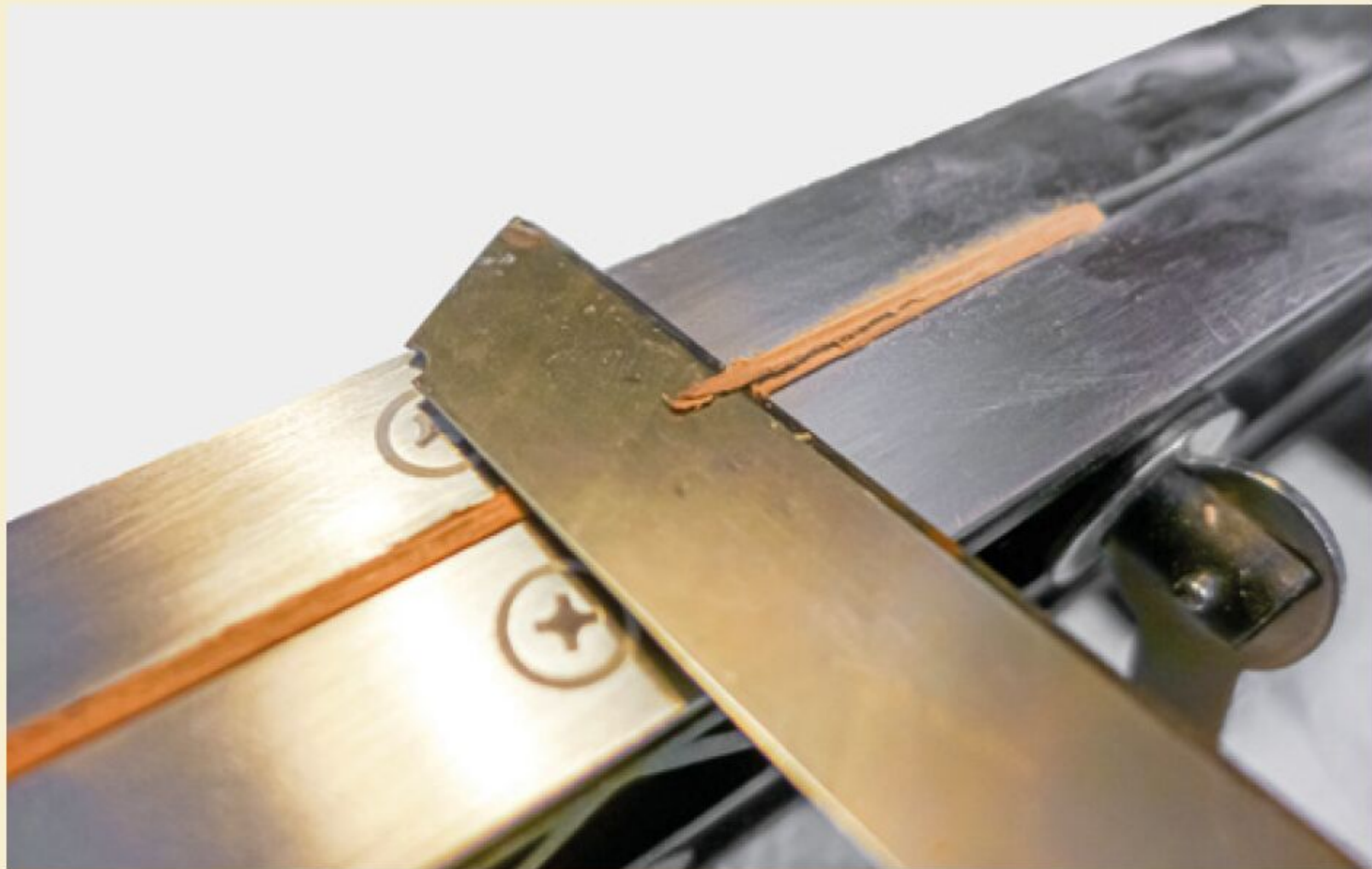
Überstehendes Material kann zwar mittels Cuttermesser abgeschnitten werden, aber es besteht die Gefahr, dass wie hier die Leiste einreißt, wenn die Maserung ungünstig läuft
