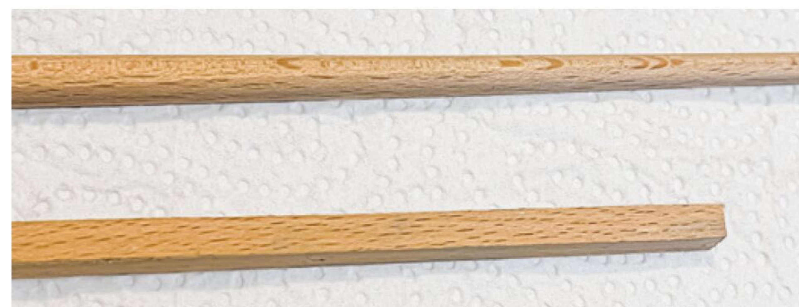
Fertiger Vierkant, der zum Achtkant gefeilt und auf der Bohr- oder Drehmaschine verrundet werden kann
