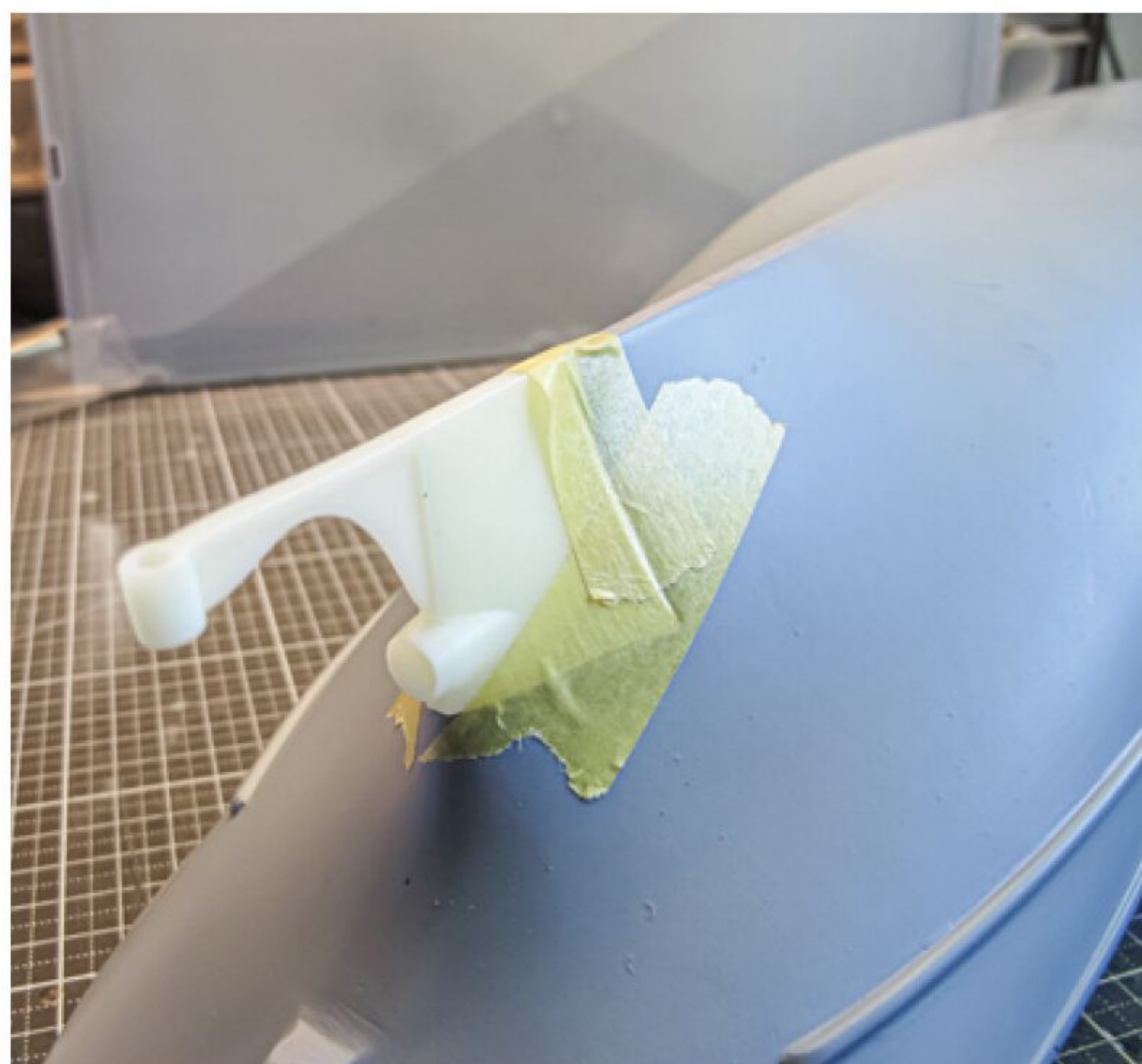
Einbau der Ruderhacke
