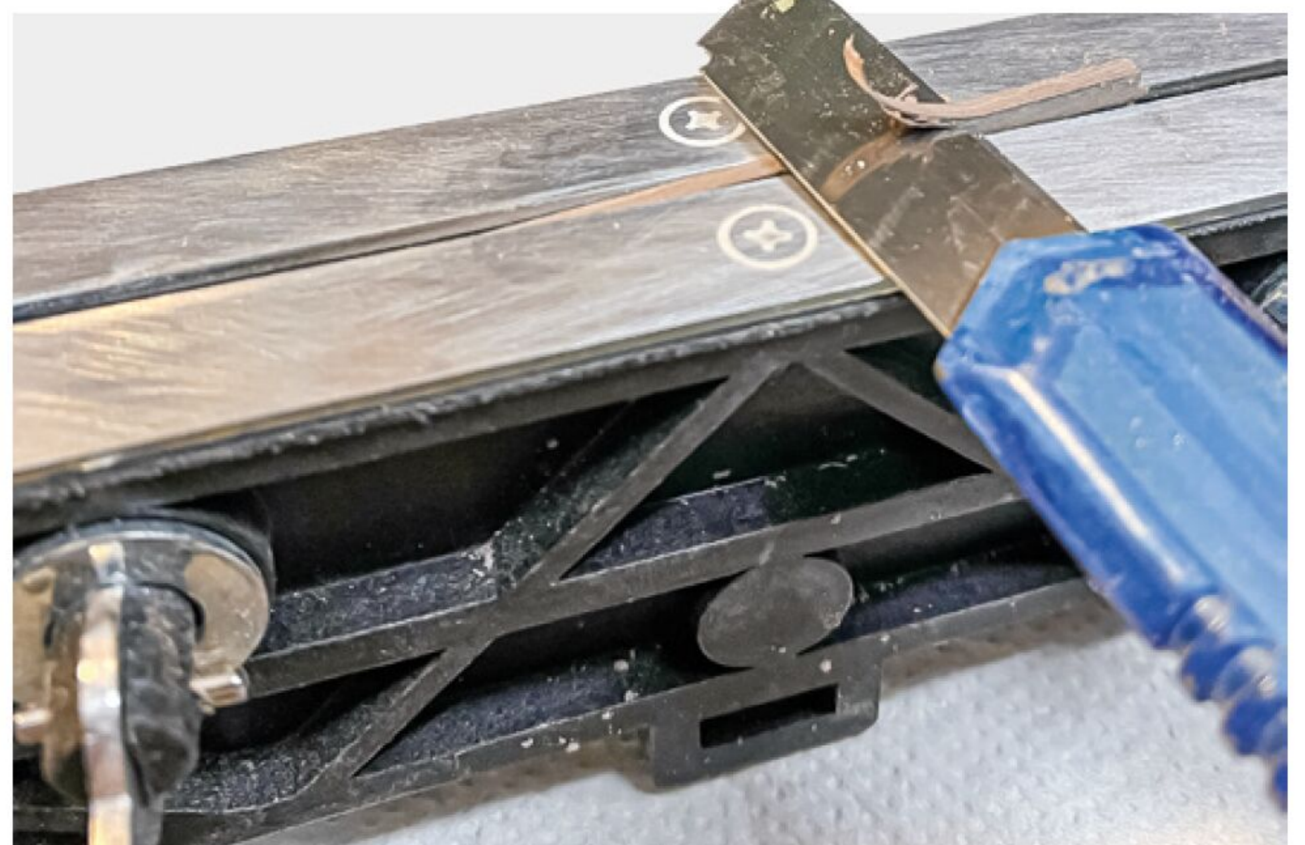
Mit dem Cuttermesser wird das überstehende Holz grob abgetragen
