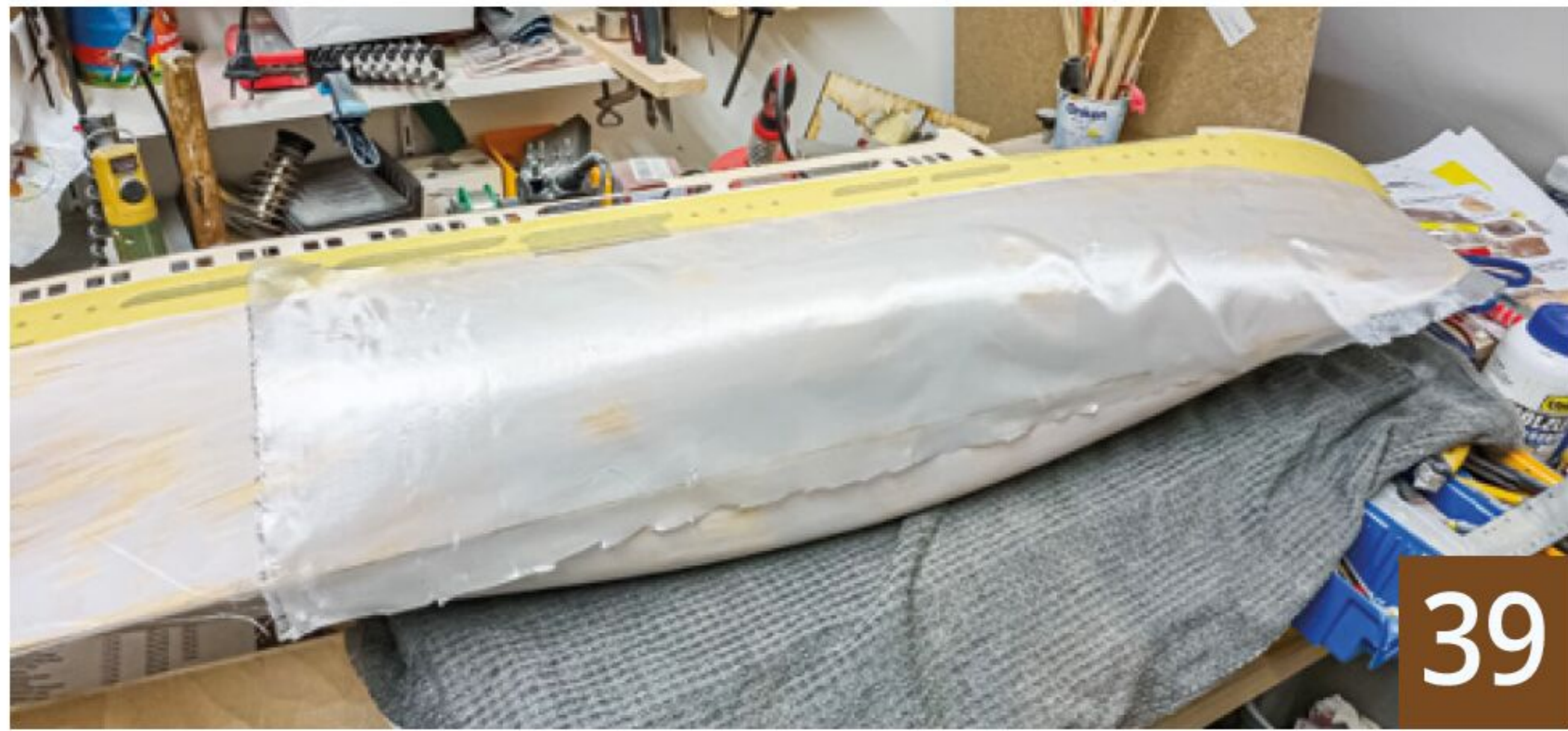
Glasfaserplatten überlappend auf dem Rumpf positioniert
