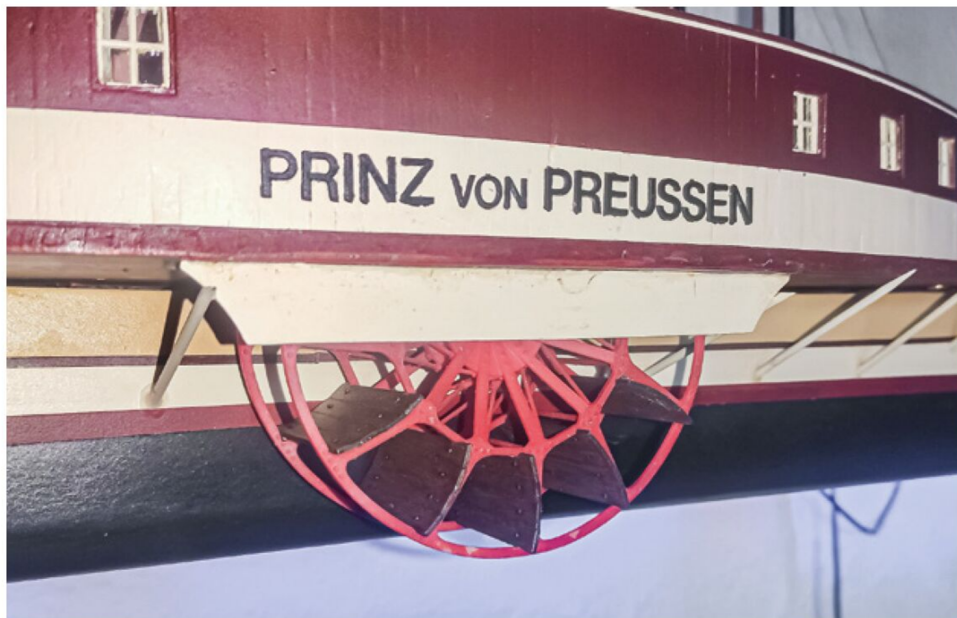
Die Räder des Prinz von Preussen haben Schaufeln aus Holz
