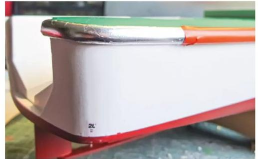
Aluminium an der Scheuerleiste
