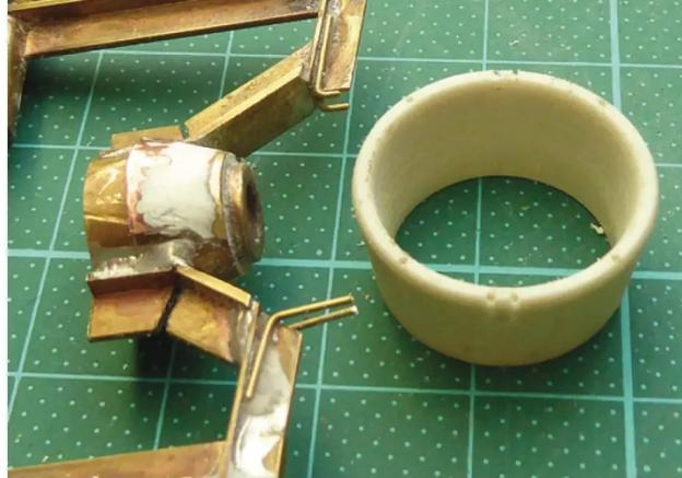
Der Ring für die Kortdüse. Zu erkennen sind die Bohrungen für die Haltestifte direkt zum Ruderblatt und diejenigen für die vier Haltearme
