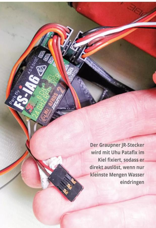
Der Graupner JR-Stecker wird mit Uhu Patafix im Kiel fixiert, sodass er direkt auslöst, wenn nur kleinste Mengen Wasser eindringen
