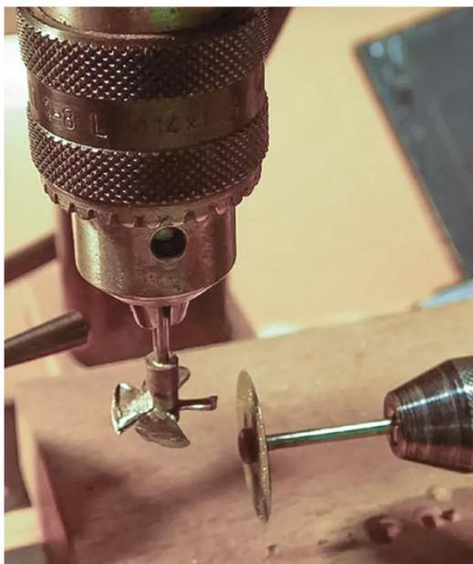
Der Propeller bei der Anpassung des Durchmessers
