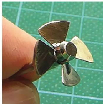
▲ Der fertige Propeller mit Nabe und Welle. Die Profilierung der Blätter ist zu erkennen ▲
