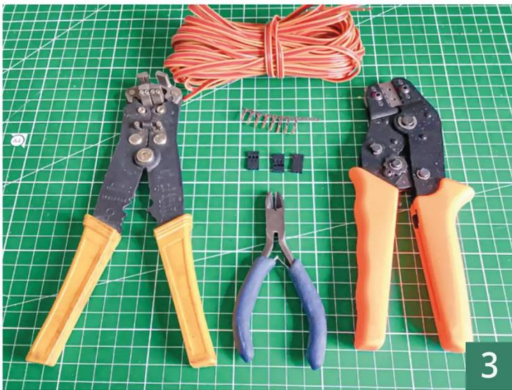
ist das Kürzen nicht einfach – schon gar nicht für Modellbau-Anfänger. Einfacher und wesentlich besser ist die Variante, Kabel zu kürzen und anschließend mit neuen Steckverbindern zu versehen. Standardmäßig sind das die von Servos bekannten JR-Stecker, die ein Raster von 2,54 mm haben. Bei wenig Platz gibt es aber auch Steckverbinder mit einem Raster von 1,25 mm. Diese lassen sich mit den richtigen Materialien und Werkzeugen auch in der Verkabelung verwenden.
