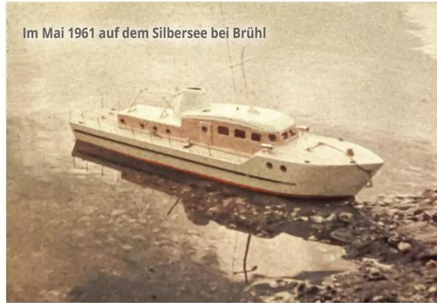
Ihre Seitenwände könnten mit Mahagonifurnier aufgewertet werden, ebenso das Deck mit schmalen Mahagonileisten. Da der angenommene Maßstab etwa bei 1:25 lag, wären 40 mm hohe Relingstützen mit Handläufen aus Messing die richtige Wahl für die neue Reling. Praktisch kein Holzteil müsste damit zu ersetzen sein. Die Untersuchung ergab auch den an für sich erstaunlichen Befund, dass sich nach über 60 Jahren das Balsaholz in einwandfreiem Zustand befand.
