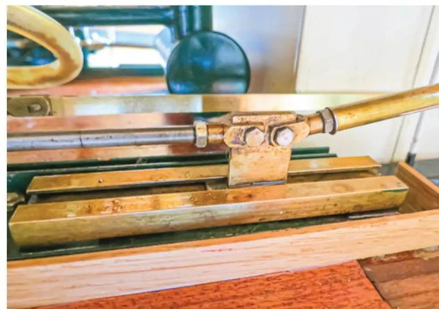
▼ Kraftübertragung auf das Schaufelrad
