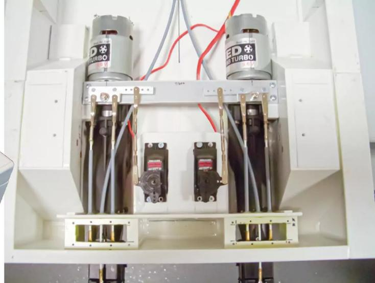
Die beiden Kehrer Jetantriebe komplett mit Motor, Seitenansteuerung und Schubumkehr
