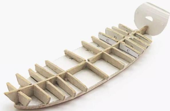
Das rund 8 cm lange Spantengerippe liegt auf einer Lage Balsaholz. Das Balsa soll später das Unterwasserschiff andeuten. Der Heckspiegel mit Hennegatt und Öffnungen für die Sorgleinen des Ruders ist angebaut
