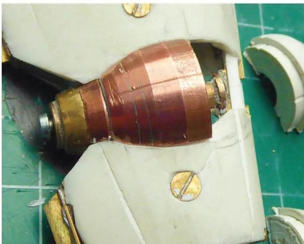
Ein Rohr-Teil ist am Ruderblatt angepasst. Oben ist das Blatt schon für die Nase ausgefräst. Unten ist ihr Verlauf markiert
