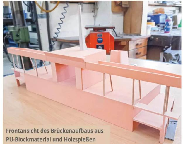
Frontansicht des Brückenaufbaus aus PU-Blockmaterial und Holzspießen
