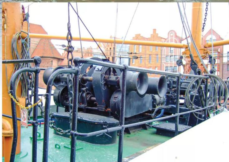
Eine Ladewinde zwischen dem vorderen, torartigen Lademast
