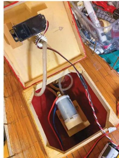
**Bild 12:** Pumpe und Dreheinheit für die Löschanlage
