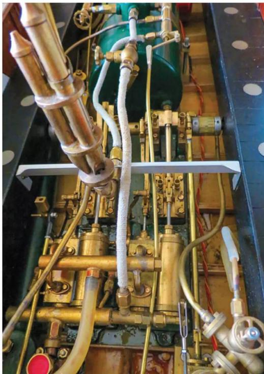
Dampfmengeventil, vom Servo angesteuert
