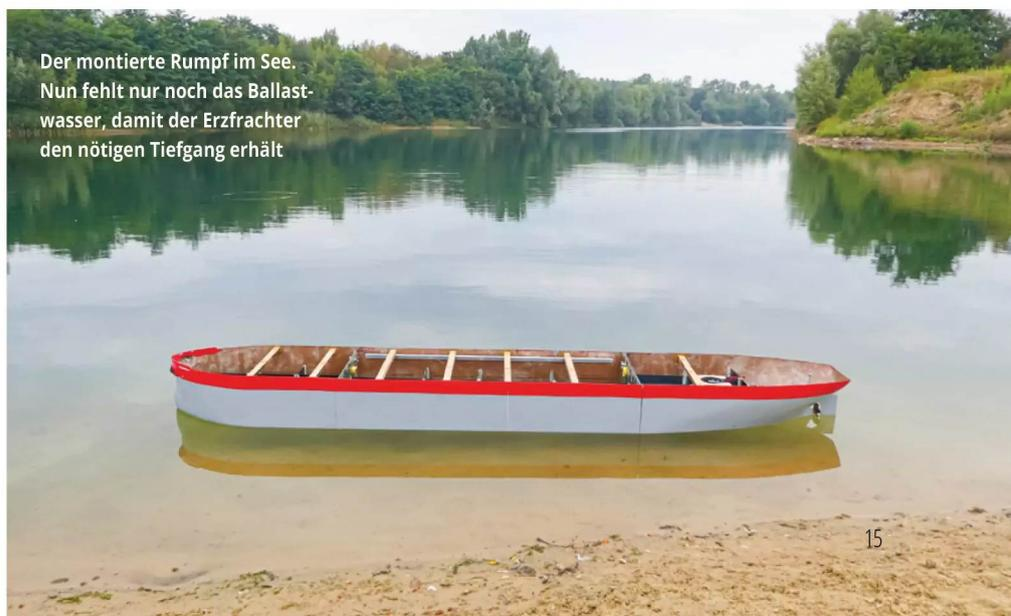
Der montierte Rumpf im See. Nun fehlt nur noch das Ballastwasser, damit der Erzfrachter den nötigen Tiefgang erhält
