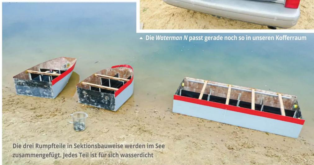
Die drei Rumpfteile in Sektionsbauweise werden im See zusammengefügt. Jedes Teil ist für sich wasserdicht
