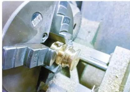
Drehen der Ankerwinden aus Messing
