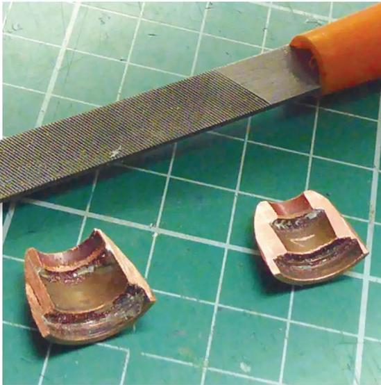
Zwei Teile des Rohrstücks werden angepasst. Man erkennt die sich nach hinten verkleinernden Durchmesser der bei der Herstellung benutzten Rohrstücke
