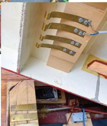
▶ Bild 19: Über Messingplättchen wird die Kabine mit Strom versorgt
