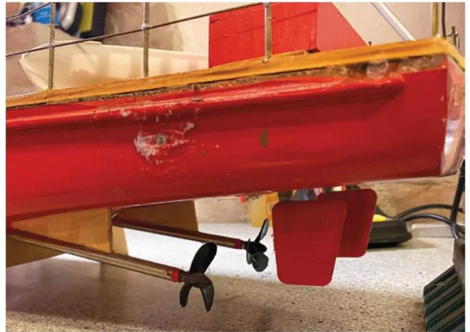
**Bild 4:** Ablösungen, Risse und Löcher werden grob repariert
