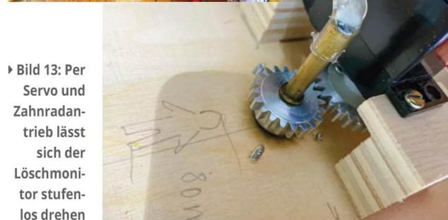
**Bild 13:** Per Servo und Zahnradantrieb lässt sich der Löschmonitor stufenlos drehen
