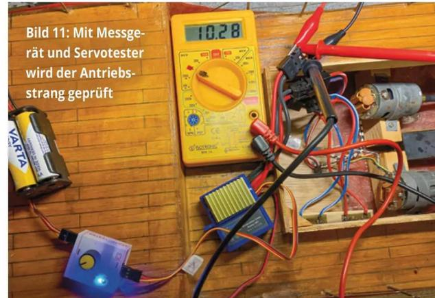
**Bild 11:** Mit Messgerät und Servotester wird der Antriebsstrang geprüft
