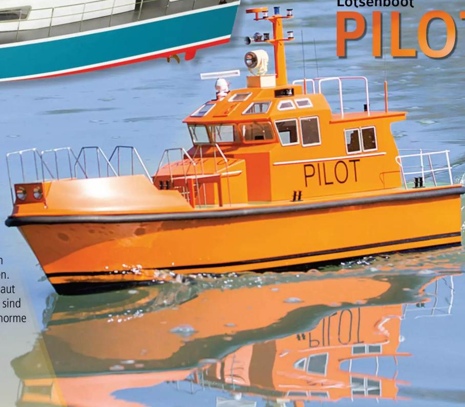
Funktionsmodelle aus lasergeschnittenem ABS. Der Rumpf wird auf der bewährten aero-naut-Helling gebaut. Der Antrieb erfolgt über zwei E-Motoren. Das Steuerhaus ist komplett ausgebaut. Die Ätzteile der Armaturentafel erlauben eine Beleuchtung der vielen Armaturen. Alle Lampen des Modells können mit LED beleuchtet werden. Der Suchscheinwerfer wird aus Ätzteilen gebaut und ist voll beweglich. Der Reflektor und die LED sind aufeinander abgestimmt und haben eine enorme Leuchtkraft und Lichtbündelung.
