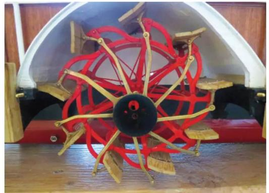
Das Schaufelrad kann nach Entfernen der Spiegel leicht herausgezogen werden
