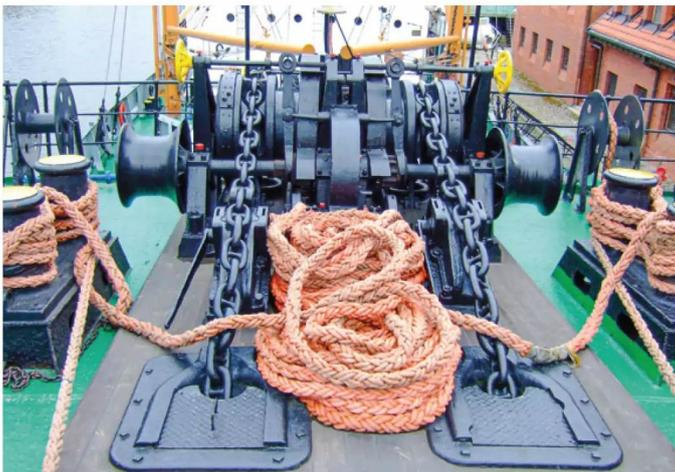
Die Ankerwinde auf der Back. Zu beachten ist der saubere und gepflegte Zustand des Schiffes sowie der Decksmaschinen
