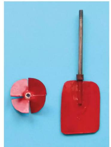
Propeller und Ruder aus Büchsenblech
