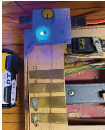
**Bild 10:** Servos werden mit dem Tester geprüft und ggf. instandgesetzt
