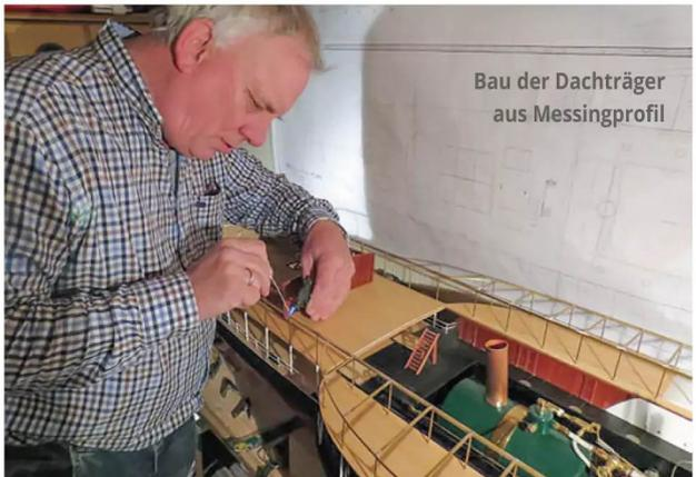
Bau der Dachträger aus Messingprofil
