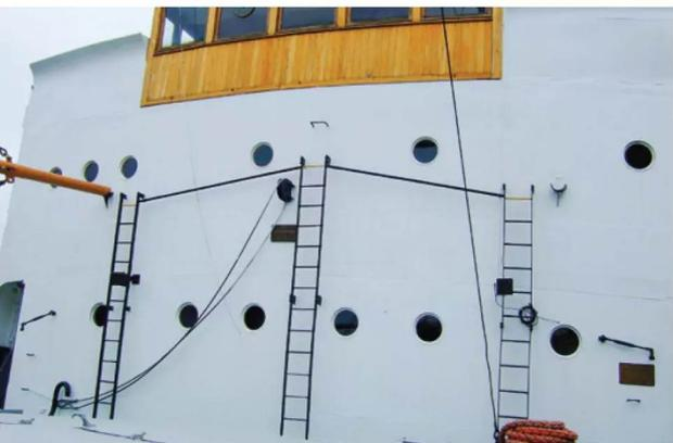
Die charakteristischen Leitern an der Brückenfront waren zum Erreichen der Ladebaumablagen sowie des Seilanschlags zum Öffnen der Luken (Mitte) nötig
