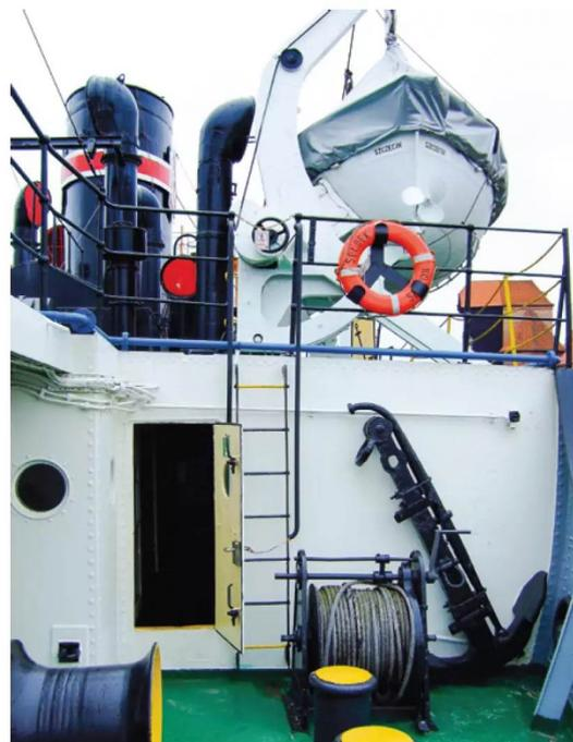
Blick von achtern zum Heckhaus mit offenem Schott. Rechts im Bild ein gestauter Anker, links ein Stück vom Spillkopf der Manöverwinde
