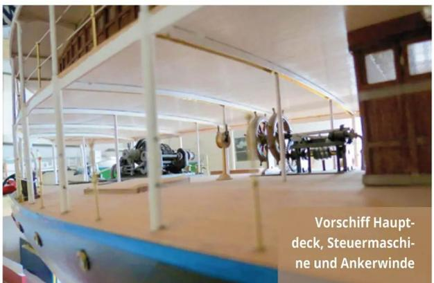
Vorschiff Hauptdeck, Steuermaschine und Ankerwinde
