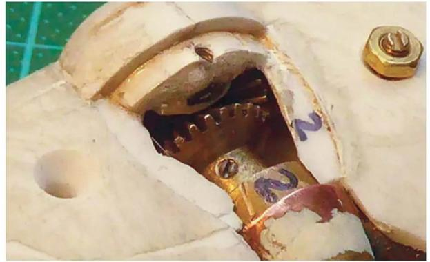
Das im Nasen-Flansch eingeschnittene M2-Gewinde und die eingeklebte Mutter. Es ist gerade noch genügend Platz für das Zahnrad
