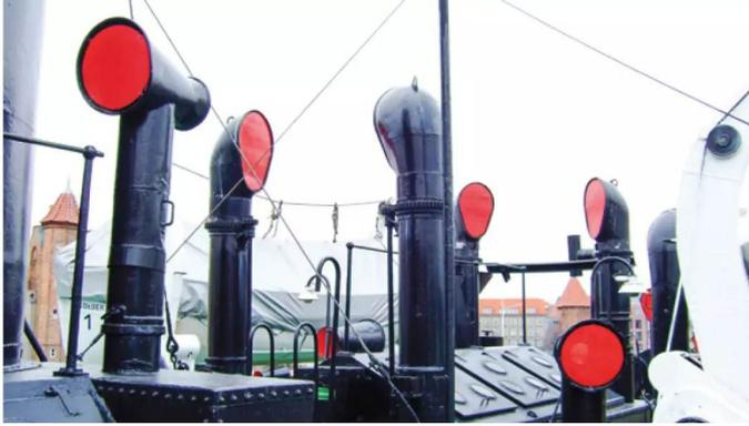
Ein Ventilator (links) und Drucklüfter um das Maschinenraumberlicht herum
