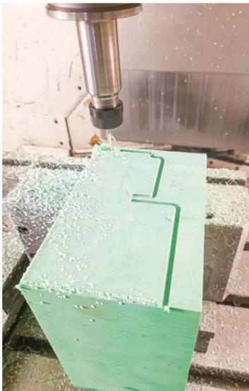
Das allererste Teil: Fertigung des Ruders auf einer CNC-Fräse
