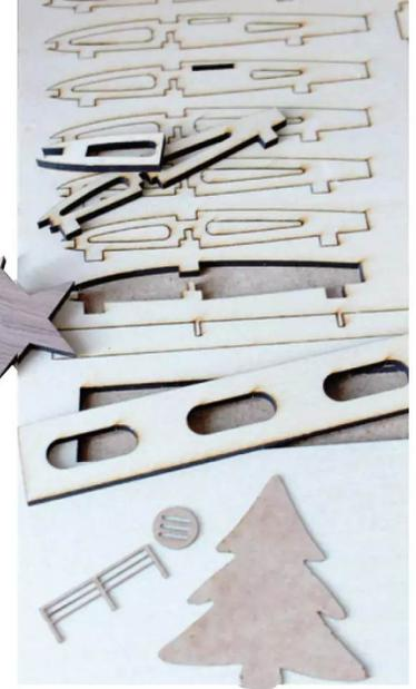
Holz wird bei den meisten Modellbauern das Hauptmaterial sein. Die drei Teile unten im Bild bestehen aus dem sogenannten Kraftplex, hier in der Stärke von 0,5 mm. Die beiden unteren Züge der „Reling“ weisen eine Dicke von gerade einmal 0,5 mm auf
