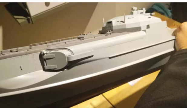
Die Torpedoklappen sind komplett abgedichtet und können auch nicht geöffnet werden. Den Aufwand, eine Mechanik zu verbauen, die per Servo die Luken öffnet, wäre nur bei einem abschießbaren Torpedo eine Alternative gewesen
