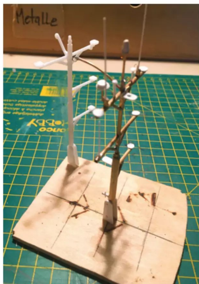
Der verformte Mast des Baukastens (l.) und der neue, aus Messing gefertigte, klappbare Mast ▼
