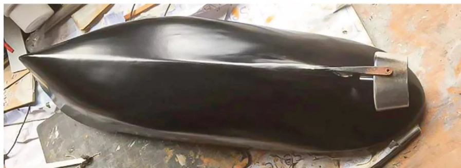
Der Rumpf erhält eine schwarze Grundierung
