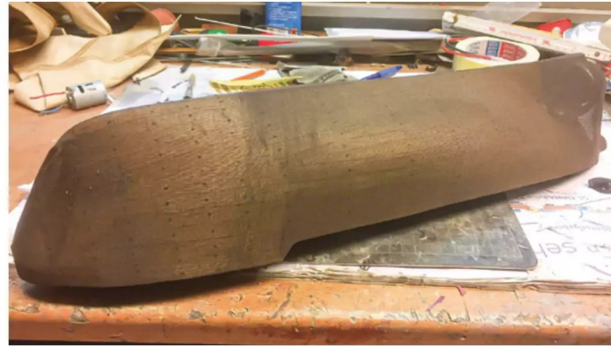
Die Strumpfhose wird einfach über den Rumpf gezogen. Dann erhielt der Rumpf insgesamt vier Schichten Lack
