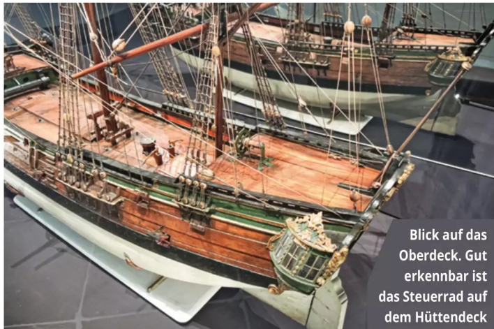
Das Achterschiff des Handelsschiffs-Modells. Interessantes Detail ist das Steuerrad hinter dem Besanmast. In seiner Bauart erinnert es sehr an frühe Anlagen dieser Art
