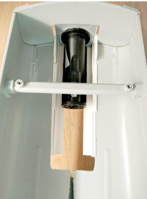
Der Jetantrieb wurde, nachdem er mit der Aufnahme verklebt wurde, das erste Mal in den Rumpf eingepasst
