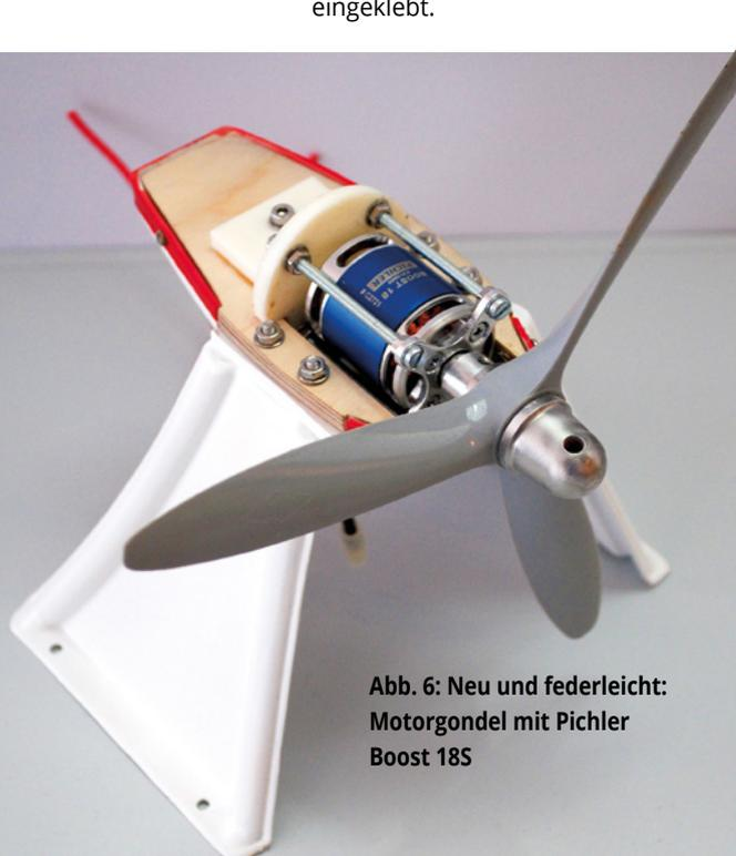
Abb. 6: Neu und federleicht: Motorgondel mit Pichler Boost 18S
