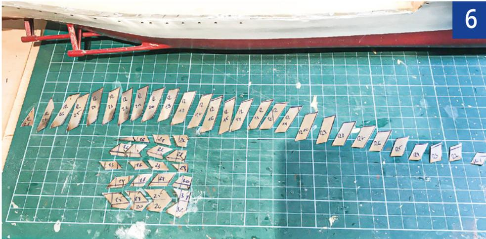
Dünne Aluminiumfolie bildet im Modell die Metallplatten des Schiffsdecks nach
