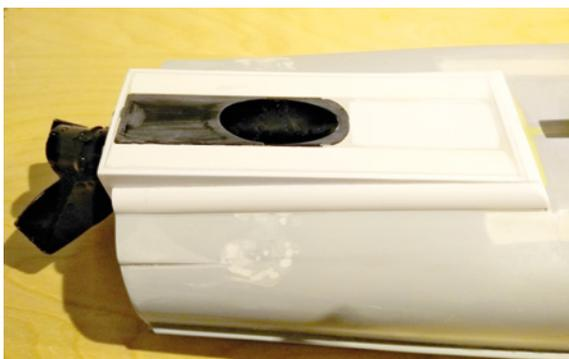
Der Jet im Prototypenstadium: Es sollte sich am Ende zeigen, dass die Kante in Fahrtrichtung keine gute Idee war. Sie staute das Wasser und verlangsamte das Boot
