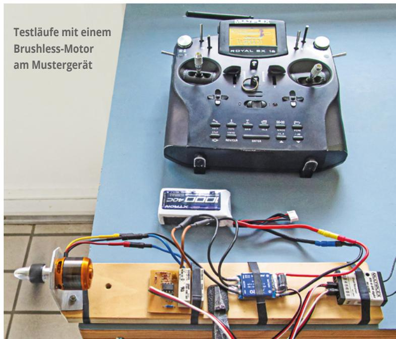
Testläufe mit einem Brushless-Motor am Mustergerät
