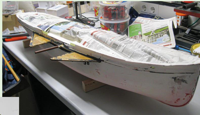
Klebefilm auf den Lack kleben und einfach abziehen
