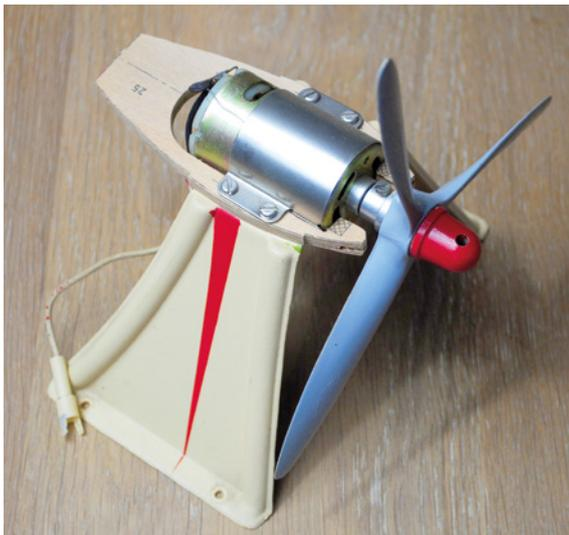
Abb. 4: Alt und schwer: Motorgondel mit Jumbo 550
