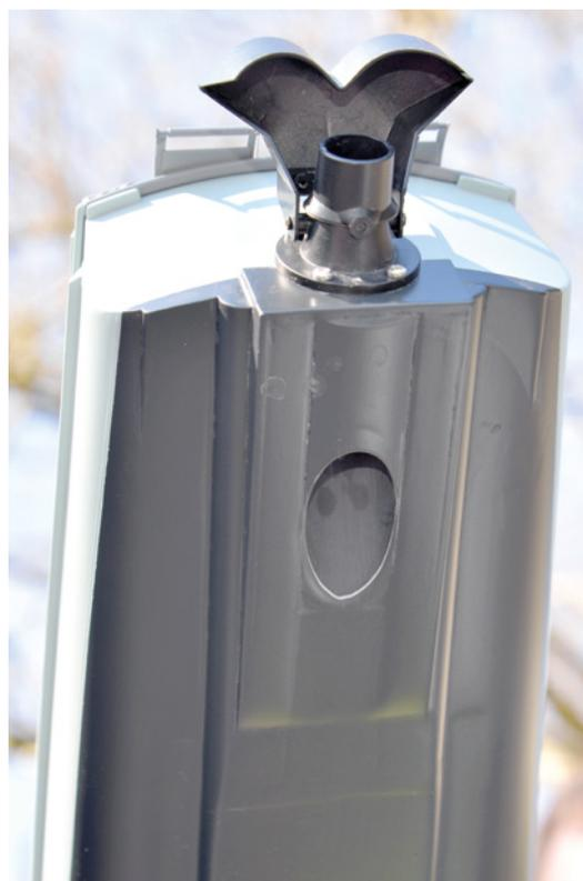
Um abschließend perfekte Anströmverhältnisse zu erhalten, wurde der Kiel weiter eingekürzt. Anschließend habe ich eine Form gebaut und diese mit Acryl ausgegossen
