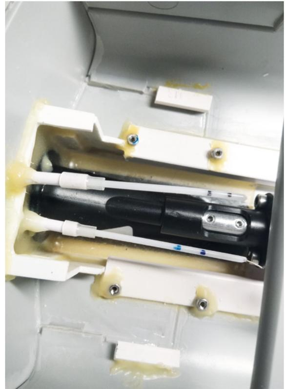
Die Anlenkung für Düse und Rückfahrklappe ist eingebaut. Die Servos werden durch Schrauben in Sicherungsmuttern, die am Rumpfboden geklebt sind, fixiert
