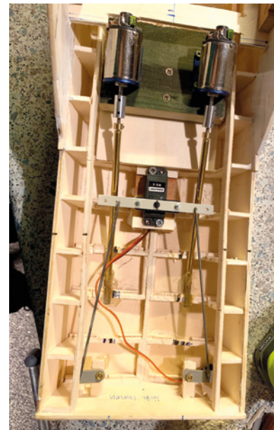
Einbau der Motoren, des Servos sowie der Anlenkung der Ruder
