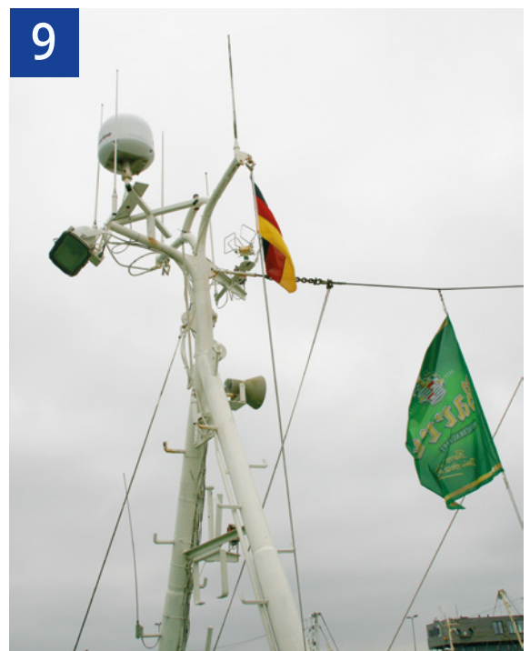
Der Kutter erfuhr im Laufe seines Lebens zahlreiche Umbauten. Hier zu sehen: die neue Antennenanlage im Heckmast
