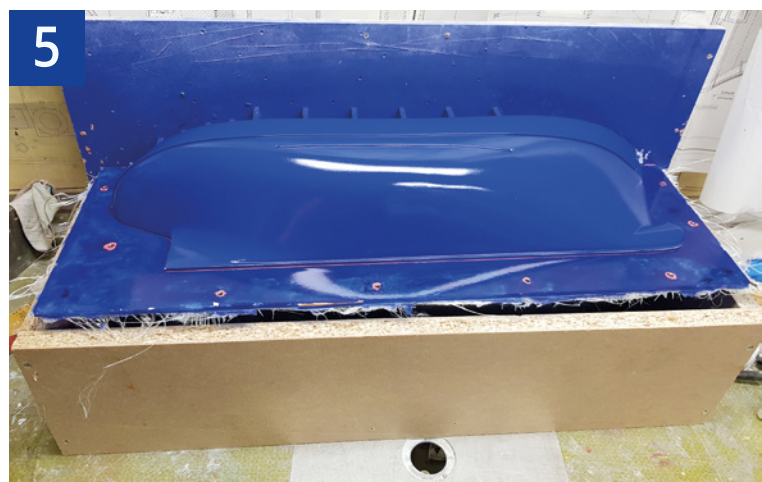
5 Die erste Formhälfte ist getrocknet. Nun wiederholen sich die Arbeitsschritte für die zweite Hälfte
