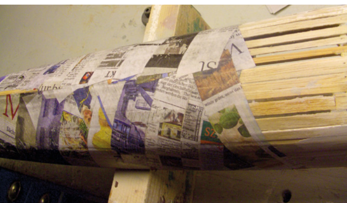
▲ ▼ Modellbau wie in den 50er-Jahren: Zeitungspapier und Leim anstelle von Glasfaser und Harz. Die fertige Oberfläche kann sich durchaus sehen lassen ▼
