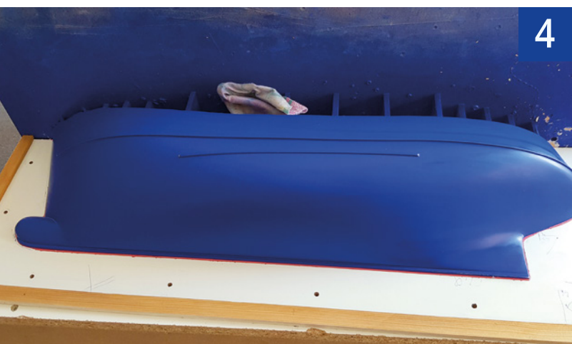
4 Mehrmaliges Wachsen und Polieren des Urmodells ist beim Formbau Pflicht, sonst gibt es Probleme beim Trennen und Ausformen
