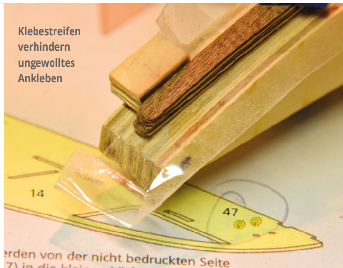
Die Helling für die Pinne. Zusätzliche Klötzchen richten die Einzelteile aus
