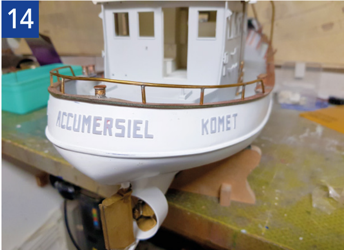
▲ Der Schiffsname ist beim Original aufgeschweißt, für das Modell kommen Buchstaben aus dem Resin-Drucker zum Einsatz ▲
