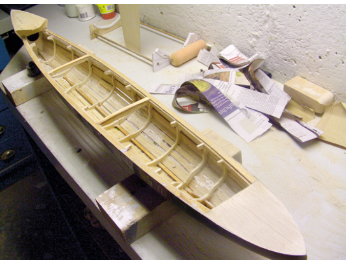
Der Rumpf meiner V27 wurde in klassischer Spantbauweise erstellt
