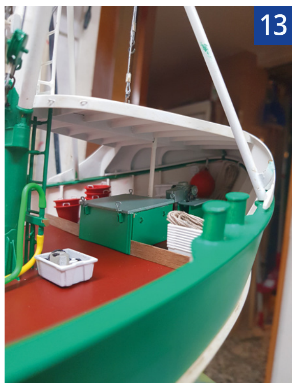
Das GFK-Backdeck mit der getrennten Leiter. Gut zu sehen sind hier die acht Unterzüge aus 0,75-mm-Polystyrol
