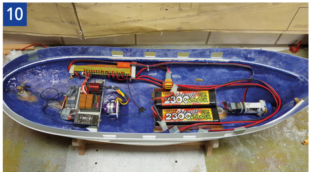
Der Rumpf mit den herausgearbeiteten Speigatt-Öffnungen vor dem Einkleben des Decks
