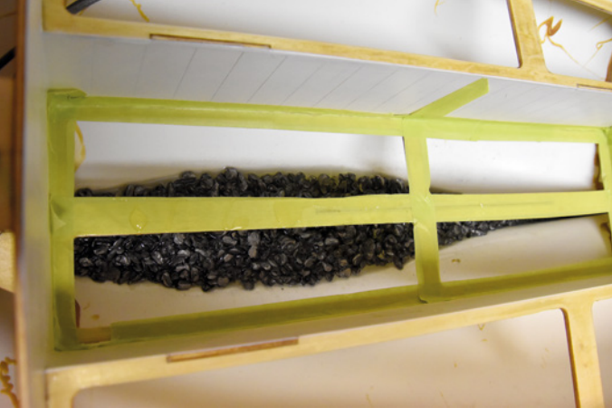
Der Ballast im Rumpf. Die Plichtauflage wird mit Kreppband geschützt
