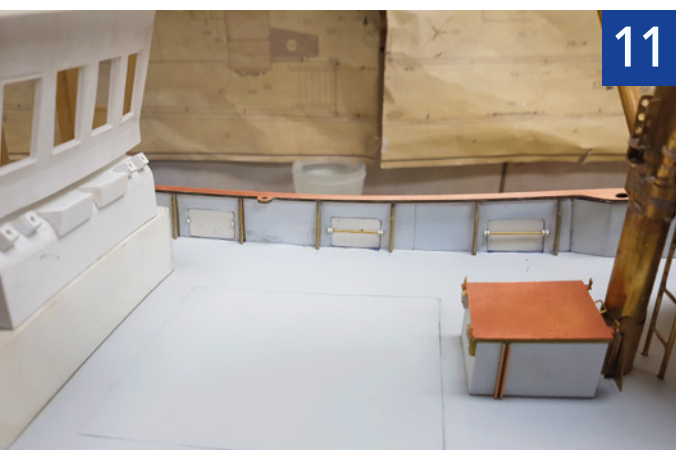
Blick auf das Schanzkleid mit den eingepassten PS-Streifen zwischen den Stützen und den Speigatt-Klappen
