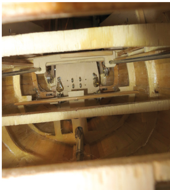
Brassen- und Schotbefestigung mit Umlenkungen im Heck
