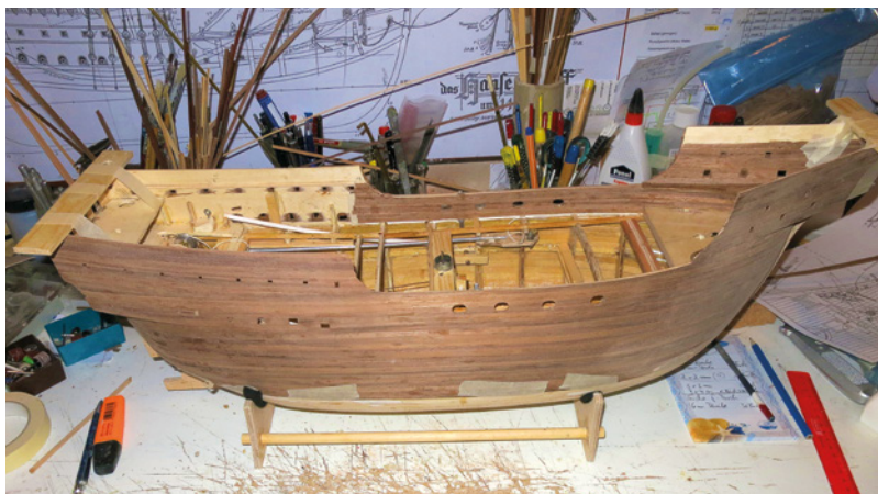
Der Rumpf wird beplankt
