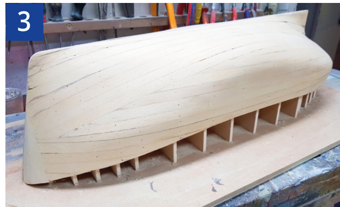
Beplankt wurde der Rumpf mit 1,5-mm-Abachi-Leisten. Bug- und Heckbereich entstanden aus Abachi-Vollmaterial
