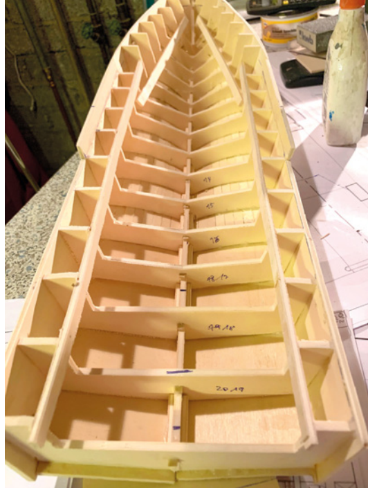
Blick auf den Rumpf mit Beplankung von innen
