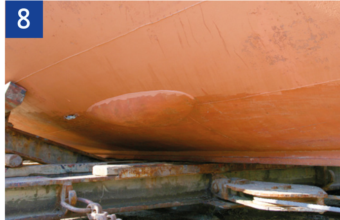
Ein Sonar-Wulst am Original. Für das Modell wurden die Wulste aus PETG gefertigt
