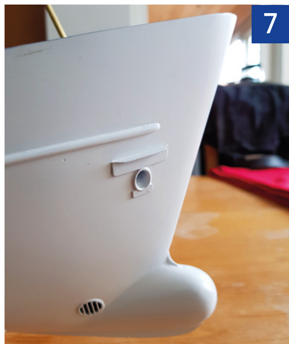
7 Das Bugstrahlruder ist eine Eigenkonstruktion und sitzt weit vorne im Bug
