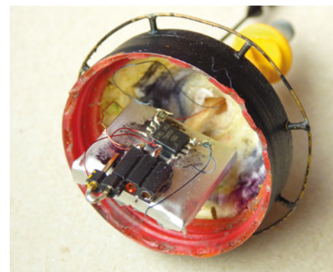
Blick in das Innenleben einer Tonne. Statt mit einem Schalter wird die Stromversorgung per Steckerleiste und Kurzschlussstecker eingeschaltet
