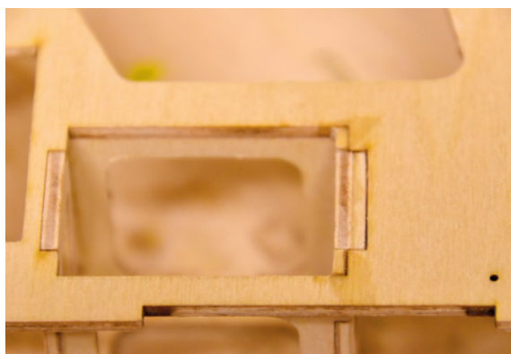
Der Akkukasten der Bullseye ist ein wenig zu kurz...
