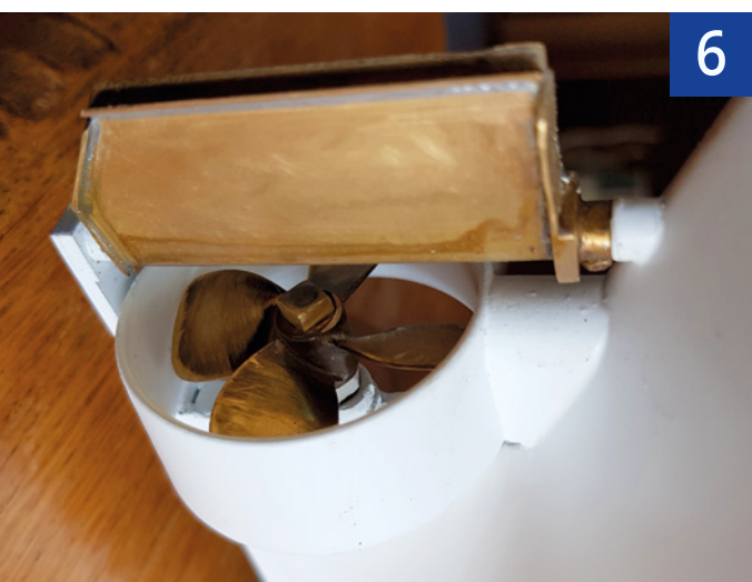
6 Das Ruderblatt ist aus Messing gefertigt und wird unten zusätzlich mit einer Schraube in der Kielhacke geführt
