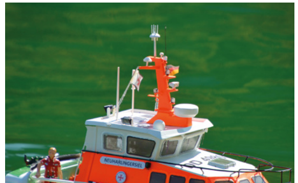
Radar, Polaris- und UKW-Antennen im Mast der Neuharlingersiel
