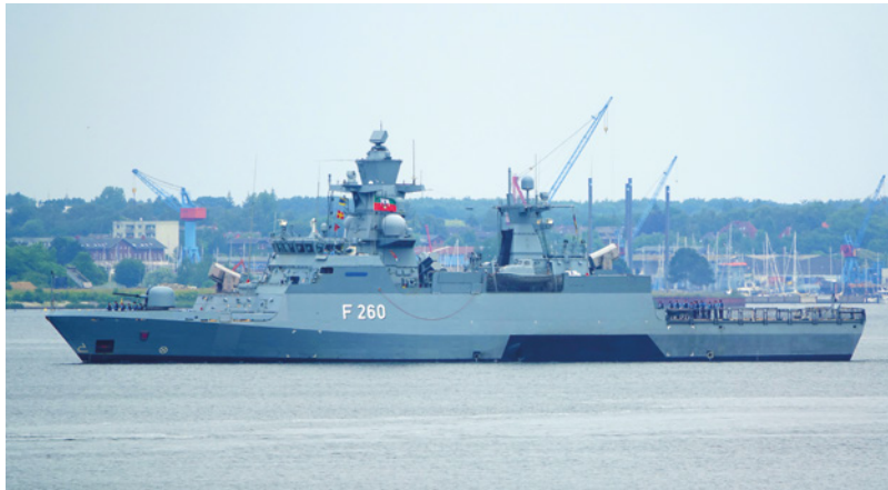
Die 89 Meter lange, 1.840 Tonnen verdrängende Braunschweig (F-260) ist das Typschiff der Braunschweig-Klasse (Korvettentyp K130) und ist seit April 2008 im Marinestützpunkt Rostock-Warnemünde stationiert
