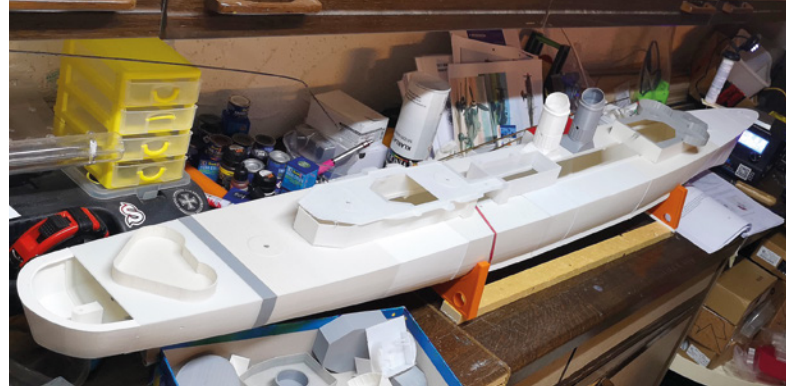
Die beiden großen Rumpfsegmente wurden verklebt, damit die Motoren eingebaut werden können. Es folgt die Anprobe der ersten Aufbauten
