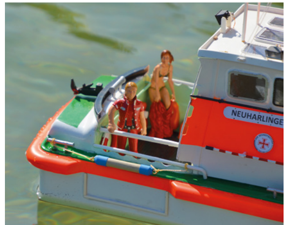
Weibliche Besatzung und funktionale Kleidung heute. Gut zu sehen sind auch die Bergungspforte und der Schlepphaken
