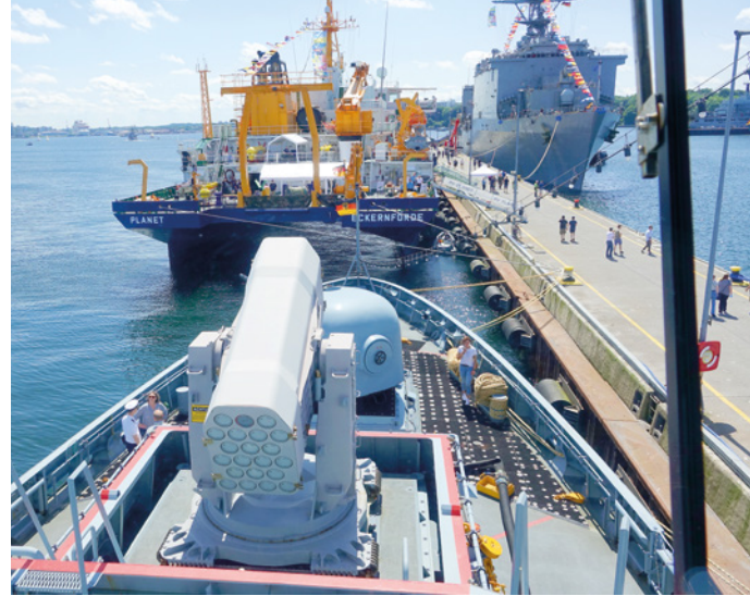
Blick von der Brücke der Braunschweig auf das Vorschiff. Man erkennt den Raketenwerfer des Nahbereichsverteidigungssystems RIM-116 Rolling Airframe Missile. Vor der Braunschweig liegt das Wehrforschungsschiff Planet in SWATH-Doppelrumpfbauweise
