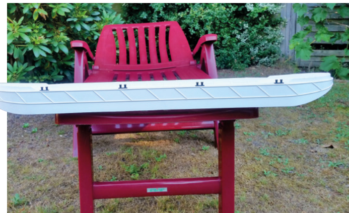
Nicht ganz vorbildgetreu, aber elegant: Die Scheuerleisten aus halbrundem Profil und schräg verlaufende Zwischenstücke
