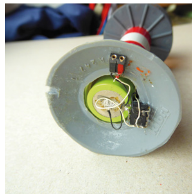
Die Lilon-Zelle steckt im Leuchtturm, außerdem sieht man noch die Ladebuchse und den Mikrocontroller. Ein Schalter ist hier noch nicht montiert
