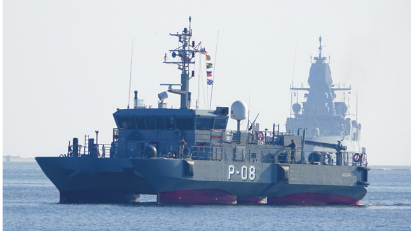
In den frühen Morgenstunden läuft das SWATH-Patrouillenboot Jelgava (P-08) in den Kieler Stützpunkt ein. Das 25 Meter lange Doppelrumpfboot wurde 2012/13 bei Abeking & Rasmussen in Lemwerder gebaut. Im Dunst dahinter erkennt man die Konturen der deutschen Fregatte Sachsen (F-219)
