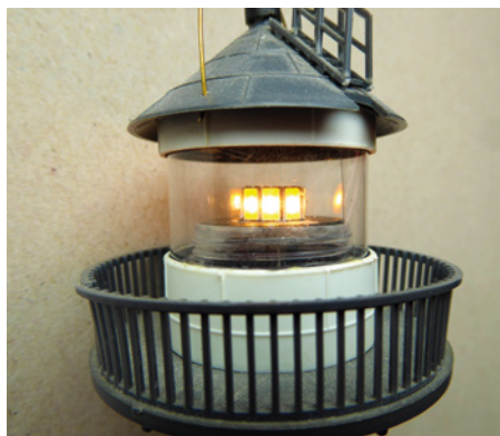
Die im Kreis angeordneten LEDs bieten eine Menge Leuchtfläche bei einem immer noch geringen Stromverbrauch von unter 10 mA
