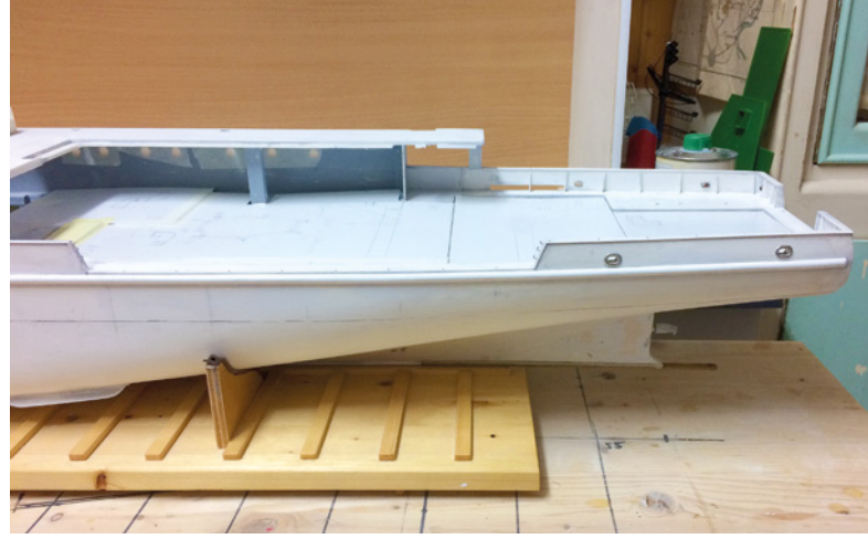
Das Hauptdeck überlappt im hinteren Bereich teilweise das Arbeitsdeck
