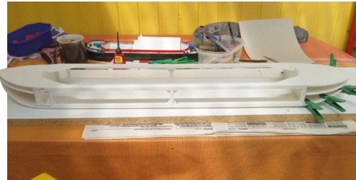
Die Schuten entstanden hauptsächlich aus einer Polystyrolplatte mit 1 mm Stärke sowie Polystyrol-Profilen
