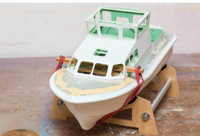
Feineinstellung der Höhe mit den Schrauben im Querträger, fixieren des Deckshauses mit den Gummis beim Kleben
