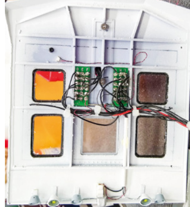
Unterm Dach ist kaum Platz: Aus Platzgründen wurden SMD-Vorwiderstände für die LED verwendet, gleichzeitig werden die fragilen Koax- und Kupferlackdrähte auf stabilere Litze auf der Dachunterseite umgesetzt, der Arduino ist unter dem „Vordach“ des Deckshauses montiert
