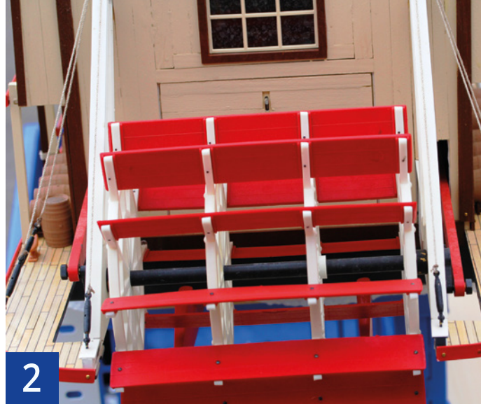
2 Das Schaufelrad mit zusätzlichen Messingstiften als Sicherung
