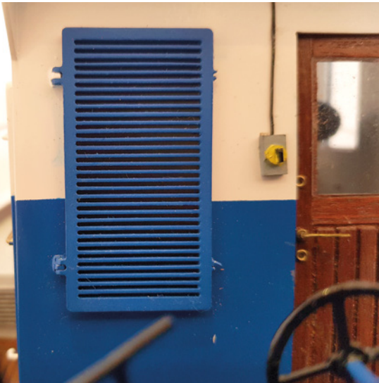
Der große Lüfter an der Aufbaurückseite
