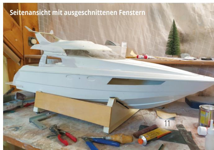
▲ Das Modell wurde komplett entlackt und anschließend mit Spachtelmasse in Form gebracht
