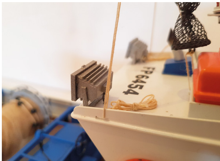
Eigenbau-Suchscheinwerfer mit Hilfe der CNC-Fräse
