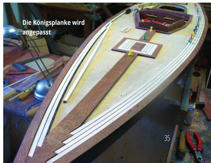
Die Planken werden verleimt
