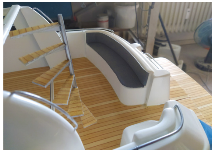
Die neu gebaute Wendeltreppe zur Flybridge im Detail
