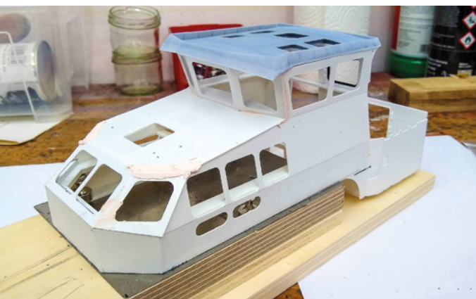
Aufbau des Deckshaus-Oberteils mit Dach als 3D-Druckteil
