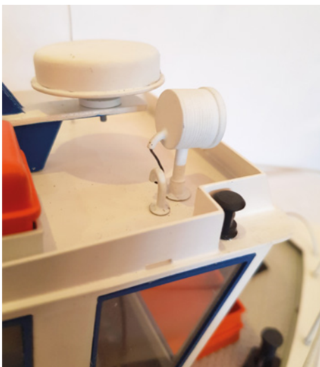
Der Suchscheinwerfer mit der Kabelführung
