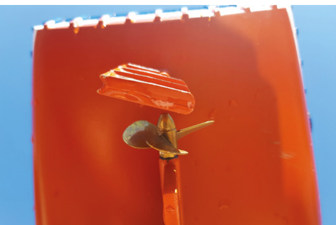
Das Ruderblatt von unten bei ca. 70° Vollausschlag. Der Schraubenstrom wird fast komplett auf das Ruder geleitet
