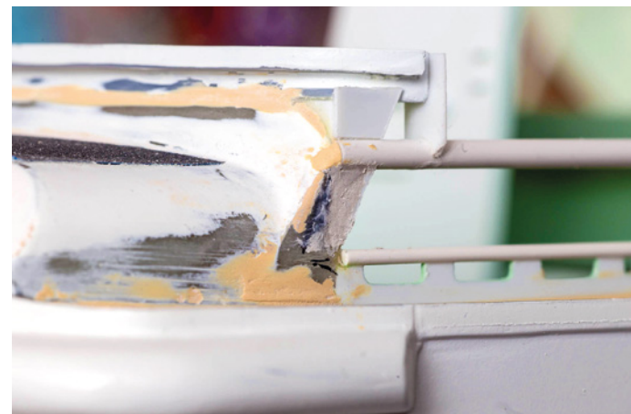
Plicht-Origami: Die Nachbildung der Blechführung am hinteren Plichtende mit Polystyrol-Stücken und ASA-Rundmaterial
