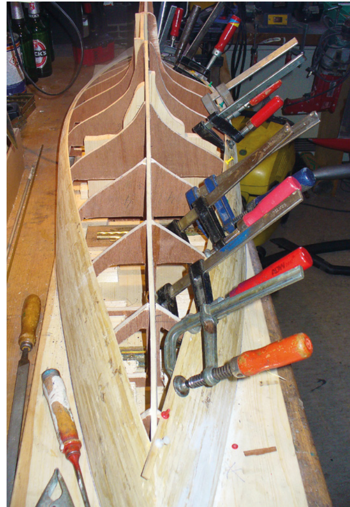
Die Planken werden verleimt
