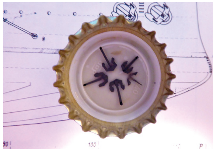
Hier entstehen die Anker. Die kantige Bauweise der Originale wird nach ihrem Entwickler „Tyzack-Anker“ genannt
