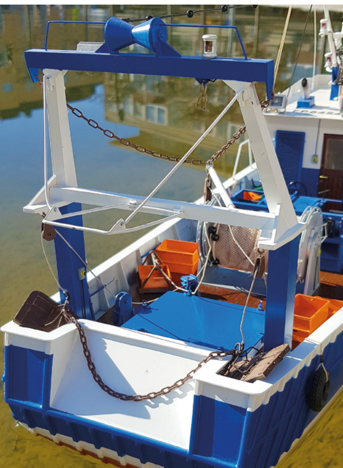
Die Wallschienen an der Heck-Seite
