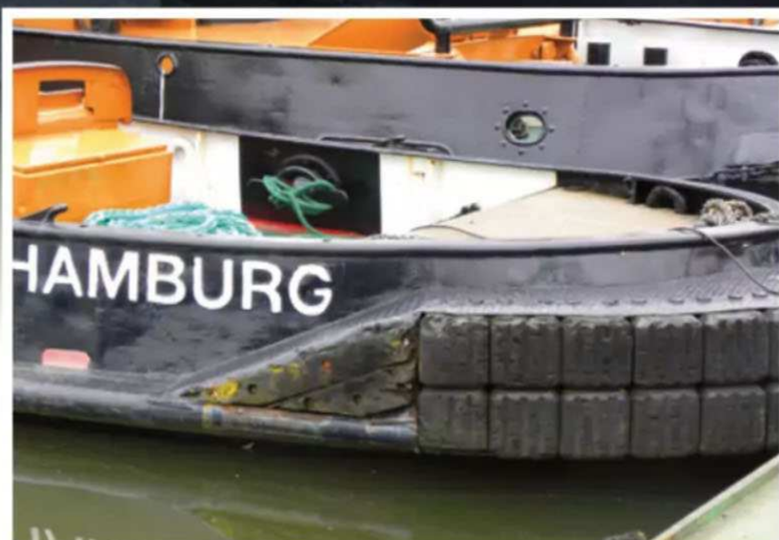
Kräftiger Heck-Fender aus einzelnen Gummiblöcken
