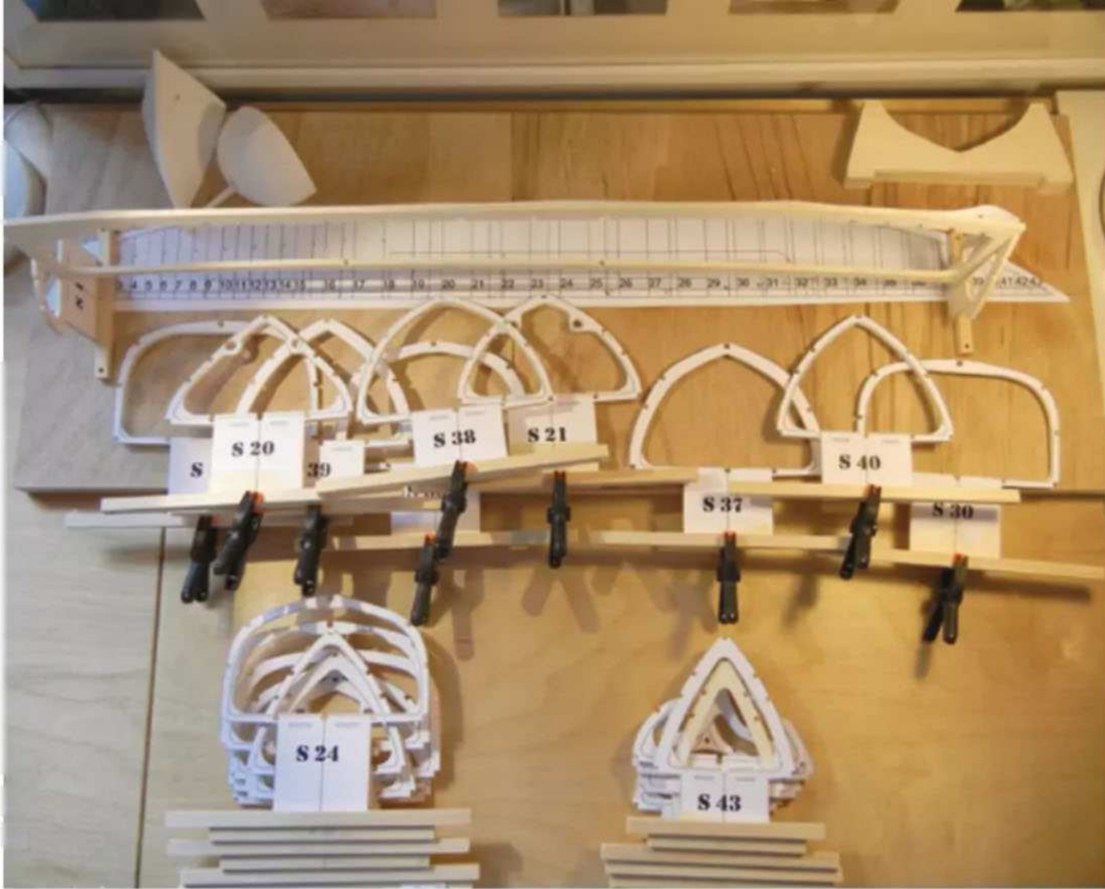
Erstellen der Spanten aus 4-mm-Sperrholz
