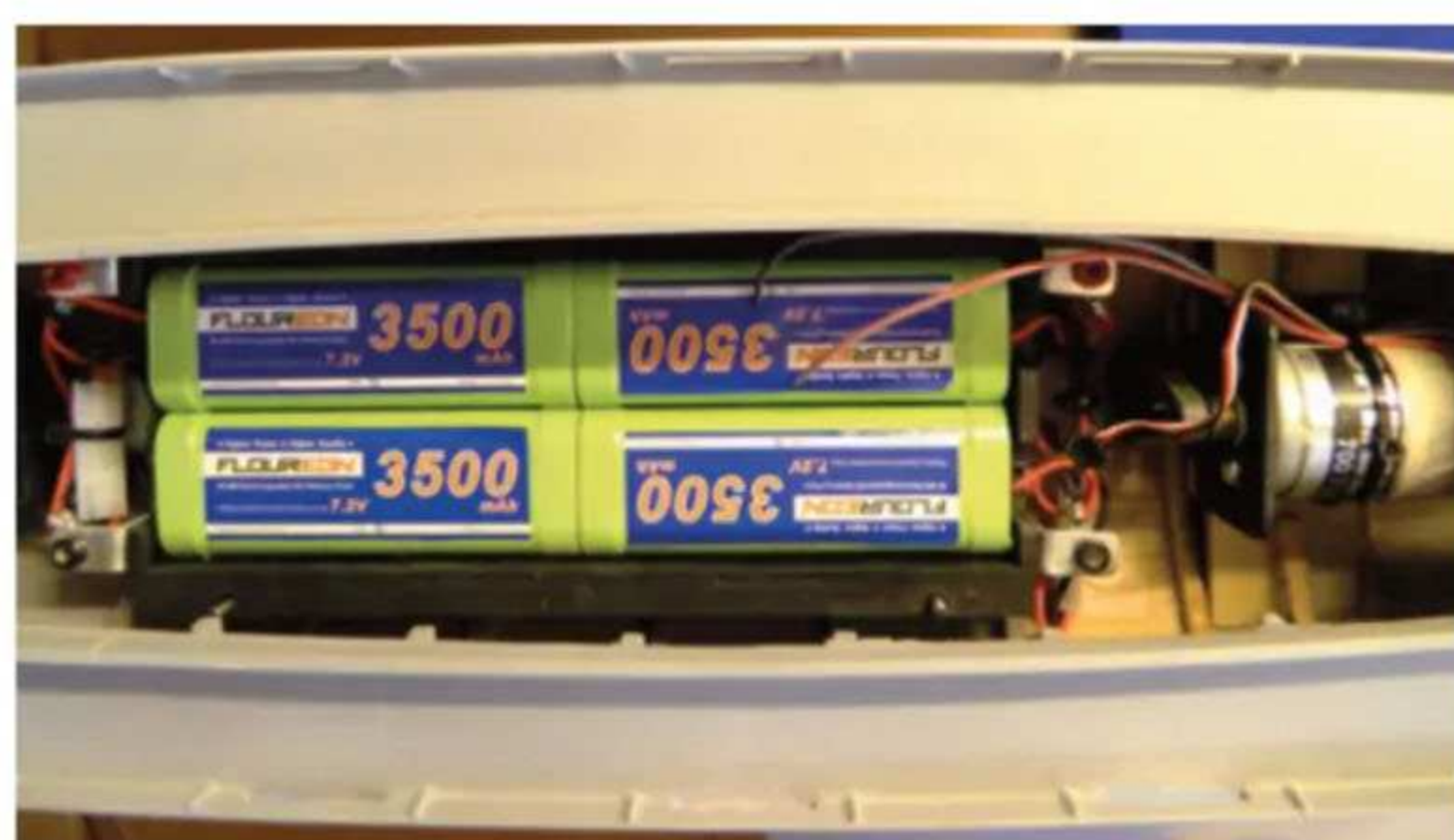
Die fertig verkabelte Akkueinheit vor dem Einsetzen der RC-Einbauplatte. Über Buchsen in den Aluwinkeln können die Akkus geladen werden, ohne die Einbauplatte entnehmen zu müssen
