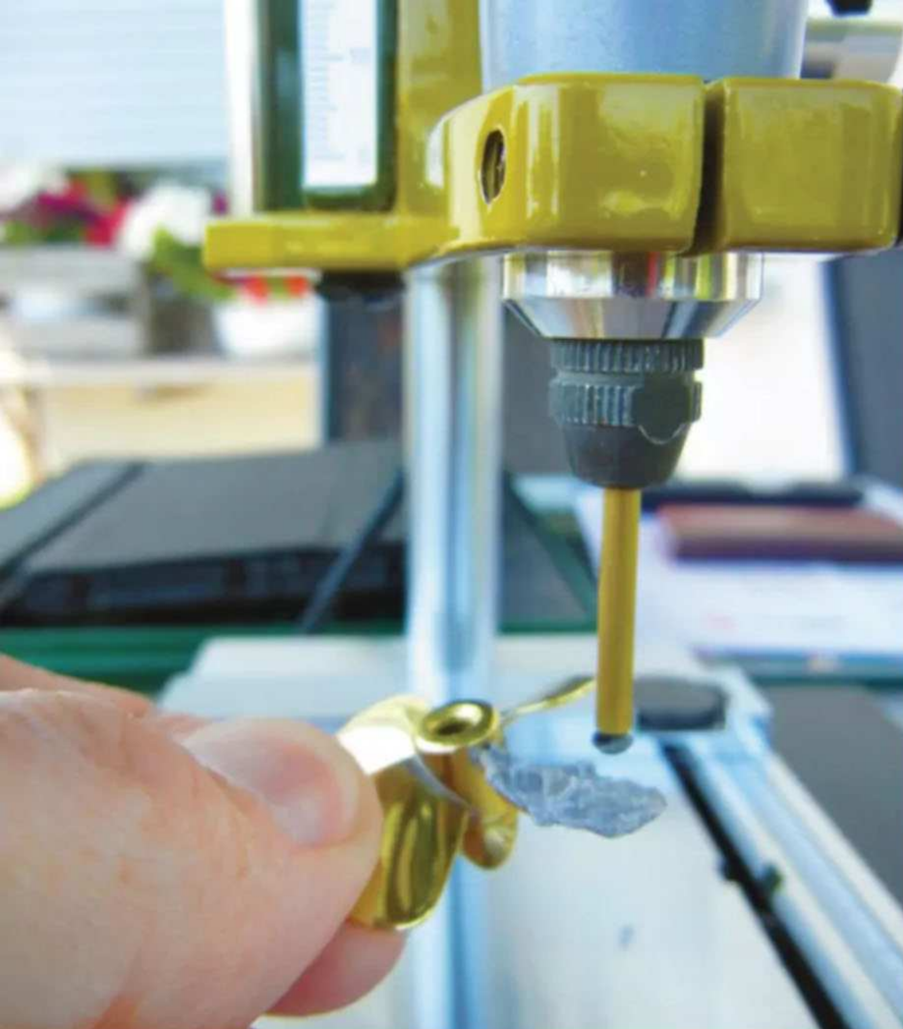
▲ ▼ Die Propeller von Raboesch wurden mittels Ständerbohrmaschine und Ventileinschleifpaste mit Pfauenaugen versehen
