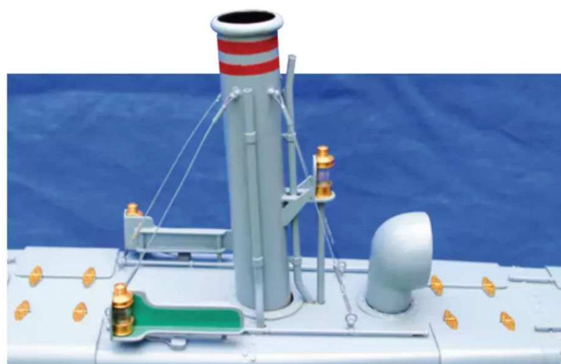
Der Schornstein am fertigen Modell, mit Abspannung, Toplaterne und den Positionslichtern (Back- und Steuerbord)
