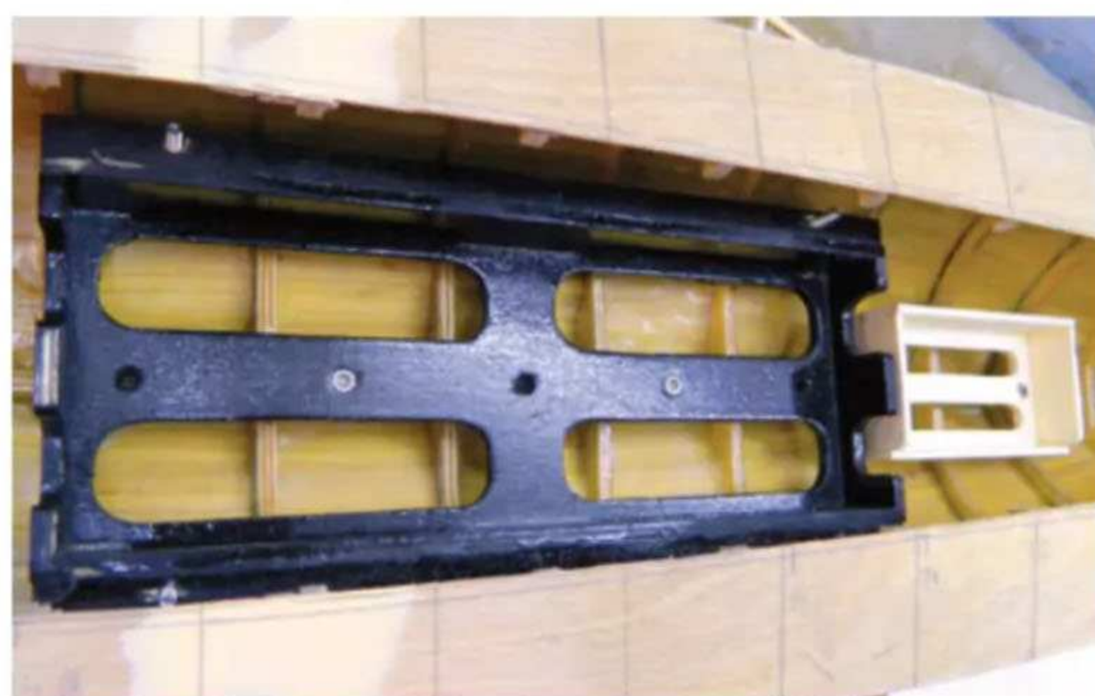
Der im Rumpf eingebaute Akkuhalter mit den vier Schrauben, mit welchen später die RC-Einbauplatte verschraubt wird
