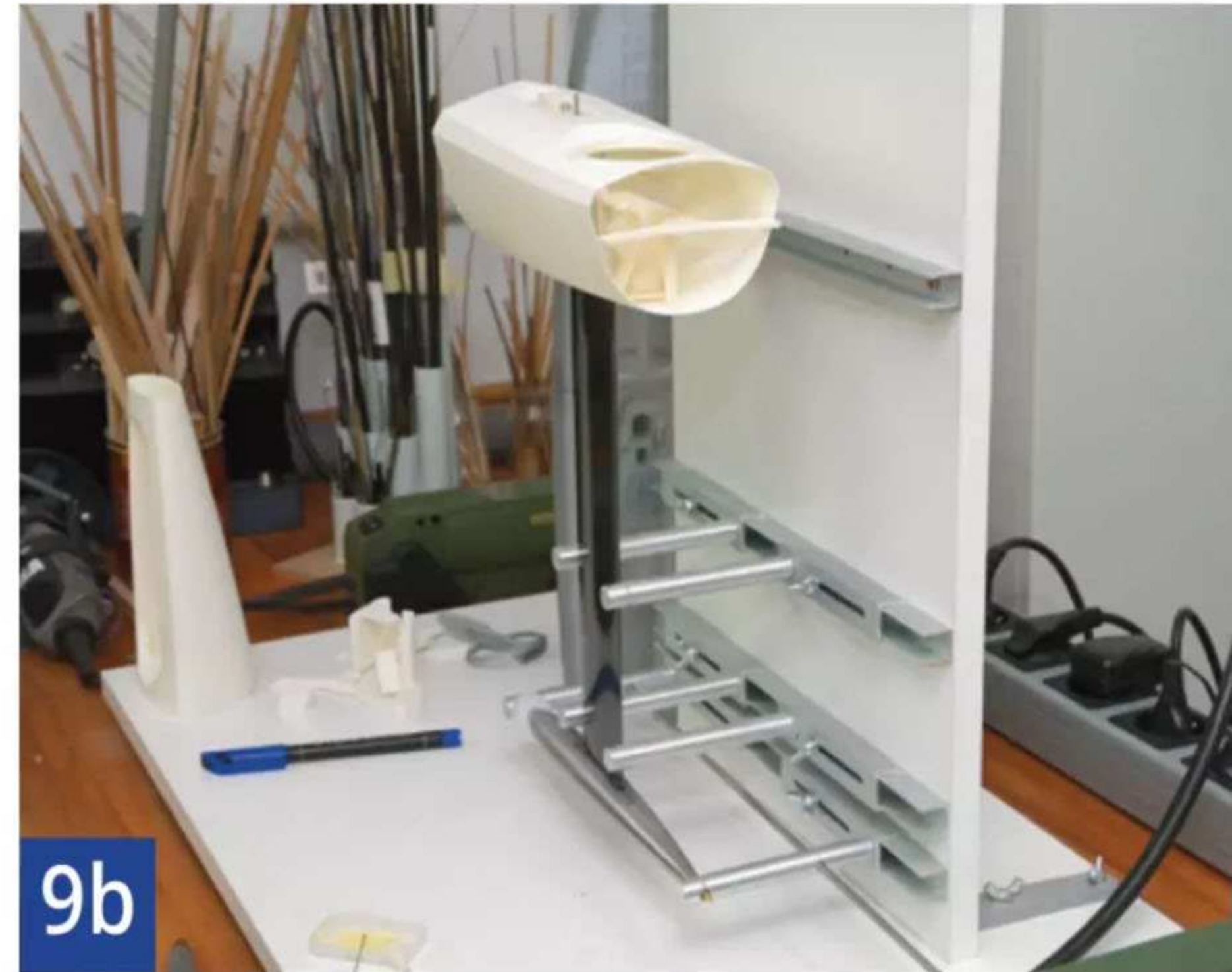
Ist alles verklebt, kann die Sicke im Rumpfboden geöffnet und der Kiel eingesteckt werden. Ein weiteres Ausrichten ist nicht erforderlich
