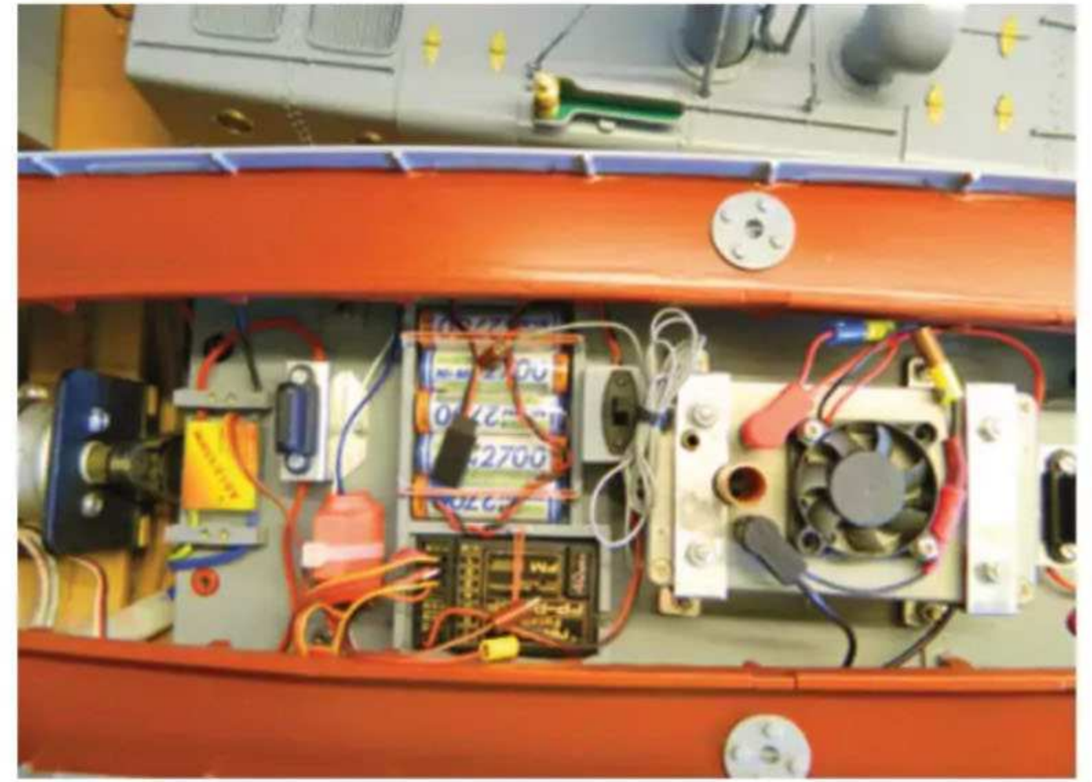
So sieht es im Rumpf aus, nachdem die Einbauplate eingesetzt und verschraubt wurde
