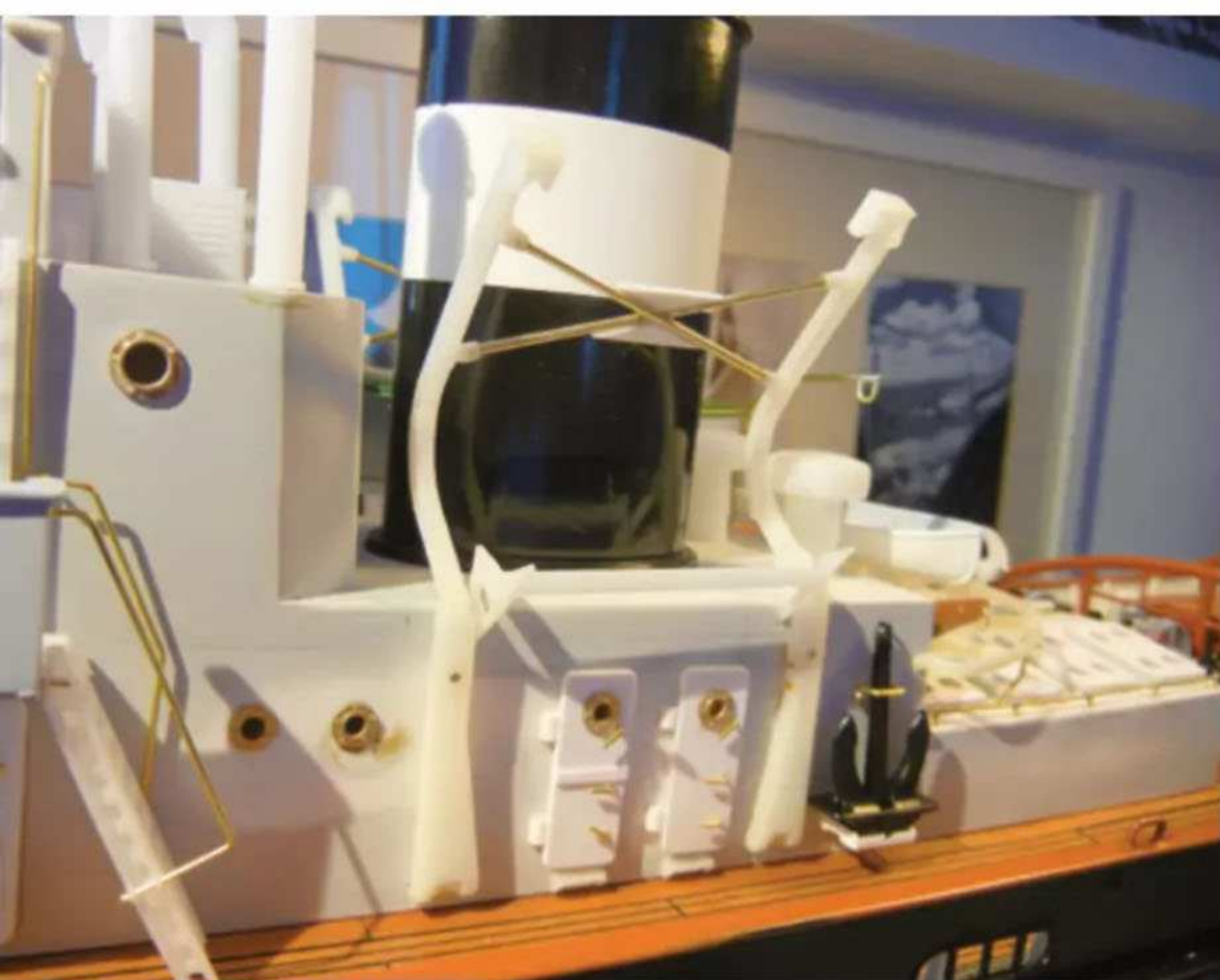
Die Bootsdavits im Rohbau
