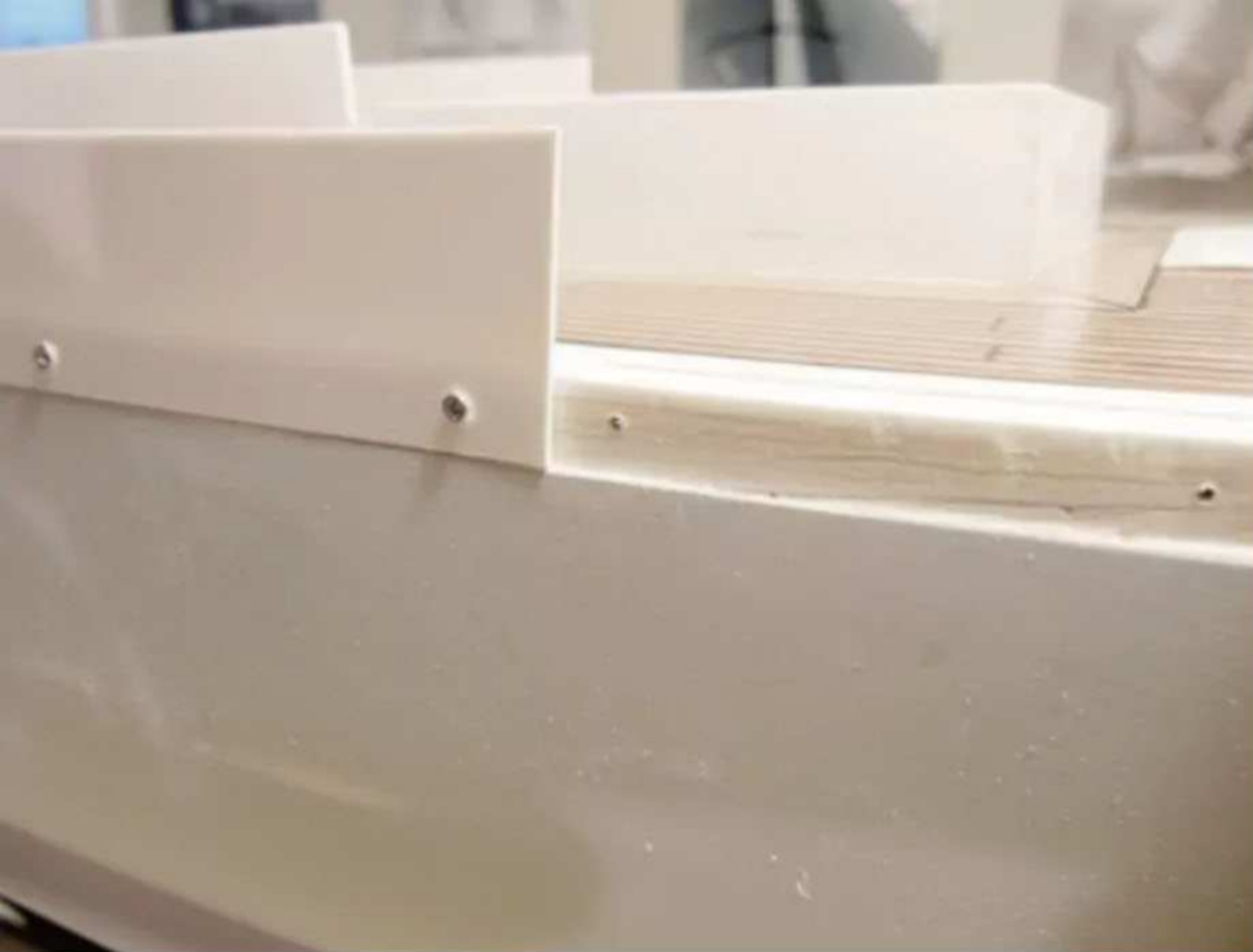
Montage des Schanzkleides
