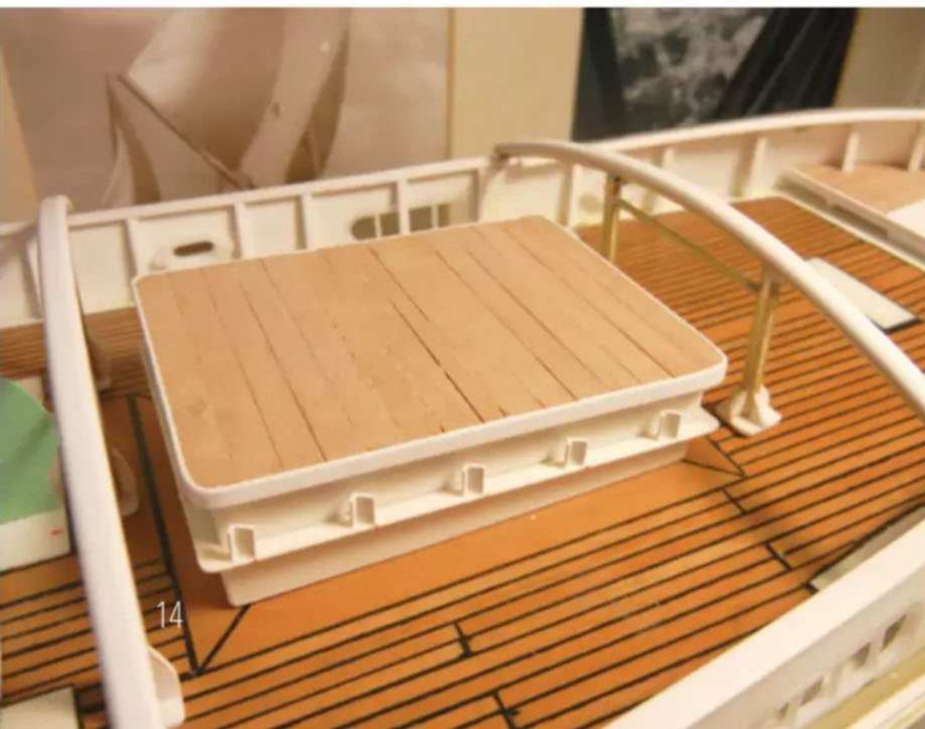
▼ Achterdeck mit Maschinenraumluk und Trossenabweiser
