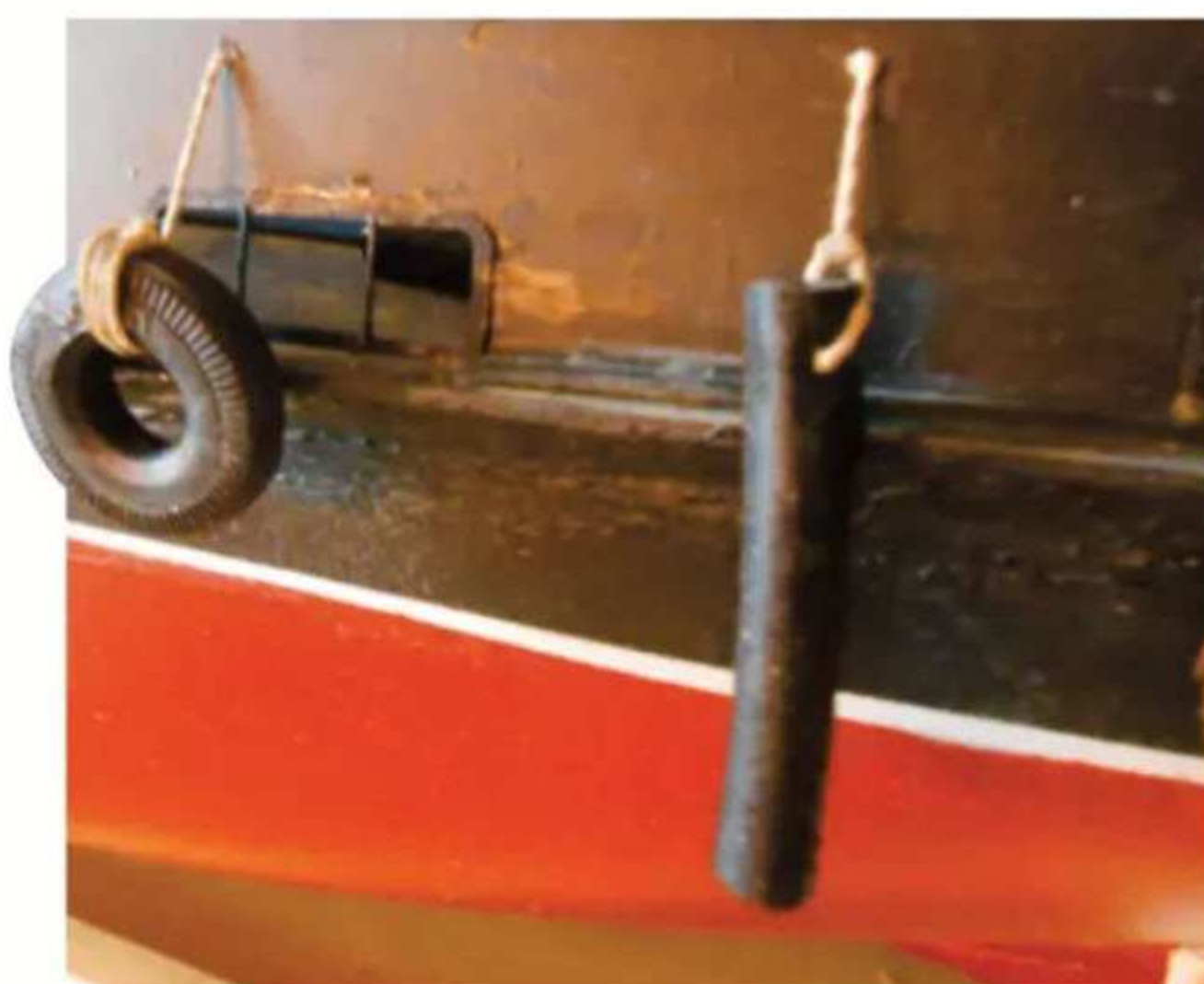
Rechts ein Fender aus Benzinschlauch
