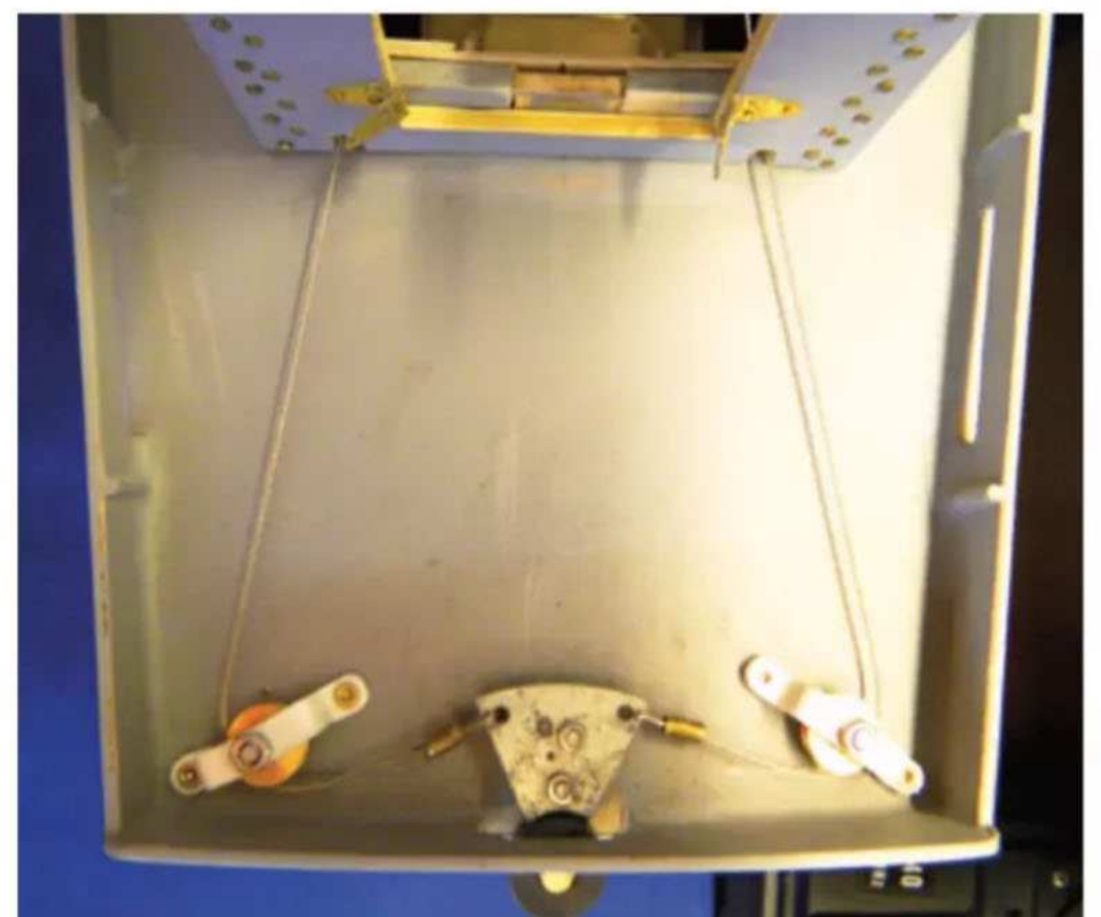
Anlenkung des Ruders über einen Seilzug - wie beim Original
