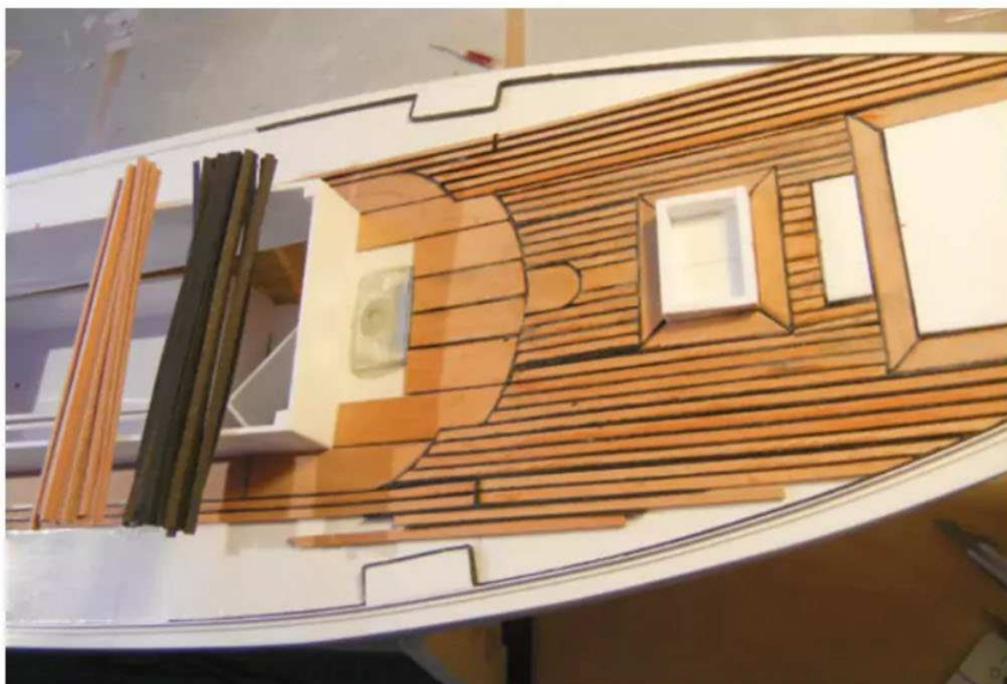
▲ Das Holzdeck wird verlegt
