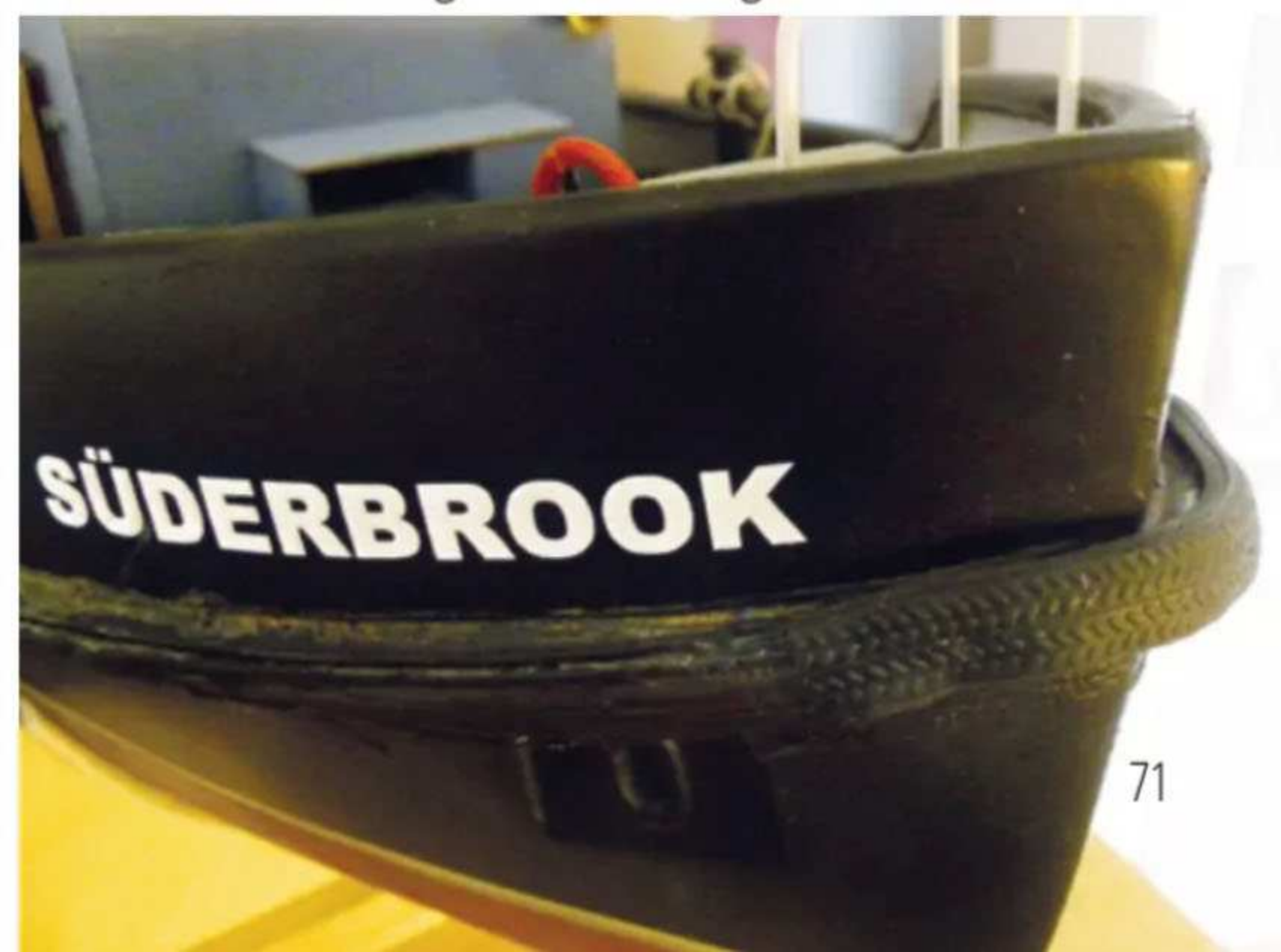
▼ Bugfender aus aufgeschnittenem Reifen
