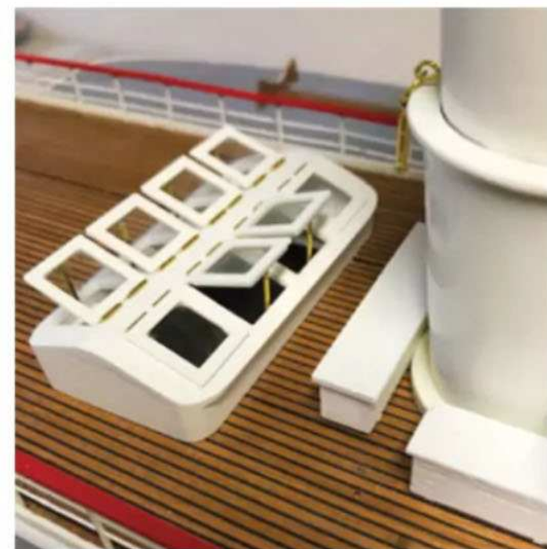
Die Fenster des Maschinen-Oberlichtes sind geöffnet, direkt darunter befindet sich der Lautsprecher für die Soundgeräusche
