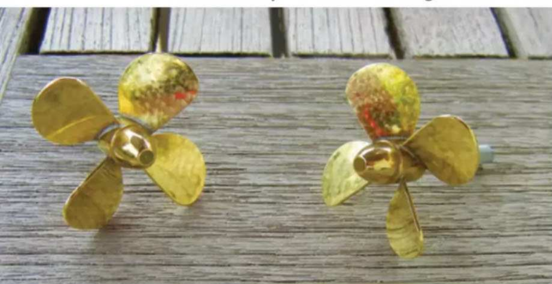
▲ ▼ Die Propeller von Raboesch wurden mittels Ständerbohrmaschine und Ventileinschleifpaste mit Pfauenaugen versehen
