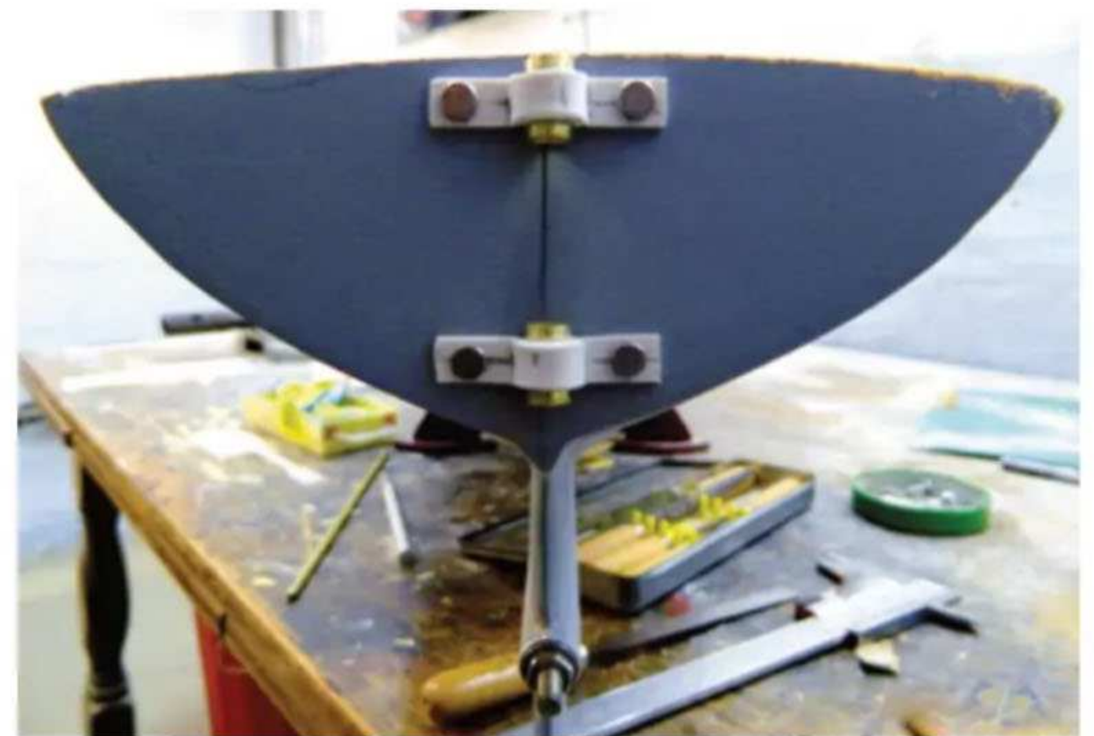
Montage der Ruderlager am Rumpf
