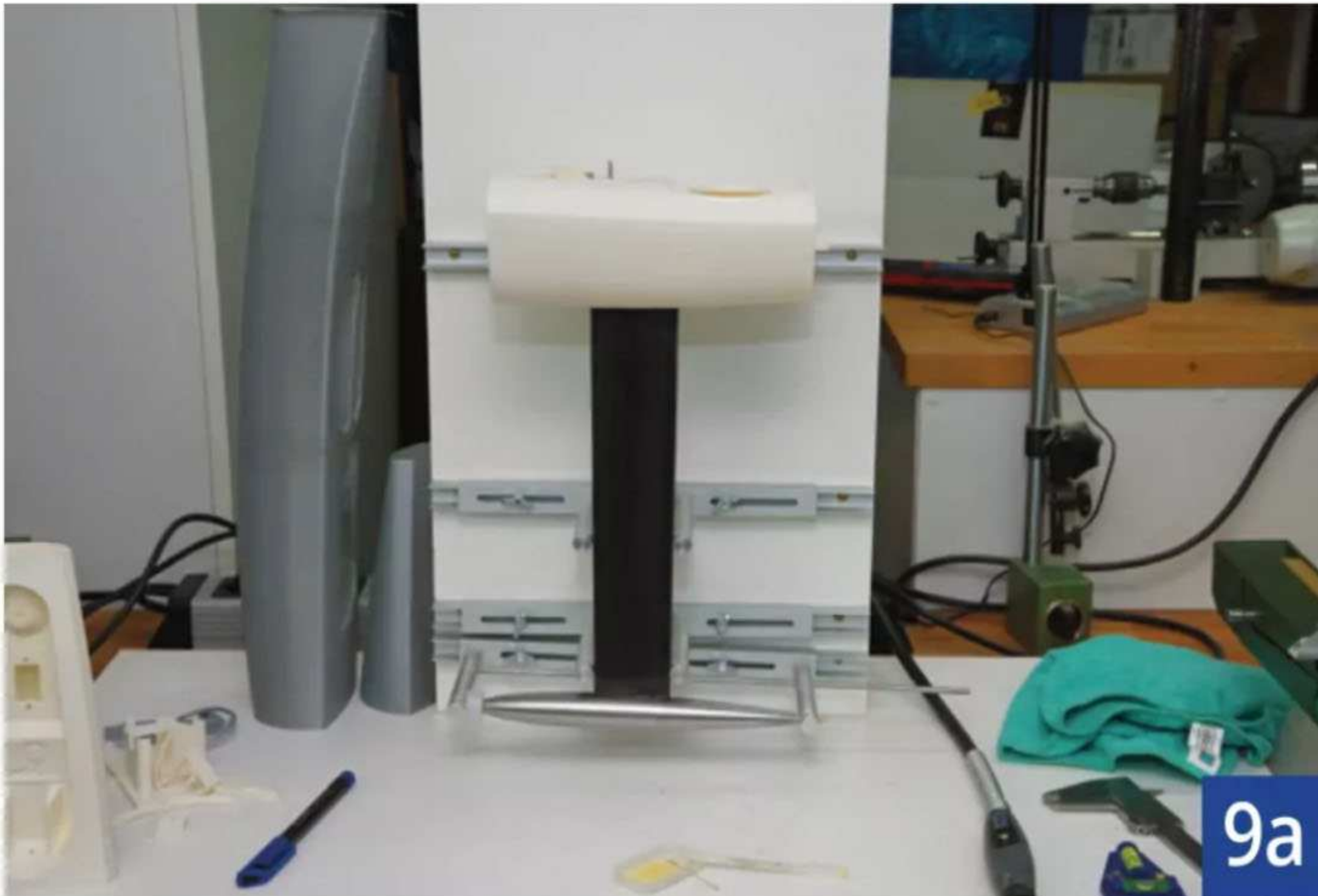
Ist alles verklebt, kann die Sicke im Rumpfboden geöffnet und der Kiel eingesteckt werden. Ein weiteres Ausrichten ist nicht erforderlich
