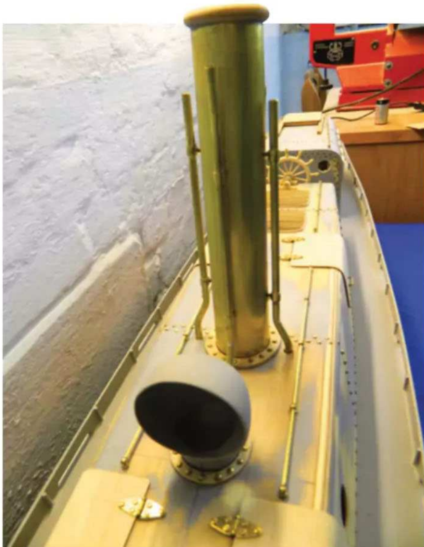
Der Schornstein mit Abdampfrohr
