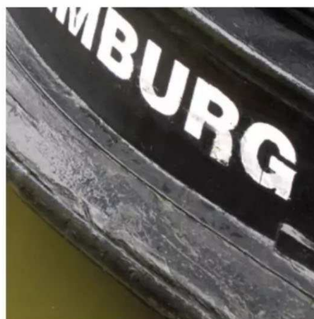
Dicke Scheuerleiste aus Holz an einem Arbeitsschiff
