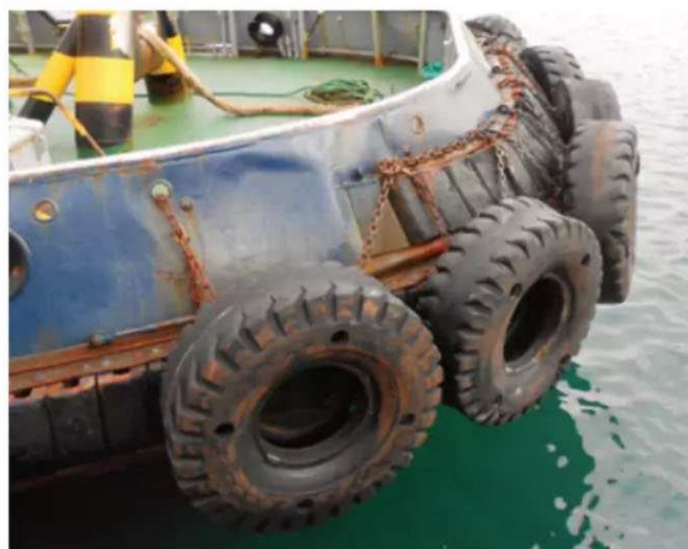
Heckfender mit Ketten fixiert
