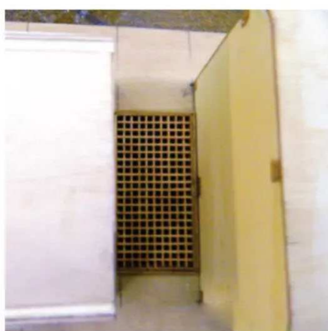
Der Steuermann steht auf einer Grätting zwischen den Aufbauten. Diese stammt aus dem Zubehörhandel, musste aber noch angepasst werden
