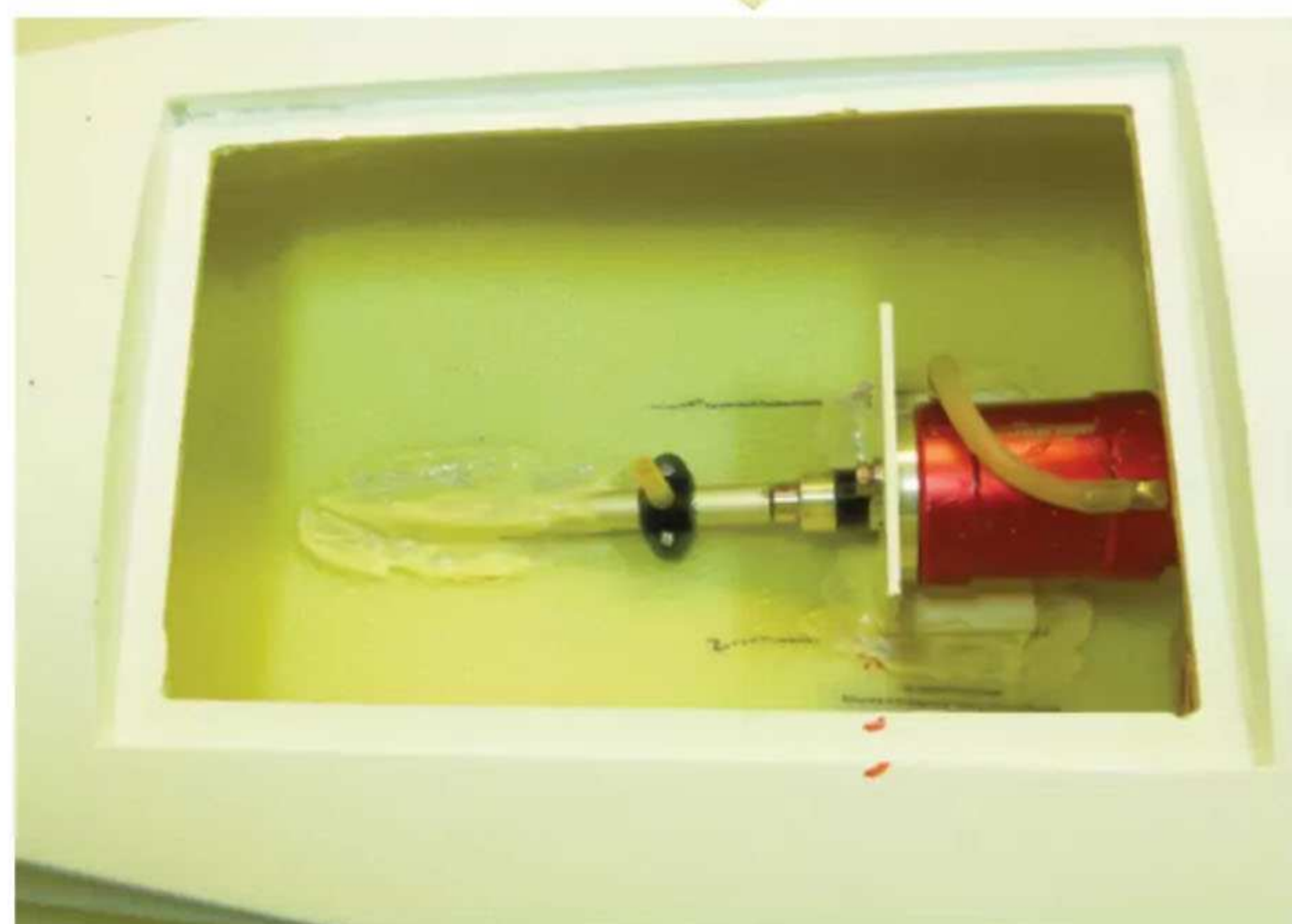
Der fertig eingebaute Leopard-Brushless-Motor
