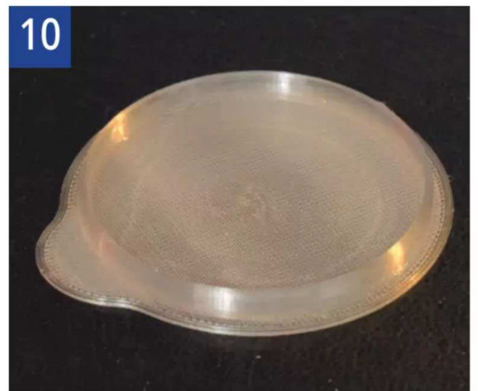
Der 3D-Druck erlaubt auch die Herstellung maßgeschneiderter Deckel
