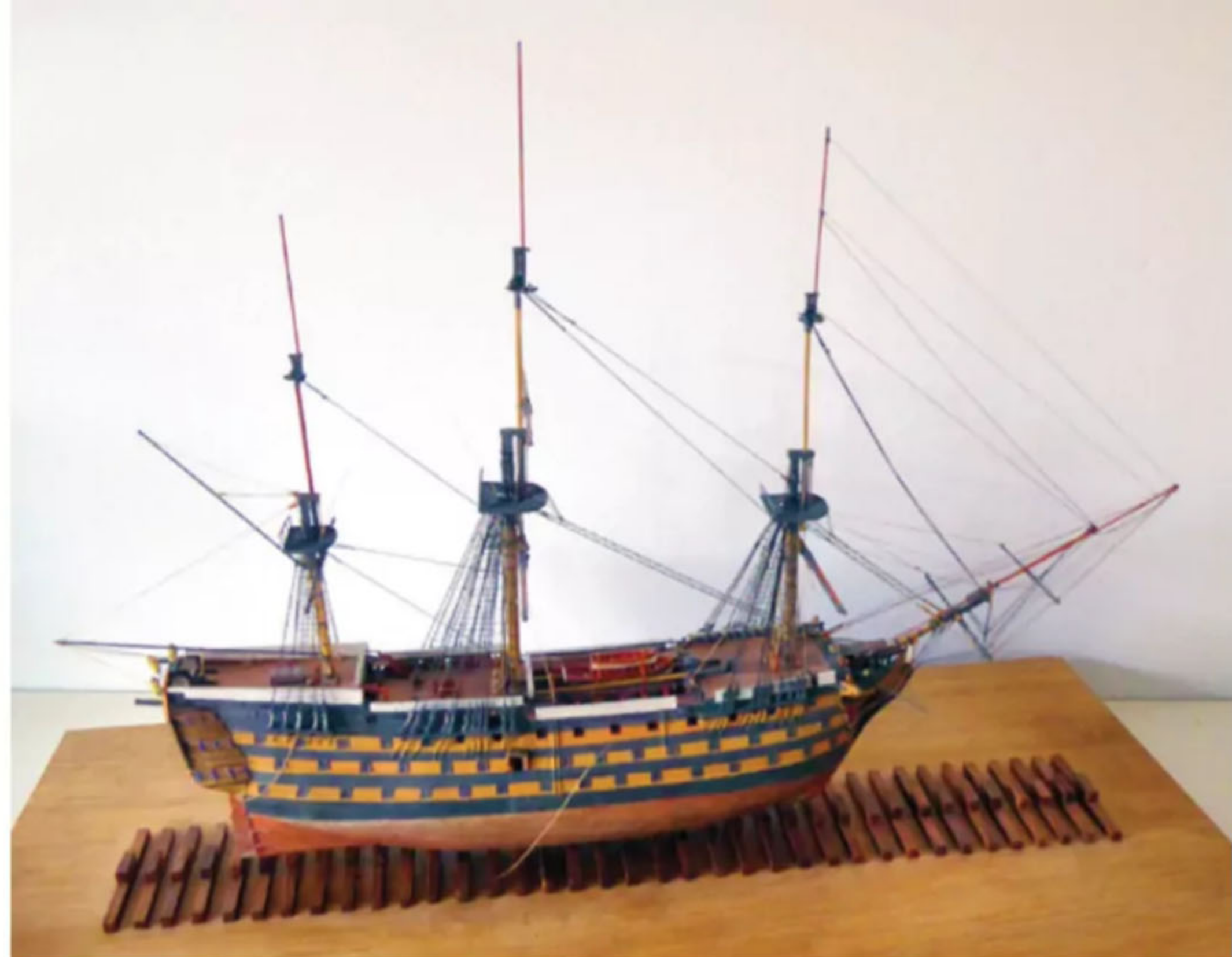
Das Stehende Gut wird gerade aufgebaut. Der Anfang der langen und mühsamen Takelarbeit. Jedes gesetzte Tau änderte das Gesamtbild des Modells
