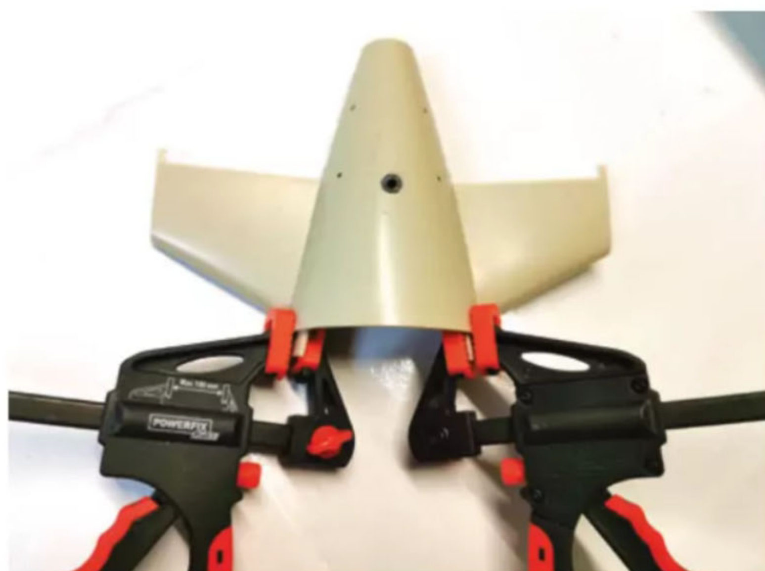
Verkleben der Auflageflächen im Heckkonus
