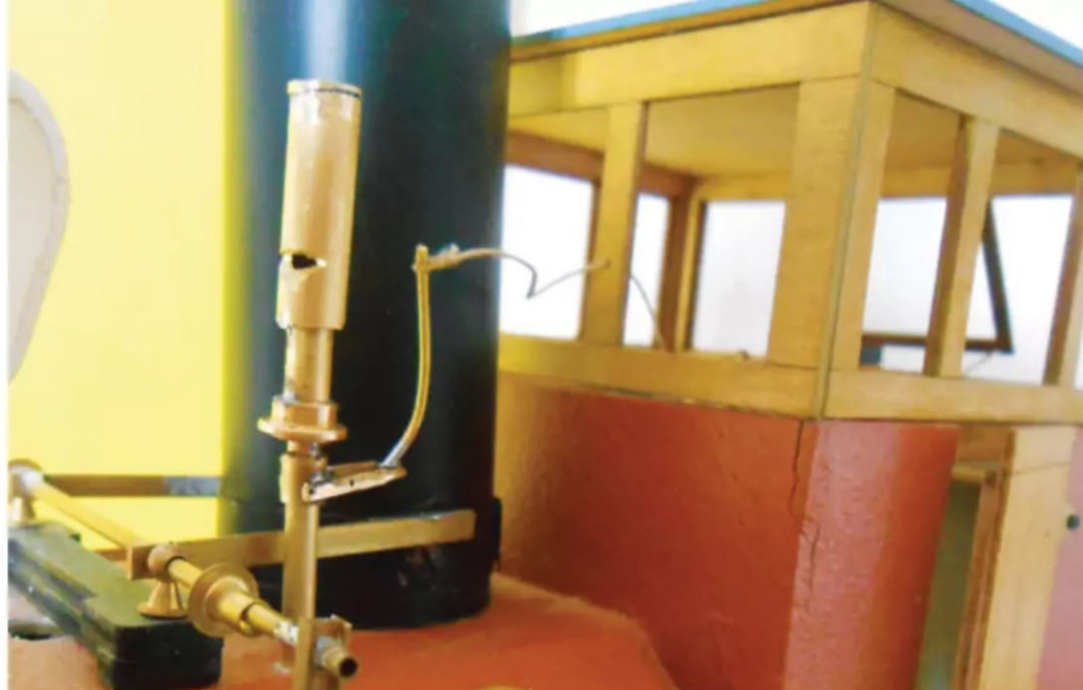
Die Dampfpeife im Modell - die Betätigung erfolgt über einen Seilzug aus dem Ruderhaus
