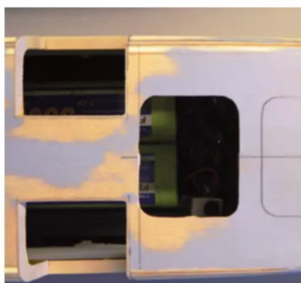
▲ Ausschnitte im vorderen Aufbau für Lukendeckel und Lüftergitter ▲
