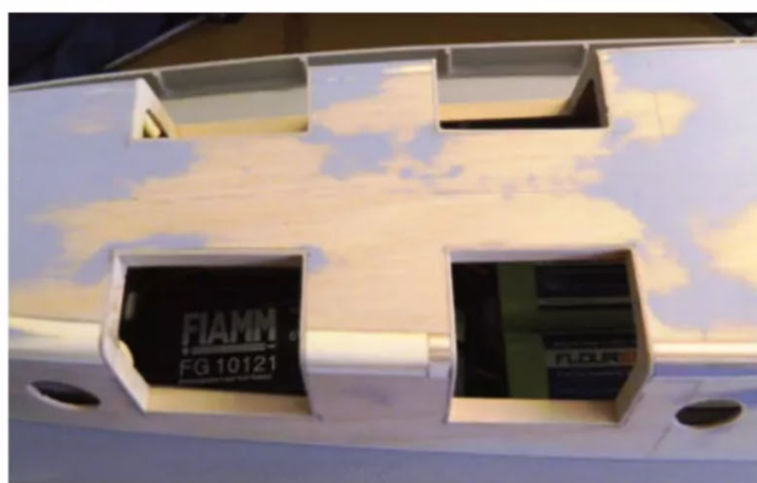
▲ Ausschnitte im vorderen Aufbau für Lukendeckel und Lüftergitter ▲
