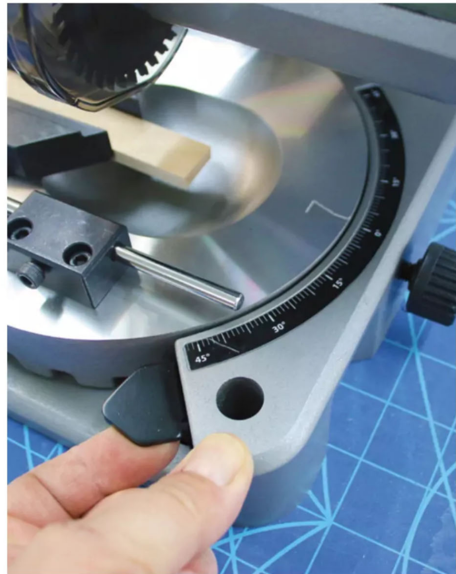
▲ ▼ Der Rundtisch aus Alu-Druckguss lässt sich beidseitig stufenlos bis 45° schwenken und feststellen. Durch Lösen der Arretierung kann der Tisch schnell in 15°-Schritten in vorhandene Raster geschwenkt werden
