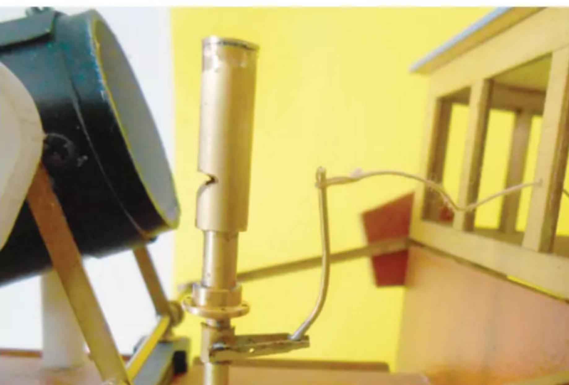
Die Dampfpeife ist auch bei umgelegtem Schornstein betriebsbereit
