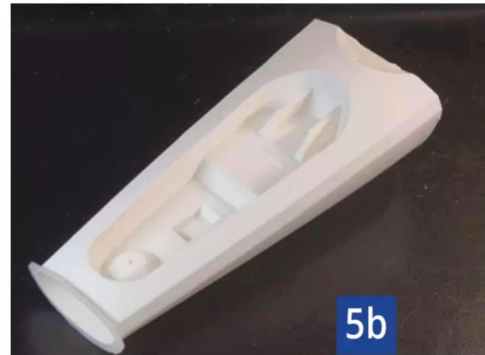
Abb. 5: Die Technikwanne enthält die notwendigen Halterungen für die Empfangs- und Ruderanlage. Der Heckspiegel wird als separates Teil eingesetzt. Abb. 5a (links) zeigt das CAD-Modell, Abb. 5b zeigt ein gedrucktes Testmuster
