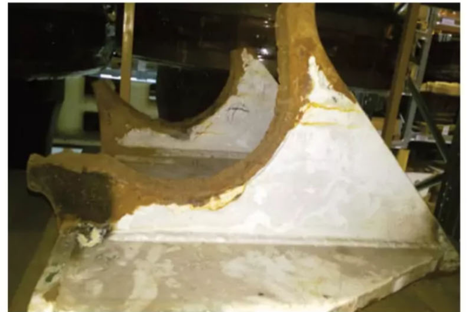
Nahaufnahme des gebrochenen Visierscharniers (Steuerbordseite). Foto: Stenborg, Per-Erik, Sjöhistoriska museet, CC BY-SA 4.0
