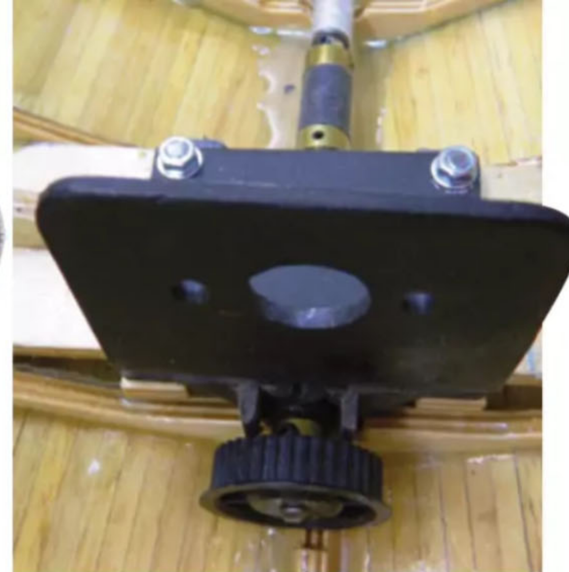
^ Angetrieben wird das Boot von einem Speed 700 Turbo in Kombination mit einem Zahnriemengetriebe ^
