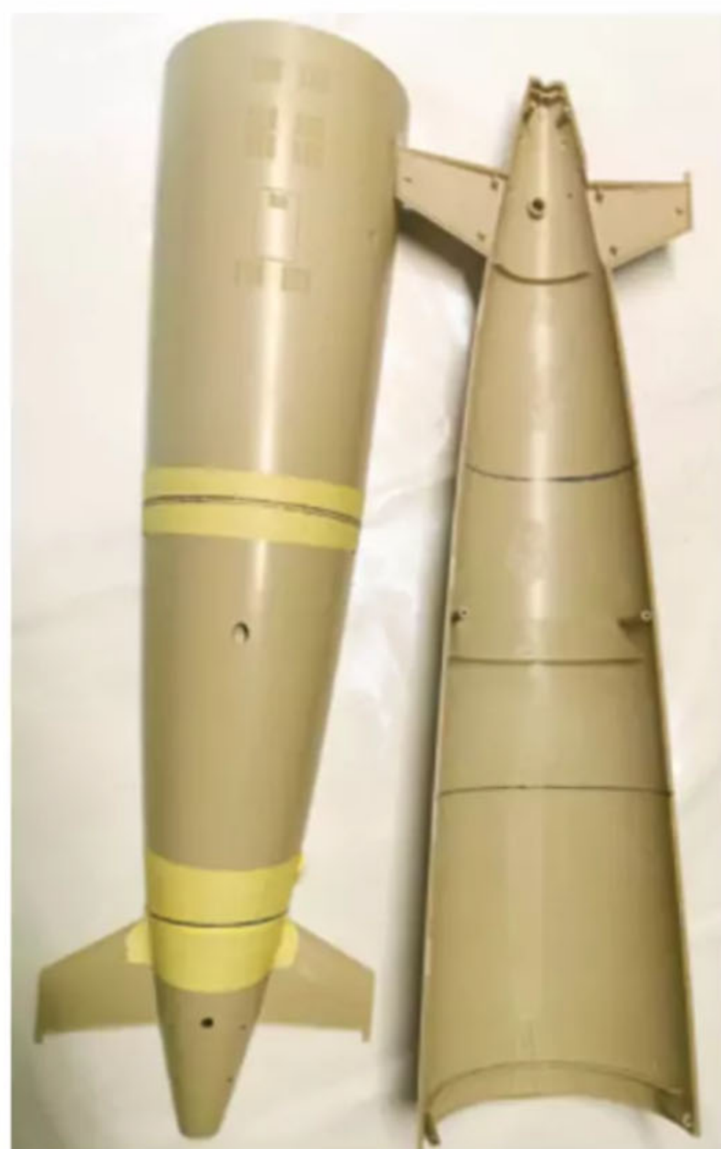
Die Positionen zum Verkleben und Trennen der Rumpfteile
