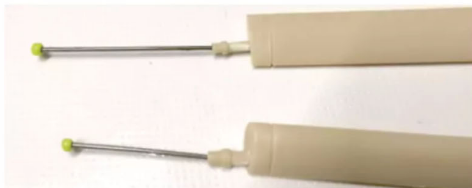
Die Kunststoffgestänge der Ausfahrgeräte wurden gegen Stahldraht ersetzt. Sie wirken nur auf dem Foto schief
