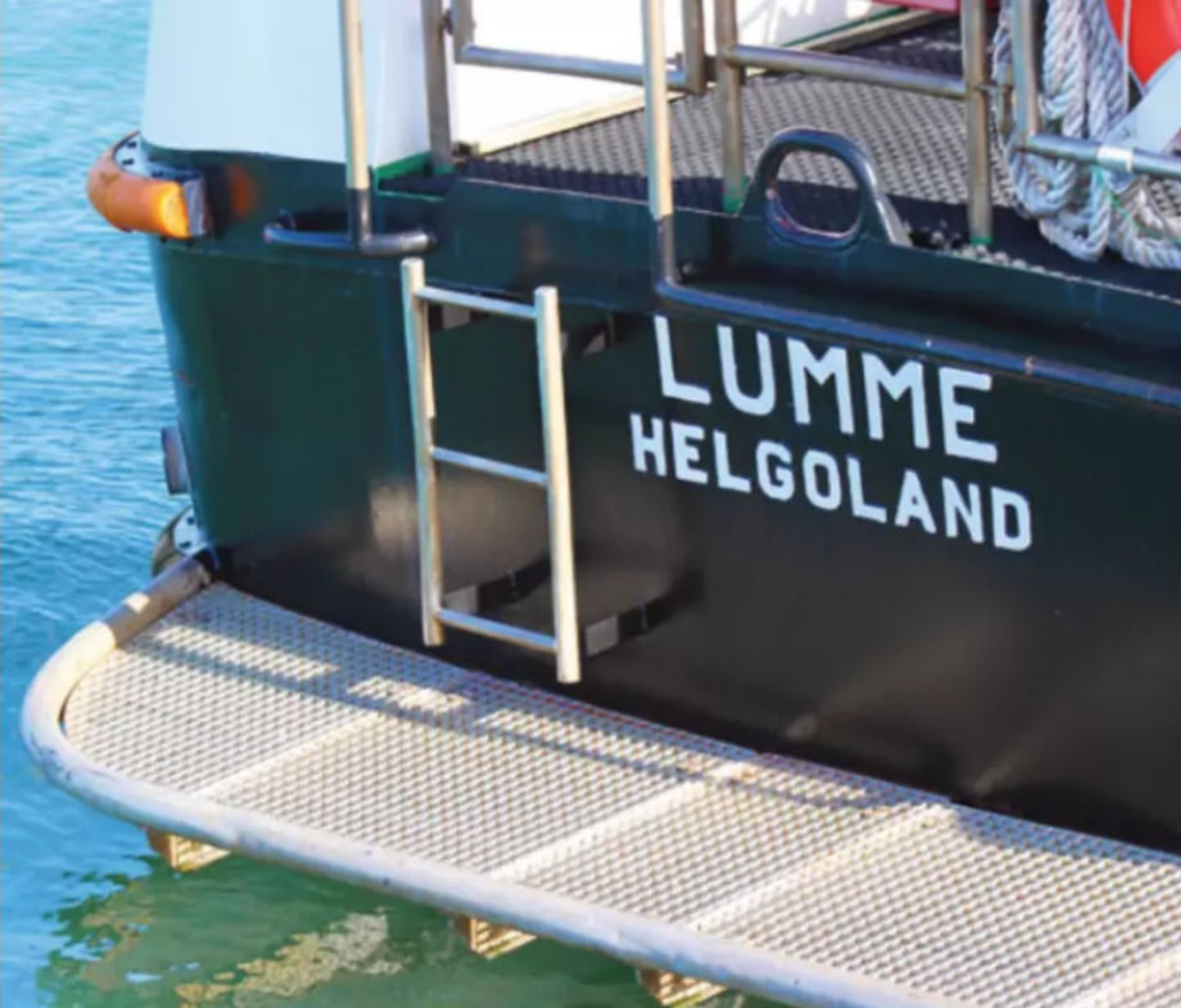
▲ Die Heckplattform der Lumme . Durch den Gitterrost kann das Wasser gut ablaufen
