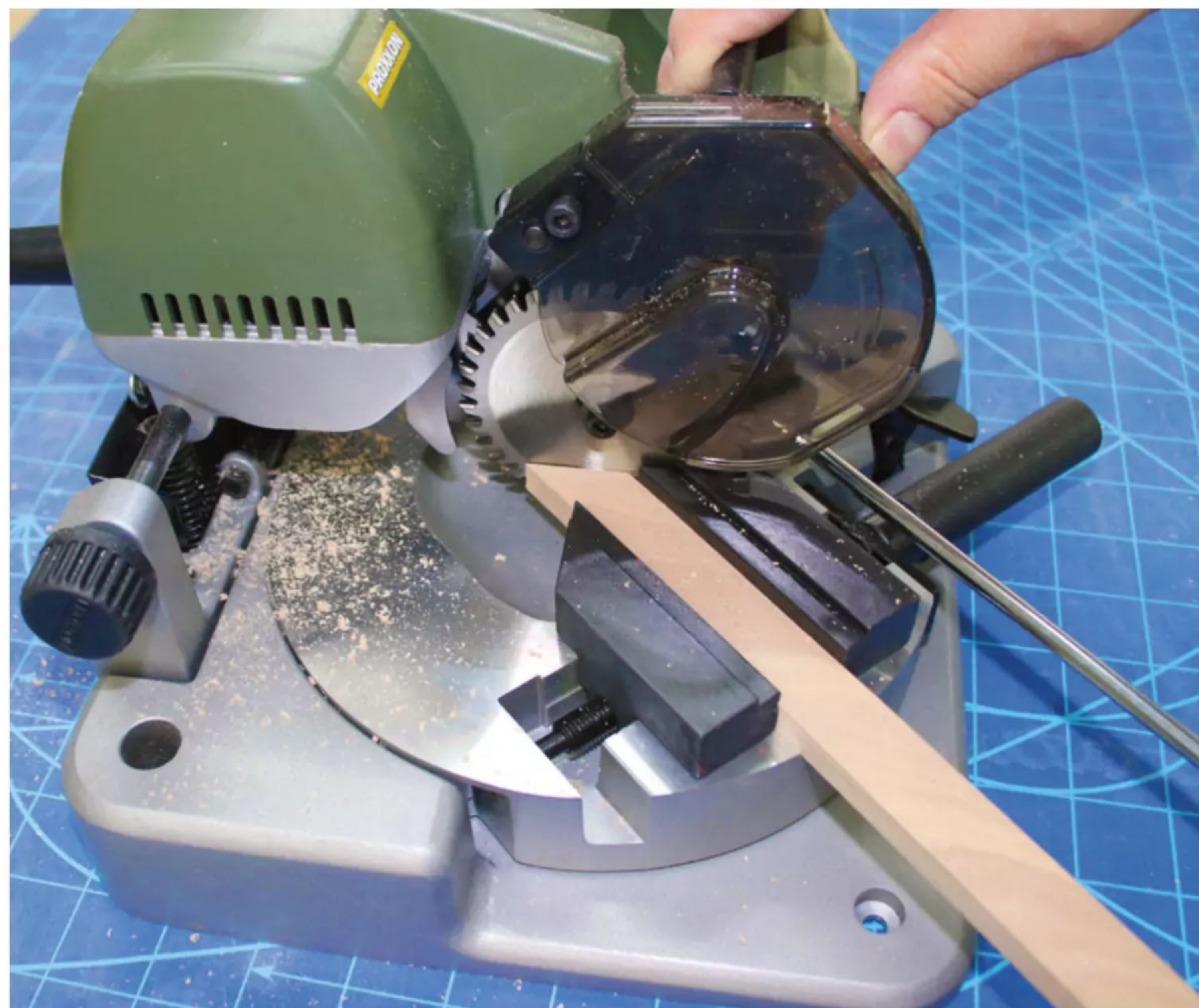
▲ ▼ Der Rundtisch aus Alu-Druckguss lässt sich beidseitig stufenlos bis 45° schwenken und feststellen. Durch Lösen der Arretierung kann der Tisch schnell in 15°-Schritten in vorhandene Raster geschwenkt werden
