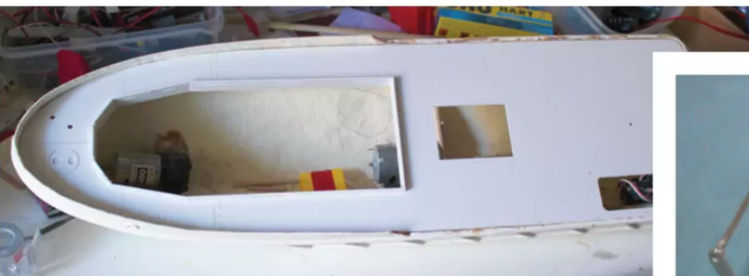
Die Technik ist drin, nun wird das Deck aufgeklebt
