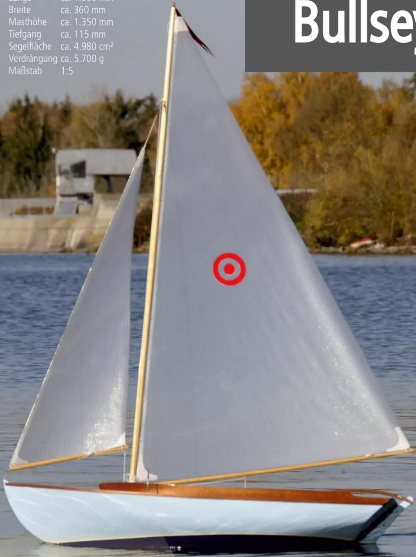
Semi-Scale-Nachbau des gleichnamigen Originals von Herreshoff. Die guten Segeleigenschaften des Originals sind auf das Modell übergegangen. Es segelt wie die großen, will aber auch aktiv gesteuert werden. Zum Abfallen müssen die Segel geöffnet werden und Wenden verlangen nach dichten Segeln. Böen müssen durch Fieren der Schoten, oder durch leichtes Anluven ausgesegelt werden.
