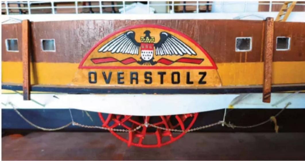
Dieses Schmuckstück wurde am PC entworfen und besteht aus Messing. Es ist im Photo-Ätzverfahren entstanden und wurde mit Emaille-Farben bemalt und dann aufgeklebt. Auch die Buchstaben sind so entstanden
