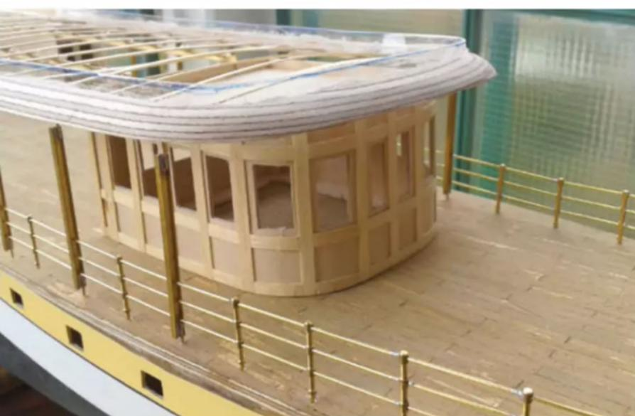
Das ist die Heckpartie. Der Pavillon ist aus Holz gebogen, darauf wurden dünne Leisten geklebt, um ein Fachwerk zu imitieren. Die Reling ist bereits verlötet. Die Pfosten bestehen aus Messing-H-Profilen
