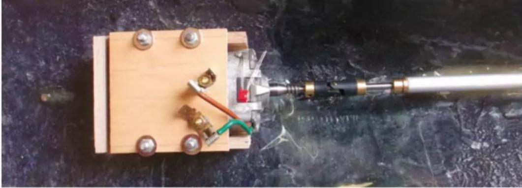
Ein ausrangierter Scheibenwischermotor dient als Antrieb
