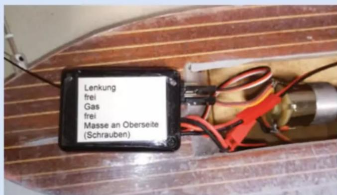
Fahrtregler und Empfänger sind wassergeschützt in einer „Strapubox“ untergebracht. Im Bugbereich ist nicht nur Platz für die Box, hier platzierte ich auch die Platine zur Schaltung der Beleuchtung
