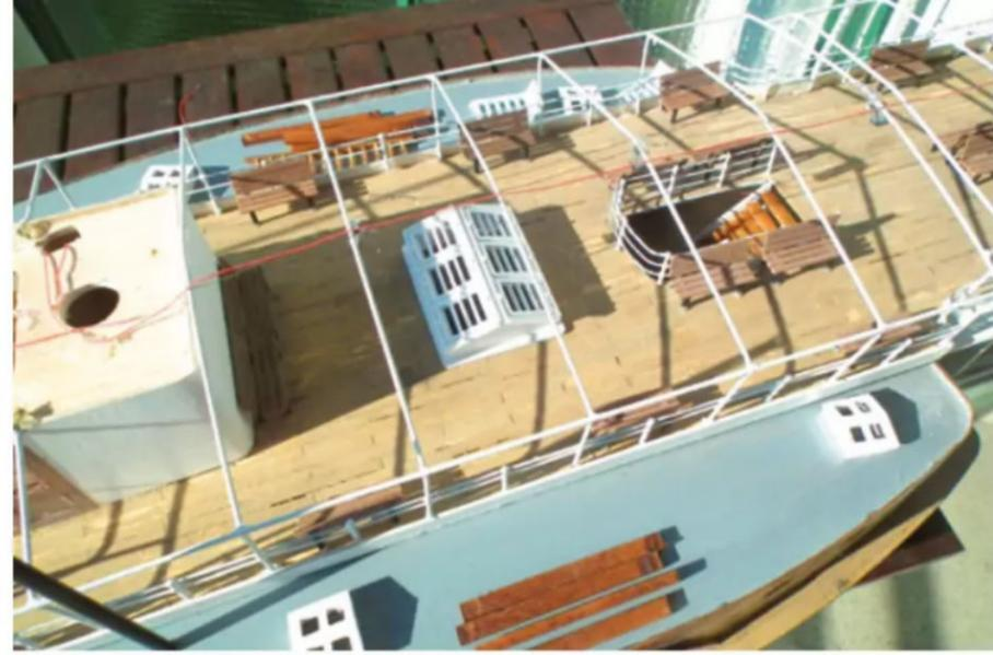
Das Deck ist fertig. Über dem Maschinenschacht sitzen die Oberlichter – ein Fertigbauteil aus dem Handel. Die Bänke sind mit Hilfe des 3D-Druckers selbst gebaut. Das Gestell für die Persenning ist aus Messing gebogen
