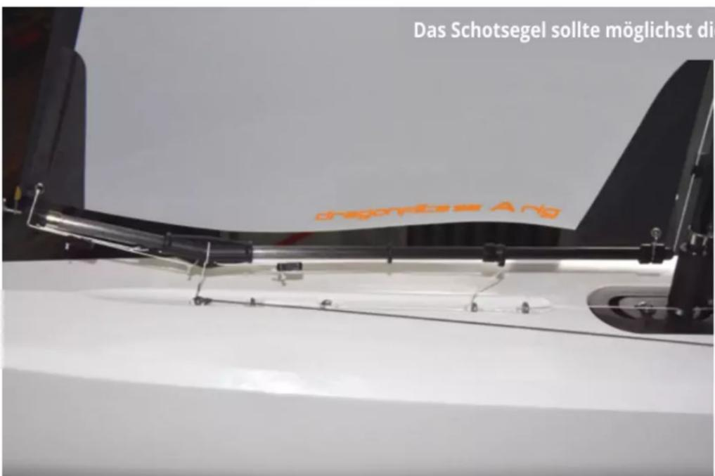
Das Schotsegel sollte möglichst dicht an den Rumpf gezogen werden
