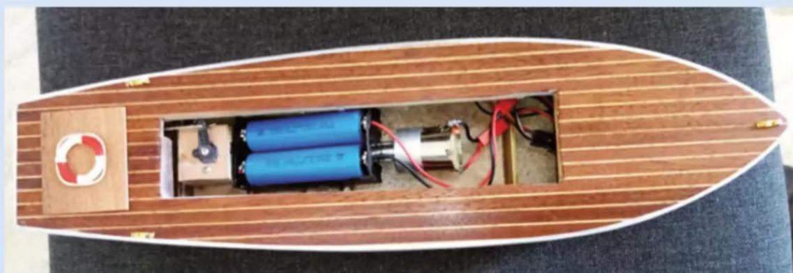
Der Fahrakku besteht aus zwei LiFePo4-Zellen der Baugröße 18650. Auf dem Bild liegt der Akku längs, damit man ihn besser erkennen kann. Der Schwerpunkt wäre so relativ hoch und nicht optimal. Der Akku liegt deshalb später quer vor dem Lenkservo auf dem Rumpfboden
