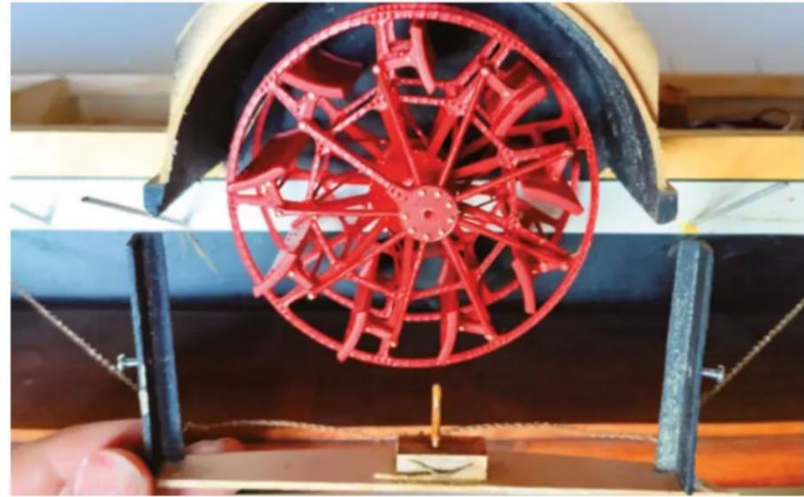
Hier sieht man das zusammengebaute Rad in seinem Kasten. Man sieht auch, wie die Exzenter funktionieren. Sie müssen von außen geführt werden – und zwar etwas vor der Radachse. Im Rahmen sitzt ein Stift, der das erledigt
