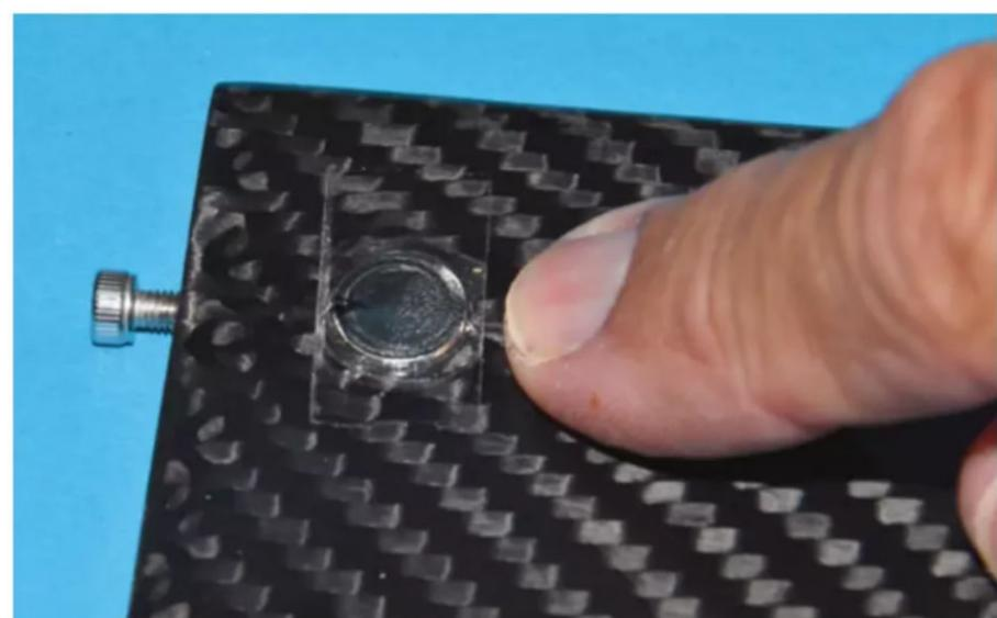
Das Kielschwert ist aus CFK. Mit den Schrauben wird die Kielbombe befestigt und das Ganze oben am Rumpf gesichert
