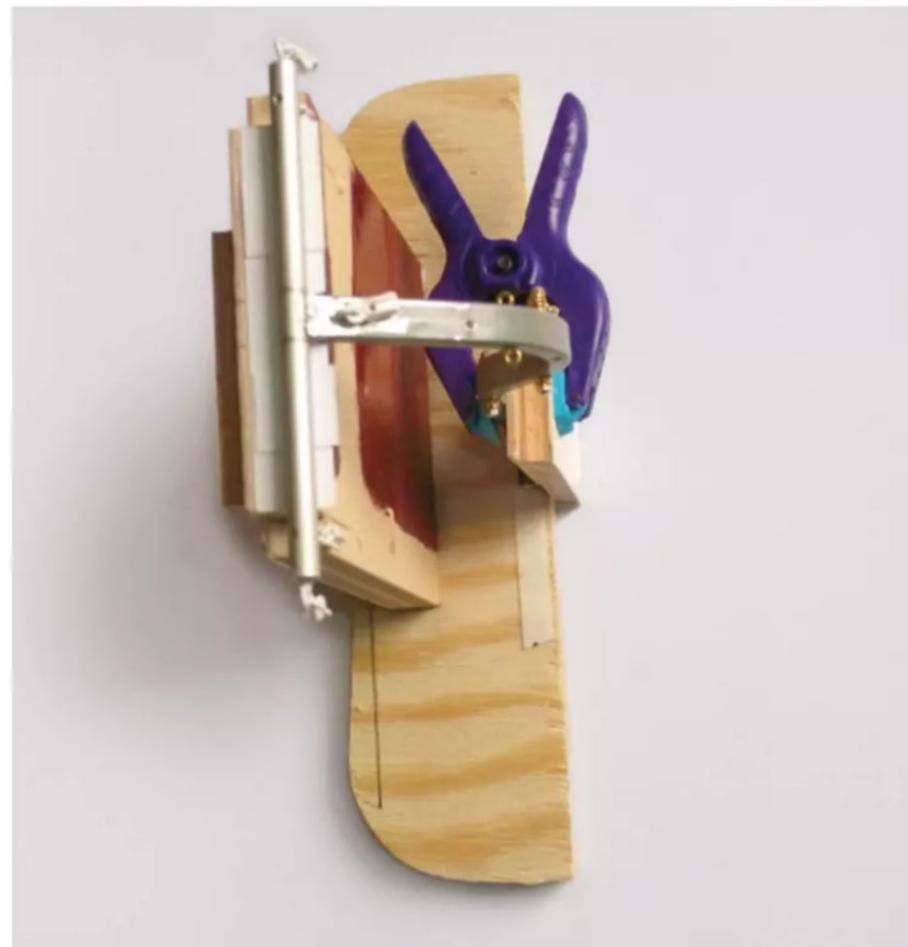
Die Klebevorrichtung für die Einbeinbarkune, mit der das Beiboot zu Wasser gelassen wird
