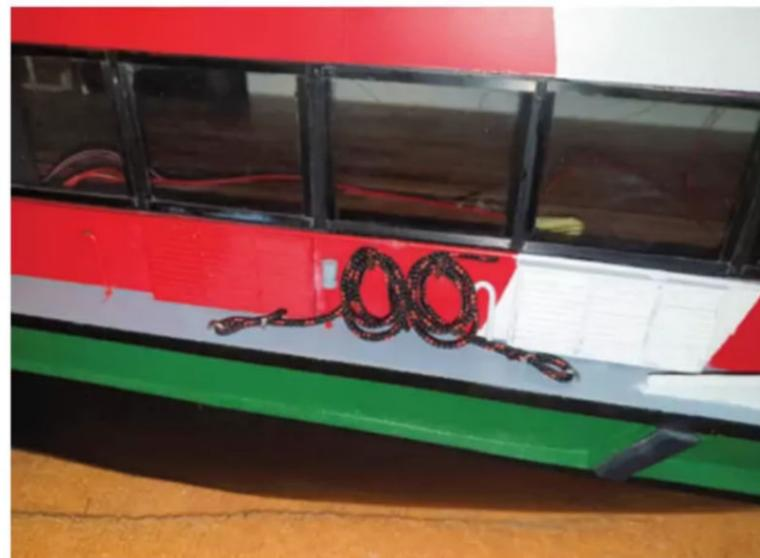
Entlüftungsgitter, Schwanenhälsa, Überläufe und Tauwerk
