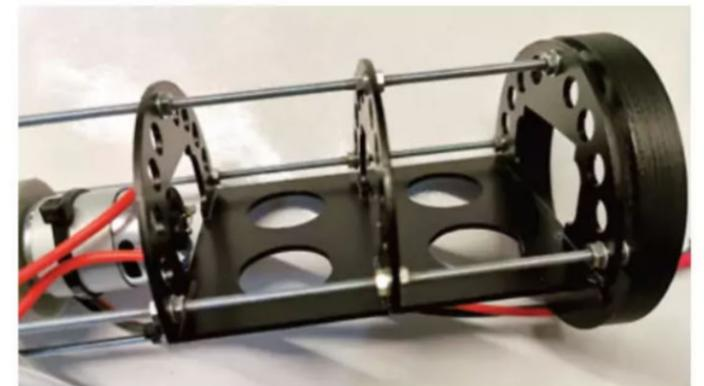
Der angebaute, gedruckte Verschlussring und der Akkuschaft laut Bauanleitung
