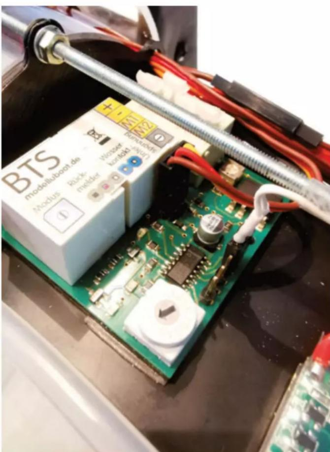
◀ Die eingebaute Balasttanksteuerung
