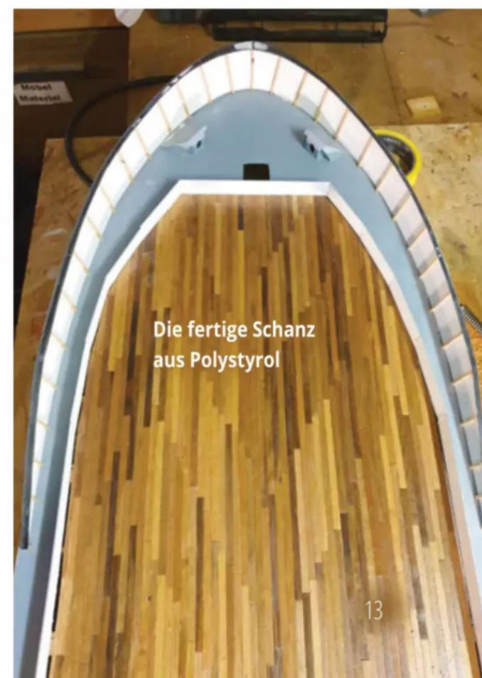
Die fertige Schanz aus Polystyrol
