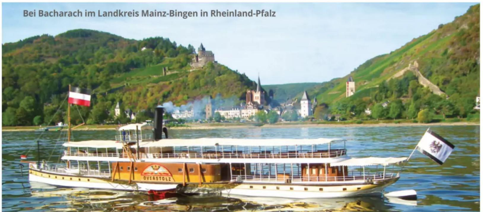
passgenau auf den Radspiegel kleben. Auch an Bug und Heck findet man filigrane Teile aus Messing. Auf der Höhe des Wasserspiegels verläuft eine kleine Messingkette, um Treibgut vom Schaufelrad fernzuhalten. Im Modell funktioniert das natürlich nicht so gut.
