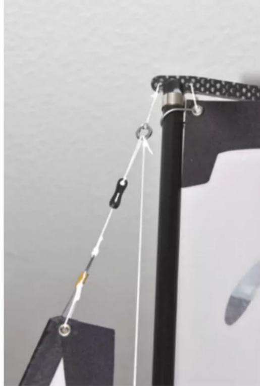
Hier ist die Fock gleich mehrfach aufgehängt. Natürlich durch einen Klemmschieber einstellbar
