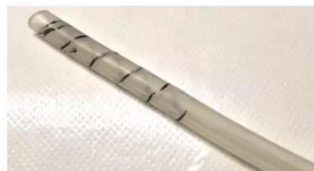
Anzeichnen des Schnittverlaufes am Schlauch
