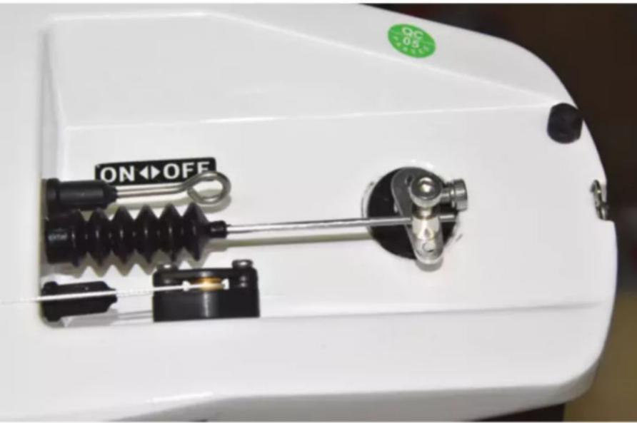
▲ Am Heck findet man die Anlenkung des Ruders, das Ein-Aus-Schaltergestänge und die Umlenkung der Leinen vom Winschservo
