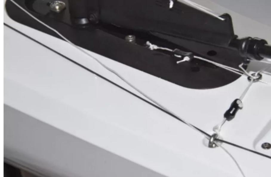
So wird die Fockschotleine geführt, damit sie nicht am Mastfuß streifen kann
