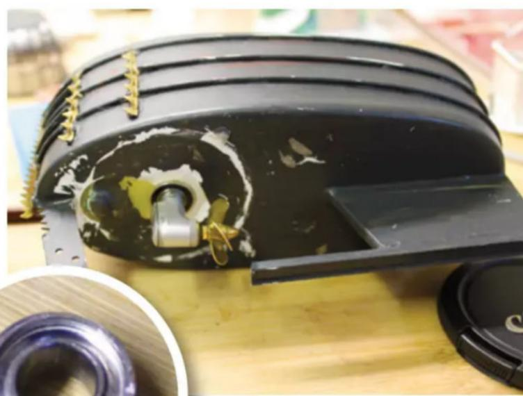
◀ ▶ Kleiner Übeltäter, große Wirkung: Das defekte Lager machte bald nach dem Neubau eine Instandsetzung notwendig
