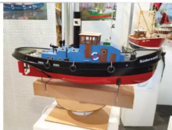
schichte des Schleppers, der typisch für die 20er- und 30er-Jahre ist, wurde in der ModellWerft-Ausgabe 05/2021 beschrieben, der ausführliche Test des Baukastens kann in der Ausgabe 11/2021 nachgelesen werden. Der Bausatz besteht aus einem ABS-Rumpf sowie Laserteilen aus Holz und Kunststoff und erlaubt eine hohe Detaillierung des Modells. Technische Daten: Maßstab 1:25, Länge 737 mm, Breite 220 mm, Höhe 380 mm. UVP: 239,- €
