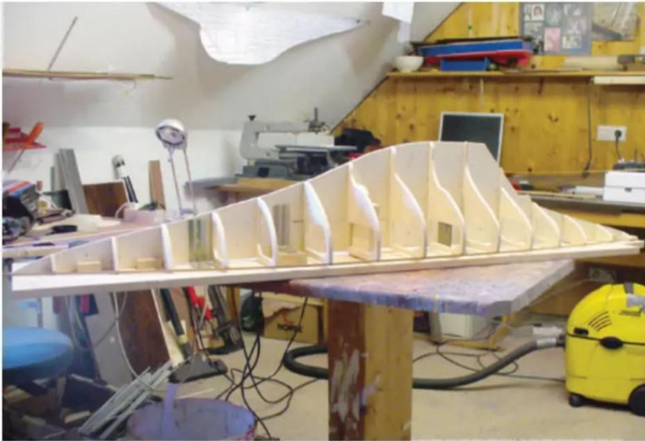
Das verleimte Spantengerüst
