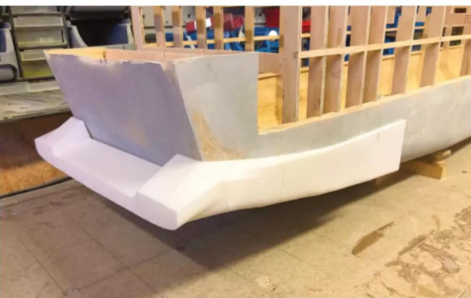
Die ersten Teile des Ducktails sind gezeichnet, gedruckt und können schon mal an den Rumpf angepasst werden
