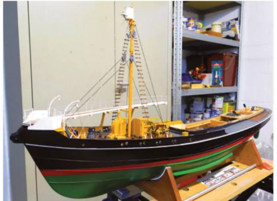
Die Bauteile des Arbeitsdecks und Winde mit fertiger Takelung des Hauptmastes
