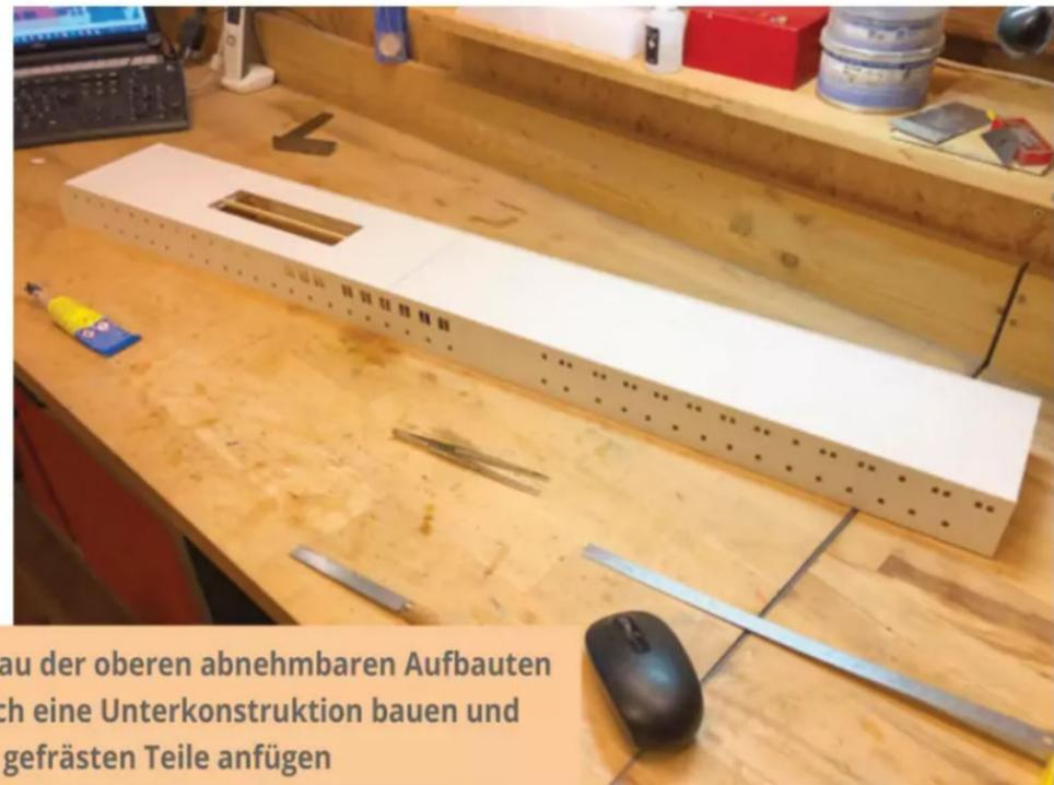
◀ Zum Bau der oberen abnehmbaren Aufbauten musste ich eine Unterkonstruktion bauen und dann die gefrästen Teile anfügen
