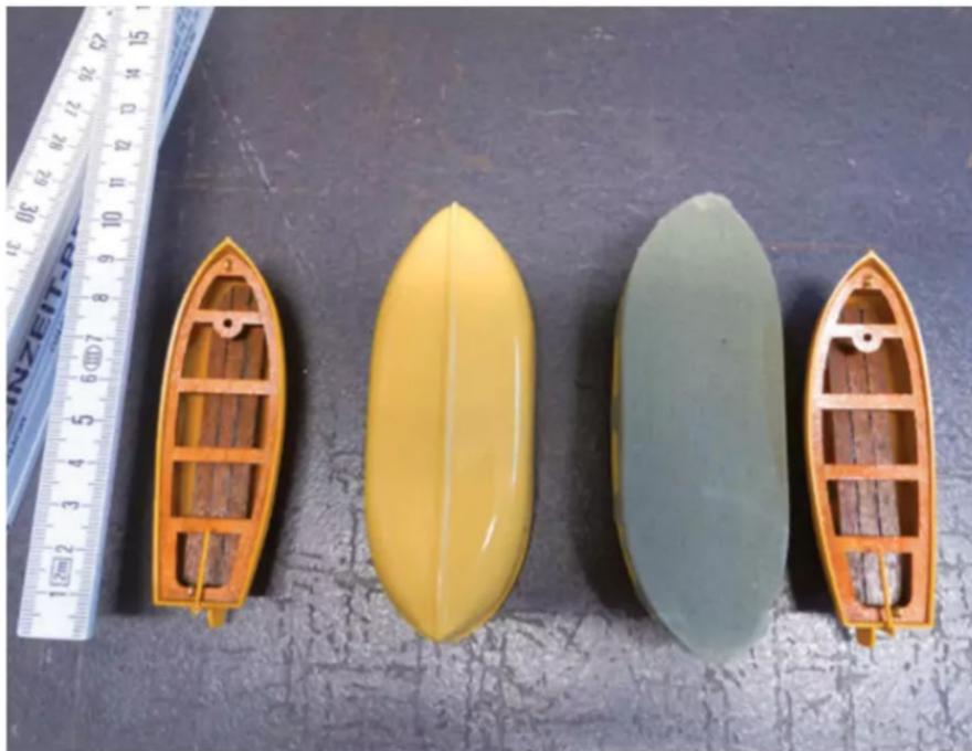
Vergleich der Bausatzboote mit den neugefertigten Rettungsbooten
