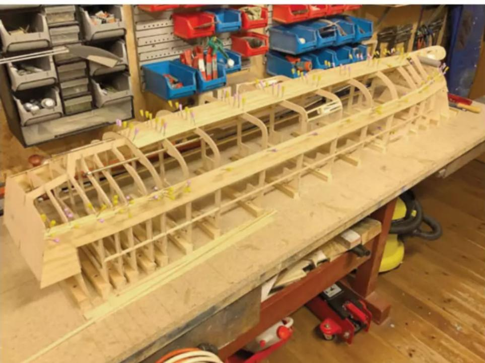
Der Rumpf wird in klassischer Überkopfbauweise gebaut
