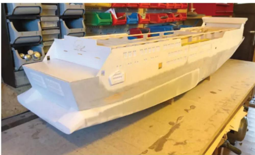
Der Ducktail mit den seitlichen Stabilisierungstanks sowie die gefrästen Rumpfseitenteile sind am Rumpf angebracht
