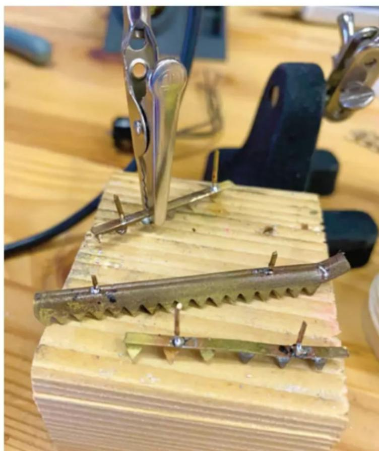
Verstiften der Greifzähne tut Not – diese Schienen greifen ja tatsächlich in das Holz der Stämme
