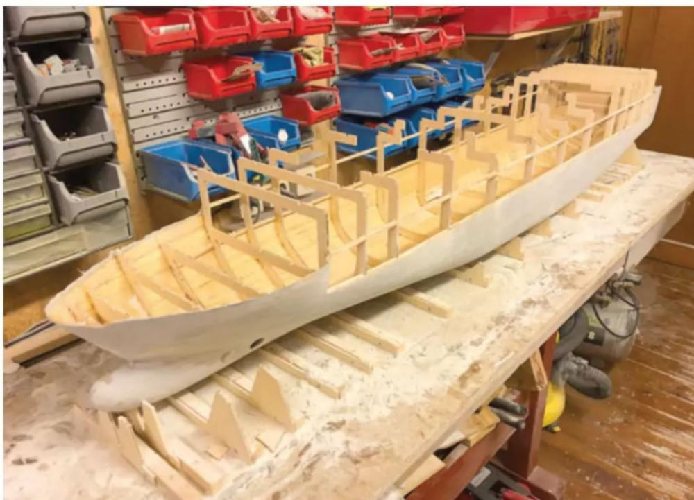
Nach dem Laminieren mit GFK sowie einer Menge Schleif- und Spachtelarbeit ist der Rohbau von der Bauhelling getrennt worden
