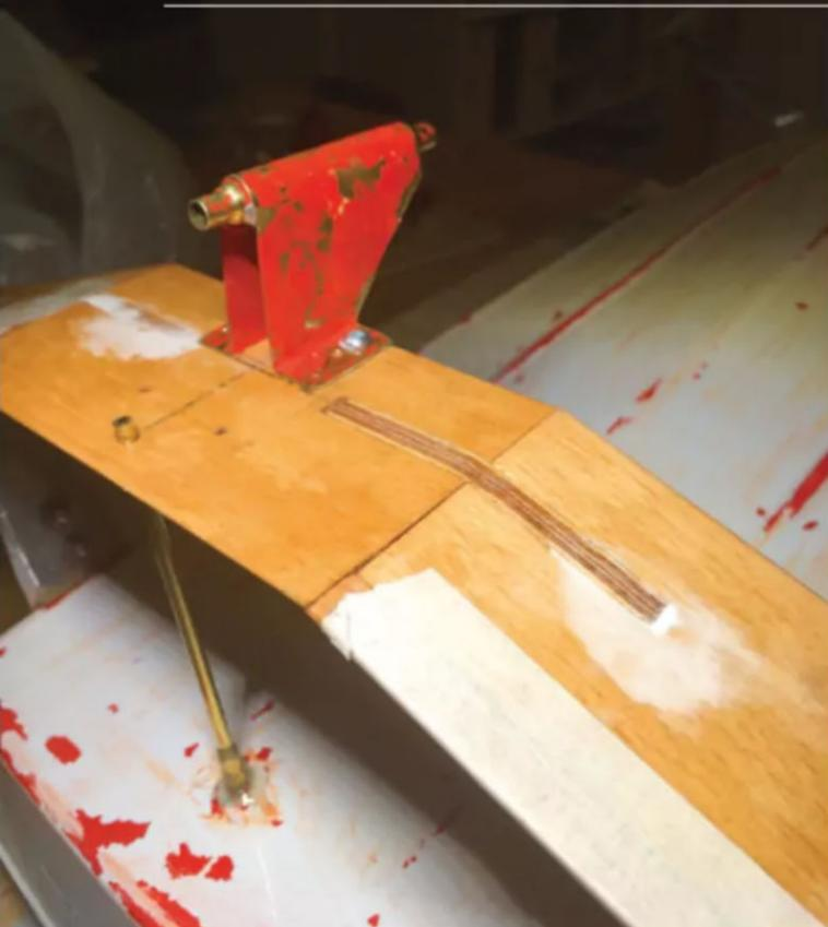
Die Antriebswellenhalterung an der hinteren Tragfläche muss wegen der neuen Ruderanlage gekürzt werden
