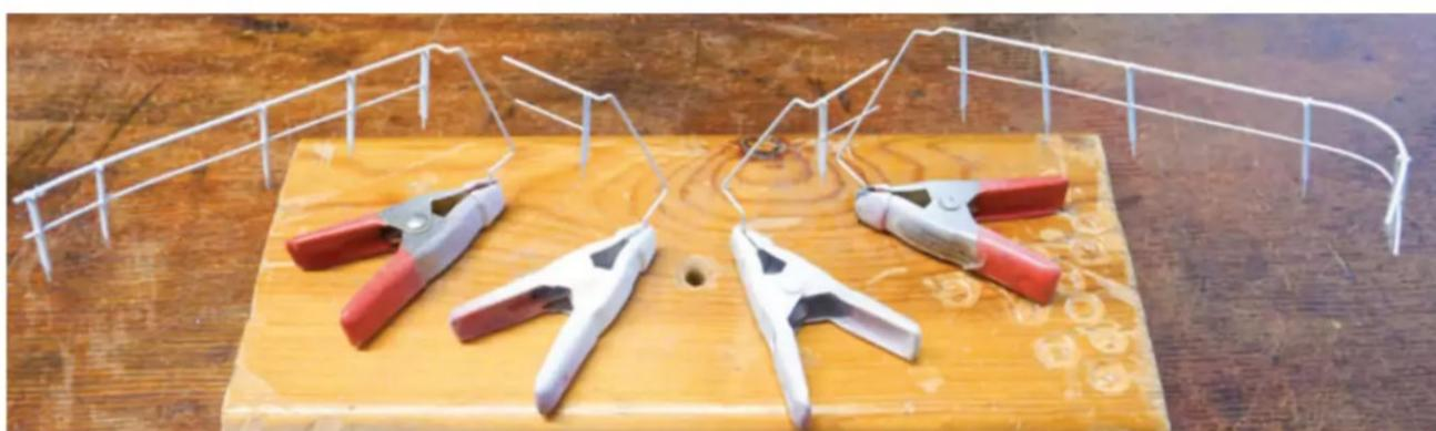
Einbaufertige Rellingteile für die Niedergänge
