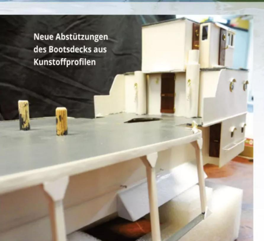
Jetzt ging es wieder mit dem Aufbau weiter. Hier wurden die Abstützungen des vorspringenden Bootsdecks aus Holzteilen (sehr spröde und empfindlich) ersetzt und aus Kunststoffprofilen neu aufgebaut. Die beiliegenden Türen des Aufbaus wurden als Schablone verwendet und diese aus dickerem Mahagonifurnier neu gefertigt. Abschließend wurden aus Messingprofilstücken die Scharniere und Türgriffe gefertigt und angebracht.
