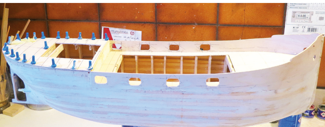
Das Deck wurde aufgelegt und die Lenzöffnungen ausgefeilt
