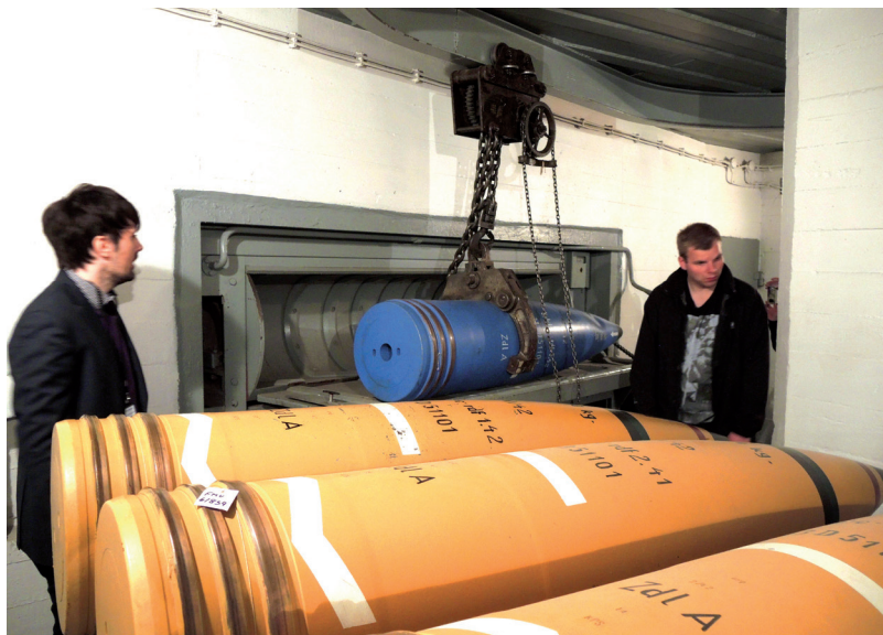
Granaten im Magazin. Die blaue Panzersprenggranate im Hintergrund befindet sich in der gasdichten Schleuse zum Barbetteneinnenbereich
