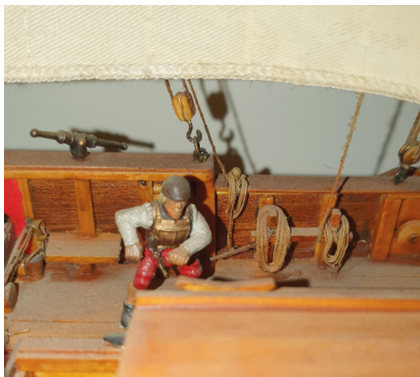
Die Reling innen mit dem Kreuzholz und dem Lagerzapfen für das Leitwerk, im Vordergrund das Deckshaus
