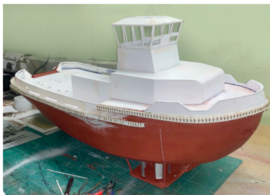
Bau des Schanzkleides und grober Aufbau
