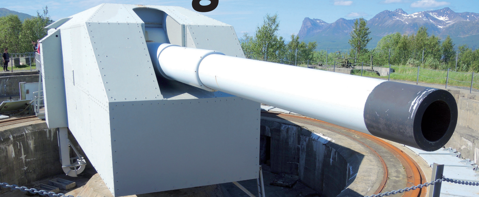
Rohr Nr.12 mit beeindruckenden Zahlen: 21,5 m Rohrlänge, fast 159 Tonnen schwer
