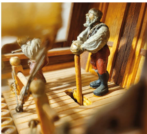
Der Steuermann mit dem Kolderstock für die Ruderanlage
