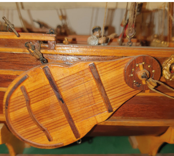
Das Leitwerk in angehobenem Zustand, der Lagerbolzen für das Leitwerk ist mit einem Keil gesichert
