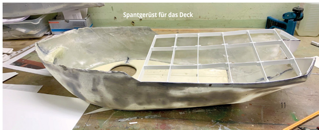
Der Rumpf mit einlaminierter Aufnahmeplatte für die Voith-Antriebe
