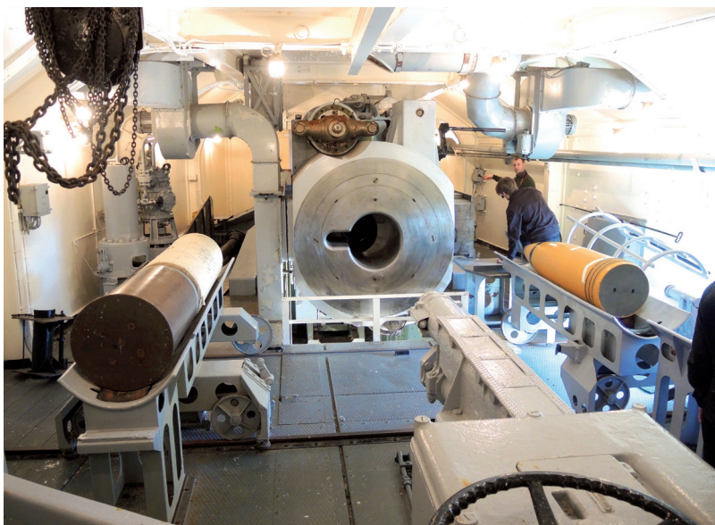
Im Geschützturm, Blick von achtern. In der Bildmitte der Boden des 40,6-cm-Geschützes mit halbgeöffnetem Verschlusskeil. Links davon die zwei Kartuschen der Treibladung, rechts eine 1,3 Tonnen schwere Sprenggranate. Im Bildvordergrund (Mitte) der Ansetzer. 20 Mann waren in diesem Turm beschäftigt
