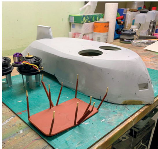
Dockplatte zum Schutz der Voith-Antriebe (vorn)
