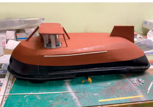
Der fertige Rumpf mit Dockplatte und Voith-Antrieben
