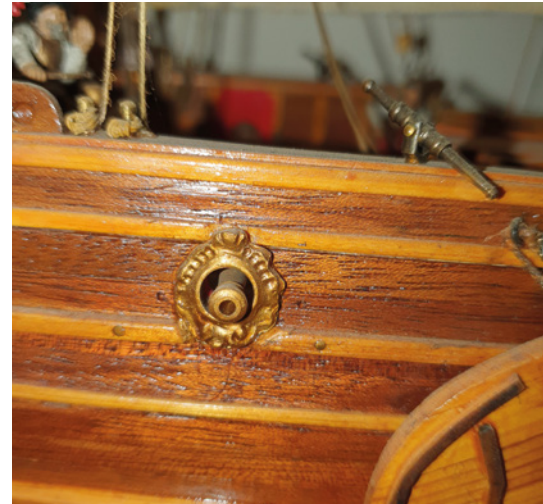
Die Stückpfortenverzierung mit Geschütz und eine auf der Reling montierte Drehbasse
