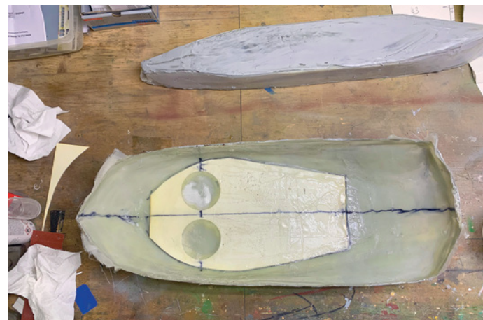
Der Rumpf mit einlaminierter Aufnahmeplatte für die Voith-Antriebe
