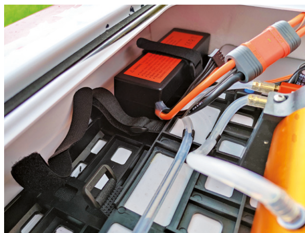
Die Akku-Rutschen, links und rechts im Rumpf, bieten reichlich Platz für Variationen des Schwerpunktes
