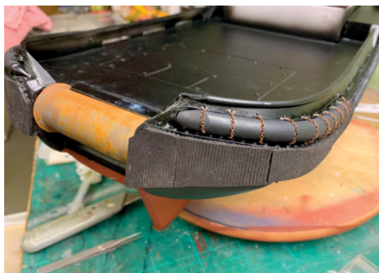
Heckrolle und fertige Gummifender
