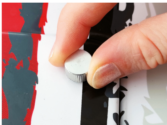
Die Haube wird mit Daumenschrauben fixiert
