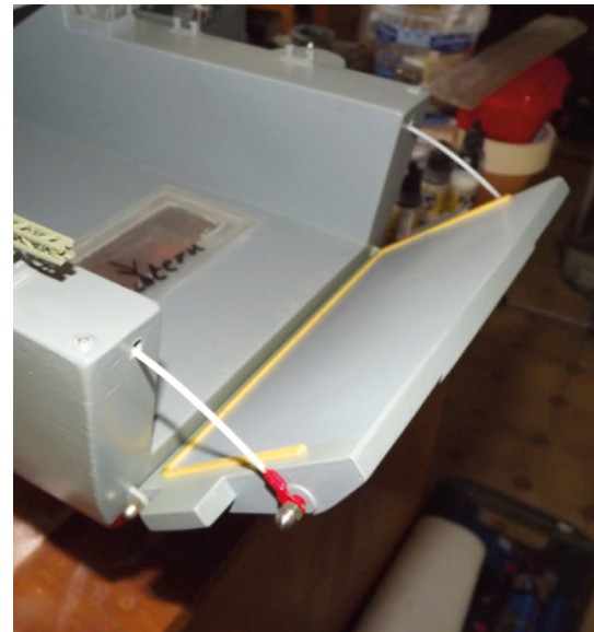
Die Mechanik zum Öffnen und Schließen der Heckklappe
