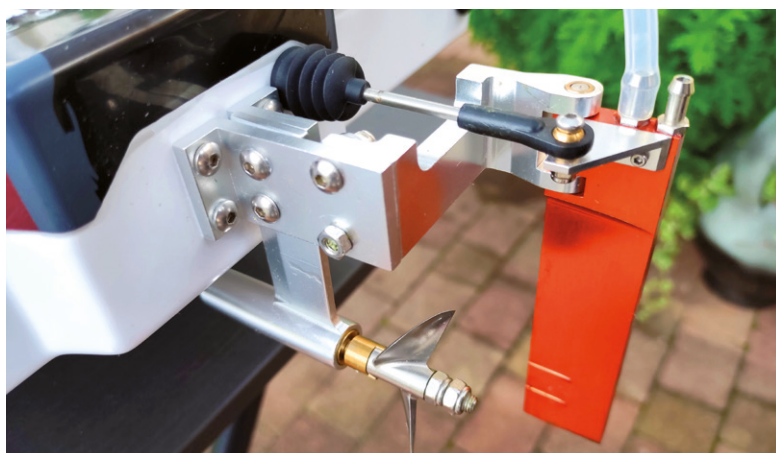
Die massive Alu-Aufnahme für Propeller und Ruder
