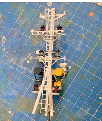
Der Mast nach dem Verkabeln mit den LEDs
