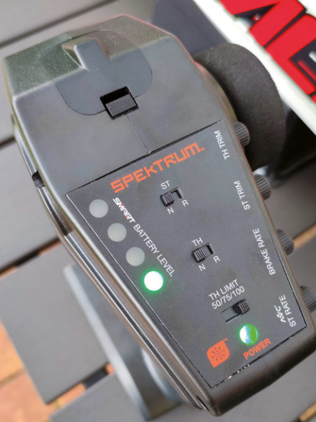
LEDs zeigen während der Fahrt, wieviel Power noch im Akku ist
