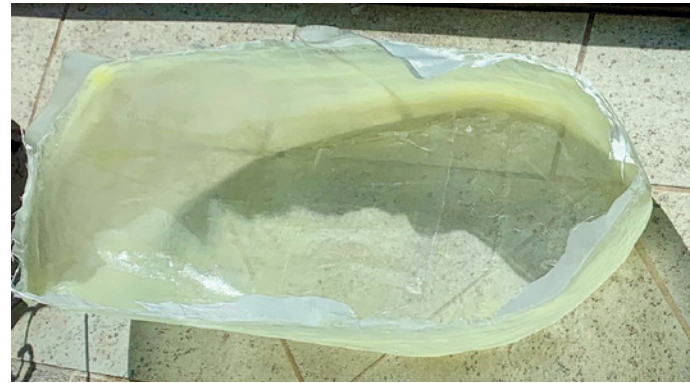
Der Rumpf nach dem Entformen des Spantgerüsts
