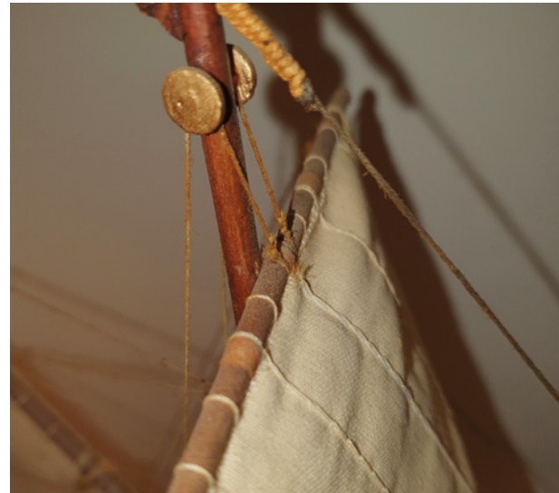
Das Rahsegel mit der Rahstenge am Mastkopf
