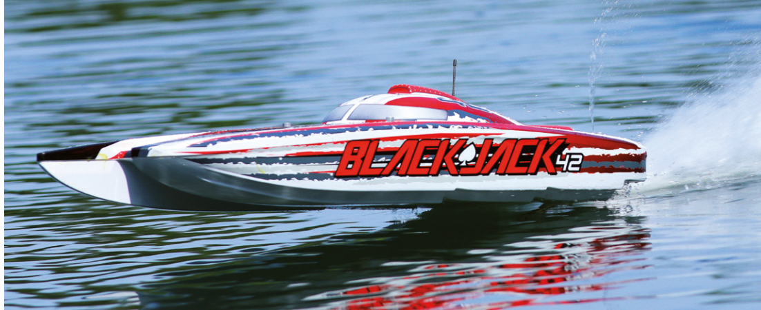
Mit zunehmendem Speed hebt sich der Rumpf immer weiter aus dem Wasser
