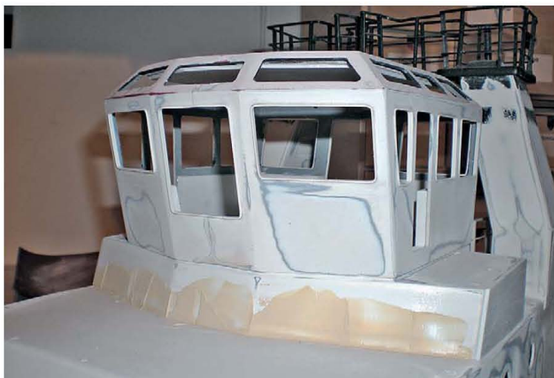
▲ Das Steuerhaus ist grob verschliffen und bereits mit eingeklebten Fensterrahmen versehen
