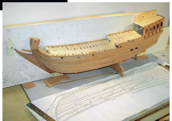
▼ Die fertige Rumpfhalschale mit den Hilfsspanen
