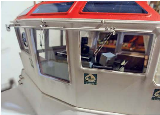
▲ Die filigranen Scheibenwischer wurden aus Beinchen von LEDs gebogen und gelötet. Auf diesem Bild ist auch gut die vordere Scheibenwaschanlage zu sehen
