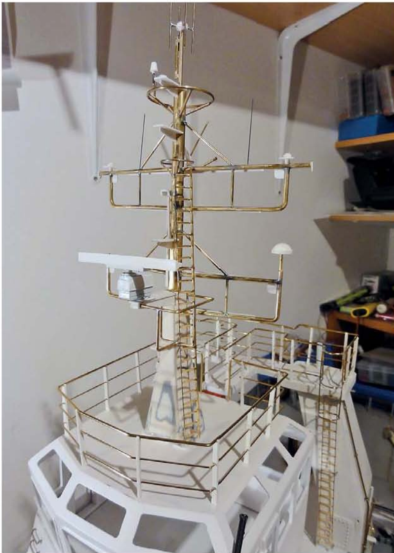
▲ Der fertig gebaute Mast besteht hauptsächlich aus Messing und Polystyrol
