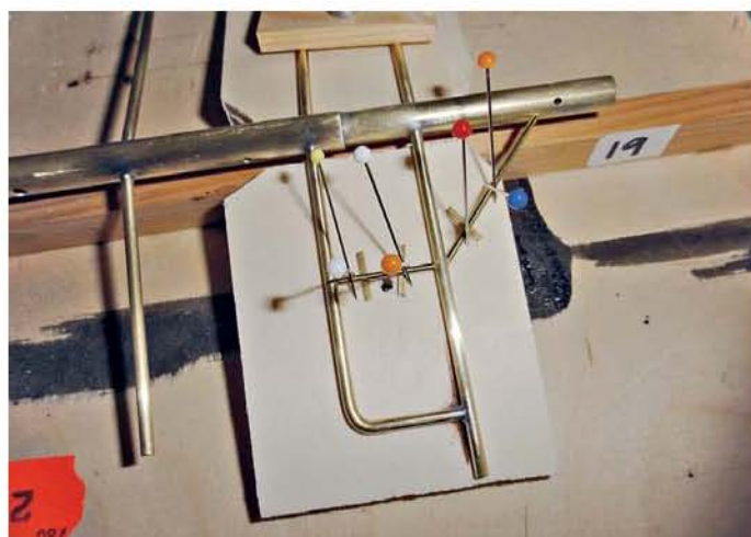
▲ Nach anfänglichem Zögern wurde der Mast komplett neu aufgebaut. Auf dem Bild sieht man eine Hilfsvorrichtung für das exakte Zusammenlöten der Teile
