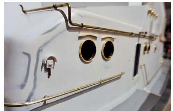
Am Aufbau sind eine Vielzahl von Details wie Wasserleitungen, Handläufe, Bullaugen, Schalter, Lüfter etc. anzubringen
