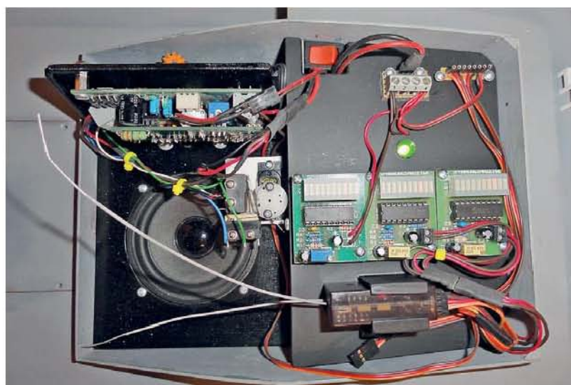
▲ In der Öffnung unter dem Aufbau befinden sich das Soundmodul und der Lautsprecher, der Empfänger, die Spannungsanzeigen sowie der Hauptschalter und die Steckverbindungen zum Aufbau
