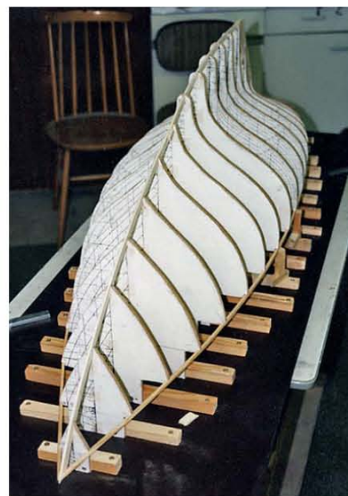
Das Spantengerüst auf der Helling
