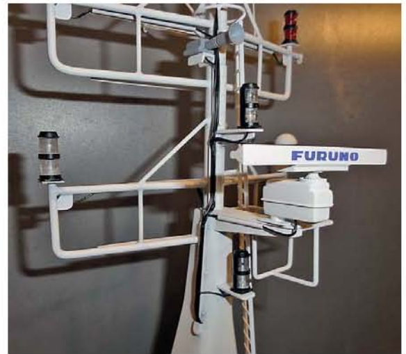
▲ Der Mast ist fertig lackiert. Die Kabel verlaufen vorbildgetreu in Kabelkanälen an der Außenseite
