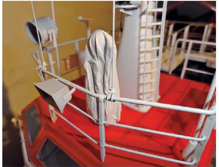
▲ Auf dem Peildeck steht der Magnetkompass unter einer Persenning. Diverse Antennen und Scheinwerfer komplettieren die Ausrüstung
