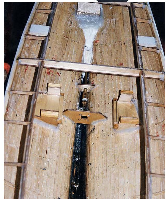
Das Achterschiff mit den anlamierten Halterungen für die beiden Segelwinden, das Ruderservo und Motorhalterung
