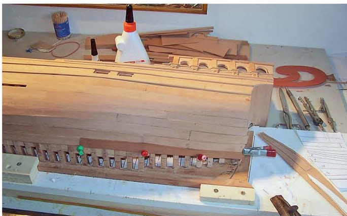
▲ Die fast fertige Außenbeplankung
