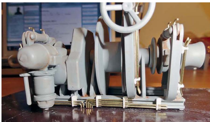
▲ Die Ankerwinde mit zusätzlichen Hydraulikleitungen aus Messingdraht
