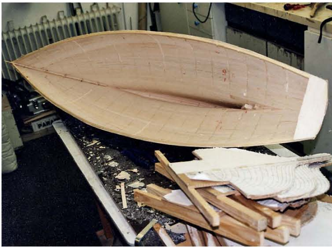
Nach dem Abnehmen des Modells von der Bauhelling wurden alle Spanten entfernt
