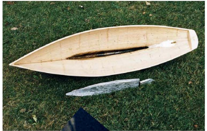
▲ Das Blei nach dem Eingießen wieder aus dem Rumpf entfernt
