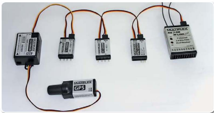
So sieht eine komplette Sensorkette aus, das GPS bildet dabei immer den Abschluss
