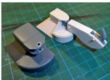
► Der Schlepphaken: links die Tiefziehteile aus dem Baukasten und rechts der Eigenbau aus Polystyrol
