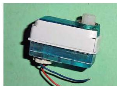
▲ Ein umgebautes Mikroservo dient als Antrieb für das Radargerät
