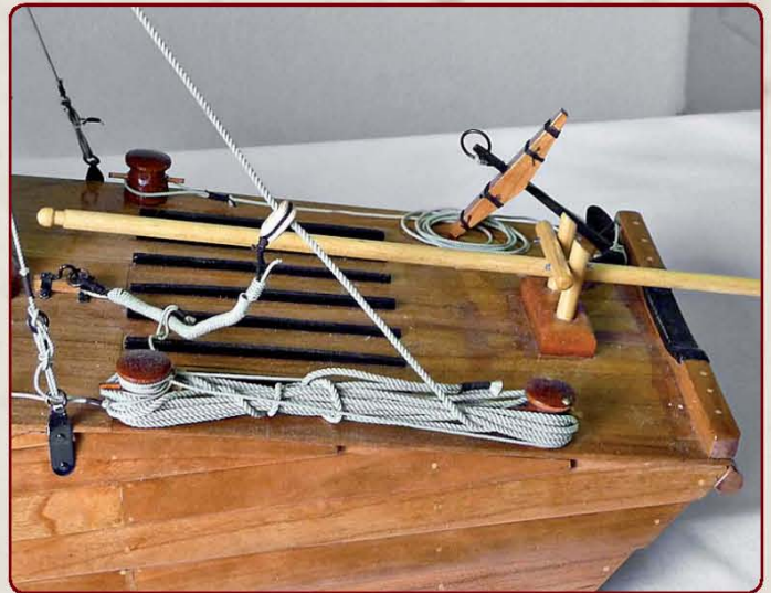
Der „Steuerstand“ – über das Ruder am Heck wurde das Schiff gesteuert
