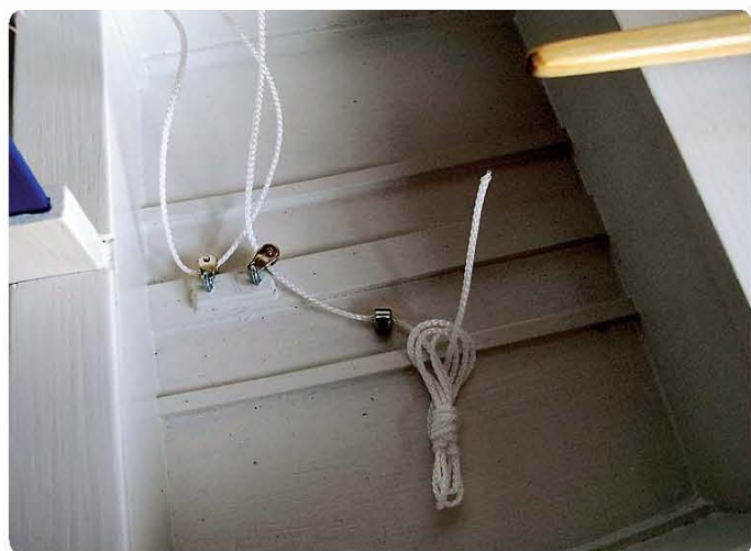
▲ Mit dem Stelling lässt sich die Schotlänge sauber einstellen
