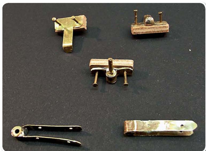
▲ Die Ruderbeschläge aus 0,5-mm-Messingblech
