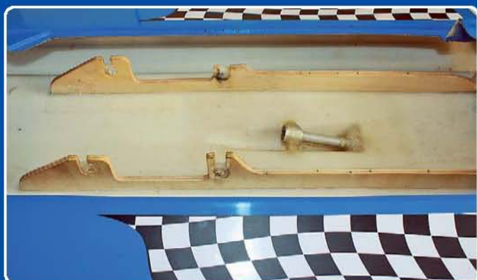
Nach Demontieren der Originalteile wurde der Spant herausgetrennt
