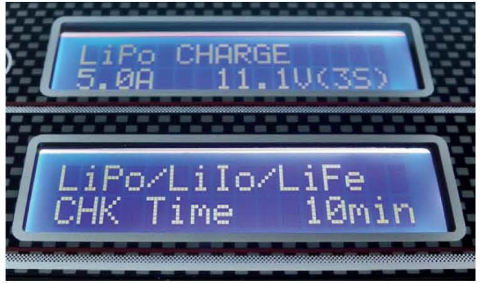
Eine zeitgesteuerte Abfrage verhindert Frühabschaltungen durch Messfehler; die Zeit ist natürlich einstellbar
