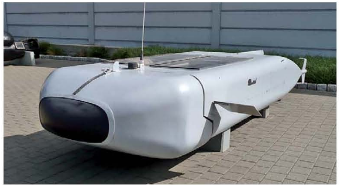
Das waffenlose „Swimmer Delivery Vehicle“ (SDV) erweiterte die Einsatzreichweite von Kampfschwimmern und Marinetauchern
