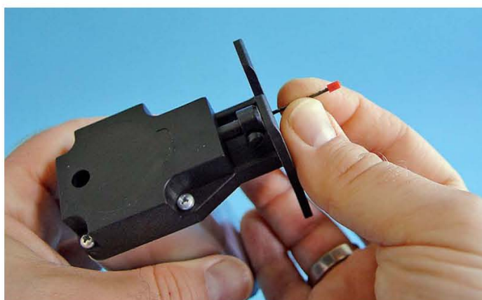
Das Sägeblatt wird in den Halter eingesteckt...
