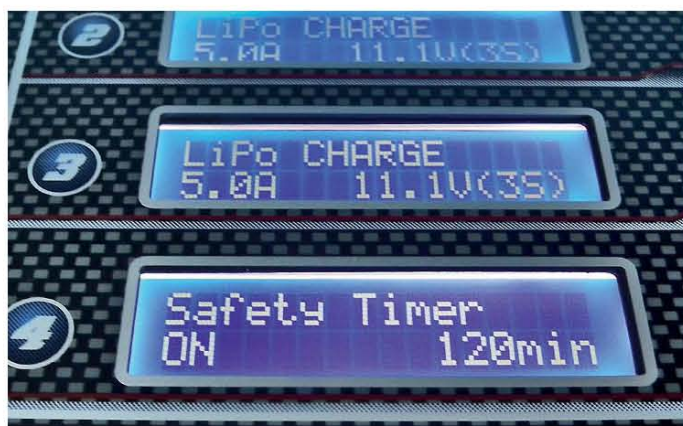
Um Überladungen zu verhindern, kann jeder Ladevorgang nach einer frei wählbaren Zeit automatisch unterbrochen werden. Hier ist nach zwei Stunden Schluss
