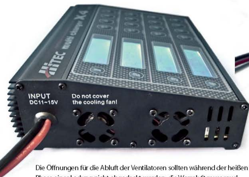
Alle Anschlüsse sind auf einer Seite untergebracht; das wird bei den Balancerkontakten eng, wenn vier Akkus dran hängen
