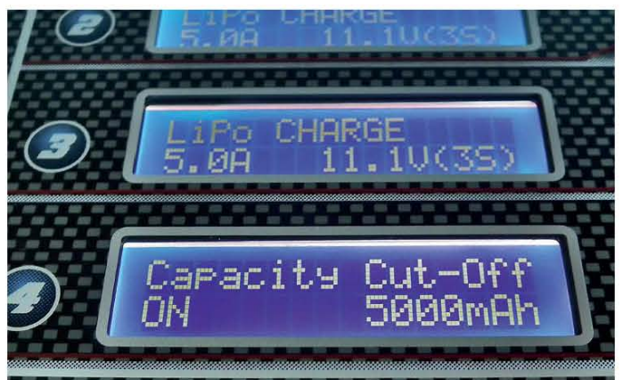
Neben der normalen Voll-Erkennung und einer zeitgesteuerten Sicherheitsabschaltung kann auch eine Kapazitätsgrenze zur Beendigung einer Ladung herangezogen werden
