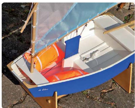
▲ Auftriebskörper und Schwertsicherung im fertigen Modell
