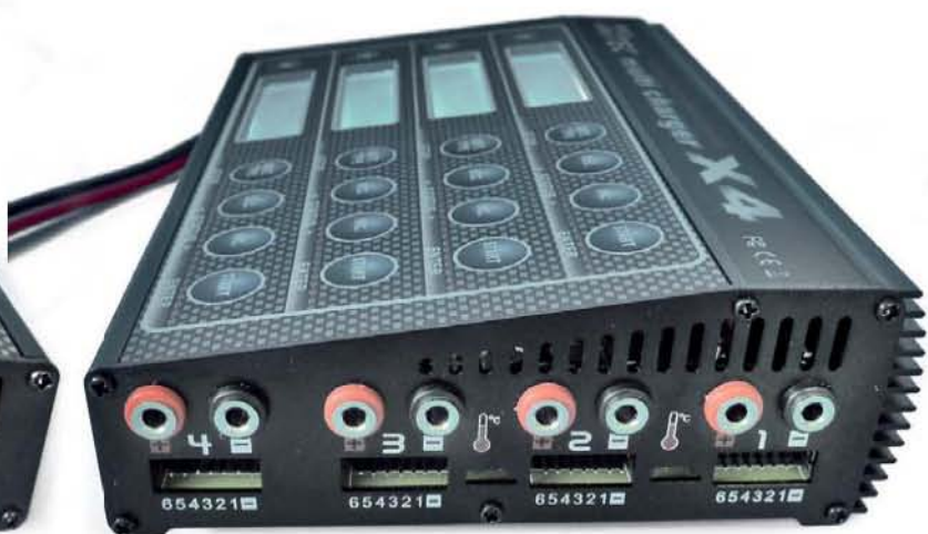
Alle Anschlüsse sind auf einer Seite untergebracht; das wird bei den Balancerkontakten eng, wenn vier Akkus dran hängen
