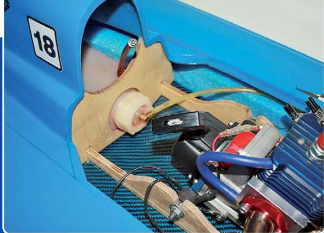
Der viereckige 500-ml-Tank und die Aufbauverstärkung
