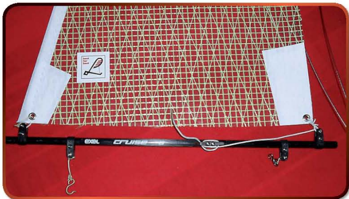
Die Segel aus Mylar/Kevlar-Gewebe von der Segelmacherei Latsch
