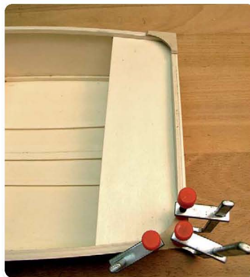
◀ Aufkleben der Eckverstärkungen
