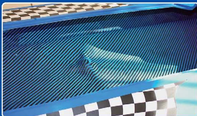
Das ausgelegte Gewebe ist bereit zum Laminieren
