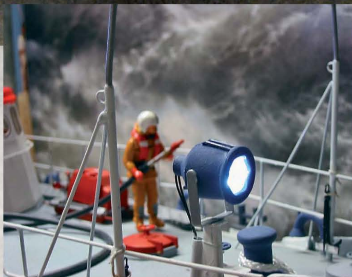
Selbstbau des Bugscheinwerfers aus einer Schlüsselampe mit LED
