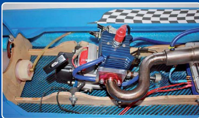
Originalkrümmer und Motorflansch wurden weiterhin verwendet
