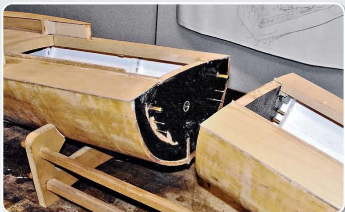
Der Rumpf ist teilbar ausgeführt, was den Transport erheblich erleichtert
