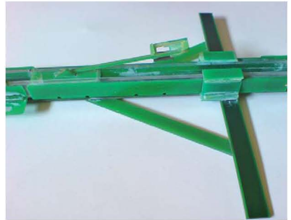
▲ Das Gewinde wurde an dieser Stelle entfernt, damit die Schlitten keinen Vortrieb mehr haben
