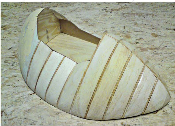
... und anschließend mit dem Bandschleifer geglättet
