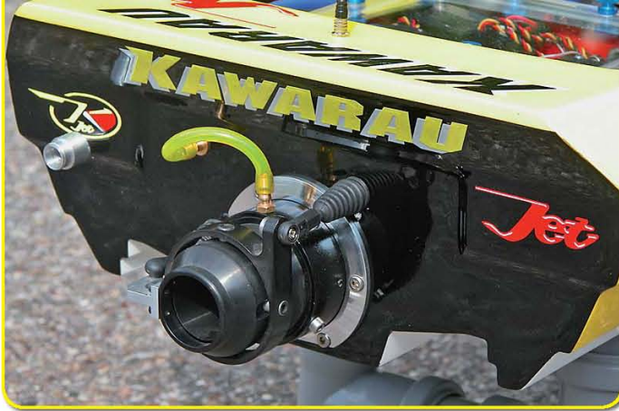
Bootsheck mit Jet-Antrieb, Auspuffauslass und Wasseraufnahme im Jet
