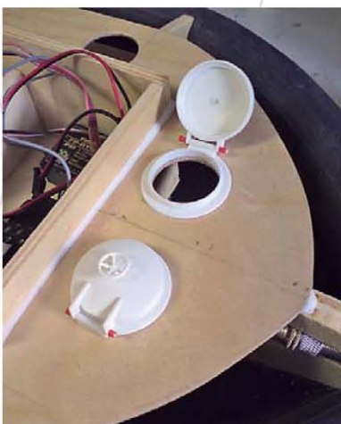
Die Mannlochdeckel von GB-Modellbau verschließen die Bohrungen im Deckel
