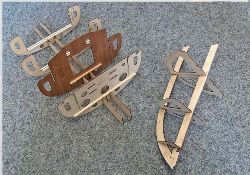
► Bug- und Mittelsektion im Bau
