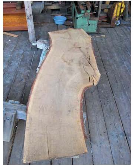
▲ Krummholz – im Schiffsbau einmal das meistbegehrte Baumaterial
