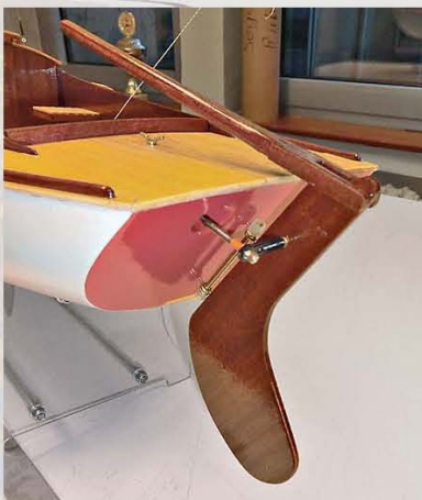
Das fertige Ruder mit Bowdenzug
