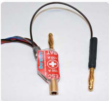
Der Stromsensor; mit seiner Hilfe lassen sich die Leistungsdaten ermitteln
