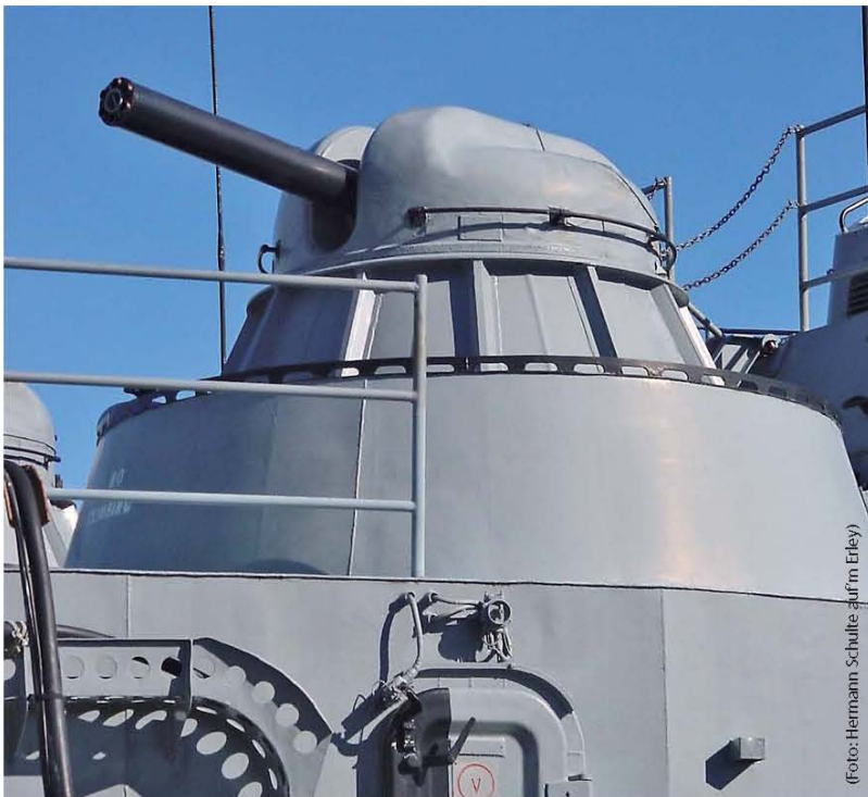
30-mm-AK-630-Gatling auf dem DDR-Raketenschnellboot Hiddensee . Das Boot liegt heute im Battleship Cove Museum in Fall River, Massachusetts.
