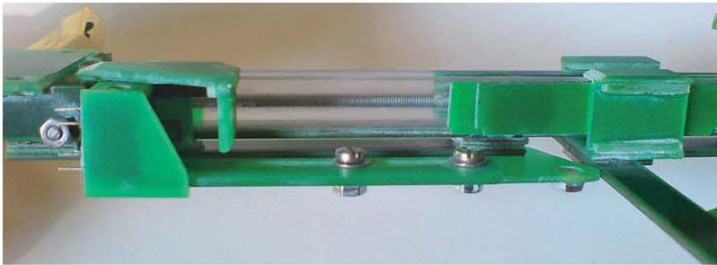
▲ Die Verlängerung für die Heckklappenmechanik, in der Mitte fährt der Schlitten für den Zugdraht ▼
