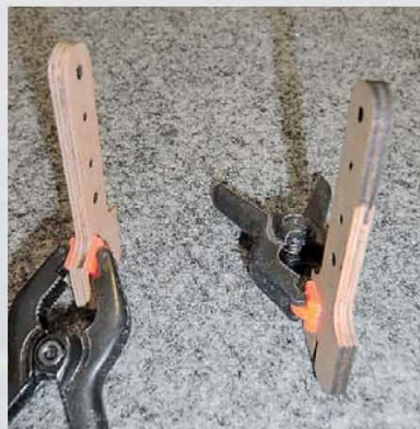
Der Maststuhl: sichtbare Kanten der laserschnittenen Teile müssen sorgfältig geschliffen werden
