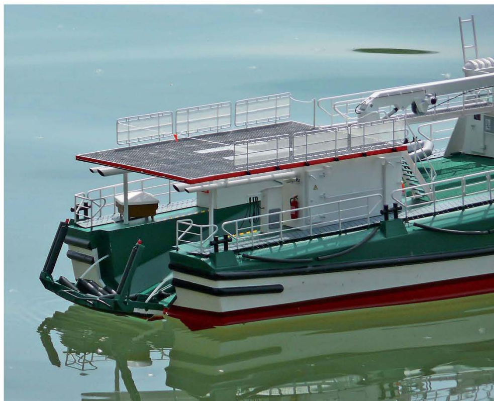
▲ Die fertige Tochterbootwanne mit Aufzugsmechanik
