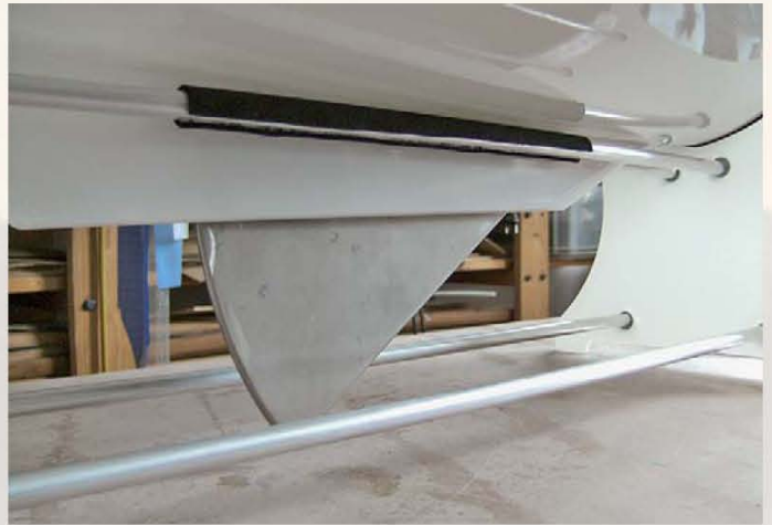
Ein Schwert aus Edelstahl ersetzt das Kunststoffschwert
