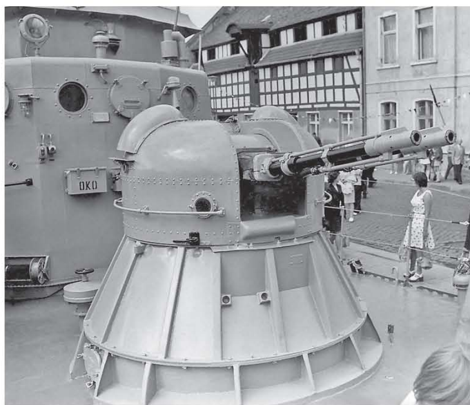
AK-230 auf der Back eines polnischen U-Jägers der Obluze -Klasse. Man erkennt deutlich zu Rohrleitung für die Flüssigkeitskühlung und unten den angepassten Deckssockel. (Foto: Jürgen Eichardt)
