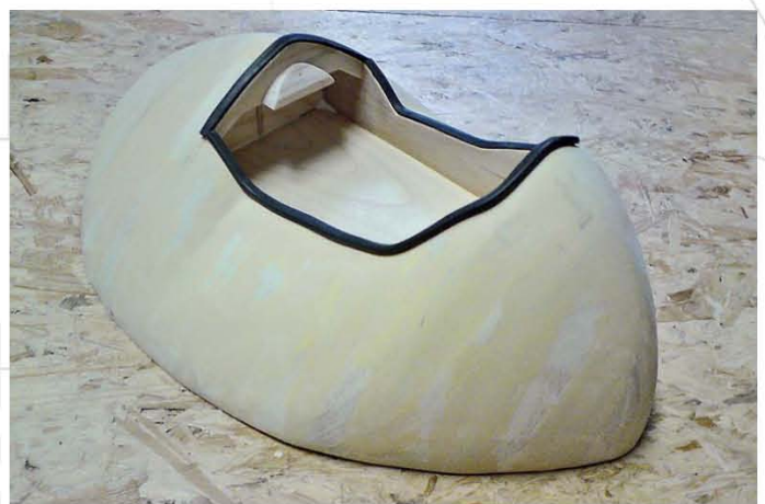
Mit Spachtelmasse und Schleifpapier wird die Oberfläche des Aufbaus für den Auftrag der Grundierung vorbereitet
