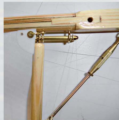
Falsche Befestigung des Großsegels; nach Plan sitzt es zu tief und kann sich nicht drehen
