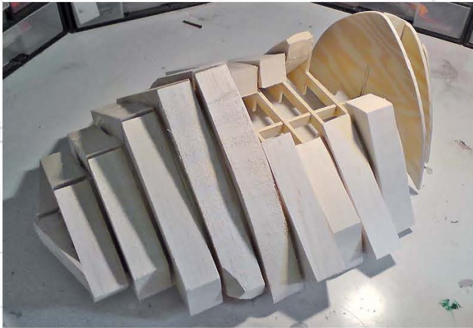
Das Spantengerüst wurde mit Balsaklötzen aufgefüttert, ...
