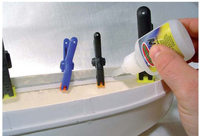
▼ Die Decksauflagen bestehen aus Polystyrolleisten, die mit Sekundenkleber befestigt werden
